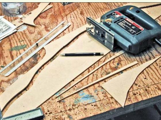
Die Unterlagen für die zwei Stützmauern werden aus einer 3 mm dicken MDF-Platte freihand ausgeschnitten.
