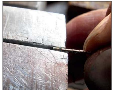
Falls die Öffnung im Röhrchen noch nicht groß genug sein sollte, könnte man noch mit einem 1-mm-Fräser nacharbeiten. Zur Überprüfung wird ein Magnet eingeschoben; die übrigen Magneten unterstützen dabei das Einfädeln. (Wenn nur der Schraubstock nicht aus Eisen wäre ...)
