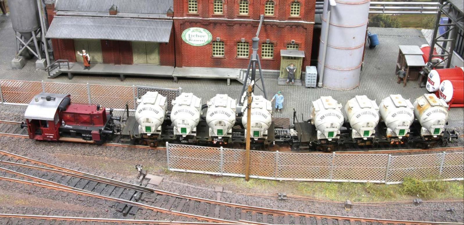
Die Köf drückt die vierständigen Behältertragwagen BTMs 55 über den Entladesumpf. Durch die Neigung der Behälter kann das lose Malz aus den halbrunden Auslauföffnungen direkt in den „Sumpf“ rieseln und wird von dort aus mit Förderbändern oder Schnecken über weiterführende Leitungen in den Produktionsablauf befördert.
