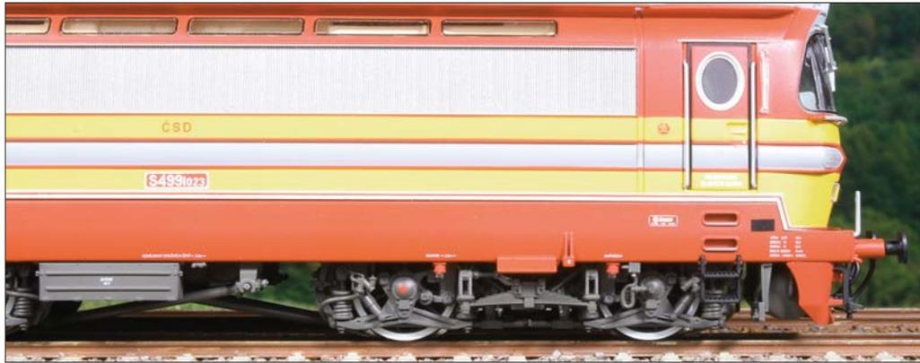
Die filigranen und fein durchgestalteten Drehgestelle verleihen der Lok sehr hohe Vorbildtreue. Zwischen den Radsätzen ist die Blattfederung zu erkennen. Auch die Sandfallrohre und die Bremsgestängesteller sind separate Bauteile. Lackierung und Bedruckung der Zierlinien sind gestochen scharf.
