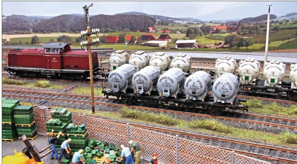
In Behältertragwagen können sowohl Rohstoffe als auch das Fertigprodukt Bier mit der Bahn transportiert werden. Mit den geschlossenen Efk-Behältern könnte beispielsweise Malz geliefert, mit den Kesselbehältern (Ddtkr-Behälter) das fertige Bier abgefahren werden.
