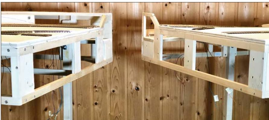
Zum Verbinden der Segmente dienen die Sperrholzzuschnitte mit korrespondierenden Löchern für M6-Maschinenschrauben in den Kopfteilen.
