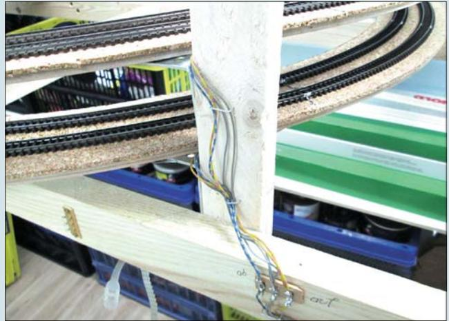
Bei der Wendel werden die Stützpfosten zur Kabelführung mit herangezogen. Auf Lötösenleisten werden die Stränge gesammelt, teilweise zusammengeführt und weitergeleitet.
