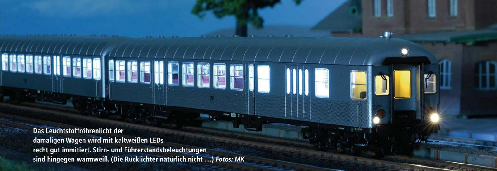
Das Leuchtstoffröhrenlicht der damaligen Wagen wird mit kaltweißen LEDs recht gut imitiert. Stirn- und Führerstandsbeleuchtungen sind hingegen warmweiß. (Die Rücklichter natürlich nicht ...) Fotos: MK
