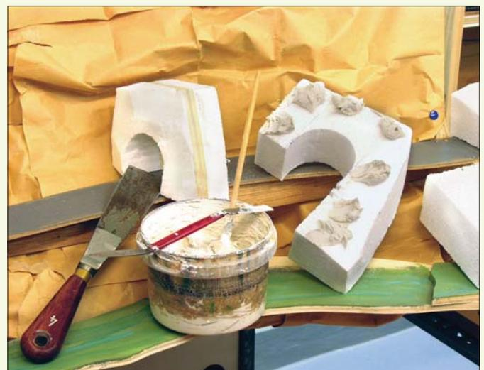
Die einzelnen Segmente werden mit Ansetzgips miteinander verbunden. Der Gips wird großzügig mit dicken Klecksen aufgebracht, um eine satte Verbindung zu gewährleisten. So kann ich die Segmente in ihrer Endposition dem genauen Straßenverlauf anpassen.
