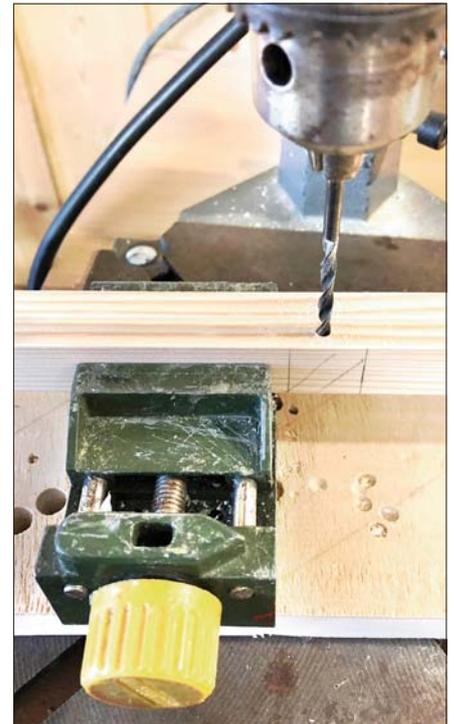
Mit einer Standbohrmaschine werden die Löcher für die Schrauben in die hochkant stehenden Leisten gebohrt.
