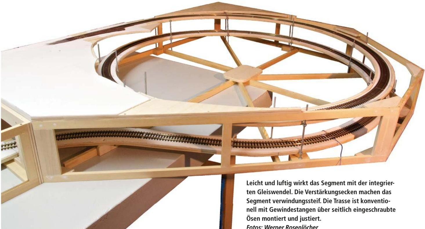
Leicht und luftig wirkt das Segment mit der integrierten Gleiswendel. Die Verstärkungsecken machen das Segment verwindungssteif. Die Trasse ist konventionell mit Gewindestangen über seitlich eingeschraubte Ösen montiert und justiert.
