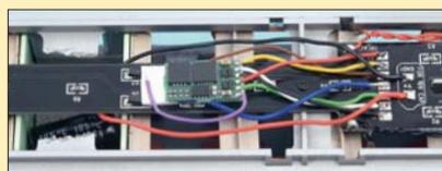
Der Stützkondensator wird an V+ und GND angelötet. Achtung, die Beschriftung der Platine ist falsch; der verwendete Kondensator muss bis 35 Volt stabil sein! Kondensatoren bis 7 mm Durchmesser passen unter das Dach. Dickere können im Einstiegsbereich versteckt werden. Damit der Kondensator effektiv angesprochen wird, muss noch die Stromsparfunktion des Decoders deaktiviert werden: CV 137 = 2.
