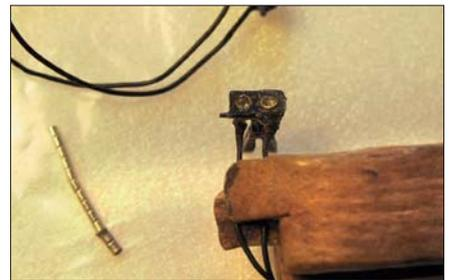
In die Stirnseiten der Schaku-Attrappen werden nun zwei 1,3-mm-Löcher gebohrt, und zwar beginnend mit 0,5 mm in 0,2-mm-Stufen bis zum Zielwert von 1,3 mm. Bei hinreichend präziser Positionierung haben die Röhrchen ringsum gleichmäßigen Abstand zu den Rändern.
