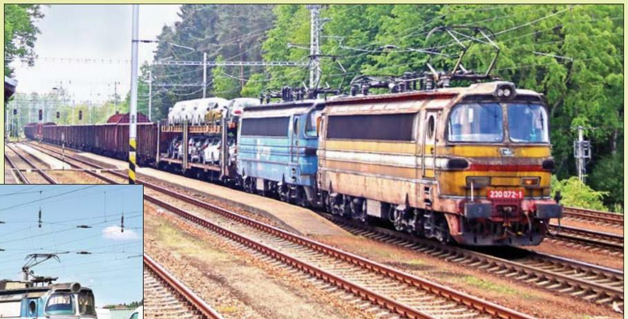
Für den grenzüberschreitenden Verkehr nach Summerau (Österreich) baute die CD 2001 bis 2004 drei Loks der Baureihe 240 in die Mehrsystembaureihe 340 um. Neben dem ursprünglichen Stromsystem von 25 kV/50 Hz können die Loks nun auch unter 15 kV/16,7 Hz nach Österreich fahren. Die Loks erhielten zudem einen Neuanstrich.
