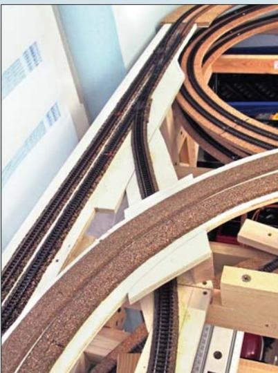
Während im verdeckten Bereich flächig verlegte Korkplatten für die Dämmung sorgen, übernehmen im sichtbaren Bereich industriell gefertigte Korkgleisbettungen diese Aufgabe.
