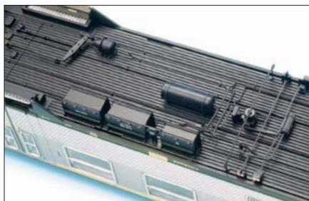
Der Unterboden zeigt die vollständig nachgebildete Bremsanlage sowie die Batteriekästen.
