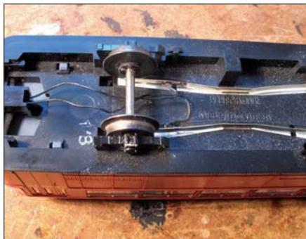
Unten: Die eingebaute Scharfenbergkupplung. Man erkennt noch die Spuren vom Entfernen überschüssigen Leitsilbers. Abschließend wird die Fläche noch schwarz eingefärbt, wozu sich nicht nur Lack, sondern – wegen der viel dünneren Schicht – auch ein Edding sehr gut eignet. Auf einer Tillig-Weiche mit 600-mm-Abzweigradius wird zum Schluss noch die Funktionalität erprobt (der Papierstreifen dient nur der besseren Erkennbarkeit). Fotos: Dr. Horst Berneth
