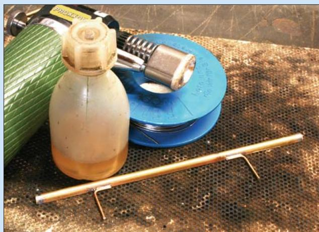
Die Dachrinnen entstanden aus Messing; die Halter, mit denen sie an das Dach geklebt werden können, wurden angelötet. Feine Halter aus Messingguss für die Regenfallrohre sind zudem beim Studio 95 zu bekommen.
