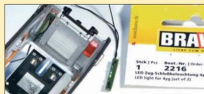
Die Zugschlussbeleuchtung (Art.-Nr. 2216) umfasst eine LED und einen Widerstand. Schlitzlötlitze neben den Schlussleuchten halten die Platinen in der korrekten Position. Das Kabel am Widerstand wird an V+ gelötet.
