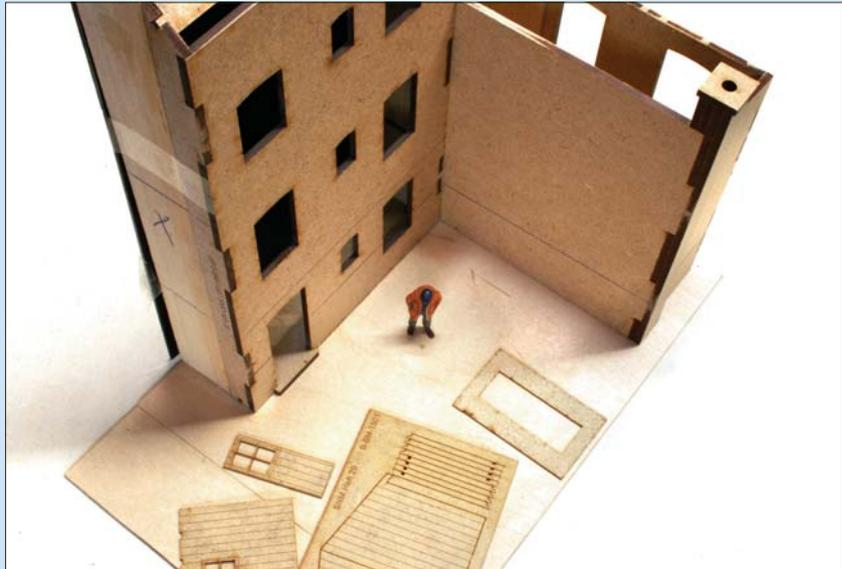
Die Bauteile bestehen aus gelaserten MDF-Platten, der kleine Schuppen ist aus Sperrholz. Die Hintergrundgebäude in zwei Ausführungen können übrigens immer noch über die Internetseite des Spur-0-Magazins bestellt werden ([www.spurnull-magazin.de](http://www.spurnull-magazin.de)).
