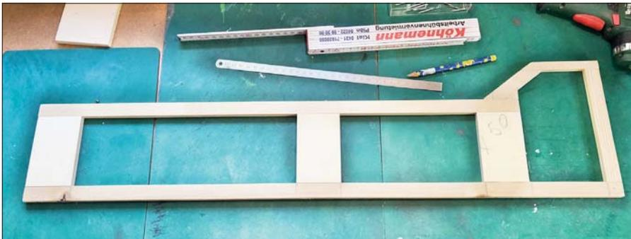
Das Kopfteil für ein Segment mit Sperrholzzuschnitten für die senkrechte Ausrichtung.
