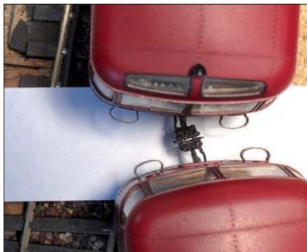
Öffnung auf 1,3 mm aufgebohrt und darin ein 1,3-mm-Messingrohr mit dünnflüssigem Sekundenkleber befestigt. Schließlich wird das Messingrohr auf die Dicke der Deichsel abgelängt, verschliffen und auf 1 mm aufgebohrt. Die fertigen Deichseln werden zusammen mit dem Frontstück eingeschoben so eingebaut, dass das Messingröhrchen auf den Lagerzapfen am Fahrzeugboden gleitet.
