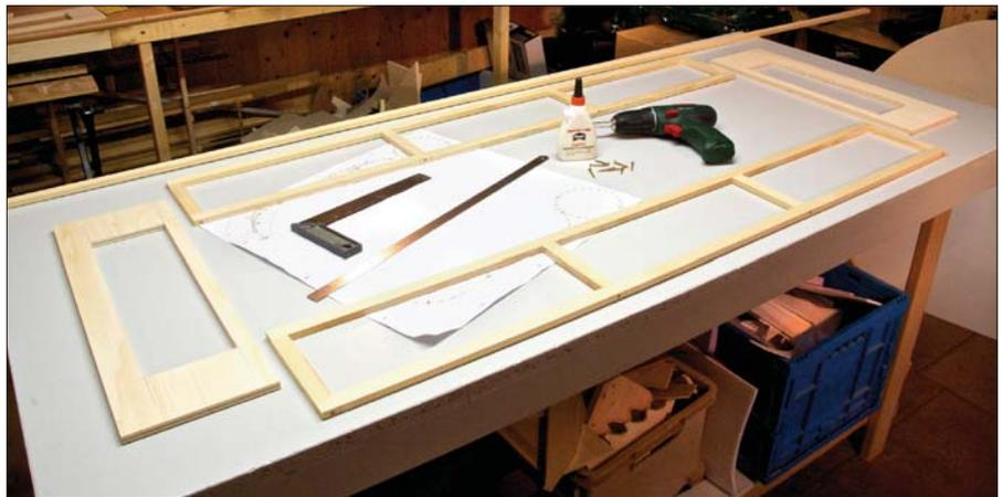
In einer Entwicklungsphase bis zur aktuellen Bauweise wurden für die Kopfteile der Segmente Sperrholzzuschnitte verwendet. Die Montage der Leistenrahmen für die Seitenteile erfolgt auf einem planen Arbeitstisch.
