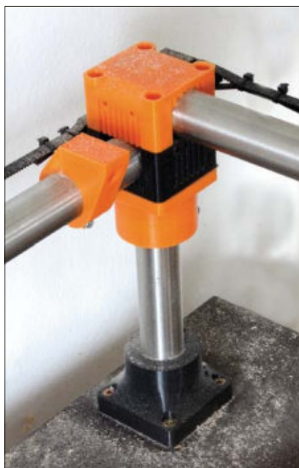
Die gedruckten Teile dienen der Montage der Stangen, Stützen und sonstigen Teile der CNC-Fräse. Fotos: Arnold Humer
