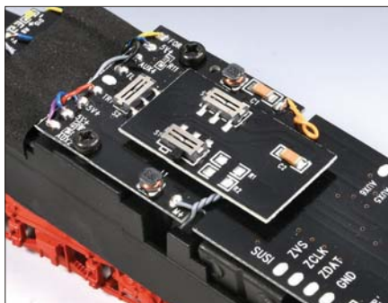
In der PluX22-Schnittstelle steckt bei der Digitalversion ein Sounddecoder.
