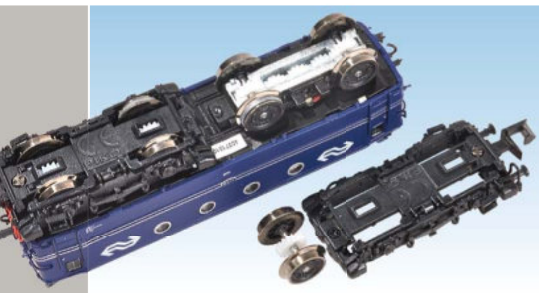
Nach Lösen einer Schraube lässt sich die Drehgestellblende aus den Rasten lösen und die Achsen können getauscht werden. Fotos: gp
