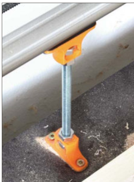
Die gedruckten Teile dienen der Montage der Stangen, Stützen und sonstigen Teile der CNC-Fräse. Fotos: Arnold Humer
