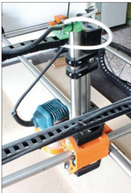
Der Schrittmotor der Z-Achse verfährt den Fräsmotor über eine Gewindestange und ist über eine gedruckte Spannzange befestigt.
