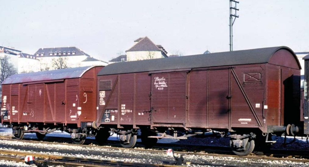
Der Vergleich zwischen dem Gm 202 103 0 733 mit neuen Lade- und Lüftungsklappen (vorn) und dem Gm 200 145 0 894 (dahinter), aufgenommen im Januar 1967 in Stuttgart Hgbf, zeigt den Unterschied zwischen den beiden Gm(s) Bremen. Foto: Fritz Willke, Slg. SC
