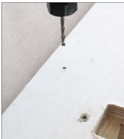
Hilfreich ist ein im Werkstücknullpunkt gebohrtes Loch als Referenz im Falle eines Rechnerabsturzes.
