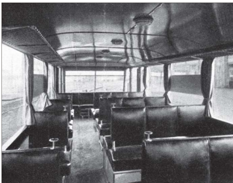
Gepäcknetze und Ledersitze wie im Omnibus, Letztere allerdings in der „eisenbahnüblichen“ Sitzteilung 1+3. Bemerkenswert auch die Haltegriffe an den Rückenlehnen.
