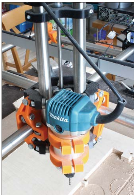
Für die unterschiedlichsten Fräsmotoren gibt es im Internet bei Thingiverse entsprechende Aufnahmen (Support).
