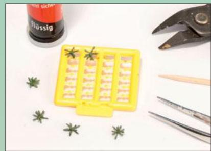
Die beiden zusammengehörigen Teile mit den Blättern werden aus dem Rahmen geschnitten und dann mit kleinsten Mengen von Sekundenkleber fixiert. Ein Zahnstocher dient zum Auftragen des Klebstoffs. Etwas „Fummelei“ ist das Befestigen der Blätter an der Blüte. Man sollte zunächst nur jede zweite Blüte mit dem „Grünzeug“ bestücken, denn sonst wird es auf dem Spritzling schnell zu eng.
