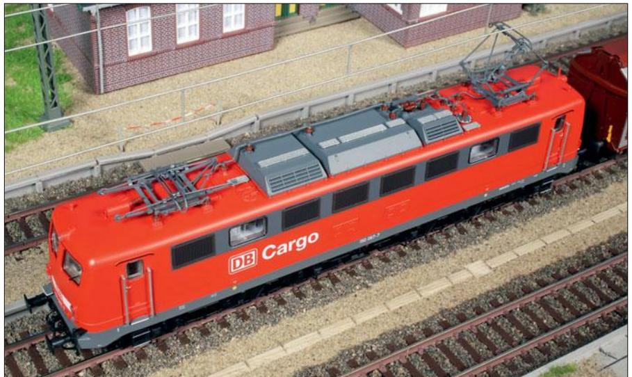
Die Dachaufbauten wirken sehr fein. Korrekt nachgebildet ist die Dachstromleitung mit den Stützisolatoren auf den Dachhauben. Der Hauptschalter befindet sich bei der E 50 über Führerstand 2. Die lackierten Gitterroste zeigen eine fein gravierte Struktur.
