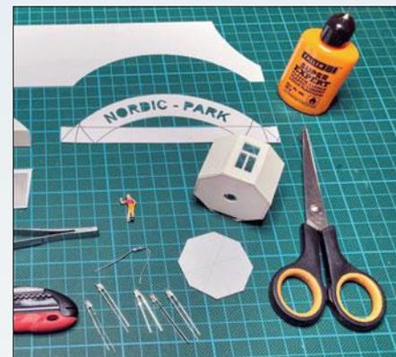
Der Eingangsbereich entstand im Selbstbau aus 1 mm dicken Polystyrolplatten.
