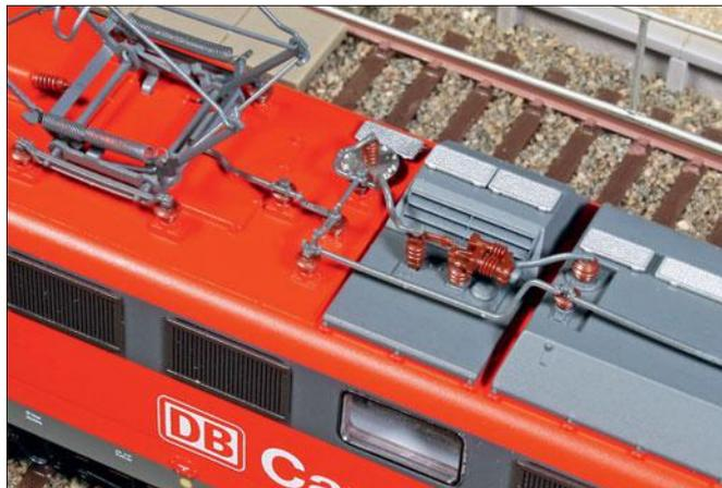
Die Hochspannungsausrüstung der Lok auf dem Dach. Die Hochspannungsleitung verbindet beide Stromabnehmer und führt zum Trenner. Oben erkennt man die Durchführung des Oberspannungswandlers, rechts daneben den Druckluft-Hauptschalter und die Durchführung zum Transformator.
