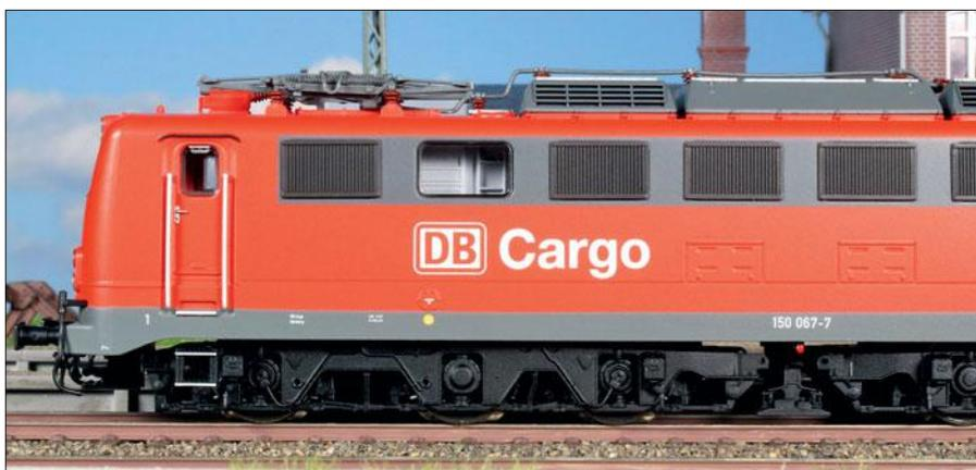
An den Drehgestellseitenwangen sind die Tritte und Sandbehälter angesetzt. Im Inneren überzeugen die Fahrmotoren und die Bremssohlen mit dem unten angebrachten Bremsgestänge. Sehr vorbildnah ist auch der flach auf dem Dach liegende abgesenkte Stromabnehmer.
