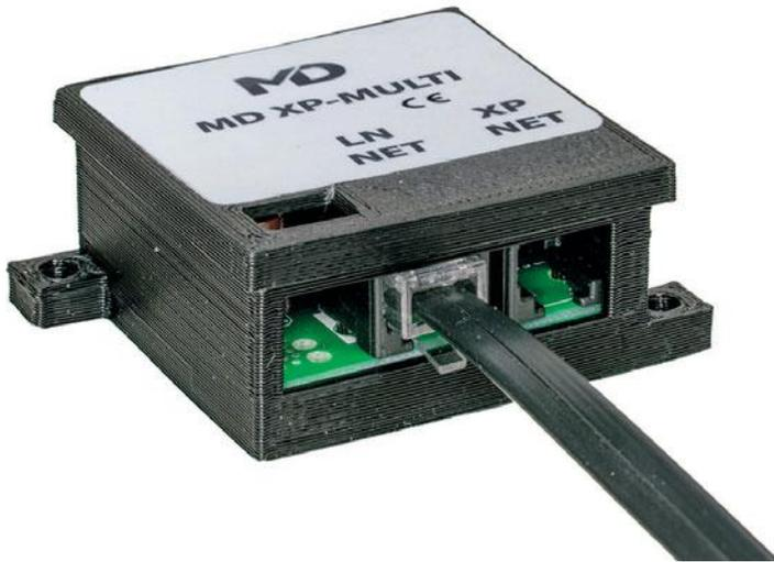
Das ca. 42 x 44 mm messende Gehäuse beherbergt zwei Buchsen und einen WLAN-Sender/-Empfänger. Damit kann das XP-MULTI ein eigenes Funknetz aufspannen, das ohne Verbindung zum Internet bzw. dem übrigen Netzwerk im Haus arbeitet oder sich kabellos in bestehende Netzwerke integriert.
