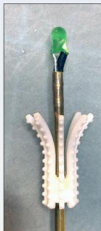
Einige Schmuckelemente der Fahrgeschäfte wurden noch zusätzlich mit LEDs ausgestattet, wie hier die Kronen der „Wilden Maus“. Die auf einem Messingröhrchen installierte LED wurde von oben in die Krone eingeführt und sorgt für die ansprechende Illuminierung.
