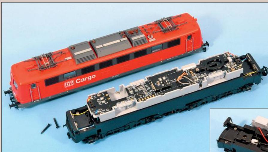
Das Gehäuse lässt sich nach Lösen zweier Schrauben abheben. Darunter befindet sich eine Motorabdeckung aus hellgrauem Kunststoff. An dieser Abdeckung ist hinter den Fenstern der Maschinenraum angedeutet. Auf der Abdeckung liegt die Platine mit Next18-Schnittstelle, in die von oben ein Decoder eingesteckt werden kann. Für einen Lautsprecher ist rechts eine Aussparung und eine Halterung vorhanden. Die Aussparung links bietet Raum für einen Kondensator.
