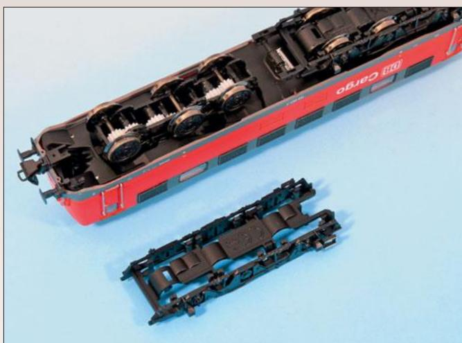
Über Stirnräder werden die beiden äußeren Achsen im Drehgestell angetrieben. Die Außenachsen tragen jeweils einen Haftreifen. An den Getriebeabdeckungen und am Getrieberahmen sind die sechs Fahrmotoren angedeutet (links).
