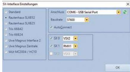
Der die Fahrbefehle führende SX 0-Bus wird wiederum als VSX 2 bezeichnet, alle steuerbaren Fahrzeuge erhalten eine entsprechende Eintragung im erweiterten Translator. Sollen nicht alle stationären Decoder per WLAN-Adapter steuerbar sein, so ist keine pauschale Weitergabe aller Daten vom SX 1-Bus an den RMX 1-Bus einzustellen, sondern statt RMX 1 bspw. VSX 3 zu wählen ...
