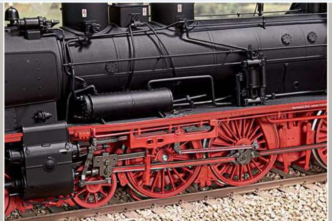
Zwischen Vorwärmer und Führerhaus ragt die Verbund-Speisepumpe mit den dazugehörigen Leitungen durch den Umlauf. Fotos: gp
