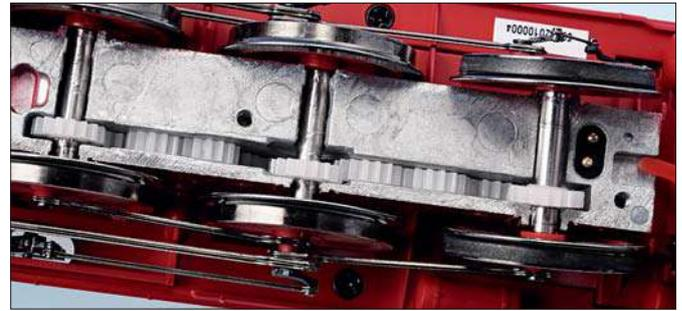
Der Motor liegt zentral in der Lok, versteckt zwischen den Wasserkästen im Kessel. Er treibt über eine Schnecke und eine anschließende lange Reihe von Zahnrädern sämtliche Kuppelachsen an. Trotz der Vielzahl von Zahnrädern läuft die Maschine nahezu lautlos und ist in allen Geschwindigkeitsbereichen gut regelbar. Fotos: MK
