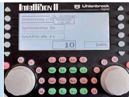
Für den Fahrplan-Betrieb sollte die Zeitverkürzung zwischen 1:3 und 1:8 liegen. Bis etwa 1:15 kann man Nebenuhren ansteuern.
