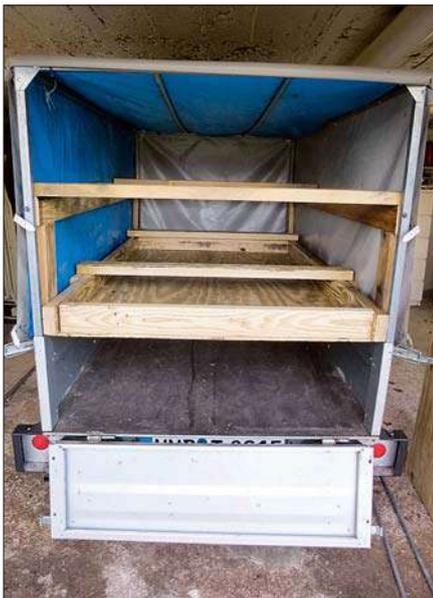
Für den Transport der drei Anlagenteile wurde der Anhänger modifiziert. Dank eines speziellen Gestells werden die Teile in drei Etagen eingeschoben. Weil die drei Etagen die nutzbare Höhe begrenzen, mussten die äußeren Landschaftsteile abnehmbar gestaltet werden.
