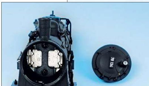
Der Lautsprecher passte so gerade eben in die Rauchkammer. Damit werden die Geräusche des Modells dort abgestrahlt, wo sie in der Mehrzahl auch am Vorbild zu hören sind.
