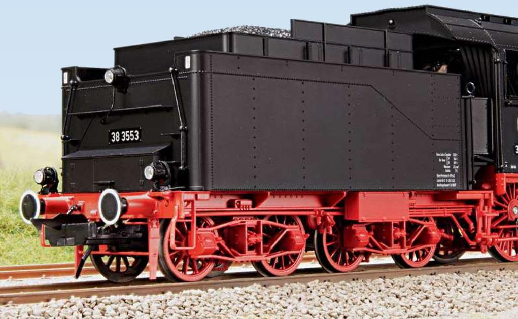
Das Fahrwerk profitiert ebenso von den fein gestalteten Speichenrädern wie von der Steuerung. Die Bremsklötze der aus Kunststoff nachgebildeten Bremsanlage liegen recht dicht an den Rädern. Nachgebildet ist auch der im Rahmen befindliche Bremszylinder. Durch die Speichenräder sind die Federpakete gut zu erkennen.
