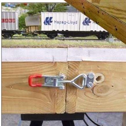
Die Anlagenteile werden mit Spannschlössern fixiert.
