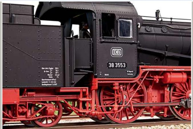
Spaltfreier Übergang für das Lokpersonal und angedeutete Verbindung von Wasser- und Bremsluftleitungen zwischen Lok und Tender
