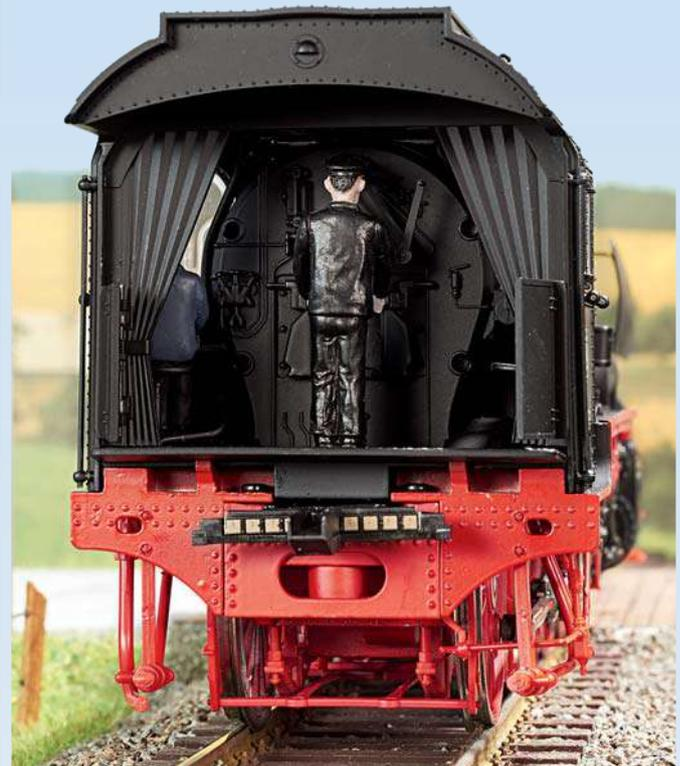
Führerstand mit gestalteter Stehkesselrückwand und Vorhängen. Unter dem Fußboden wird die Deichsel kulissengeführt.
