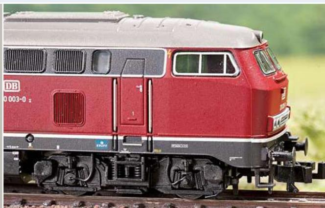
Rahmen und Lamellen der Lüfter sind scharfkantig graviert. Die Details an den Drehstellen sind ebenso fein ausgeführt.
