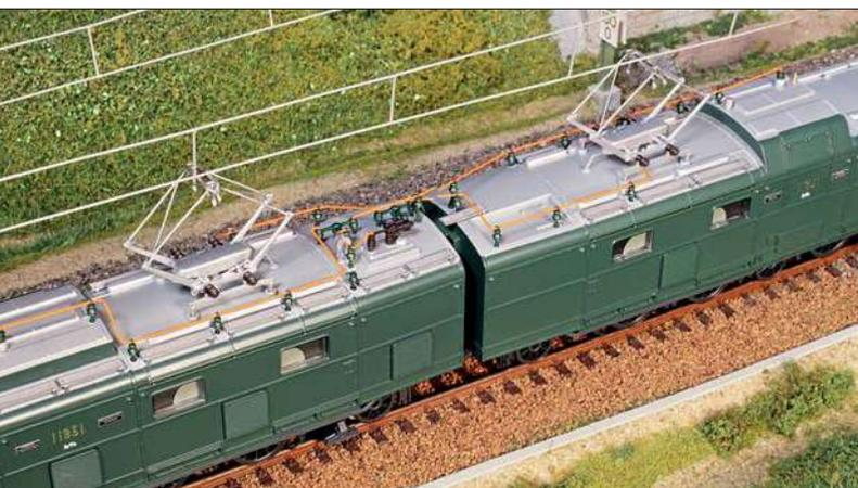
**Die beiden Lokkästen unterscheiden sich im Formenbau. Von oben erkennt man die Hochspannungsausrüstung mit Hauptschalter, die hier nur auf dem vorderen Lokteil verbaut ist. Das Dach besticht durch aufgesetzte und durchbrochene Stege und eine scharfe Farbtrekkante.**
