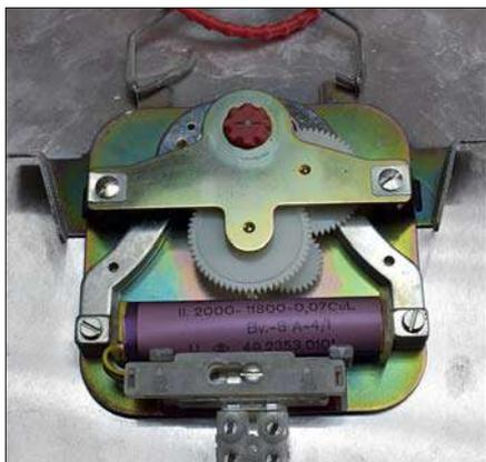
Das Uhrwerk einer Nebenuhr ist so ähnlich wie ein magnetischer Weichenantrieb aufgebaut. Diese Uhr hier lässt sich zwischen 12- und 24-V-Betrieb umstellen.
