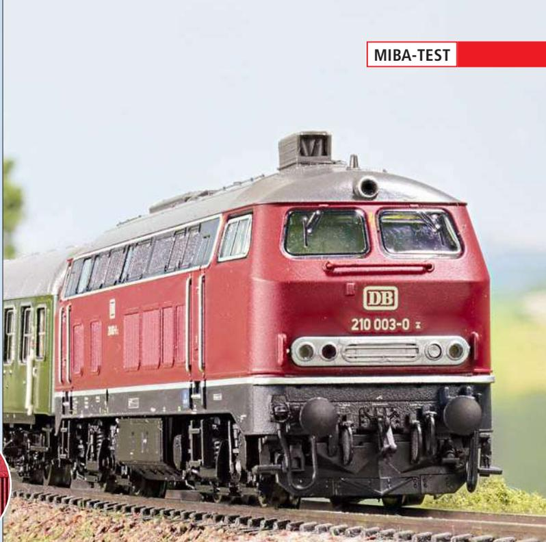
ren Rahmen zeigen sich mit kantigen Strukturen. Das gilt auch für die umlaufende Einfassung des grau lackierten Lüfter- und Fensterbandes. Präzise angefertigt sind die silbern bedruckten Türöffner. Die Aufstiegsgriffe neben den Türen sind ebenso angesetzt wie die Griffstangen unter den Stirnfenstern. Die weit vorstehenden Rangiergriffe neben dem blanken Stahlband sind lediglich angeformt und wirken je nach Blickwinkel wie Fremdkörper.
