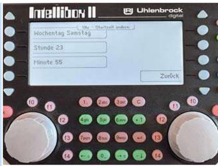
Alle zwanzig Modellminuten wird der aktuelle Wochentag als Laufschrift eingeblendet. Die Geschwindigkeit der Laufschrift kann im Programm eingestellt werden.
