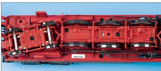
Am Fahrwerk sind nicht nur die Bremsen, sondern auch das Bremsgestänge von Haupttrahnen und Drehgestellen nachgebildet. Bis auf die Treibachse tragen alle Radsätze zur Stromabnahme bei.
