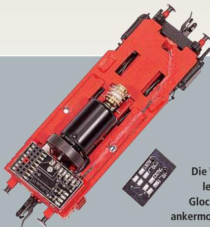
Die Welle des Glockenankermotors trägt eine geschwärtzte Schwungmasse und das Schneckenrad. Der Entstörersatz passt in die PluX16-Schnittstelle.
