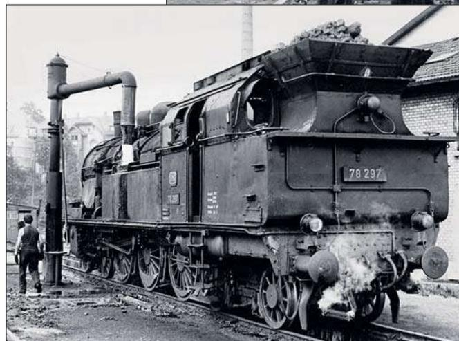
Dass die äußeren Luftschläuche für die Hauptluftbehälterleitung nachträglich angebracht wurden, erkennt man auch an der Rückseite: „Auf Putz“ sind die zugehörigen Leitungen am Umlauf und auf den Pufferträgern verlegt.
