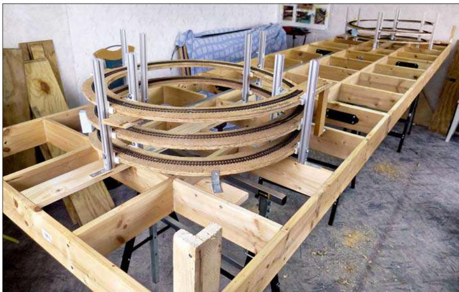
Um Gewicht zu sparen, wurde der Rahmen der dreiteiligen Anlage aus Fichtenbrettern gebaut. Für den Bau der Gleiswendeln kamen quadratische Alunutprofile zum Einsatz. Mit Schrauben und Nutmuttern können die Trassen in der Höhe justiert werden.
