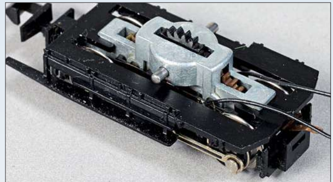
Die Kabelverbindungen werden nach schräg oben weggeführt und durch die neuen Bohrungen im Chassis geführt.
