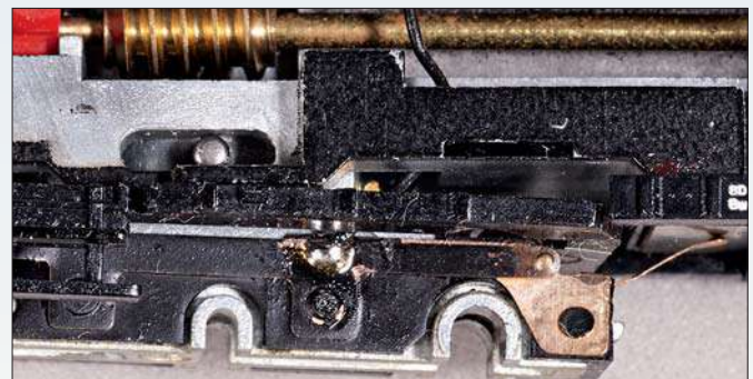
Von der Seite ist die Kabelführung vom Drehgestell durch das Chassis vorbei an der Antriebswelle zur Platine nachvollziehbar.
