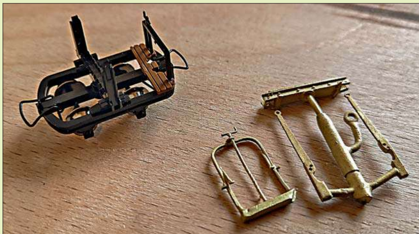
Eine originale Drehschemellore von Minitrains und die Messingussteile für den Drehschemel und die Bremserbühne von Panier. Die hier jetzt nicht verwendeten „Trucks“ sind aber nicht verloren – sie konnten auf der Anlage als Dekoration aufgestellt werden, da sie im Betrieb nicht zum Einsatz kommen.
