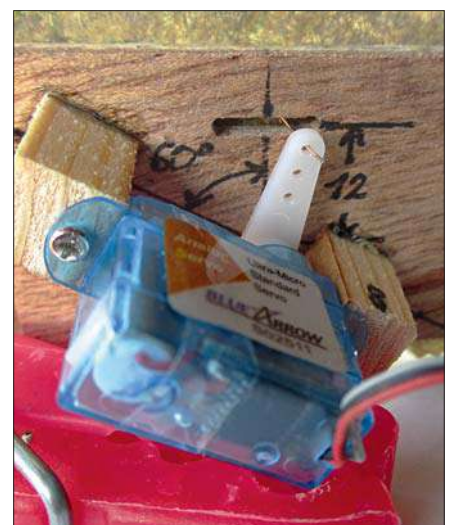
Durch die um 60° verdrehte Montage des Servos stößt der Servoarm nicht an das rechte Holzklötzchen.
