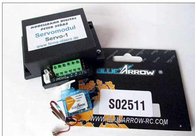
Bewegung ins Spiel bringen das Servomodul und der Miniservo von Stärz. Das Servomodul ist auch als preiswerter Bausatz erhältlich.
