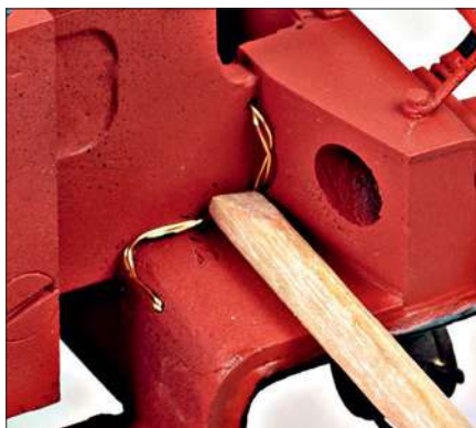
Nach dem Lackieren verschwindet der dünne Kupferlackdraht unscheinbar in der Ecke von Rahmen und Pufferbohle.
