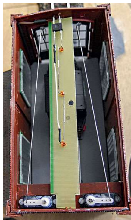
Die Servos sind an der Rückwand des Schuppens befestigt und erfordern zum Öffnen der Tore eine gegenläufige Drehbewegung. Unkontrollierte Bewegungen sind unerwünscht.
