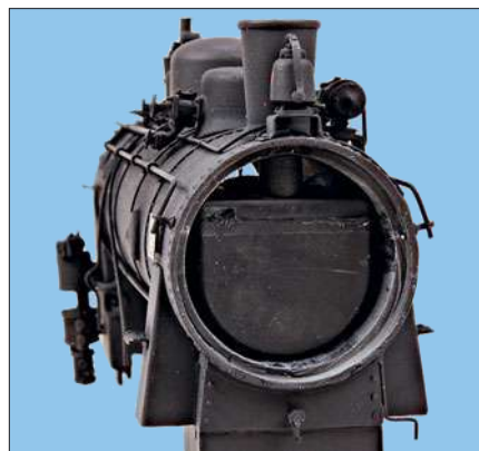
Der Raucherzeuger wird lediglich durch einen durch den Schlot geführtes Messingrohr fixiert – ursprünglich ein Silikonschlauch.
