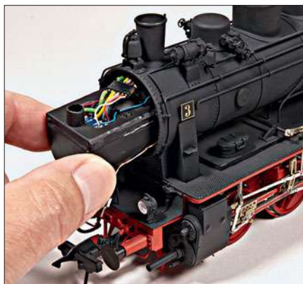
Die Steckverbindung für den Kabelbaum liegt auf dem Raucherzeuger, um ihn bei Bedarf ohne Aufwand ausbauen zu können.
