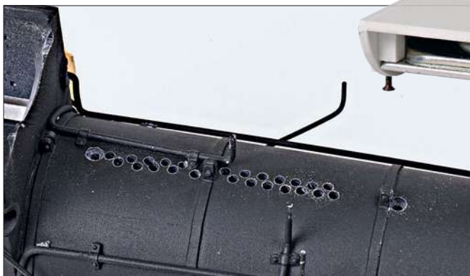
In den Kesselbauch wurden 1,5-mm-durchmessende Schallöffnungen gebohrt, sie sind von der Seite nicht zu sehen.
