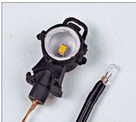
Statt Glühlampen illuminieren LEDs der Baugröße 0603 die Loklaternen. Die LEDs werden „stehend“ in der Laterne fixiert.
