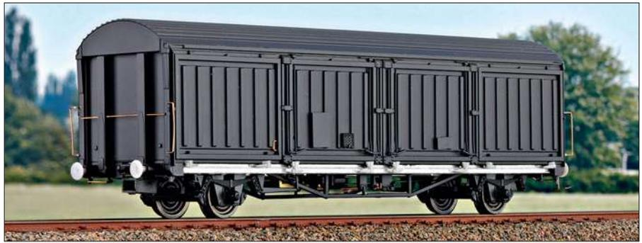
**H0:** Der niederländische Schiebewandwagen Hbis 1930 weist sieben Sicken in den Schiebewänden auf.
