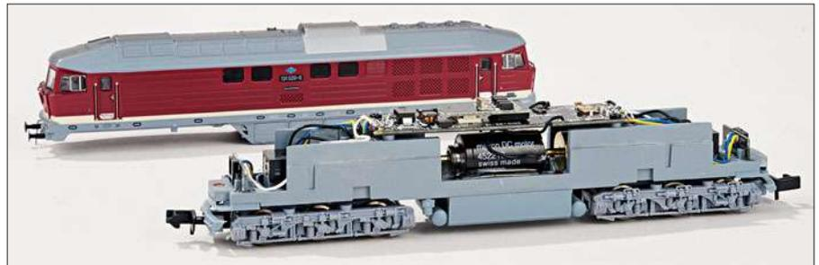
**N:** Antrieb mit Maxon-Glockenankermotor von SB-Modellbau für Ludmilla von Arnold
