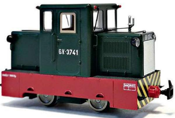
H0e: Die ungarische Schmalspurdiesellok der Baureihe C-50 von Posch-Modell. Das Modell besitzt einen aus Messing gefrästen Antrieb, eine NEM 651-Schnittstelle und eine fahrtrichtungsabhängige Stirnbeleuchtung.
