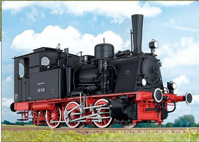
1: 89 7462 dampft mit klassischer Allan-Trick-Steuerung, weißen Radreifen und beschriftet als Maschine des Bw Hamm der BD Essen über die Spur-1-Gleise.
