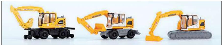
**N:** Der Liebherr-Bagger A922 Litronic hat gleich drei verschiedene Fahrwerke zur Auswahl: Ganz links als Zweibegebagger mit Reifen und Spurkranzrädern, in der Mitte mit normalen Reifen und rechts mit Raupenfahrwerk. Unten der MAN F90 mit Kofferaufbau bzw. als Wechselpritschen-Hängerzug. Neun verschiedene Lackierungen sind angekündigt.
