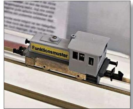
N: Die in die Rangierlok konstruktiv äußerst geschickt und auf originelle Weise integrierte Kupplung ließ bei den zahllosen Modellvorführungen erahnen, mit welcher Perfektion der N-Bahner rechnen kann: Kupplungskopf und Kupplungsaufnahme entsprechen der Norm. Der Entkopplungsmechanismus ist völlig im Fahrzeug verborgen. Entkuppelt wird durch Anheben der Kupplung.
