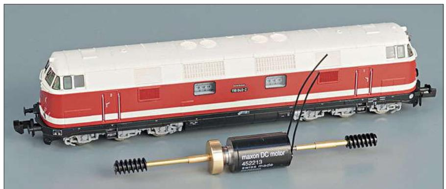
**N:** Motorisierung mit Maxon-Glockenankermotor von SB-Modellbau für Fleischmann-BR 118
