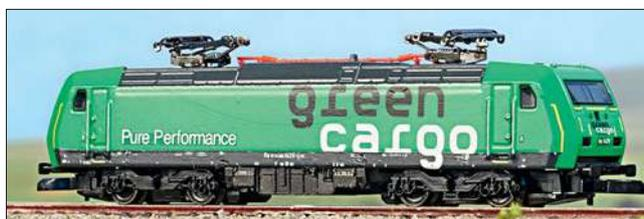
Z: Das feine Modell der „green cargo“-Lok der Reihe RE 14 erhielt (serienmäßig eingebaut) einen Glockenankermotor.
