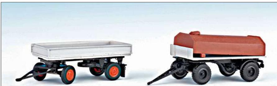
**H0:** Aus dem VEB Fahrzeugwerk Annaburg stammt das Vorbild des Traktorenkippanhängers TZK 5. Die Nutzlast beträgt 4600 kg. Das Modell ist akkurat umgesetzt und trägt sicherlich auch ein paar Gramm ...
