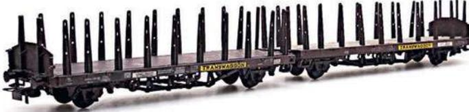
**H0, TT:** Die Flachwagen-Doppeleinheit der Bauart Laas 1 dient überwiegend zum Holztransport. NPE bietet sie jeweils ...
