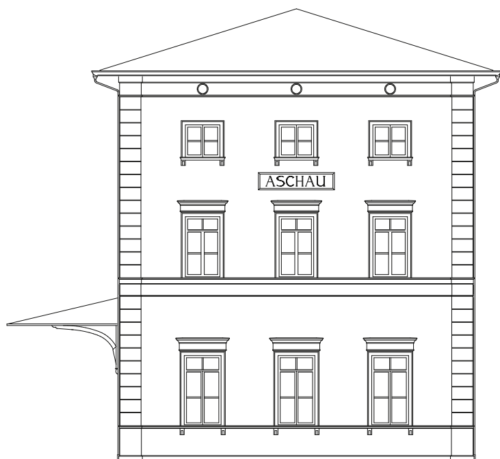
Oben: Seitenansicht des Empfangsgebäudes von Prien aus gesehen, links die Bahnsteigüberdachung
