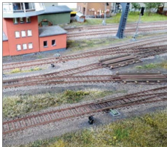
Links: Ansicht einer Hemmschuhauswurfvorrichtung. Eine Zwangsschiene hält die Wagen im Gleis, während der Schuh über das angewinkelte Gleis in das Fangblech rutscht und dort abkühlt.
