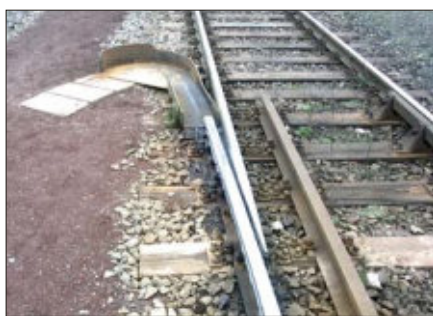
Links: Ansicht einer Hemmschuhauswurfvorrichtung. Eine Zwangsschiene hält die Wagen im Gleis, während der Schuh über das angewinkelte Gleis in das Fangblech rutscht und dort abkühlt.
