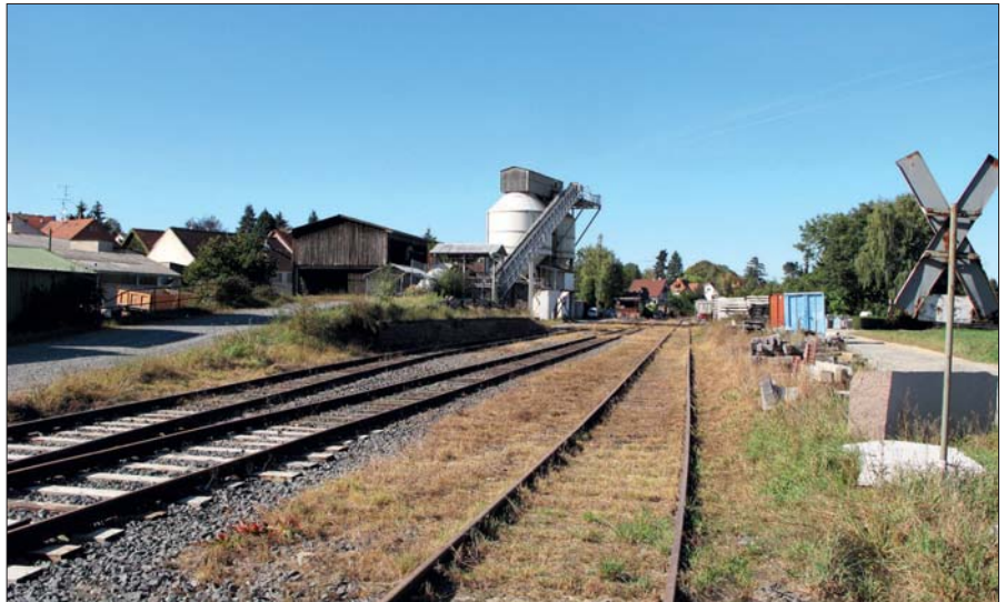
Das Gleisfeld der Schotterverladung in Groß-Bieberau. Das rechte, etwas zugewucherte Gleis ist gleichzeitig das Rübenverladegleis.
