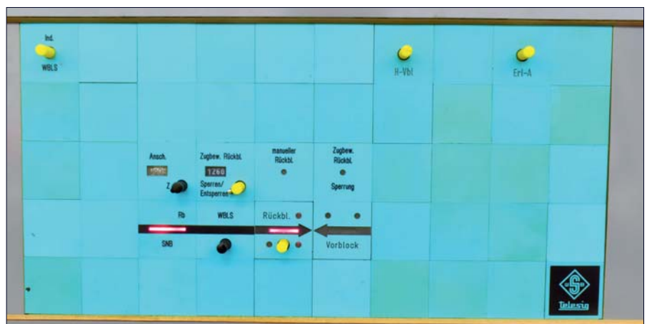
Hier ist ein Zug auf der Strecke von links nach rechts. Die Strecke ist belegt und ein Vorblick ist eingegangen.
