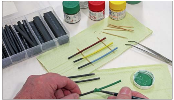
Farbige Pufferhüllen (einseitig oder zweiseitig) ließen sich einfach aus Schrumpfschlauch anfertigen.
