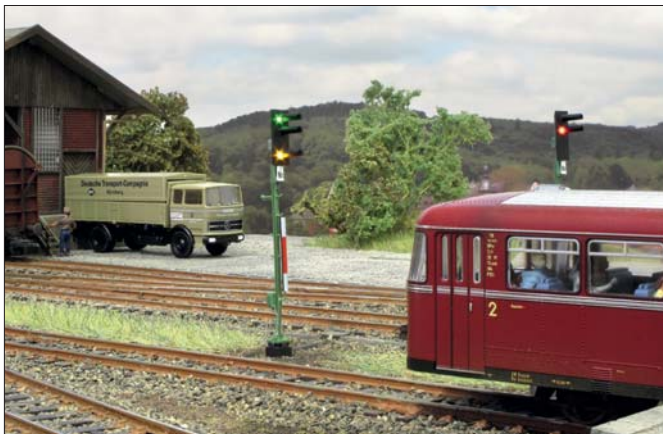
Die vereinfachten Nebenbahnsignale im Bahnhof Jugheim zeigen (bei einer Anordnung ähnlich der Nachtlichtanordnung bei Formsignalen) nur Signalbegriffe für Zugfahrten.
