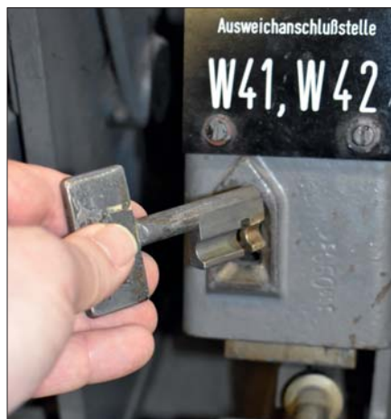
Ein typischer Schlüssel, wie er im Eisenbahnbereich zum Einsatz kommt. Hier bei der Entnahme aus einem Hebelbankschloss.
