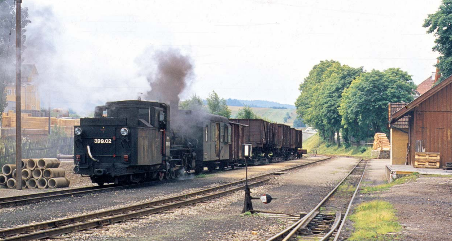
Auf dem Bild oben ist ein Güterzug bestehend aus regelspurigen E-Wagen zu sehen, die mit Rollwagen transportiert werden (Weitra/Waldviertelbahn am 11. Juli 1980). Hinter der 399.02 läuft ein Packwagen und ein Güterwagen. Die Rollwagen wurden meist mit Zwischenwagen hinter der Lok in den Zug eingereiht. Foto: Slg. Sebastian Koch
