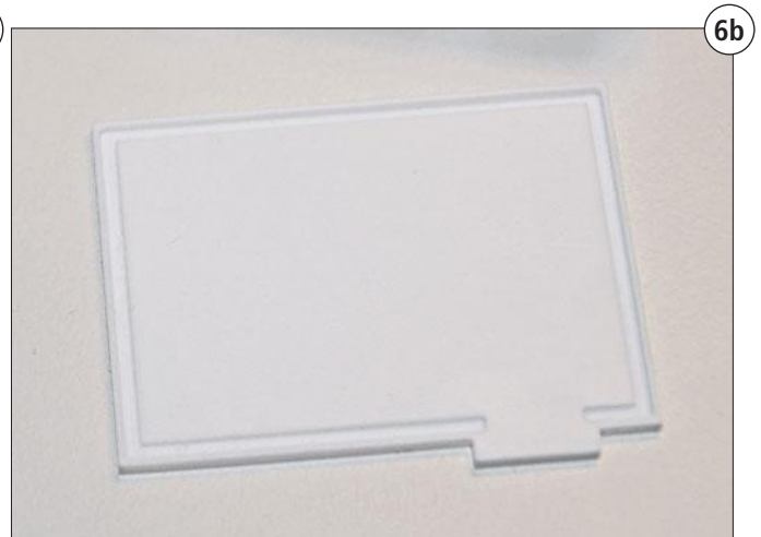
Screenshot von EstlCAM für die Grundplatte mit den Fräsbahnen für die Nut und zum Schneiden der Grundplatte. Rechts das gefräste Bauteil mit der Nut zur Aufnahme der Wände
