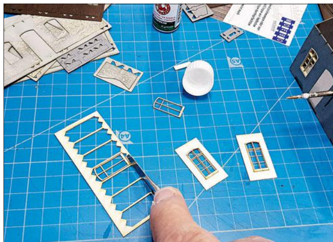
Ähnlich wie bei Joswood-Bausätzen sind die Schnittkanten der Stege leicht erkennbar mit einem Platzhalter markiert.
