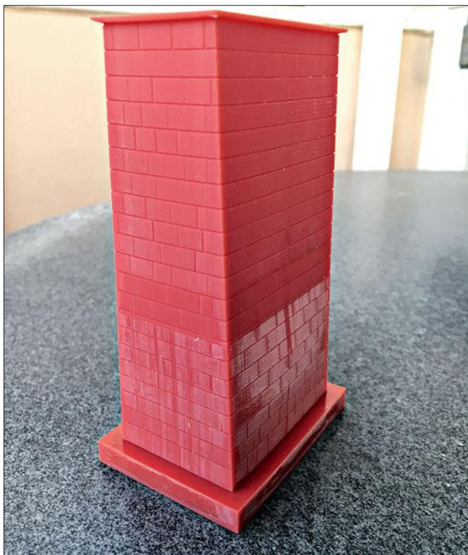
Der Pfeiler, hier farblich noch unbehandelt, wurde als Monolith, mit-hin im ganzen Stück, gedruckt. Sämtliche Druckteile sind nach ihrem Druck mit Isopropanol zu reinigen und mit UV-Licht zu härten.
