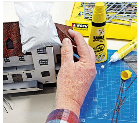
Zum Fixieren der Wände mit Vierkantgummis dürfen diese nicht zu stramm sitzen, um nicht Ecken zu beschädigen oder Bauteile einzudrücken.
