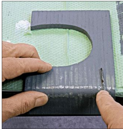
An der seitlichen Rundung mussten Spachtel-spuren nachgefeilt werden, die erst durch den Farbauftrag erkennbar wurden.
