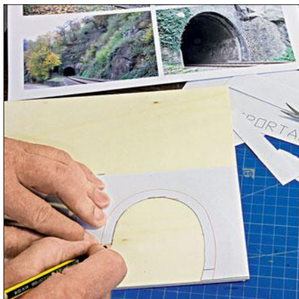
Von der Papierschablone werden die Umriss auf das 4 mm Sperrholz übertragen.
