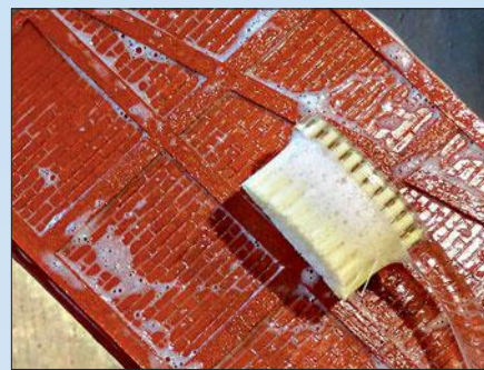
Die Resinteile werden mit Pril-Wasser von Rückständen befreit – eine Zahnbürste ist hier sehr hilfreich.
