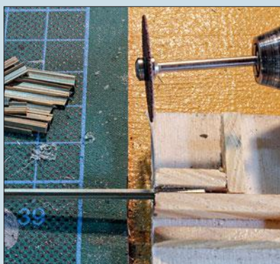
Schienenprofile in passender Länge halten die Bahnsteigkanten, welche ...
