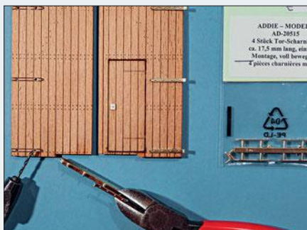
Bei den Fertigscharnieren werden die Zapfen stark gekürzt und nach der Farbgebung des Tores in die Bohrungen geklebt.
