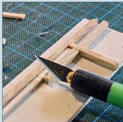
Dann folgt der Bau des Schüttbahnsteigs. Hier das Zuschneiden der Schwellen
