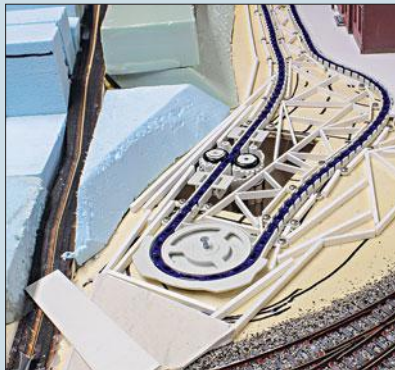
Wird die Kette störungsfrei bewegt, erfolgt das Auffüttern der Umgebung, damit die Straßen auf der gleichen Höhe liegen wie der Kettenkanal.
