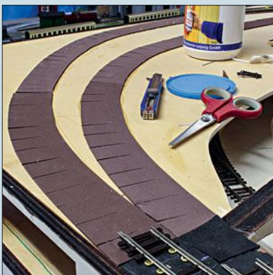
Moosgummiunterlagen gewährleisten einen leisen Lauf der Fahrzeuge.
