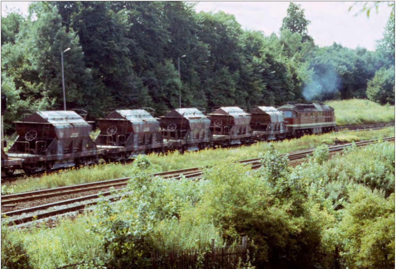
Ab Frühjahr 1982 konnte das Bw Nordhausen vor dem Zugpaar Gdg 56 405/Lg 58 616 diesel-elektrische Loks der Baureihe 132 einsetzen. Auf der Rampe nach Blankenheim (Foto kurz vor Blankenheim, Sommer 1984) war dennoch Nachschub erforderlich. Foto: Gernot Gattermann
