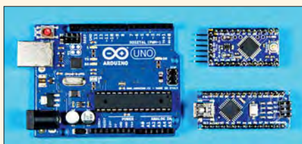
Drei Arduino-Boards im Größenvergleich: links der Uno, rechts oben der Mini und rechts unten der Nano
