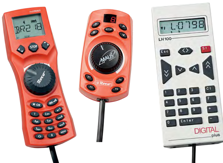
Multimaus [3] und Lokmaus von Roco mit Drehreglern und Handregler LH100 von Lenz mit reiner Tastenbedienung. Die Steuergeräte lassen sich an entsprechenden Buchsen am Anlagenrand für die Bedienung vor Ort einstöpseln und als Walkaround-Geräte nutzen. Fotos: gp
