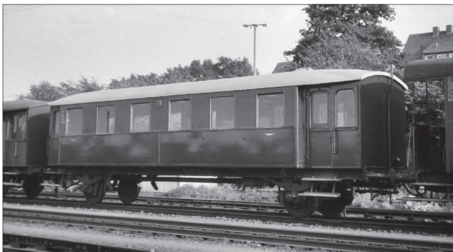
Zwei Wagen des Akku-Triebwagens der Linke-Hofmann-Werke wurden zu Personenwagen umgebaut und dienten der Söhrebahn bis zur Einstellung des Personenverkehrs. Fotos (3): Peter Letulé, Slg. Michael Bismarck
