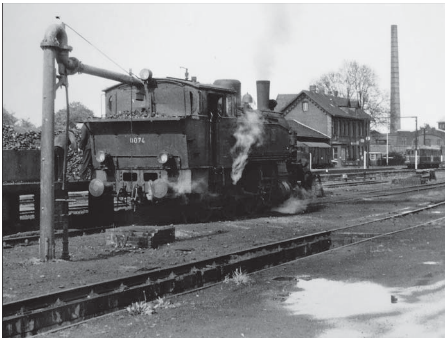
1961 wurde noch fleißig von Hand von der Kohlebühne die Kohle in den Tender der Lok 0074 der WLE (ex. pr. T 9.3) geschaufelt. Fotos: Gerd Wolff, Slg. WLE-Museum (3)
