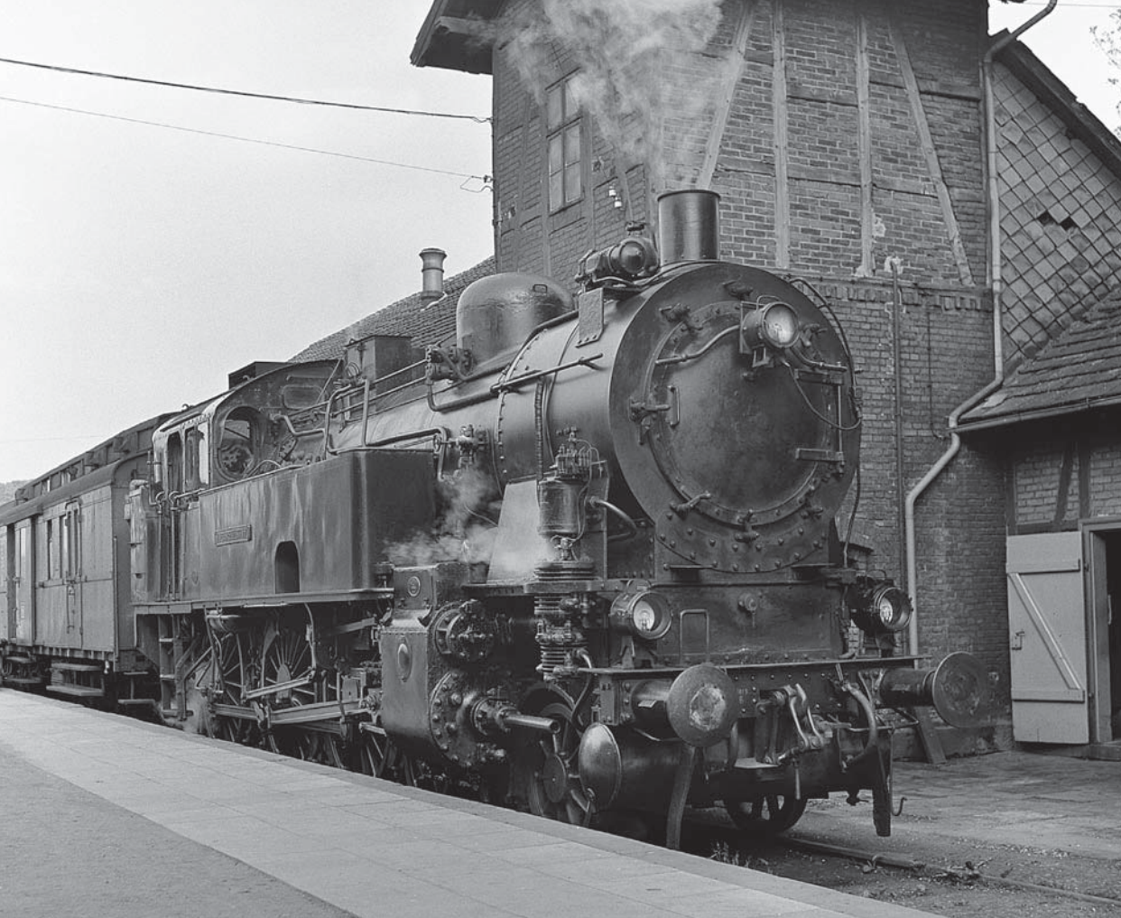
Zwischen 1949 und 1962 setzte die Ilmebahn eine der ehemaligen Tenderloks der Baureihe 76 (Achsfolge 2' C) ein und reichte sie als Lok 7 in ihren Bestand ein. Hier hat die ehemalige 76 002 am 23.5.1961 in Dassel mit einem Personenzug Kopf gemacht. Foto: Joachim Claus, Slg. Eisenbahnstiftung
