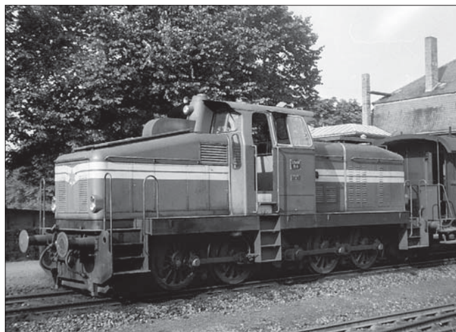
Als Lok 4 wurde die erste DH 850 D von Henschel in Dienst gestellt. Sie unterscheidet sich von der zweiten Lok gleichen Typs über einen leicht abgeschrägten langen Vorbau – hier zum Zug zeigend.
