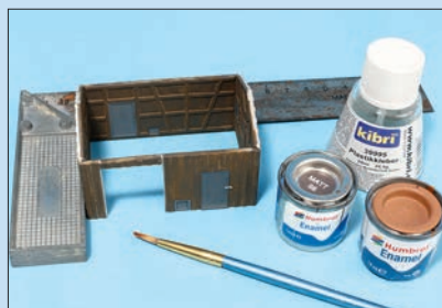
Alle Wände und die Blende oberhalb des Tors klebt man mit Plastikkleber rechtwinklig zusammen. Dann lackiert man die Stoßkanten mit wenig Farbe nach.
