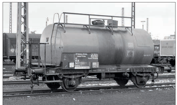
Der 724 0 130 [P] (links) der VTG, aufgenommen 1983 im Hamburger Hafen, hatte für den Transport von schwerem Heizöl eine Isolierung bekommen. Hingegen entsprach der im Februar 1983 in Hamburg-Wilhelmsburg fotografierte Bahndienstwagen 943 3 000 (rechts) auf den ersten Blick der üblichen Bauform. Die Befestigung des Laufstegs zeigt aber, dass auch er zuvor eine Isolierung besaß. Fotos (2): Peter Driesch
