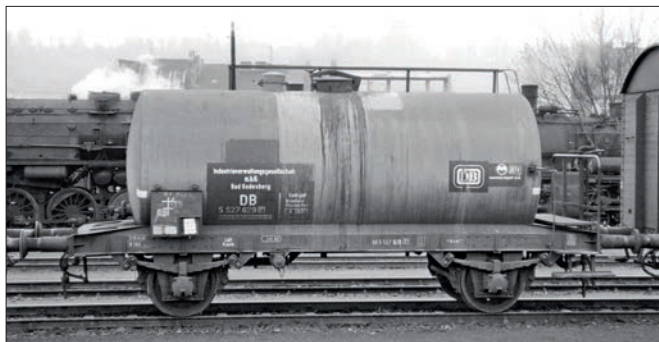
Im Jahr 1959 präsentierte sich der 590 829 [P] der VTG im Gbf Bad Cannstatt noch weitgehend im Ablieferungszustand von 1943 mit Laufwerken der Ursprungsbauf orm, kleiner Anschriftentafel, Rohrhandlauf und Heizung. Foto: Fritz Willke
