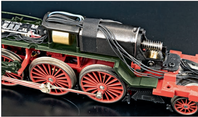
Im Kessel liegt der schlanke Motor. Über ein – teils aus Metall bestehendes – Getriebe wird die hintere Kuppelachse angetrieben. Die Bodenplatte trägt übrigens noch das Bremsgestänge. Fotos: MK
