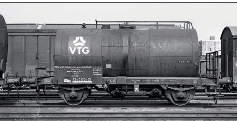
Der 724 0 130 [P] (links) der VTG, aufgenommen 1983 im Hamburger Hafen, hatte für den Transport von schwerem Heizöl eine Isolierung bekommen. Hingegen entsprach der im Februar 1983 in Hamburg-Wilhelmsburg fotografierte Bahndienstwagen 943 3 000 (rechts) auf den ersten Blick der üblichen Bauform. Die Befestigung des Laufstegs zeigt aber, dass auch er zuvor eine Isolierung besaß. Fotos (2): Peter Driesch
