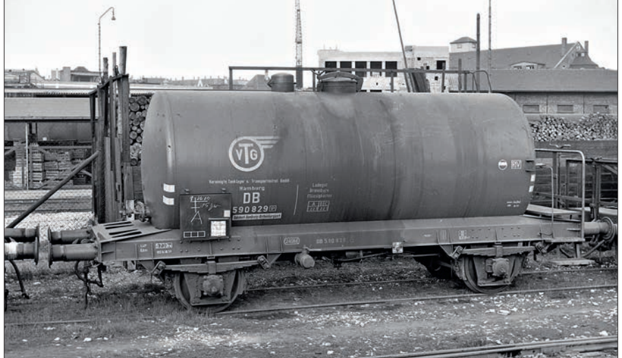
Im Jahr 1959 präsentierte sich der 590 829 [P] der VTG im Gbf Bad Cannstatt noch weitgehend im Ablieferungszustand von 1943 mit Laufwerken der Ursprungsbauf orm, kleiner Anschriftentafel, Rohrhandlauf und Heizung. Foto: Fritz Willke
