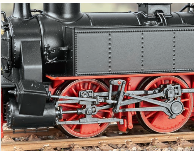
Die Allan-Tricksteuerung ist nicht nur ausgezeichnet nachgebildet, sie funktioniert auch ohne Hakeln.
