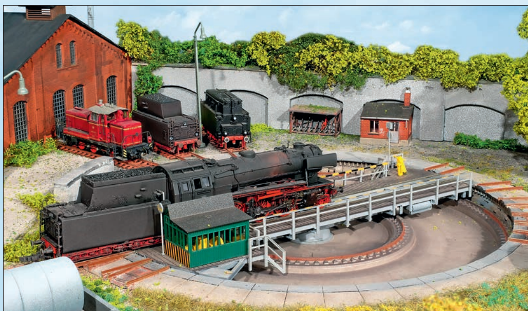
Die Drehscheibe dient hier nur zum Drehen der Lokomotiven und um die im Winkel angeordneten Bereiche des Bahnbetriebswerks zu erreichen.
