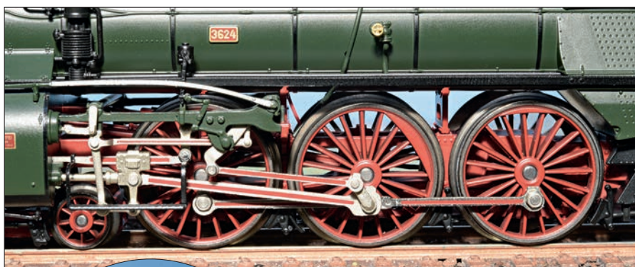
Am Steuerungsträger ist der Antrieb der Schmierpumpen als separates Teil aufgesteckt.
