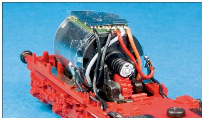
Das Bild zeigt die Führung der Anschlussleitungen zum Decoder. Die blaue und die weiße Ader werden nicht benötigt und wurden daher vor der Montage vom Decoder abgelötet.
