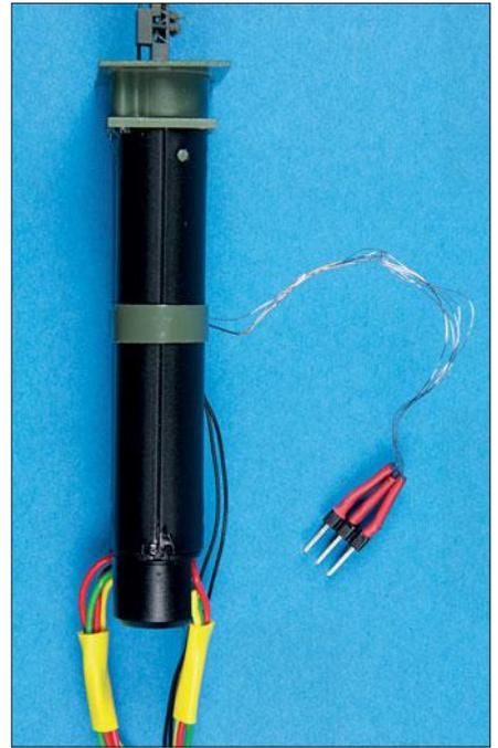
Zur leichten Montage sind die Leitungen an einen Stecker gelötet worden.
