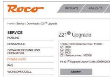
Die z21start muss erst für den Netzbetrieb vorbereitet werden. Dazu bietet Roco ein WLAN-Package mit einem Router und einem Freischaltcode an. Die Freischaltung bezieht sich auf die Seriennummer der z21start und wird auf der Roco-Homepage vorgenommen.
