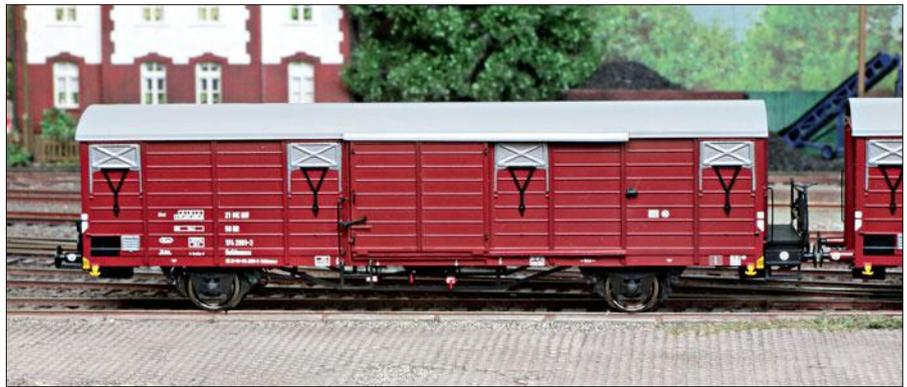
Wagenkasten-Grundkonstruktion mit sieben Sicken und, wie bei den Brawa-Glmms, mit Seilhaken an den Wagenenden – schließlich gelten für alle Modellbahnhersteller ähnliche Zwänge bei der Konstruktion.
