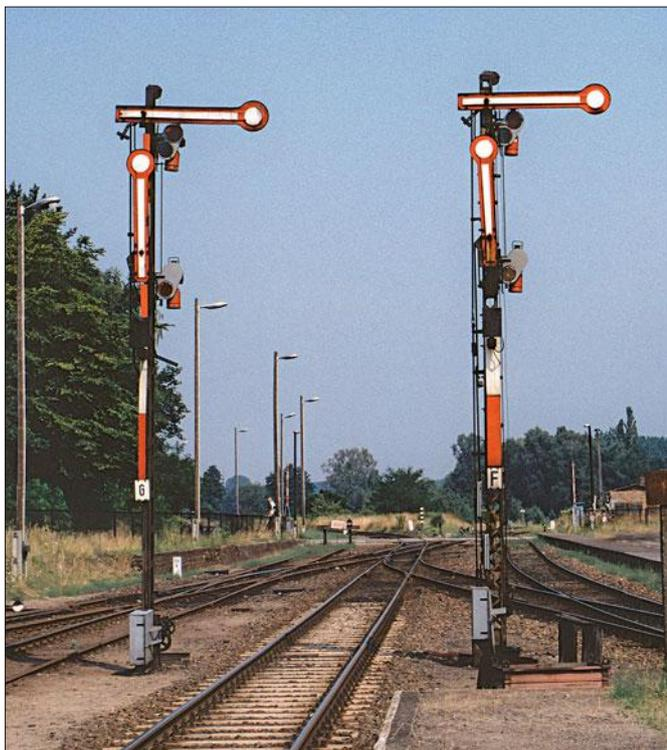
Beide Signale sind mit dem Ersatzsignal Zs1 ausgestattet. Sie gestatten dem Lokführer die Vorbeifahrt, falls z.B. das Signal gestört ist. Die Aufnahme entstand am 29.07.1994 in Basdorf bei Berlin.
