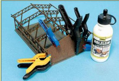
Auf Pfosten und Querträger wird dünn Holzleim aufgestrichen, ehe die Bretterverkleidung aufgesetzt wird. Leimklammern halten an verschiedenen Stellen die dünne Platte am Ständerwerk.
