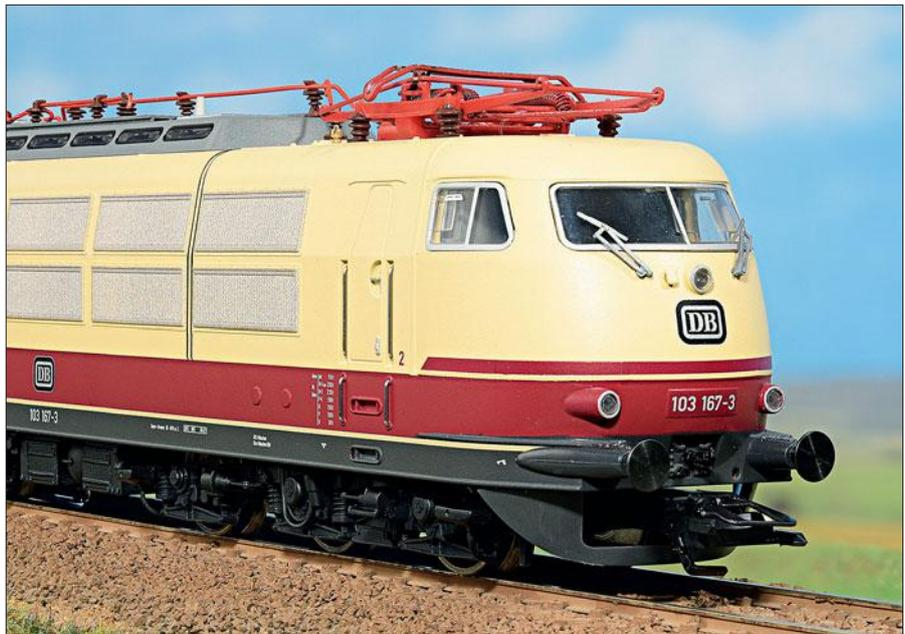
Die Seitenwände geben mit den fein gravierten Lüftungsgitterbändern das Vorbild ebenso korrekt wieder wie die Gravur der Türen mit silbern bedruckten Beschlägen und separat angesetzten Handstangen. Bei den wiederum zu hoch angeordneten Puffern wurde recht geschickt deren Verkleidung bei korrekter Oberkante deutlich flacher ausgeführt. Diese Teile sind angesteckt; das eröffnet die Möglichkeit, die Pufferhöhe und die Form der Pufferverkleidungen bei der Trix-Version korrekt auszuführen.
