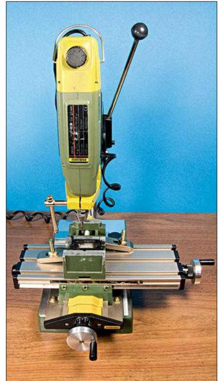
Im Tenderoberteil muss soviel ausgefräst werden, dass der vorgesehene Decoder ausreichend Platz hat. Dazu diente beim Autor eine Ständerbohrmaschine. Zu Führung des Werkstücks diente ein passender Kreuztisch, der zusätzlich angeschafft wurde.
