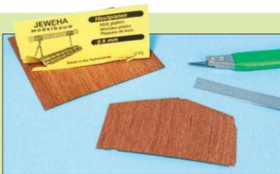
Die Verkleidung von Längs- und Giebelseite entsteht aus dünnen Holzplatten der Fa. Jeweha. Zugeschnitten erfolgt mit einem scharfen (!) Messer, das Ritzen der Bretterfugen mit einem stumpfen Messer.
