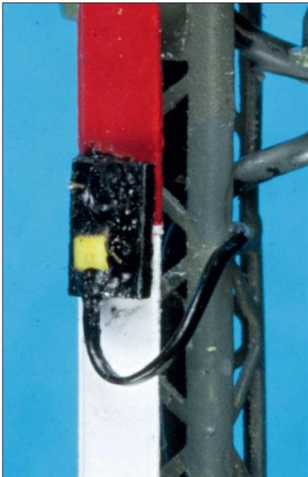
Auf die selbstgemachte Trägerplatte wurde die verdrahtete LED aufgeklebt.
