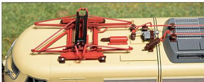
Links: Die Dachaus-rüstung über Führer-stand 1. Der Haupt-schalter ist recht vereinfacht dar-gestellt. Der Panto-graph kann digital gesteuert abgesenkt werden, sodass ...
