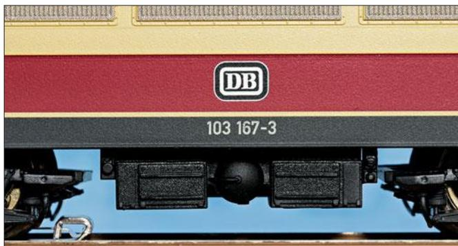
Im Lieferzustand hat die Schürze eine große Aussparung, so dass der Normschacht frei aus-schwenken kann.
