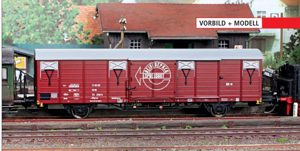
Zwei Gehlmmss bzw. Gbqrss von Exact-train: oben ein Gbqrss – EX20475 – im Zustand Anfang der 70er-Jahre, unten ein Gehlmmss (14.051) aus dem Set EX20460; für Ende der 60er-Jahre korrekt als freizügig einsetzbarer Güterwagen beschriftet. Jeweils neben dem linken Achshalter ist der Hebel des Wiegegestänges der automatischen Lastabbremsung zu erkennen.
