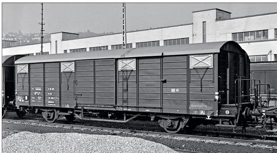
sis der Ghlmmss-Konstruktion. Äußerlich unterschieden sich diese Ibbpls [8256] nur durch den hellen Anstrich und die fehlenden Rastleisten an den Türen von den gedeckten Wagen.
