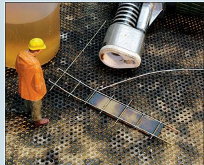
In der gefrästen Löttschablone werden die Komponenten verlötet. Die Flamme lässt das Zinn hauchdünn fließen.
