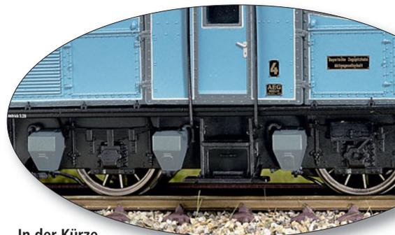
**In der Kürze liegt die Würze: Das Fahrwerk der Tallok zeigt auf engstem Raum alle Einzelheiten wie Sandbehälter, Achslager, Aufstiegstreppe mit Werkzeugkasten und den Sifa-Antrieb.**
