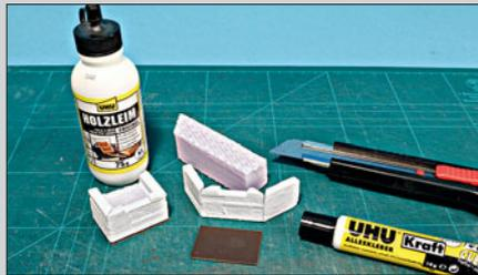
Vor der Montage werden eine Grundplatte und ein Füllstück aus Dämmstoff benötigt. Man verklebt die drei Teile mit Holzleim. Die Kunststoffplatte wird mit Alleskleber fixiert.
