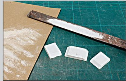
Die zugeschnittenen Teile eines Widerlagers werden auf Gehrung gefeilt. Die letzten Zehntelmmillimeter zieht man auf einem Schleifpapier ab.
