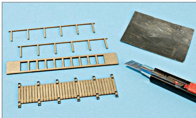
Der Bausatz von Busch ist nicht sehr umfangreich. Die Teile werden mit einem Messer aus den Rahmen geschnitten und leicht mit feinem Schleifpapier versäubert und anschließend gemäß Anleitung montiert. Eine farbliche Bearbeitung empfiehlt sich. Fotos: Thomas Mauer
