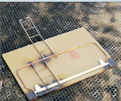
Dann werden die Leitern mit dem Geländerbügel und der Traverse für die Schluss­scheibenhalter zusammengefügt.
