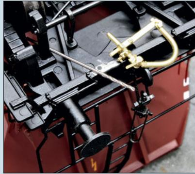
Der Wagen soll auch neue Bremschläuche erhalten. Dafür wird ein 1-mm-Loch von unten in das Fahrwerk gebohrt.
