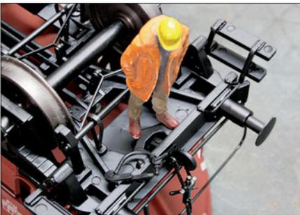
che angebracht werden. In unserem Fall stammen die Messingteile von Addie Modell (info@addie-modell.de). In die auf 1,0 mm aufgeweitete Bohrung an der Pufferbohlenunterseite wurden sie mit Sekundenkleber eingesetzt.
