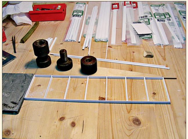
Eine einfache Lehre aus Aluminiumplatte und Holzleiste genügt, um die Fachwerk-Konstruktion rechteckig zu bauen. Für diesen Teil der Brücke eignet sich das Evergreen scale models-Material.
