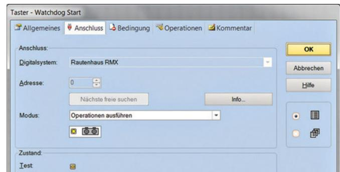
Als letzter Schritt erhält nun der zuerst definierte Bahnwärter noch zwei Auslöser: Dies ist einerseits „Watchdog-Trigger aus“, andererseits der gerade definierte Taster „Watchdog-Start“. Damit ist die „Programmierung“ des TrainControllers abgeschlossen.
