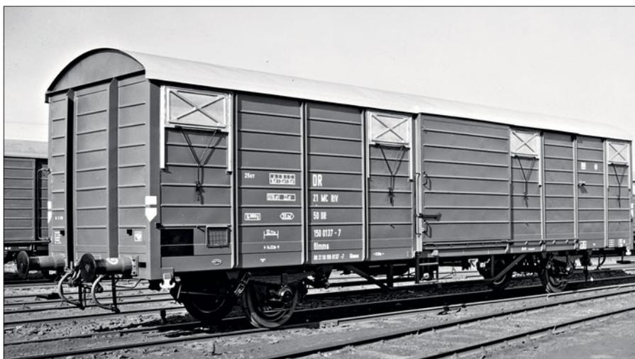
Nach einem Prototyp im Jahr 1966 baute das Raw Leipzig ab Frühjahr 1968 die Glmms (14.05) in Serie. Die Wagen besaßen ein herkömmliches Untergestell, hatten aber anstelle von Wagenkastenstützen in der Ebene der Seitenwände liegende Abkantprofile. An diese Profile war der Wagenkasten aus gesickten, innen mit Holz verkleideten Blechwänden geschweißt. Auch die Dächer bestanden aus Blech. Zur Ausrüstung gehörten vier der UIC-Bauart ähnelnde Lüftungsschieber auf jeder Wagenseite.
