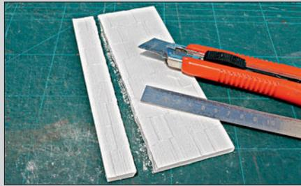
Der benötigte Streifen des Abgusses wird auf der strukturierten Seite entlang eines Stahlhlineals eingeritzt und dann gebrochen. Anschließend wird die Kante versäubert.
