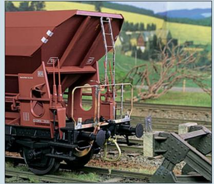
U-Profil und Spindel werden an das Geländer gelötet, Laschen und Sichel führen zum Bremsgestänge.
