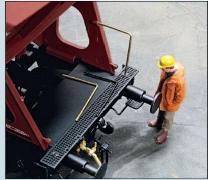
Aus einfach abgewinkeltem Draht entstehen die Griffstangen oberhalb der Trittstufen.
