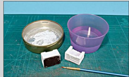
Die kleinen Nahtstellen an den Stoßkanten füllt man mit Spezialgips des Herstellers auf, so wirkt das Widerlager am Ende „wie aus einem Guss“.
