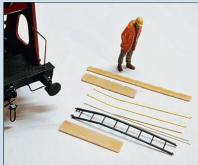
Die neue Leiter besteht aus zwei geätzten Seitenwangen und ein wenig Messingdraht. Die Lötlehre liegt dem Satz bei.
