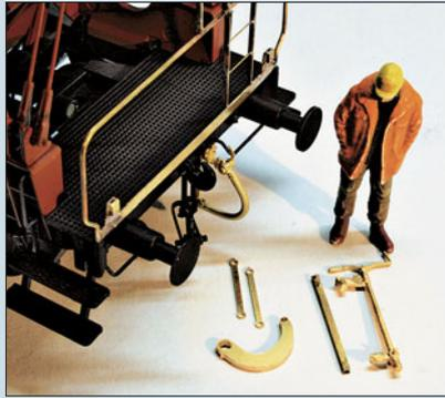
Die Bauteile der Handbremse liegen bereit: Spindel mit Handkurbel, U-Profil, Laschen und die Sichel.
