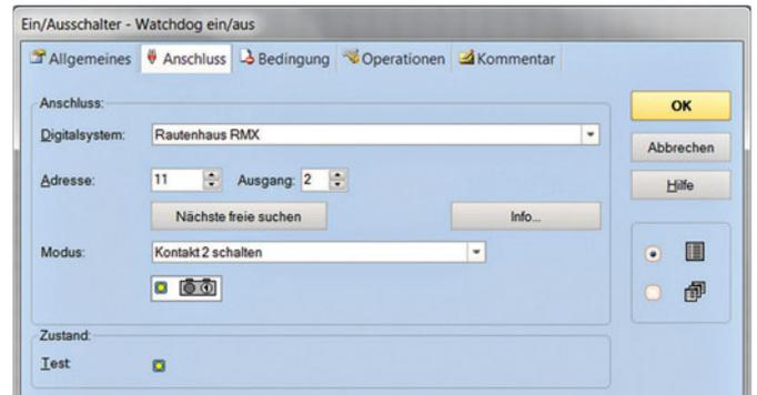
Zum manuellen Betrieb der Modellbahn wird der WD-DEC durch ein Relais überbrückt. Zur Ansteuerung dient ein Ein-/Ausschalter, der den zweiten Ausgang des Funktionsdecoders, hier mit der Systemadresse 11, ansteuert. Der Schalter wird mit einem sprechenden Namen (hier: „Watchdog ein/aus“) versehen, da dieser später bei den Bedingungen verwendet wird.
