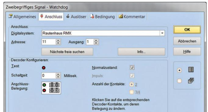
Funktionsausgang 1 des gleichen Funktionsdecoders bedient den Trigger-Eingang des WD-DEC. Damit hier ein Triggerimpuls erzeugt wird, ist der Ausgang des Funktionsdecoders abwechselnd ein- und auszuschalten. Das zweibegriffige Signal dient quasi als Stellvertreter. Wer mag, und TrainController in der Gold-Version verwendet, kann die verwendeten Symbole bearbeiten und bspw. einen Hund als Symbol kreieren. Wichtiger ist jedoch wiederum die Vergabe eines selbsterklärenden Namens.
