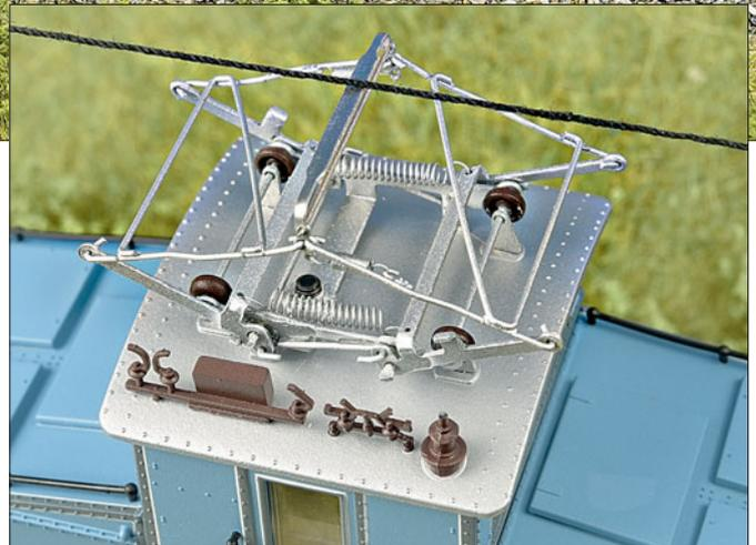
Die Dachrüstung umfasst den aus Metall filigran konstruierten Stromabnehmer. Vorn sieht man von links nach rechts die Hörnersicherung für die Zugheizung, den Kasten für die Sicherung, den Hörner-Blitzschutz sowie Überstromableiter und Durchführungsisolator.
