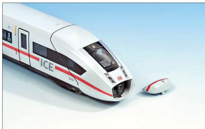
Die Bugverkleidung des ICE 4 kann abgenommen werden, darunter befindet sich eine Möglichkeit zum Kuppeln zweier Züge.
