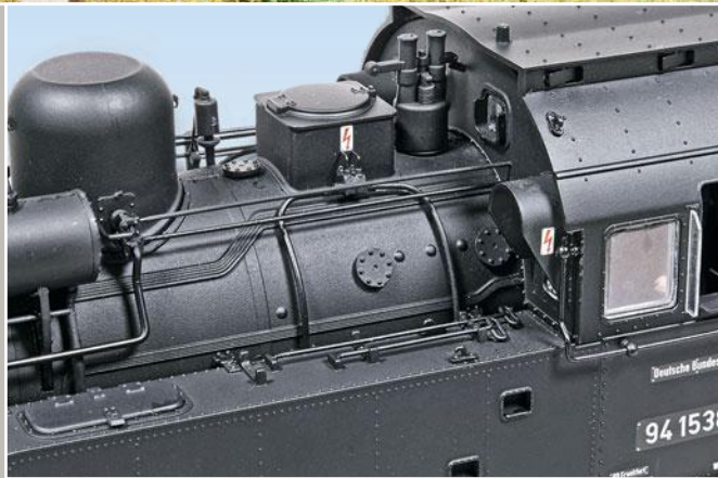
Die Sandfallrohre verschwinden zwischen Kessel und Wasserkasten. Extra montiert sind die Lukendeckel der Waschlukten.
