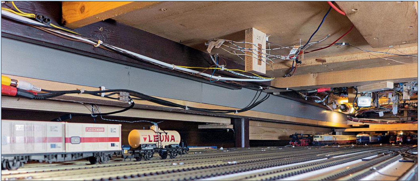
Für den manuellen Eingriff wurde ausreichend Platz zwischen Schattenbahnhof und oberem Anlagenteil vorgesehen.
