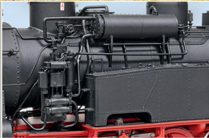
Fein nachgebildete Tolkien-Speisewasserpumpe und den daran angeschlossenen Vorwärmer der Bauart Knorr
