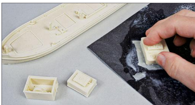
Vor der Montage müssen die Resinteile frei geschliffen werden.
