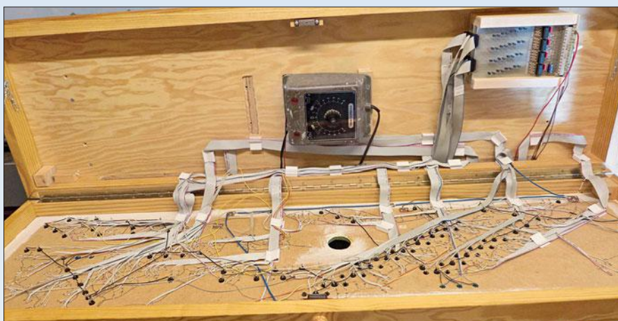
Die Tasten der Gleisbildstellpulte sind mit den Eingabebausteinen der MpC-Steuerung verbunden und ermöglichen einen komfortablen Betrieb.
