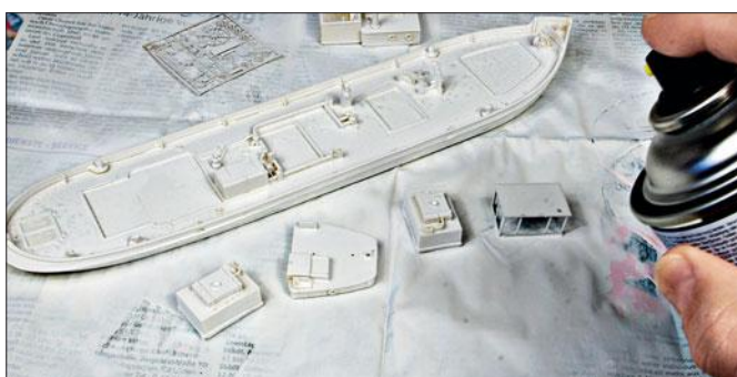
Die vorbereiteten Resin- und Messingätzteile werden vor dem Bemalen mit einer Haftgrundierung aus der Spraydose behandelt.
