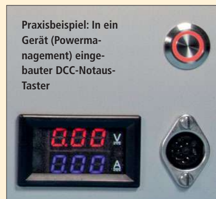
Der Taster besitzt einen Ring, der per LED beleuchtet werden kann. Ein Vorwiderstand und ein Gummiring werden mitgeliefert, wobei der Widerstand hier nicht benötigt wird.
