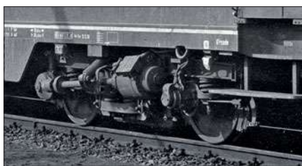
Zum Vergleich Minden-Deutz-Drehgestelle mit Achsgeneratoren von Krupp (ganz oben) und Pintsch-Bamag (darunter). Fotos: Joachim Claus, Slg. Eisenbahnstiftung
