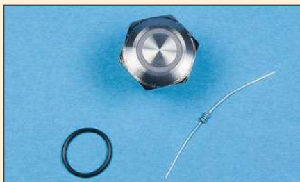
Der Taster besitzt einen Ring, der per LED beleuchtet werden kann. Ein Vorwiderstand und ein Gummiring werden mitgeliefert, wobei der Widerstand hier nicht benötigt wird.
