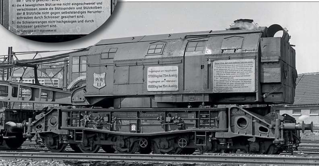
Die Anschriften am Kranwagen „München 6664“. Die letzte Prüfung war am 20.7.1957. Große Tafeln verkünden die wichtigsten Handlungsanweisungen. Besonders groß ist die maximale Last angeschrieben: 57 Tonne bei 7,5 m Ausladung und nur noch 15 Tonne bei der doppelten Auslegung. Unten der zugehörige Wasserwagen, ein mit zusätzlicher Pufferbohle und Geländer ausgerüsteter 2'2'T 34-Tender. Fotos: Fritz Willke, Slg. Stefan Carstens
