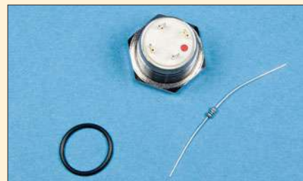
Der Taster besitzt einen Ring, der per LED beleuchtet werden kann. Ein Vorwiderstand und ein Gummiring werden mitgeliefert, wobei der Widerstand hier nicht benötigt wird.
