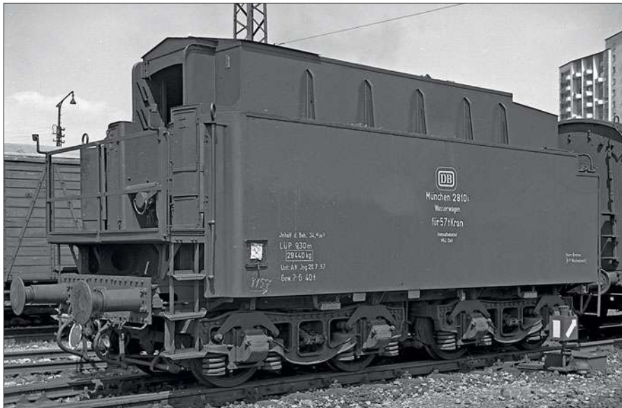
Die Anschriften am Kranwagen „München 6664“. Die letzte Prüfung war am 20.7.1957. Große Tafeln verkünden die wichtigsten Handlungsanweisungen. Besonders groß ist die maximale Last angeschrieben: 57 Tonne bei 7,5 m Ausladung und nur noch 15 Tonne bei der doppelten Auslegung. Unten der zugehörige Wasserwagen, ein mit zusätzlicher Pufferbohle und Geländer ausgerüsteter 2'2'T 34-Tender. Fotos: Fritz Willke, Slg. Stefan Carstens
