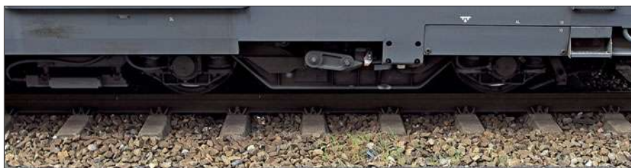
Oben das Drehgestell eines Wagens zweiter Klasse der Bauart Bx 794 darunter das führende Drehgestell eines Steuerwagens Bxf 796 . Letzteres besitzt eine Sandstreueinrichtung sowie einen PZB-Fahrzeugmagneten. Fotos: gg (3)
