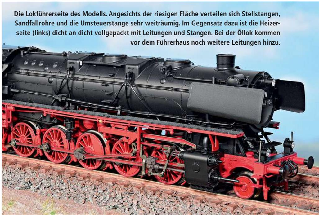
Die Lokführerseite des Modells. Angesichts der riesigen Fläche verteilen sich Stellstangen, Sandfallrohre und die Umsteuerstange sehr weiträumig. Im Gegensatz dazu ist die Heizerseite (links) dicht an dicht vollgepackt mit Leitungen und Stangen. Bei der Öllok kommen vor dem Führerhaus noch weitere Leitungen hinzu.
