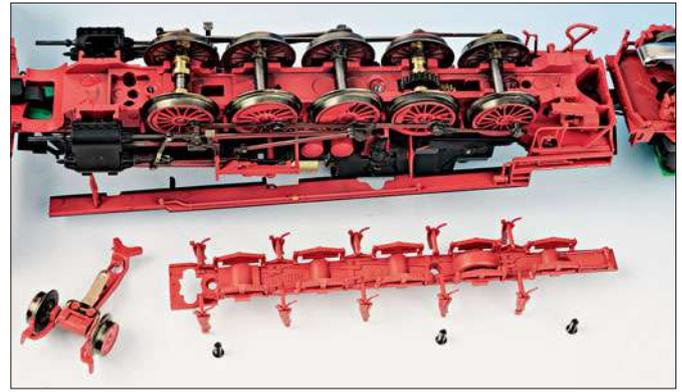
Die Zugkraft ist für normale Betriebsverhältnisse angemessen und wird insbesondere bei Vorwärtsfahrt durch die Querkräfte aus der Kupplungskinematik auf beiden Seiten des Tenders begrenzt. Das Modell verfügt vorn und hinten über einen kulissengeführten Normschacht.
