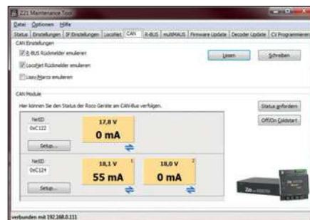
Links: Für angeschlossene Booster werden Untermenüs angezeigt. Hier können Parameter wie die Schaltgeschwindigkeit bei Kurzschlusserkennung und Auto-Invertierung eingestellt werden. Screenshots: Werk (2)
