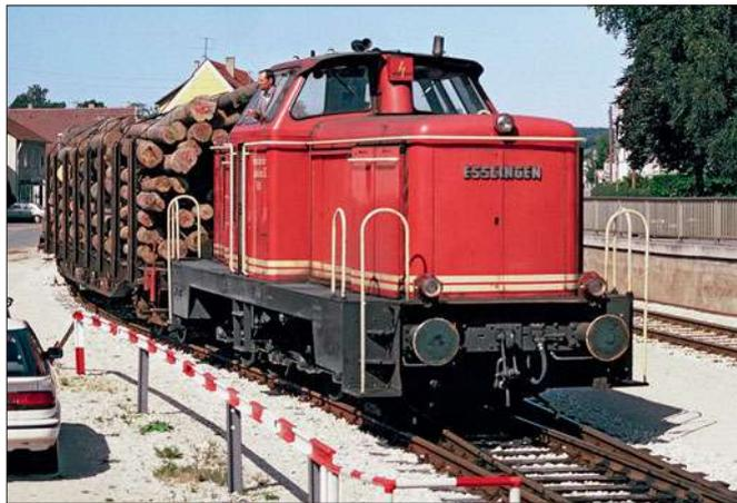
Die von der Maschinenfabrik Esslingen als „Alb-Klasse“ bezeichnete V 81 blieb ein Einzelstück; das vierachsige Fahrwerk mit den Kupplungen erinnert an die V 65 der DB. Die beiden Aufnahmen entstanden im August 1994 im Bahnhof Gammertingen (oben) und in Burladingen (links).
