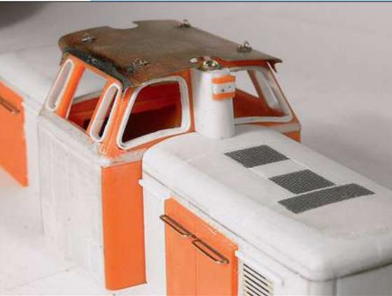
Die Griffstangen am Gehäuse und an der Pufferbohle bestehen aus 0,4 mm dickem Messingdraht. Die Laternen stammen von Weinert.
