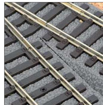
Wenn die Gleise an die Weichen anschließen sollen, muss die Bettung zugeschnitten werden. Die Lage der erforderlichen Schnitte ist im Inneren der Bettung markiert. Die Weichen des A-Gleises wirken erfreulich schlank, der Abzweigwinkel beträgt 15° – und die einfache Weiche weist einen Abzweigradius von 908 mm auf. Die Bogenweiche ist indes an die Standardradien angepasst.
