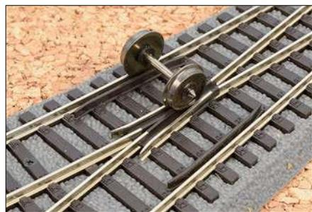
Von Fahrzeugen mit NEM-Radsätzen wird das Herzstück sicher befahren. Die Herzstückspitze besteht aus Kunststoff, die Länge des stromlosen Abschnitts beträgt rund 25 mm. Bei einer Spurkranzhöhe von 1,2 mm kommt der Spurkranzauflauf in der Herzstücklücke zum Tragen; Radsätze mit niedrigeren Spurkränzen sinken deutlich ein. Beim Betrieb mit ganz unterschiedlichen Testfahrzeugen gab es jedoch keine Probleme.
