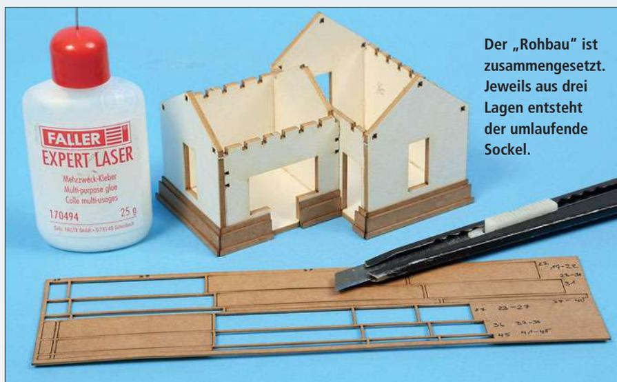
Der „Rohbau“ ist zusammengesetzt. Jeweils aus drei Lagen entsteht der umlaufende Sockel.
