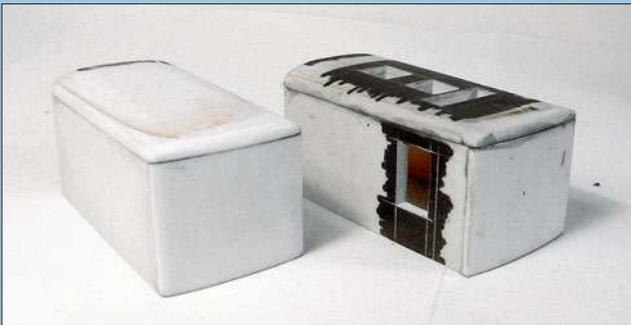
Die Bauteile für das Gehäuse sind weitgehend fertiggestellt. Auf das Fahrwerk von Kato wurde eine Messingplatte gesetzt, an die noch die bereits zugefeilten Seitenteile des Rahmens gelötet werden müssen.
