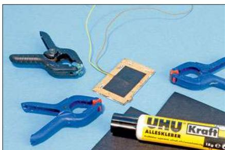
Um auch hier den Lichtschein zu minimieren, wird ein schwarzer Karton über die Öffnung mit der LED geklebt. Ein Alleskleber ist hierfür ideal. Zwingen sorgen für den nötigen Anpressdruck.
