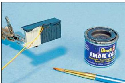
Um die Box zusätzlich lichtundurchlässig zu machen, wird diese von außen satt mit einer Emailfarbe schwarz gestrichen. Erst jetzt ist sichergestellt, dass kein Lichtschein durch den Kunststoff dringt.
