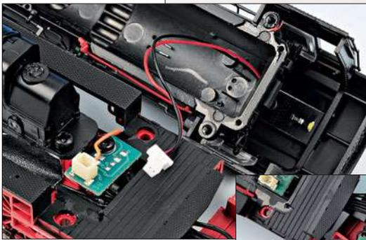
Die LED der Führerstandsbeleuchtung ist über einen Stecker angeschlossen, damit sich das Lokgehäuse vom Fahrwerk abnehmen lässt.
