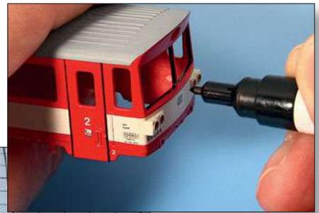
Die langen Kanten der Fenster wurden mit stärkeren, die Ecken mit deutlich feineren Farbstiftspitzen eingefärbt. Abschließend erhielt der komplette Wagenkasten seidennatten Schutzlack aufgesprüht.
