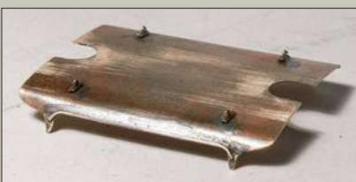
Schritt für Schritt entsteht das Dach des Führerhauses aus 0,2 mm starkem Messingblech. Nach dem Aussägen und Biegen wurde es auf das Führerhaus gesetzt, um zu überprüfen, ob alles passte. Anhand der aufgeklebten Zeichnung konnte es danach genau zugefeilt werden. In die Fensterausschnitte sind auch schon die 1,5 mm breiten Polystyrolstreifen zur Nachbildung der Fensterrahmen eingeklebt.
