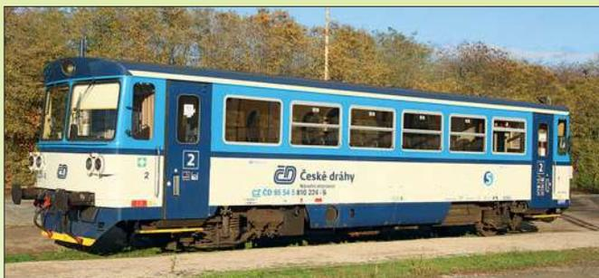
Im Ergebnis der Modernisierung existieren inzwischen mehrere Varianten dieser Triebwagen, darunter mehrteilige Fahrzeuge mit Niederflurabteilen. Unter Beibehaltung des originalen Wagenkastens erhielten viele der Triebwagen die neue Najbert-Farbgebung in Blau und Lichtgrau mit Seitenfenstern in Aluminiumrahmen und Wärmeschutzverglasung (links). Das Foto unten rechts zeigt 810 183 am 31. Mai 2013. Außer dem Abgasstutzen im Bereich der Toilette ist auch eine nachgerüstete Funkantenne erkennbar.
