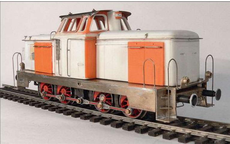
Geschafft – Gehäuse und Rahmen sind fertiggestellt und bereit zum Grundieren und Lackieren, diese Arbeiten erfolgten dann mit der Spritzpistole.
