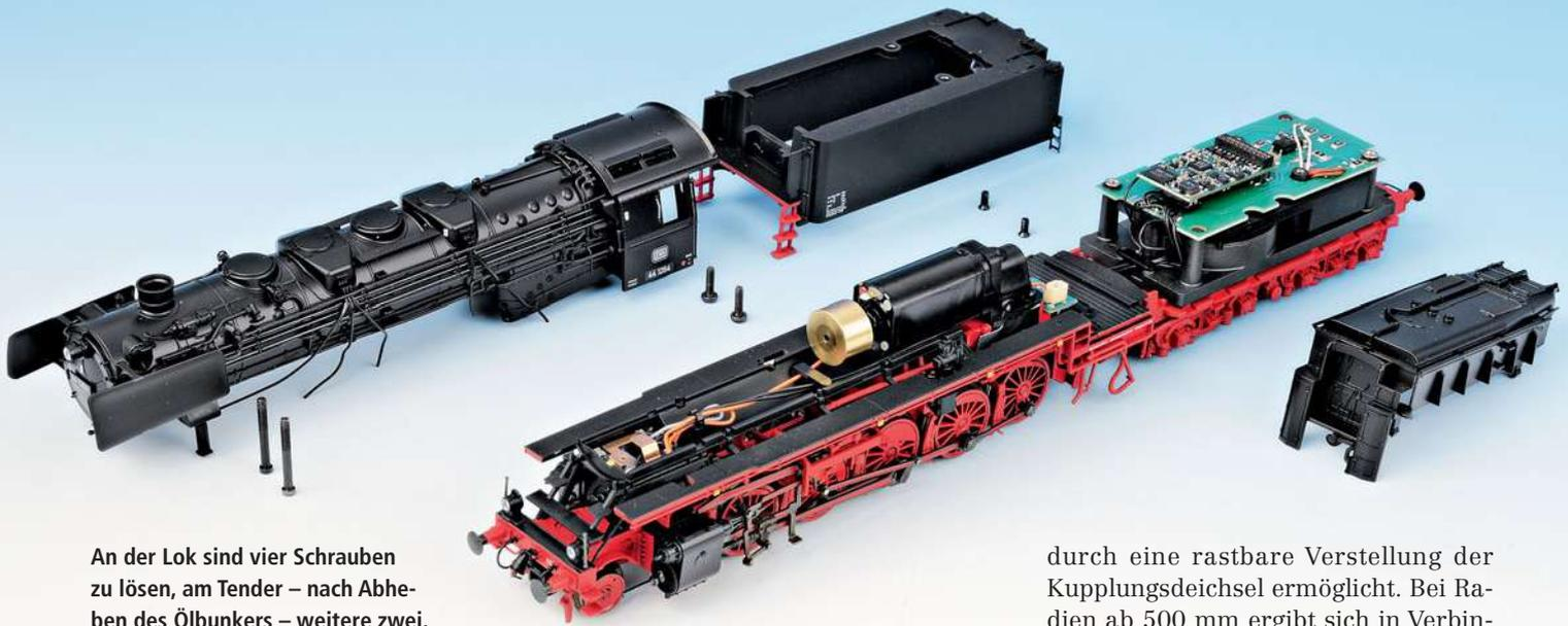
An der Lok sind vier Schrauben zu lösen, am Tender – nach Abheben des Ölbunkers – weitere zwei. Dann können die jeweiligen Gehäuse bequem abgenommen werden.
