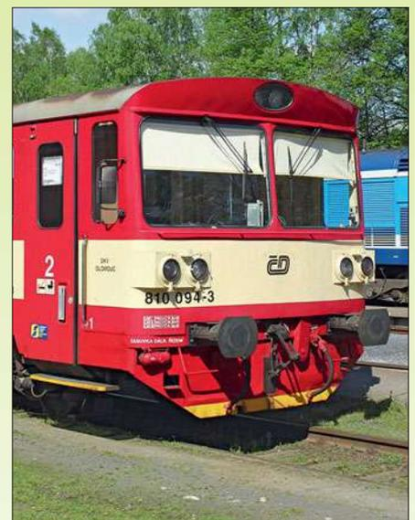
Die charakteristische Frontpartie der Baureihe 810 wird durch die beiden leicht geneigten, in Gummidichtungen gefassten Fenster bestimmt. Die Zug- und Stoßvorrichtungen ermöglichen sowohl das Ankuppeln von Beils als auch von einzelnen Güterwagen. Die Rollos hinter den Frontfenstern lassen sich in mehreren Stufen herunterziehen.
