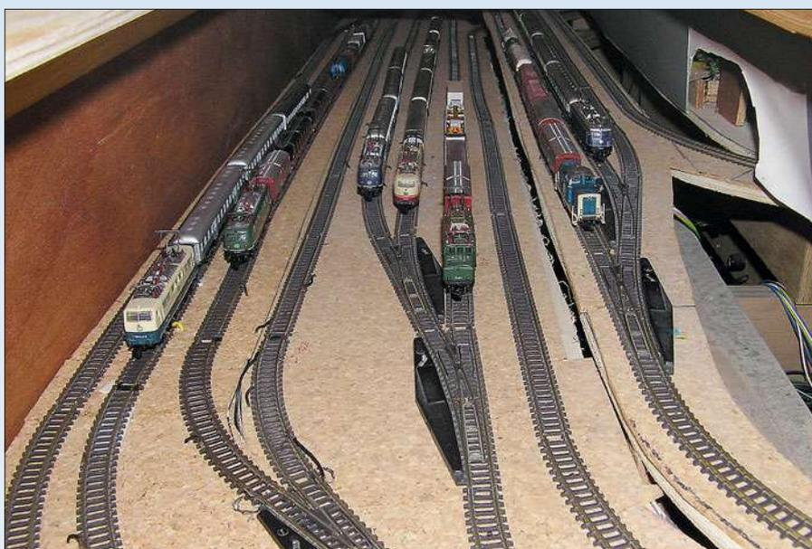
Die Gleise verlegte ich auf 6 mm dicken Sperrholztrassen, die eine Auflage aus 2,5 mm dicken Korkstreifen erhielten. Als Kleber verwendete ich für den Schotter nicht das übliche Gemisch aus
