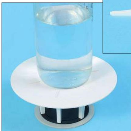
... sollten die Säulen noch feinjustiert werden. Dazu zentriert die unterste der drei Dachscheiben die Säulen. Das Wasserglas sorgt dabei für die erforderliche Fixierung der Säulen an deren Basis. In dieser Position sollte die Konstruktion ausreichend lange – zum Beispiel über Nacht – ausharren. Dann ist der Kleber sicher ausgehärtet.
