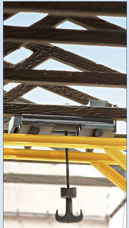
Zum Heben schwerer Bauteile erhielt der Schuppen nachträglich ein Stahlgerüst mit Laufkran.
