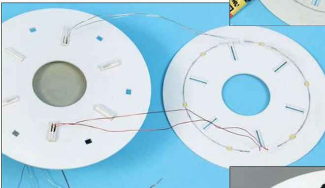
Oben: Die LEDs und ihre Leitungen werden exakt in die hierfür ausgefrästen Rillen der Zwischendecke eingeklebt. Die Zuleitungen der ...
