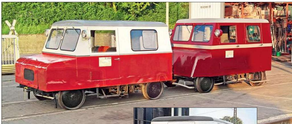
Die EF Wetterau besitzen unter anderem auch diesen KlV 11. Das Foto zeigt nicht nur die Unterschiede bez. der Motorhauben, sondern auch bez. BA- und Bm-Draisinen. Rechts die hintere Ansicht von KlV 12-4528. Die Tür ermöglicht den Zugang zum Laderaum. Das Loch darunter ist für die Kurbel zum Wenden. Fotos: Stefan John/EF Wetterau
