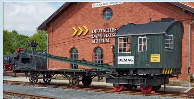
Der Dampfkrane in Neuenmarkt-Wirsberg wurde ab der zweiten Hälfte der 1970er-Jahre aus zwei Kranwagen zu einem funktionsfähigen Museumsstück restauriert. Foto: gg
