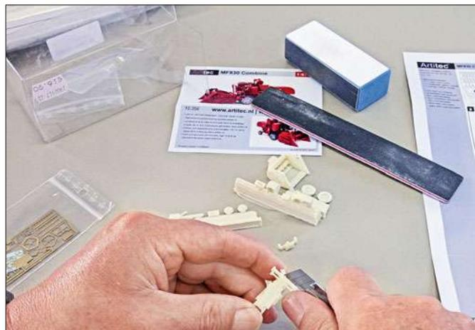
Die aus Resin gegossenen Bauteile müssen – wie bei jedem Resinmodell – zunächst mit Bastelmesser und Feile entgratet werden.
