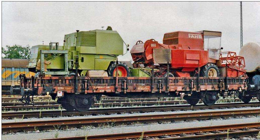
Zwei seinerzeit noch recht kleine Mähdrescher, auf einem Ks-Rungenwagen verladen. Räder und Mähwerk sind montiert. Auffällig sind die zahlreichen Niederbindungen mit Rödeldraht.
