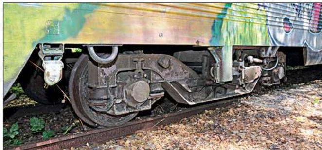
An den Drehgestellen, die einst die hohe Laufruhe der Wagen ausmachten, nagt der Zahn der Zeit. Die Konstruktion wurde auch bei den später in Serie gebauten x-Wagen beibehalten.
