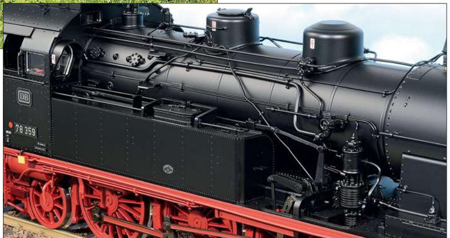
Auch die Lokführerseite des Kessels lässt keinerlei Details vermissen. Während der Kessel selbst aus Zinkdruckguss gefertigt ist, bestehen die angesetzten Teile überwiegend aus hochdetailliertem Messingguss.
