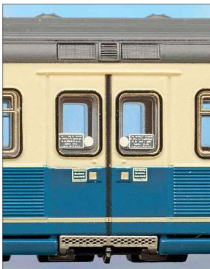
Im Türbereich wurden Ätzteile als Trittroste verwendet. Mehrere Druckdurchgänge stellen Anschriften, Dichtungen und Türgriffe dar.
