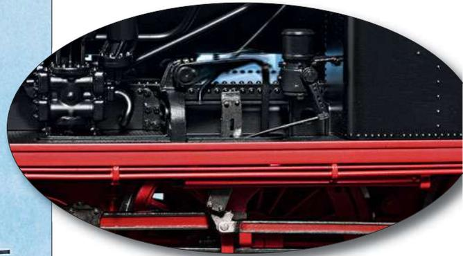
Die bei der 78 charakteristischen Aufwerfhebel werden über einen Servo stets in die richtige Stellung gebracht.
