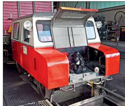
Der Klv 12 mit der Betriebsnummer 4528 ist bei den Eisenbahnfreunden Wetterau im aktiven Museumseinsatz. Das Fahrzeug stammt aus der Lieferserie 4450 bis 4649, die von FKF (Frankfurter Karosserie Fabrik Friedrich Schmitt) 1956/57 ausgeliefert wurde. Das Fahrzeug stand hinsichtlich Abmessungen und Sound Pate für das Lenz-Modell. Die geöffnete Motorklappe zeigt den winzigen Motor – einen 28-PS-Industriemotor von VW.
