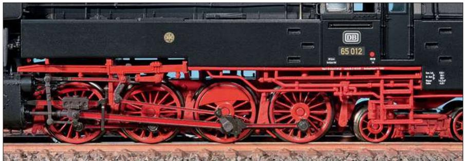
Die Beschriftung zeigt authentisch die bei der Ablieferung der Lok vorhandenen Schilder in Messing sowie später angebrachte Schilder in Alu. Die letzte Bremsuntersuchung ist mit dem 18.5.65 angegeben. Beim Fahrwerk gefällt, dass auf beiden Seiten die voreilenden Gegenkurbeln in korrekter Stellung angebracht sind.
