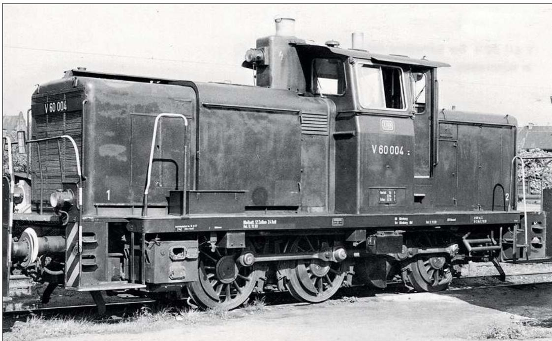
Im Unterschied zu den Serienmaschinen hatten V 60 001 bis 004 einen durchgehend niedrigeren Umlauf und keine schmucken Zierlinien. Die Frontgeländer wurden erst später angebracht, die seitlichen Geländer behielten ihre abweichende Bauform bei. V 60 004 machte am 27.5.1960 in Nürnberg Hbf Pause.
