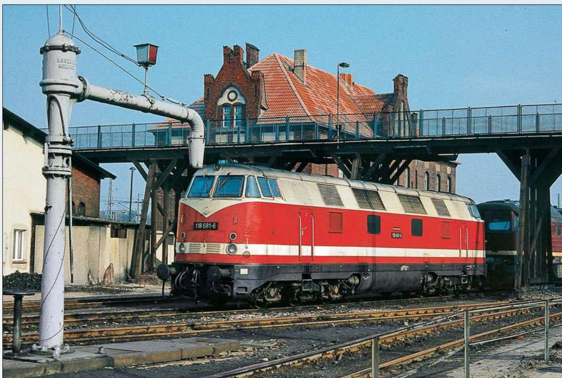
118681, vor dem Einbau leistungsgesteigerter Motoren 118281, entsprach mit ihrer Frontgestaltung und den Seitenfenstern bzw. Lüftungsgittern noch 1991 weitgehend dem Vorbild für das Roco-Modell in der Baugröße H0. Das Hellgrau der sechsachsigen Drehgestelle ist schon längst dem rostbraunen Bremsabrieb zum Opfer gefallen.
