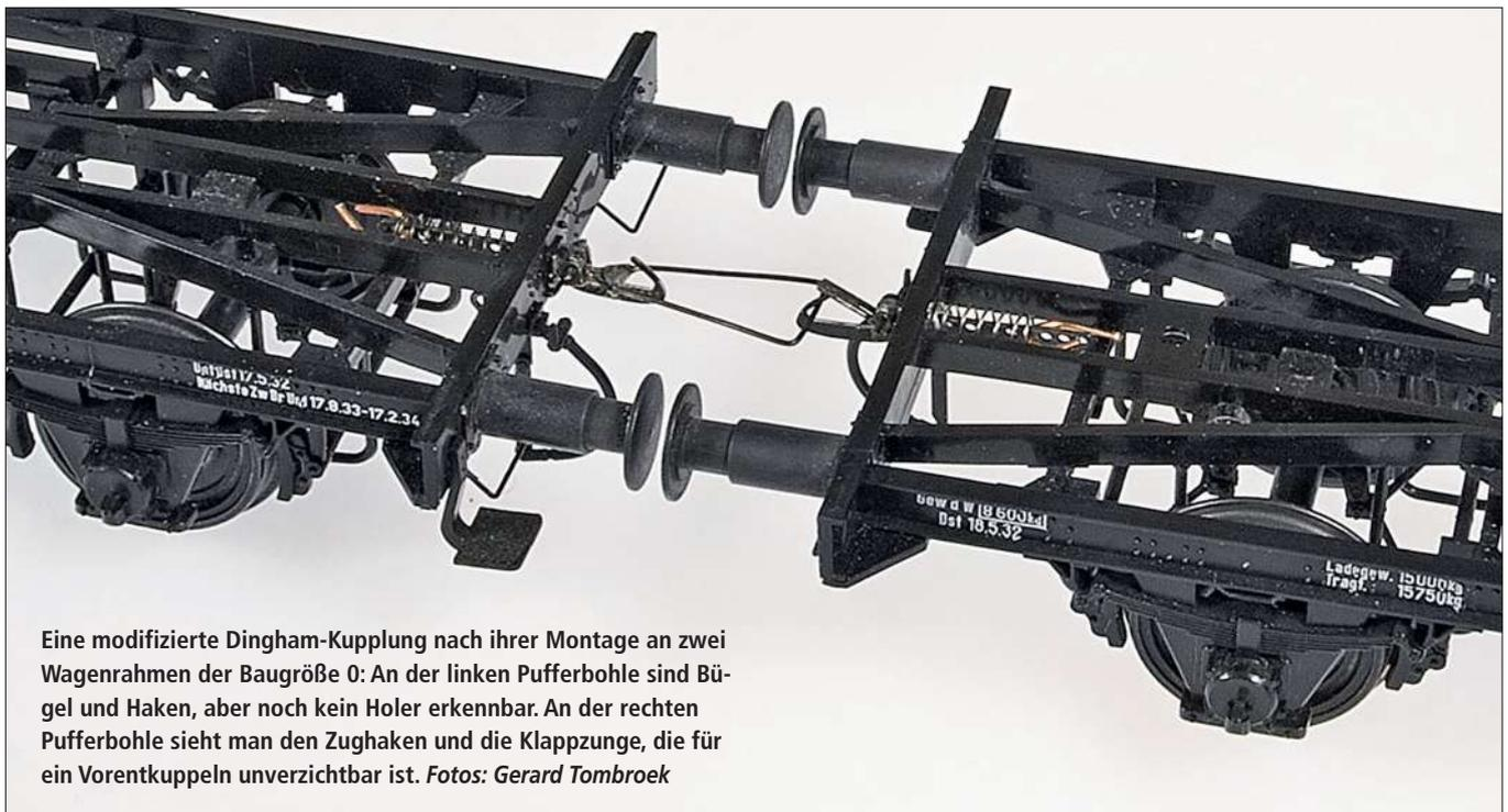
Eine modifizierte Dingham-Kupplung nach ihrer Montage an zwei Wagenrahmen der Baugröße 0: An der linken Pufferbohle sind Bügel und Haken, aber noch kein Holer erkennbar. An der rechten Pufferbohle sieht man den Zughaken und die Klappzunge, die für ein Vorentkuppeln unverzichtbar ist. Fotos: Gerard Tombroek
