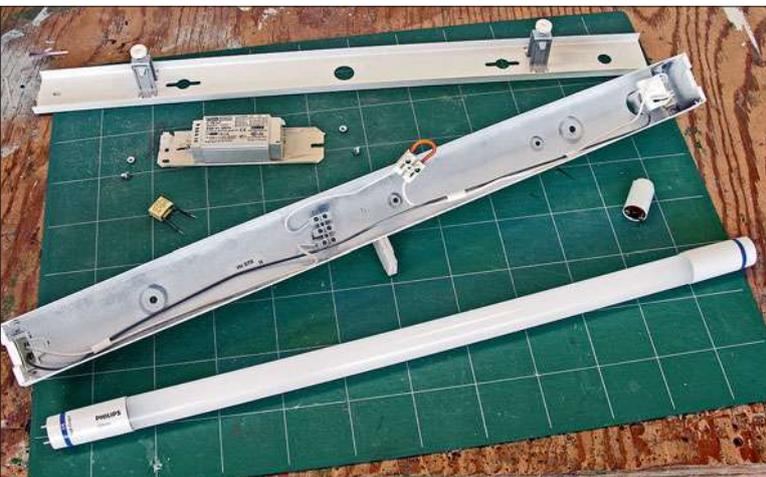
Die Halterung nach dem Umbau. Der mit der LED-Röhre mitgelieferte Überbrücker wurde eingesteckt und das alte Vorschaltgerät entfernt. So reduziert man zudem das Gewicht der Halterung – dies kann beispielsweise für die Beleuchtung einer transportablen Ausstellungsanlage von Vorteil sein.
