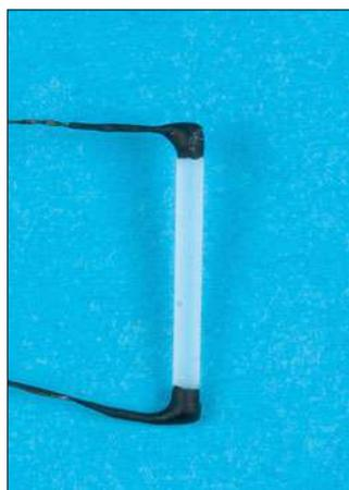
**Um den Acrylstab gleichmäßig zu beleuchten, werden von beiden Seiten LEDs angeklebt. Die Kabelabgänge sollten in die gleiche Richtung führen. Sind die Lampen sichtbar angebracht, kaschiert man die LEDs und Kabel mit schwarzer Farbe.**
