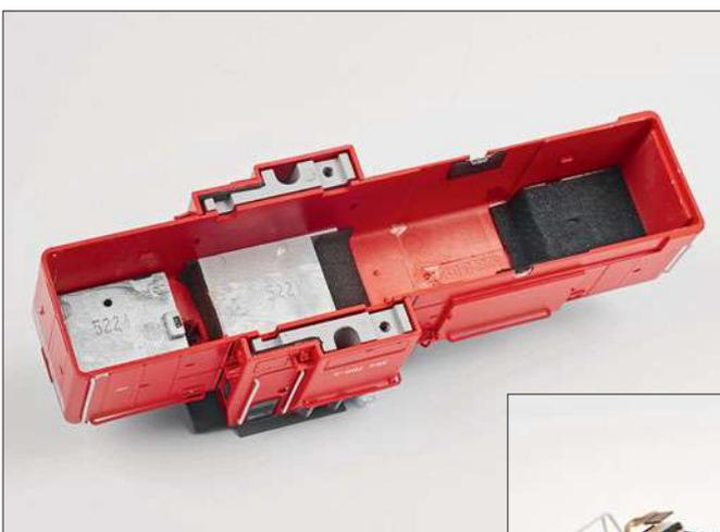
Links: Im Gehäuse sind mehrere Gewichte angeordnet, auch in den Taschen, die sich zwischen Führerstand und Mittelaufbau ergeben. Die Gehäuseschrauben werden in diesen Gewichten mit Gewinden geführt.
