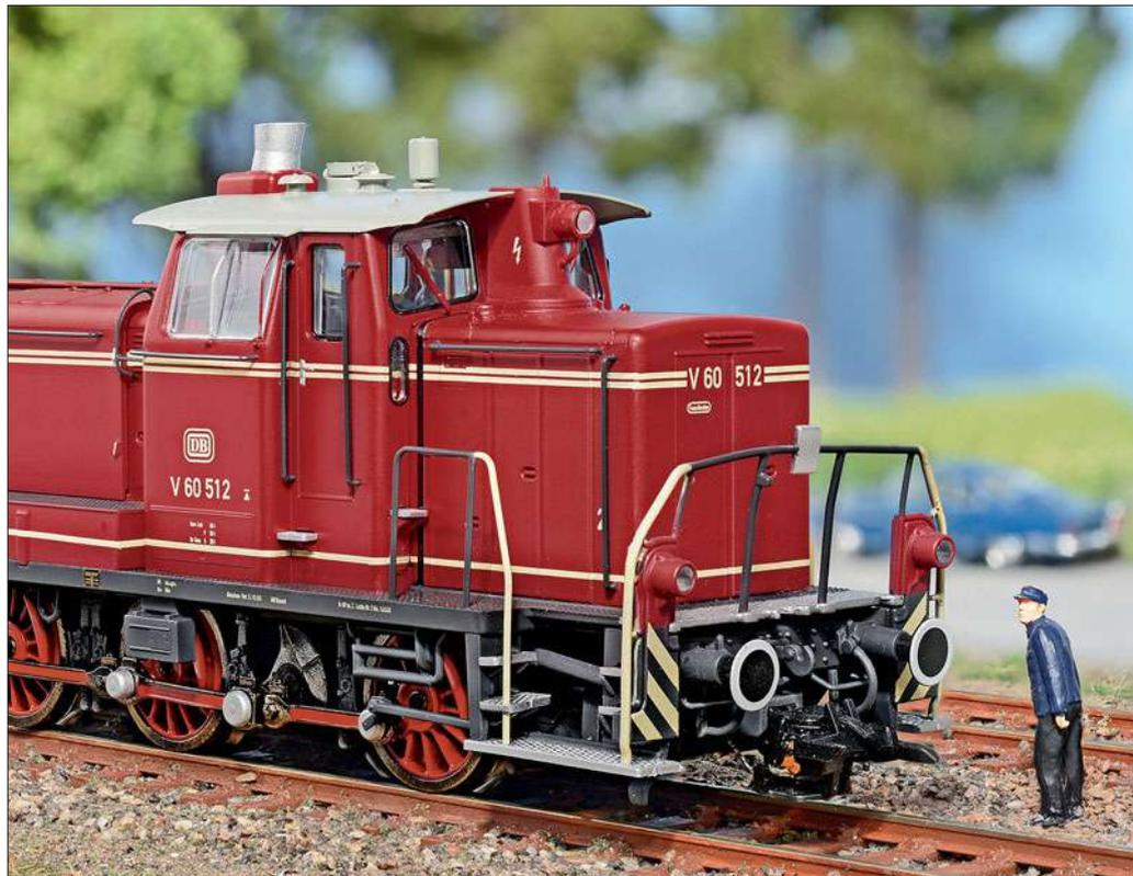
Am Fahrwerk fällt auf, dass die Räder nun einen stahlblanken Radreifen haben. Außerdem sind die Achsstirnflächen blank, korrekt für eine Lok im Neuzustand. Die Kuppelstangen bestehen aus Metall und berücksichtigen vorbildgerecht alle Gelenke sowie die Schutzkappen der Stangenlager.
