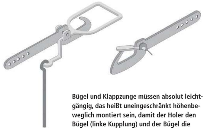
Bügel und Klappzunge müssen absolut leichtgängig, das heißt uneingeschränkt höhenbeweglich montiert sein, damit der Holer den Bügel (linke Kupplung) und der Bügel die Klappzunge (rechte Kupplung) anheben kann.
