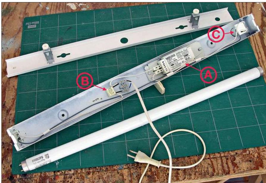
ermüdend. Außerdem neigt das Vorschaltgerät dazu, im Laufe der Zeit zu vibrieren und ein leichtes Brummen zu verursachen. Ein KVG muss zudem mit einem Starter in Reihe geschaltet werden. Der zweite Typ, der moderner und auch etwas teurer ist, versorgt dagegen die Röhre durch ein elektronisches Hochfrequenz-Vorschaltgerät (EVG) ohne Starter. Dieses beseitigt das Flackern und Brummen, reduziert den Verbrauch und erhöht die Lebensdauer.
