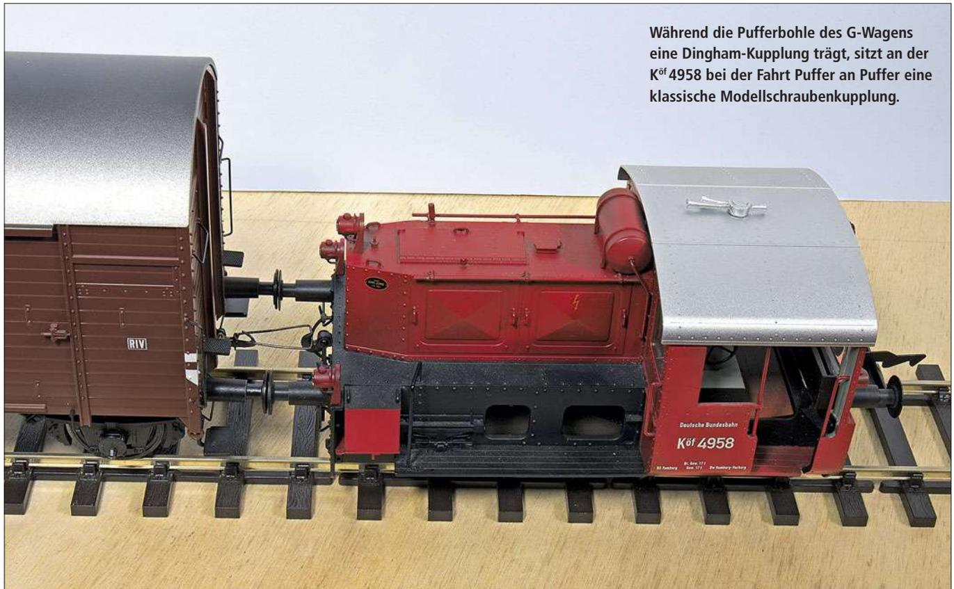
Während die Pufferbohle des G-Wagens eine Dingham-Kupplung trägt, sitzt an der Kof 4958 bei der Fahrt Puffer an Puffer eine klassische Modellschraubenkupplung.
