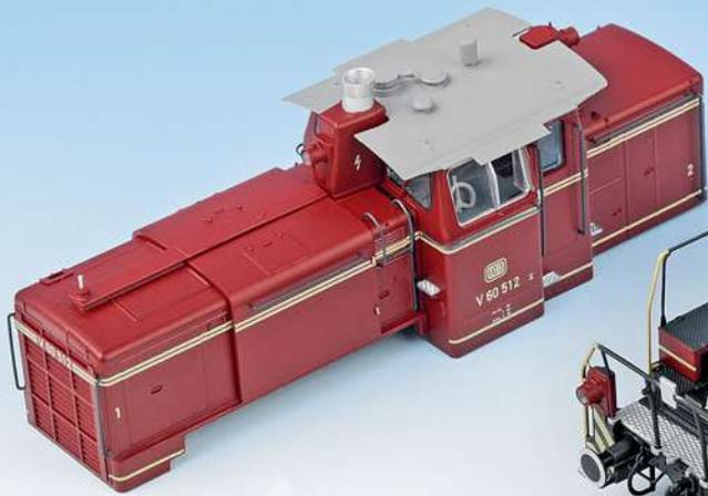
Fünf unterschiedlich große Schrauben sind zu lösen, dann kann der Lokkasten vom Fahrwerk abgehoben werden. Es kann passieren, dass die Führstandsinneneinrichtung und der Rauchgenerator zunächst im Gehäuse verbleiben.
