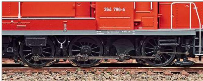
Das Fahrwerk mit Blindwelle im Detail: Die schwarzvernickelten Stangen sind sehr filigran, die Lager gut nachempfunden worden. Die Befestigung wurde dezent gelöst.
