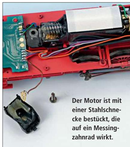
Der Motor ist mit einer Stahlschnecke bestückt, die auf ein Messingzahnrad wirkt.
