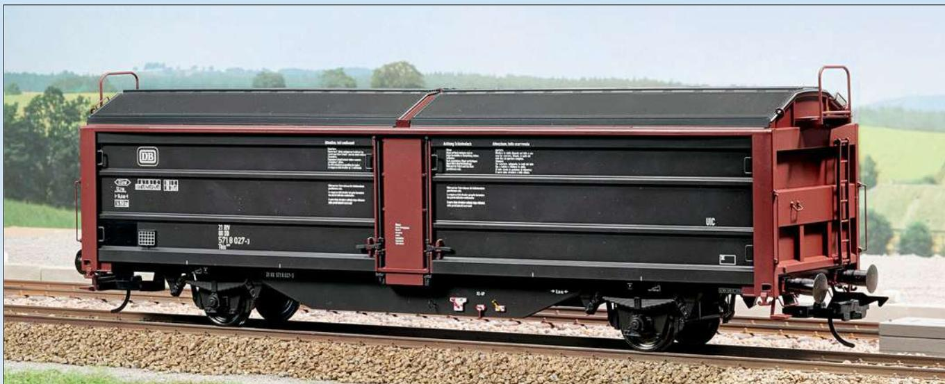
Der zweitürige Thbis 870 in grauer Farbgebung mit auffälligen Anschriften zur Bedienung der Schiebetüren und Hubschiebedächer.
