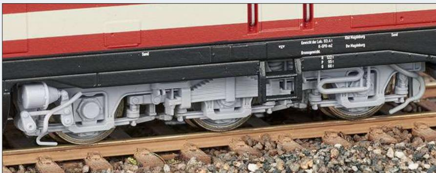
Die Drehgestelle überzeugen durch räumliche Tiefe und scharfkantig gravierte Details von Bremsanlage, Blattfedern, Ausgleichshebeln und Sandfallrohren.
