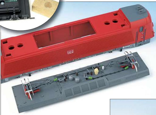
Der komplette Dachgarten ist ein eingeklipptes Kunststoffteil. Die vier Löcher für die Pantographenbefestigung deuten auf weitere Varianten der Škoda-Lok hin. Rechts: Die Führerstands-Inneneinrichtung lässt sich herausnehmen, farblich anpassen und mit einem Lokführer bestücken.
