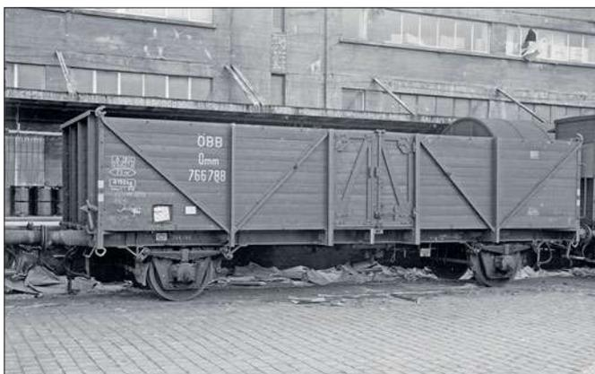
Der 1958 in Stuttgart Hgbf fotografierte Omm 766788 der ÖBB besaß wie der PKP-Wagen auf dem Foto darüber Holztüren der verstärkten Ausführung und die alten Bremsumsteller der Kriegsbauart.
