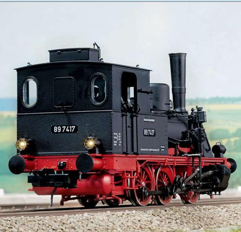
Die senkrechte Rückwand ist vorbildgerecht getroffen. Die Lampen sitzen auf Konsolen mit versteckt laufenden Kabeln für die LEDs.
