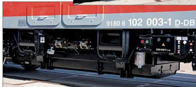
Der Trafo ist bei Drehstromloks üblicherweise zwischen den Drehgestellen angeordnet, seitlich ist eine der Ölumläufpumpen zu erkennen.
