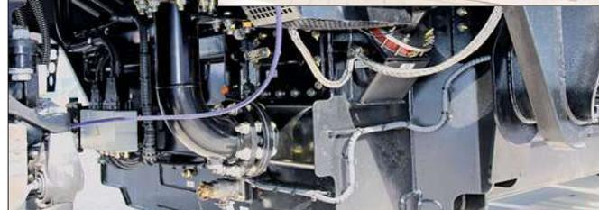
Links: Die Anschlüsse an der Trafomulde sind vielfältig. Im Vordergrund das Rohr zum Ölkühler im Maschinenraum.
