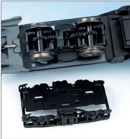
Zum Tauschen der Haftreifen lassen sich die Drehgestellseitenwangen samt Bodenplatte ganz bequem abklipsen.
