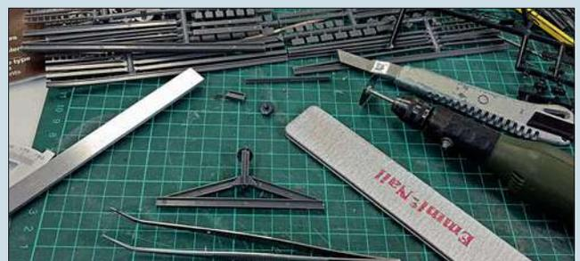
Links: Die Gegengewichte werden von unten eingeschoben und sozusagen verkehrt herum angeklebt. Seitlich müssen sie bis zum Aushärten des Klebers auf Abstand gehalten werden. Der Hebebaalken entsteht aus zurechtgeschnittenen I-Profilen aus dem Falter-Stahlprofile-Set. Dies lässt sich nur mit einer Trennscheibe, nicht aber mit dem Bastelmesser bewerkstelligen.
