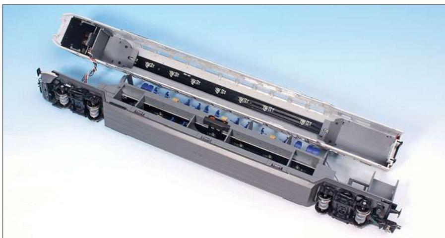
In den Raumdecken sowohl im Ober- als auch im Unterstock sind Platinen mit SMD-LEDs installiert. Die Zugzielanzeiger werden über lichtleitende Kunststoffteile ebenfalls durch kleine Leuchtdioden auf diesen Platinen beleuchtet. Die erforderlichen Drähte sieht man nicht.
