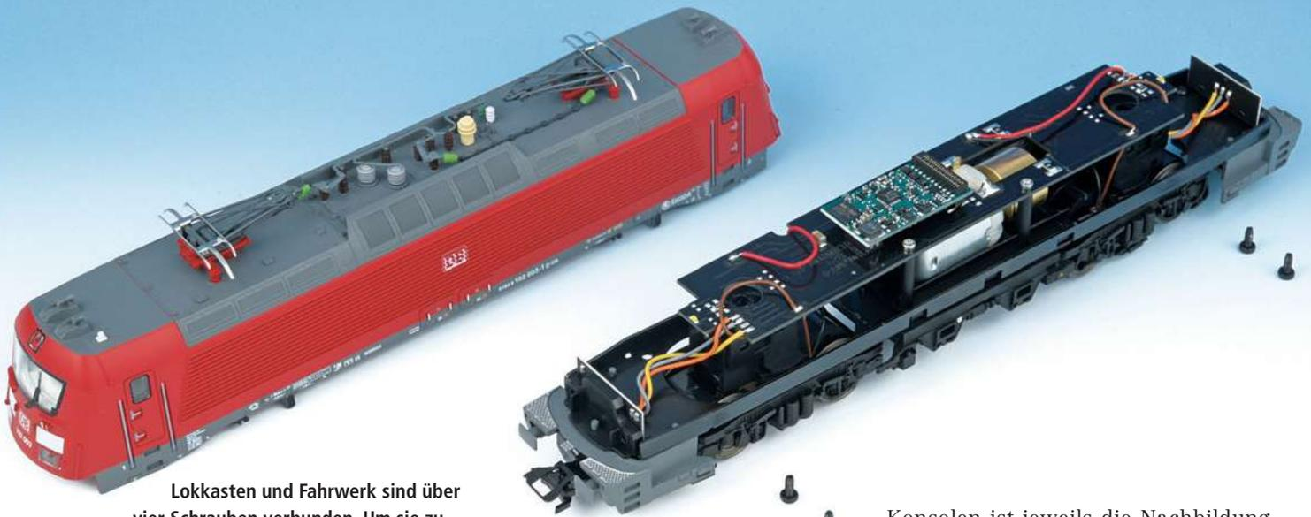
Lokkasten und Fahrwerk sind über vier Schrauben verbunden. Um sie zu erreichen, genügt es, wenn man die Drehgestelle ein wenig zur Seite schwenkt.
