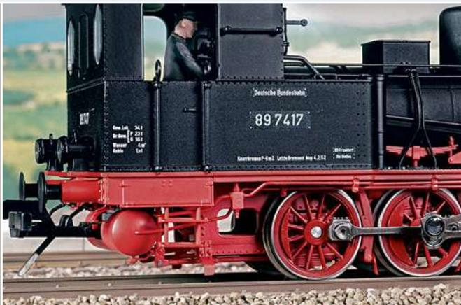
Blick durch den hinteren Teil des Rahmens mit Luftkessel und der erkennbaren Blattfeder unmittelbar hinter der dritten Achse
