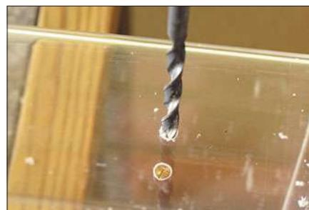
Dann werden die Löcher noch mit einem 3-mm-Bohrer gesenkt, sodass die Senkkopfschrauben bündig eingesetzt werden können.
