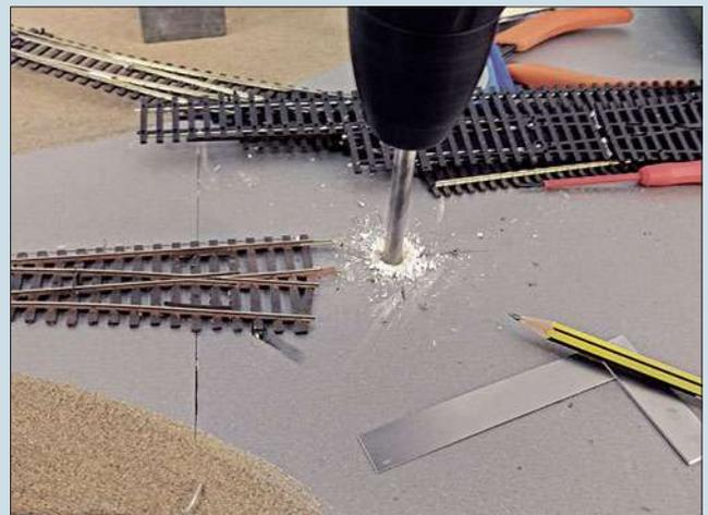
Für die Stelldrähte müssen entsprechend große Löcher (8 mm) gebohrt werden. Nur so hat der Stelldraht später genug Spielraum, sodass er seitlich nicht anschlägt.
