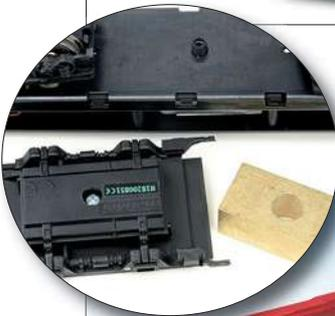
Oben: Die unteren Lampen der Frontbeleuchtung sind auf einer separaten, kabelgebundenen Platine untergebracht, während die dritte Spitzenlampe von einer LED auf der Hauptplatine versorgt wird. Der Führerstand hat keine Beleuchtung.
