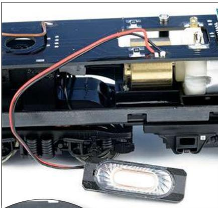
Der schmale Lautsprecher ist samt Schallkapsel neben der Schwungmasse festgeklebt. Er ist trotz seiner kleinen Bauform erstaunlich effektiv.
