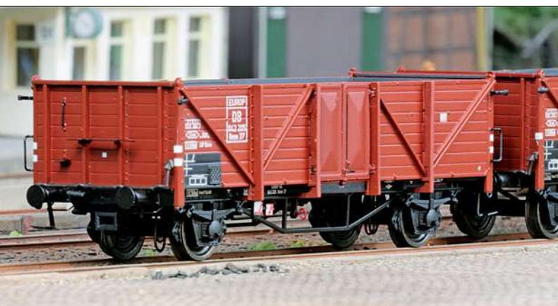
Wichtiger erscheint uns die erstklassige Detaillierung mit separat gefertigten Kastensäulen, sodass sogar die Nachbildung von Hinterschnidungen möglich ist. Die vielen eingesetzten Teile lassen kaum noch Verbesserungspotenzial, sogar die Ösen der Lösezüge sind bereits werksseitig rot lackiert. Zur Selbstmontage liegen Bremsschläuche und Kupplungsnachbildungen bei.
