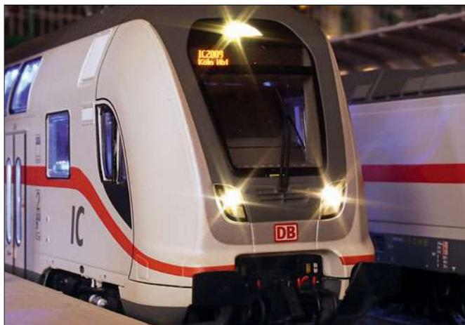
Die kleinteilige Beleuchtung der Steuerwagen umfasst neben dem Abblendlicht (im Foto links) auch ein Fernlicht (rechts). Überdies lassen sich der Zugzielanzeiger in Gestalt einer „bernsteinfarbenen“ Punktmatrix-Anzeige und das Führerstandslicht ein- und ausschalten. Durch diese differenzierbare und dabei stets vorbildgerechte Beleuchtung wirkt das Brawa-Modell des IC2 auch in H0 überaus realitätsnah.
