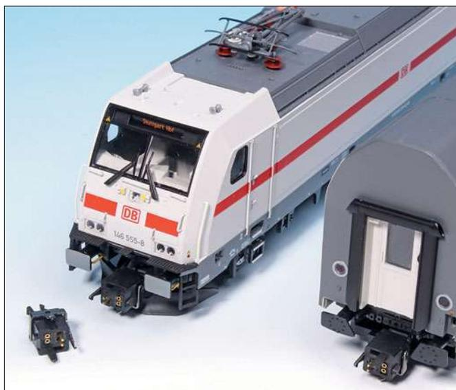
Zum Kuppeln des Modells der Traxx-Lokomotive der Baureihe 146.5 mit dem IC2 sind im Grundset zwei passende Kupplungen enthalten, die man in den Normschacht der Lok stecken kann. Diese ist nicht stromführend, ermöglicht es aber, dass man keinen bestimmten Wagen am Ende des Zuges haben muss.
