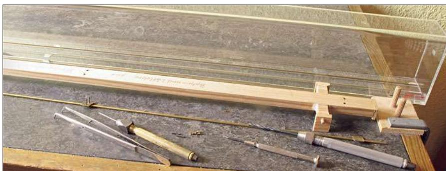
Damit die Fahrleitung mit ihren Halteplättchen und die Löcher in der Train-Safe-Röhre exakt zusammenpassen, wurde zunächst eine Montagelehre aus einer 2 x 1-cm-Holzleiste gefertigt. Hölzerne Anschläge gewährleisten eine exakte Position auf der Röhre. Die Bohrungen sind durch Messingröhrchen ausgebuchst, sodass die Löcher präzise bleiben.
