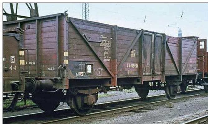
Der im März 1944 gebaute Ommu Klagenfurt 16 916 hatte bereits ab Werk unten aufgeweitete Kastenrungen. *Foto: Werk, Slg. SC*
