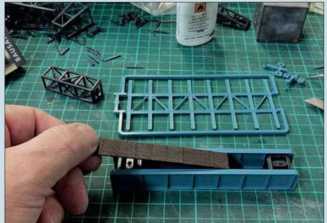
Für den eigentlichen Querträger dienen die Seitenelemente einer Blechträgerbrücke als Korpus. Sie wurden mit Würfeln der Stako-Elemente verklebt und oben mit einem Abschlussstreifen, der genietete Eisenplatten darstellt, verschlossen.
