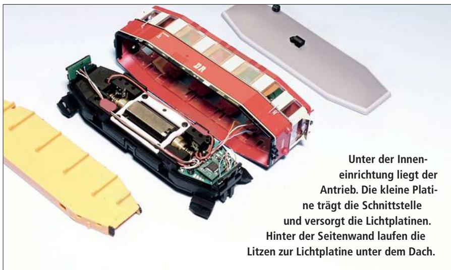
Unter der Inneneinrichtung liegt der Antrieb. Die kleine Platine trägt die Schnittstelle und versorgt die Lichtplatinen. Hinter der Seitenwand laufen die Litzen zur Lichtplatine unter dem Dach.
