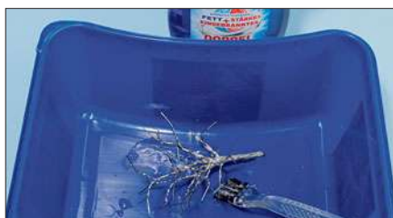
Das anhaftende Flussmittel sollte unbedingt entfernt werden. Dabei helfen Spülmittel, eine kleine Bürste und warmes Wasser.
