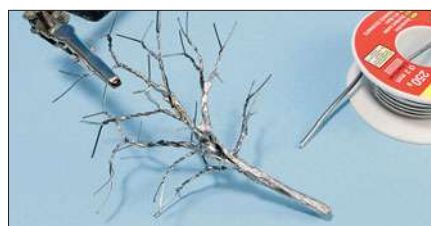
Nach und nach werden die Drähte aus dem Stamm gebogen und verdreht. Das Zinn wird mit einem kräftigen LötKolben aufgebracht.
