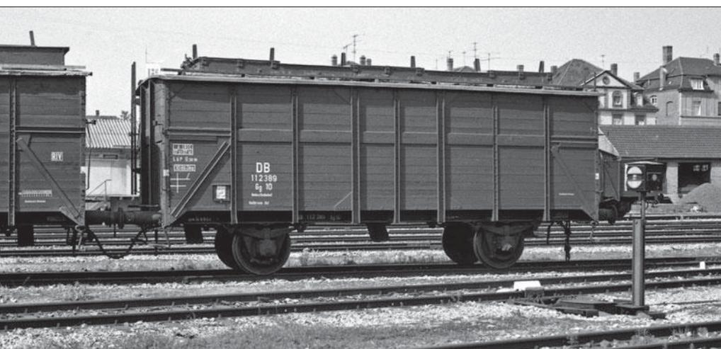
L-Profilen in derselben Position. Darüber hinaus baute man in der DDR bei vielen Wagen ab Anfang der 60er-Jahre die Bremserhäuser ab und versah die Wagen mit einer die Puffer überragenden Handbremsbühne, wobei man dann bisweilen auch an diesem Wageneinde die Stirnwandsäulen drehte.
