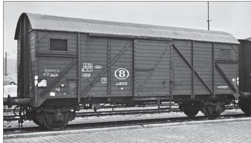
Zwei typische aus Deutschland stammende Belgier mit dem belgischen Standard entsprechenden Lade- und Lüftungsluken, eingeschweißten Endfeldverstärkungen und großen Dachüberständen: links der 1040106, ein ehemaliger Glts Dresden mit überbreiten Stirnwandtüren; rechts der 4416926, ein zu einem G-Wagen umgebaute ehemaliger KPwgs-44. Fotos (8) Fritz Willke
