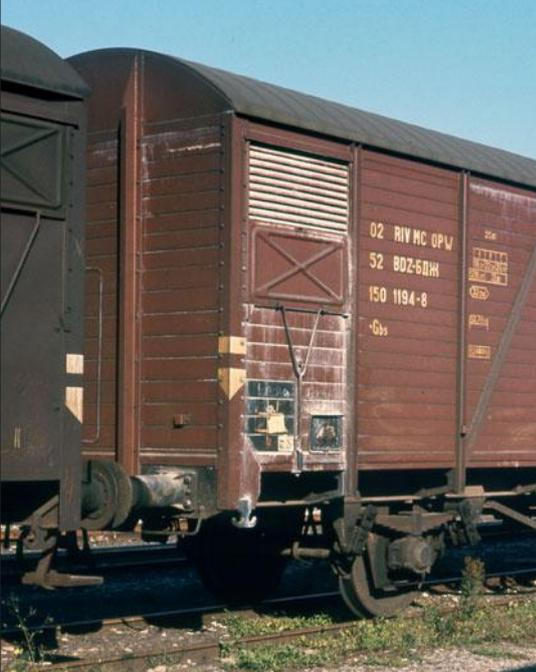
Noch moderat war die Verschmutzung mit herabgewaschenem Kalkstaub beim Gbs 150 1194 der BDZ, aufgenommen im September 1970. Der meiste Kalk war in den Lüftungslamellen zu finden und auf den Brettern darunter. Die Kalkspuren am Wagenoberrahmen lassen auf Undichtigkeiten in diesem Bereich schließen.
