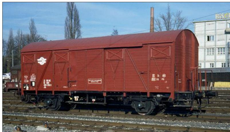
verwendete Kddet(h) mit Heizleitungen und O-GP-A-Bremsen wurden zu Gqrss 170 5000 ff.
