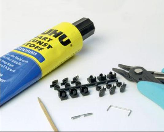
Die serienmäßigen Kupplungshaken aus POM werden gegen solche aus PS von von Freudenreich getauscht, die, lackiert und mit einem Metallstreifen aus Heftklammern versehen, elektromagnetisch entkuppelt werden können.
