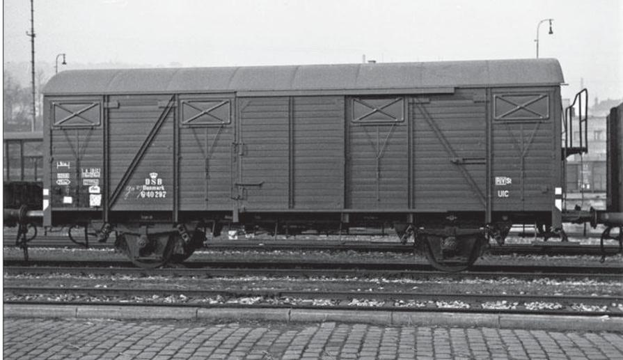
Die DSB beschaffte gedeckte Wagen nach den UIC-Zeichnungen in der Ausführung mit Bretterwänden, die ersten davon mit Zollverschlüssen. Eine Besonderheit waren die auf halber Höhe angebrachten Handbremsstege: für die Kurbel musste das Stirnwandsegment in diesem Bereich ausgespart werden. Die Fotos zeigen den G 40 297 (links) vermutlich 1957 in Stuttgart Hgbf sowie die Gs 1230005 ohne Handbremse (unten links) im Juni 1965 und 1202968 (unten rechts) im März 1977 im Rbf Untertürkheim.
