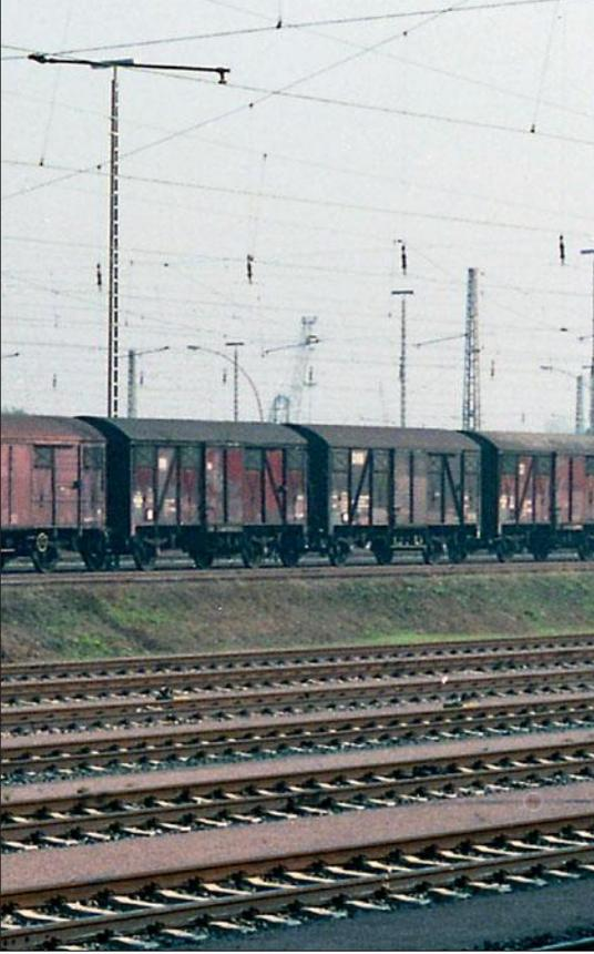
Die für die Eisenbahnen des Saarlandes gebauten Gmhs 54 entsprachen dem UIC-Standard. Die DB reihte sie 1957 als Gmhs 55 ein, da die Bauartnummer 54 bereits belegt war. Der Gmhs 55 254 922, aufgenommen 1959 in Stuttgart Hgbf, besaß noch französische Signalstützen.
