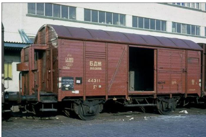
Zwei weitere an die BDŽ gelieferte Wagen aus deutscher Fertigung: Das Bild oben zeigt den Fz 44311 im Dezember 1966 in Stuttgart Hgbf. Er entsprach den Gr Kassel der Austauschbauart, besaß aber ein Blechdach, verstärkte Bremserhäuser und Türen sowie eine Kunze-Knorr-GP-Bremse. Der Forz (darunter) war in Anlehnung an die Grs Oppeln gebaut worden, aber mit zusätzlich Lüftungsschiebern im Bodenbereich zum Obsttransport.
