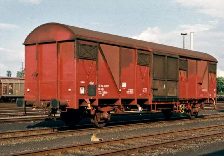
Die UIC-Gbs der SNCB besaßen Leichtmetalltüren und darunter zwei Einzeltritte: oben der 150 2 999, ein Wagen des Typs 2216A8 mit Feststellbremse, im Juni 1997 im AKN-Rbf Hamburg-Tiefstack. Foto SC
