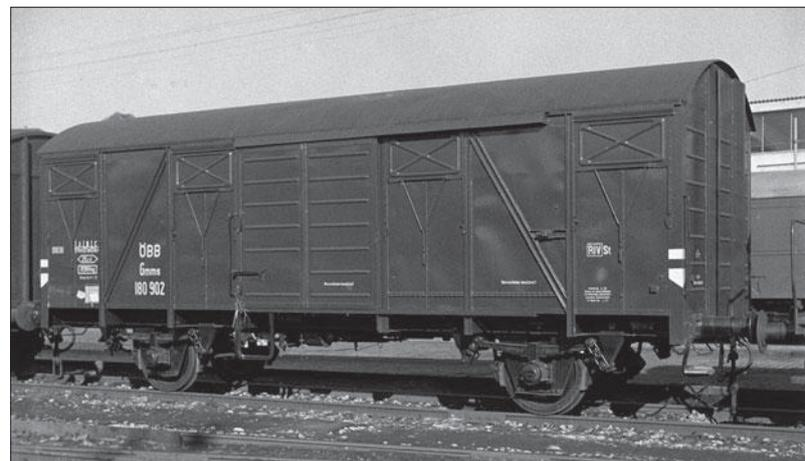
Die von der SBB beschafften gedeckten Wagen in UIC-Abmessungen wiesen zwei Besonderheiten auf. Diese K4 hatten zum einen selbsttragende Blechdächer mit Stirnwandsegmenten aus Blech, zum anderen Schiebetüren aus Leichtmetall: rechts der K4 47128 aus einer frühen Lieferserie mit Seilösen 1956 in Stuttgart Hgbf, darunter der Gs 120 1 433 mit Seilhaken im März 1994 im Gbf Hamburg-Altona. *Fotos Fritz Willke, SC*
