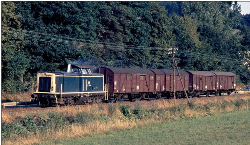
Am 31. August 1983 zog 211 232 den Ne Gummersbach–Brügge–Hagen; das Foto entstand bei Kierspe. Gebildet war er aus einer Hkks-uvz 332-Einheit und der aus den beiden oben gezeigten Hks-vz 333. Foto Peter Schiffer, Slg. Eisenbahnstiftung.
