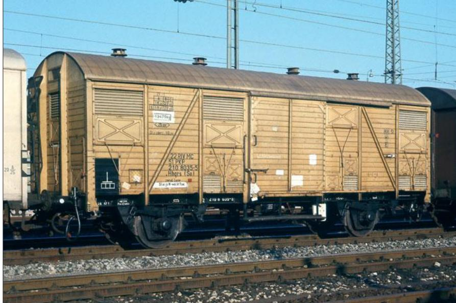
Im September 1971 stand der Obst- und Gemüsewagen Hhqs(So) 210 8035 der PKP im Rbf Untertürkheim. Abmessungen, grundsätzliche Konstruktion und die Bauteile entsprachen dem UIC-Standardtyp, deshalb hatte die PKP ihn wie ihre Ggs als Einheitswagen eingestuft. Die zusätzlichen Lüftungsöffnungen über dem Wagenboden und in den Stirnwänden sowie die Flettner-Rotoren waren Zutaten für den speziellen Einsatzzweck.
