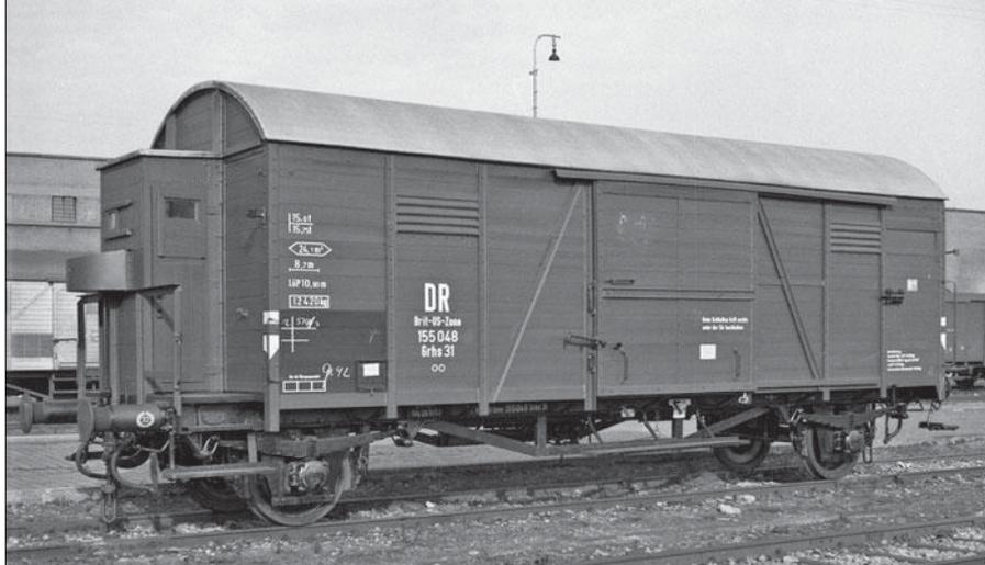
Die langen Oppeln, bei der DRG ursprünglich als Glhs Dresden eingereiht, waren die erste neue Wagenbauart mit langem Achsstand, GP-Wechsel an der Bremsanlage und Dampfheizleitungen. Das Foto zeigt den am 28.10.53 im AW Oldenburg aufgearbeiteten Grhs 31 155 048 in Stuttgart Hgbf wenige Tage nach dem AW-Aufenthalt.
