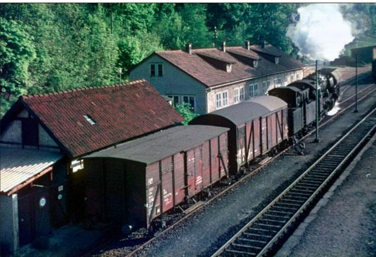
Bahnhof Alpirsbach am 15. Mai 1971: Links erledigte 050 443, die an dem Tag den Ng 16859 beförderte, das Rangiergeschäft. Deutlich ist der Unterschied zwischen der Gewebedachdecke des Gklm 191 112 7 413 vorn und der teilweise erneuerten PVC-Dachdecke des Gls 205 132 4 335 dahinter zu erkennen.
