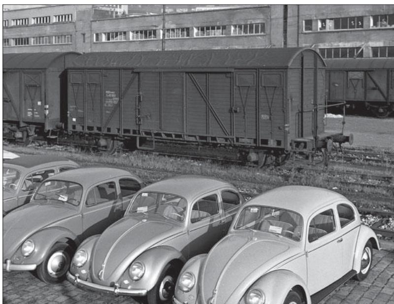
im Stirnwandsegment. Wie die Gmhs 53 der DB hatten auch die ersten G der DSB nur 1,80 m breite Türen. Zwischen 1959 und 1964 kamen weitere 2.000 G-Wagen hinzu, nun mit 2,00 m breiten Türen, KE-GP-Bremsen und ohne Zollverschlüsse, jedoch weiterhin mit halbhohen Handbremsstegen.
