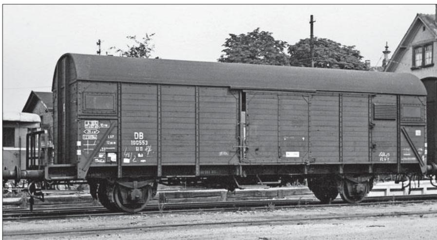
Der Gl 11 190 553 besaß Ladeklappen über niedrigen Aussteifungen in den Endfeldern und ebenfalls Austauschbauart-Achshalter. Rechts hatte der im August 1965 in Wiesloch fotografierte Wagen, bei dem das Bremserhaus abgebaut worden war, eine Lüftungsöffnung. Fotos J. Claus, Slg. Eisenbahnstiftung
