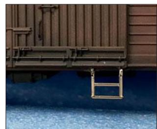
Pannen können passieren: Beim Drehgestellwagen traf es einen Türtritt, der durch ein geätztes Messingteil ersetzt wurde.
