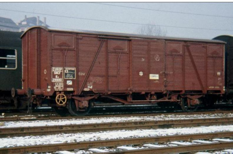
Auch wenn die Standardwagen sich verkehrlich glichen, waren längst nicht alle nach UIC-Zeichnungen gebaut. Auch nationale Besonderheiten flossen in die Konstruktion ein, insbesondere Wandbekleidung und Bremsausrüstung differierten stark. Die Bilderreihe rechts zeigt diese Vielfalt; oben der Gmhs 53 251 760 mit Plattenwänden im August 1965 in Basel. Foto Joachim Claus, Slg. Eisenbahnstiftung
