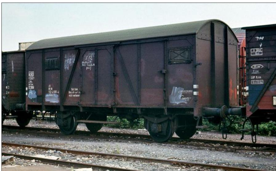
Links: Bremsumsteller eines Gos 245: Die Hebel sind nachlackiert, da sie deutlich erkennbar sein müssen, der Rest ist ziemlich verschmutzt. Dasselbe gilt auch für die Schürze unter der Tür und bei genauer Betrachtung sind rechts am Türrahmen Lackabplatzungen als Folge von Rost zu sehen. Foto SC
