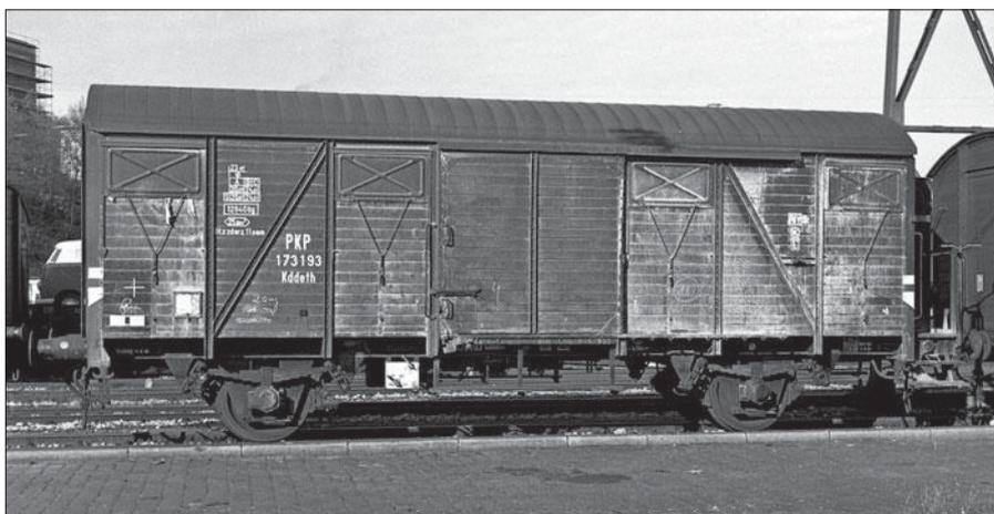
Die ab den 50er-Jahren gebauten Kddet(h) der PKP entsprachen weitgehend den UIC-Zeichnungen mit Bretterwänden. Besondere Merkmale waren die quer gesickten Dächer und die Blechbremserhäuser auf den Vorbau-Handbremsbühnen.
