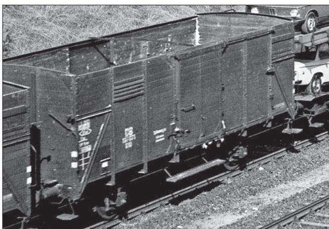
Der ungebremste Gh 10 121 862, aufgenommen im März 1961 in Unna, ist vermutlich schon vor dem Vlmms 63-Umbauprogramm aus einem Vh 14 entstanden. Foto Reinhardt Todt, Slg. Eisenbahnstiftung
