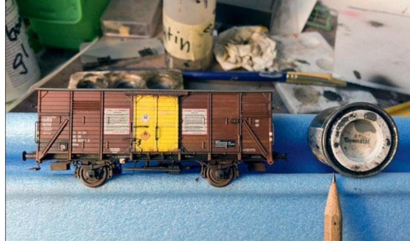
Grafit und Gunmetal erzeugen die metallische Note an den eisernen Beschlägen. Insbesondere hier ist aber Vorsicht geboten: Weniger ist in der Regel mehr.
