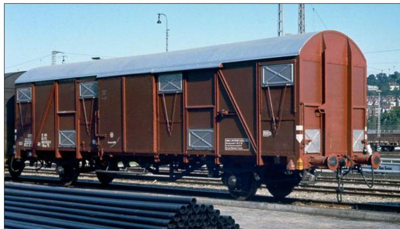
Gltmm(eh)s 62/Hbcs 300, Gbs 256 und Gbs 257. Nur ein Teil der zuletzt gebauten Gbs 254 und die von vornherein für den Einbau der AK vorbereiteten Gbs 252 waren mit RIV St UIC gekennzeichnet. Die häufig auch in Deutschland anzutreffenden spurwechselfähigen Gbs der Transfesa waren hingegen nur einfache RIV-Wagen.
