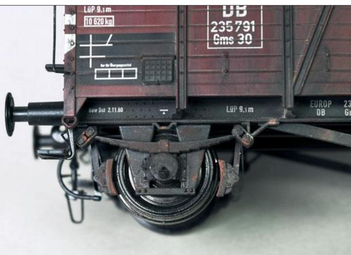
**Ein verschmutztes Laufwerk im Detail: Gut sind die Rostspuren zu erkennen. Das Foto zeigt jedoch auch, dass am Tritt noch Nacharbeiten erforderlich sind, sowie die Schwachstelle vieler Brawa-Oppeln: die hängenden Bremsklötze. Sie fallen zwar im Anlagenbetrieb nicht auf, auf Detailfotos aber umso mehr.**
