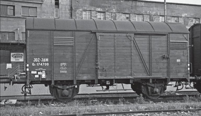
Auch viele Gr Kassel der Austauschbauart blieben bei Kriegsende im Ausland. Zu ihnen gehörte der 1954 in Stuttgart Hgbf aufgenommene Gv 174700 der JDŽ, wie viele von der DRB stammende G-Wagen mit einem Blechdach und Gittern vor der Ladeklappe versehen.
