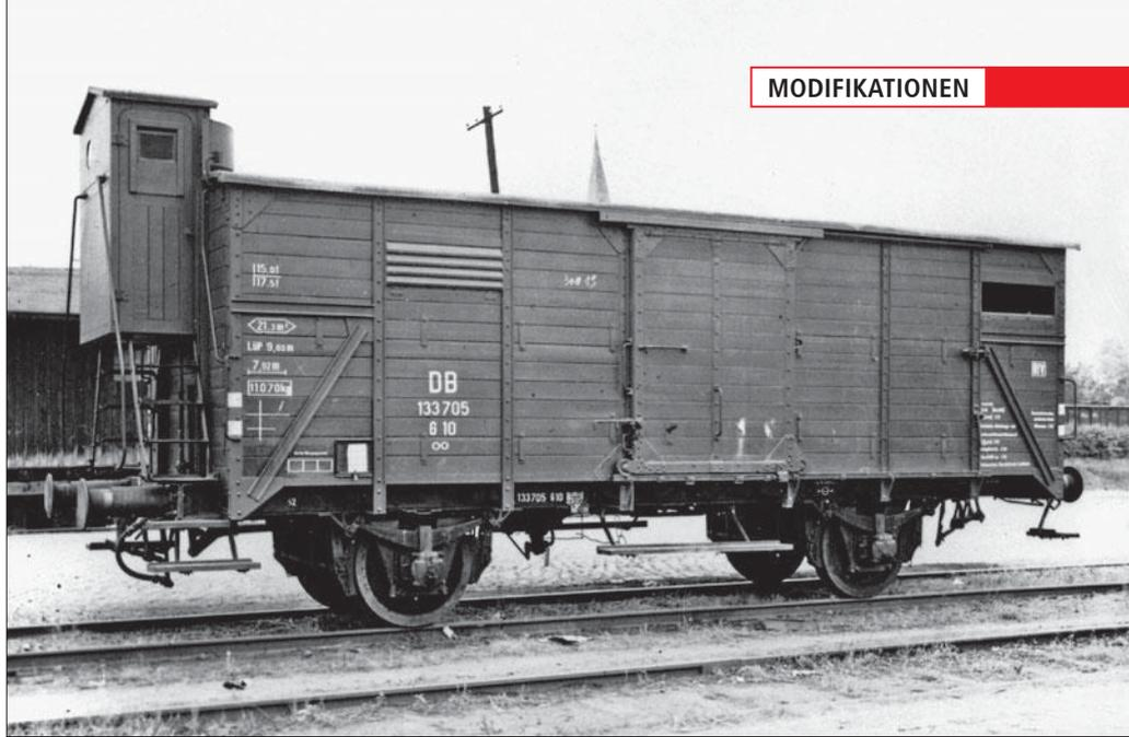
genden Ausgaben der Zeichnung, die bedeckten (später gedeckten) Wagen in unterschiedlichen Ausführungen dargestellt: als ungebremste Wagen oder mit Handbremse sowie mit zwei oder vier Lade- und Lüftungsöffnungen auf jeder Wagenseite.
