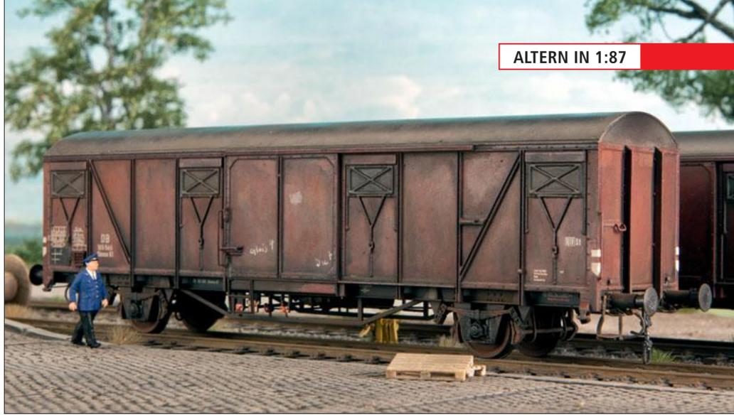
Die wesentlichen Abmessungen entsprechen dem Vorbild bzw. weichen maximal im 1/10-mm-Bereich davon ab. Am Untergestell sind die Achsbremsgestänge sogar mit Bremsfangschlingen nachgebildet. Darüber, dass nicht alle Bremsklötze genau auf der Ebene der Radlaufflächen liegen, lässt sich hinwegsehen. Die Bremsumstellhebel und die Lösezüge der Bremse sind sogar farblich abgesetzt.
