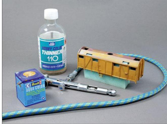
„Lackierung rückwärts aufgebaut“: Nach einer weißen Grundierung erfolgt eine holzbraune Lackierung mit Farben aus dem Revell-Aqua Color-Programm.
