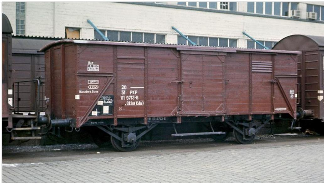
Der im März 1958 in Flensburg fotografierte 4417002 war als Waffenstillstandswagen nach dem Ersten Weltkrieg zur SNCB gekommen. Bei der SNCB erhielt er Lade- und Lüftungsklappen, Zug- und Stoßeinrichtungen belgischer Bauart und eine Westinghouse-Bremse. Außerdem wurde die Handbremse nach unten verlegt und der Wagen ausgesteift. *Foto P. E. Clausen, Slg. DMJK*
