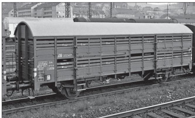
Ebenfalls in Stuttgart Hgbf entstand das Foto des Hbqrss-57 Glmehss 216 470 mit Doppelbremsklotzsohlen und automatischer Lastabbremung. Fotos (6) Fritz Wilke
