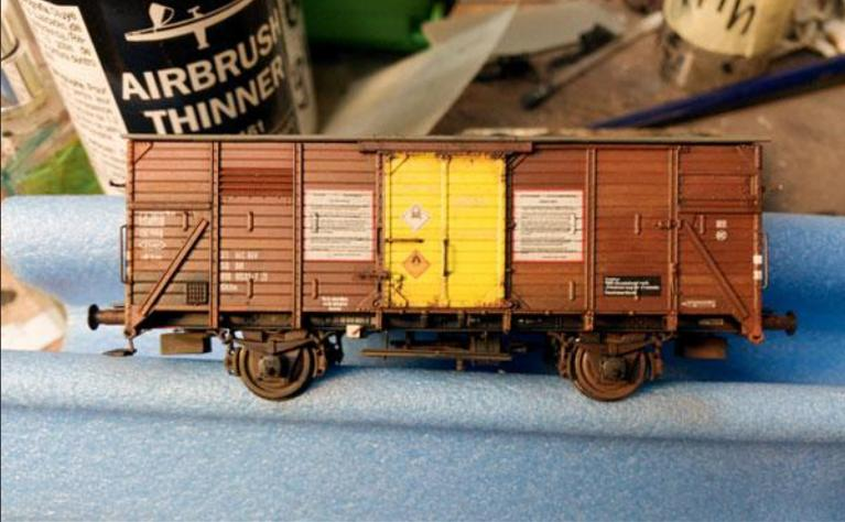
Rost und Schmutz an den Türführungen und Laufrollen werden mit einem spitzen Pinsel mit brauner Acrylfarbe aufgebracht und das Dach und die Achslager erhalten mit Braun und Schwarz den letzten Schliff.
