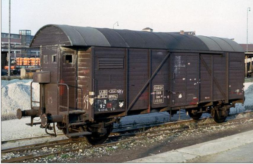
Zwei Drittel der ÖBB-G-Wagen im EUROP-Park waren Bremen und deren Nachbauten; links zwei solcher Nachbauten: der Gms 170 156 mit in den Wagenkasten integriertem Bremserhaus im September 1965 im Gbf Bad Cannstatt und darunter der GmDs 151 543 mit Sprengwerk und Blechsegment in der Stirnwand, 1965 in Stuttgart Hgbf – mit Aufklebern für Hoechst-Düngemittel und Hakle-Toilettenpapier.
