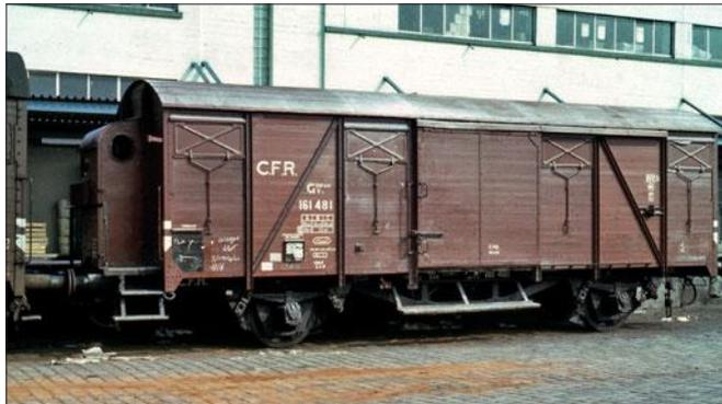
Zwei RIV-St-Wagen der CFR, links der Gv<sup>SDFWH</sup> 161481 im Jahr 1965 in Stuttgart Hgbf: Gleitlager, Bremserhaus, Lüftungsschieber und Dachwölbung waren noch weit vom UIC-Standard entfernt. Hingegen war der im Oktober 1977 im Rbf Untertürkheim aufgenommene Ggs 148 6452 mit Plattenwänden und zur Mitte versetzten Seilhaken sogar nach den UIC-Zeichnungen gebaut.
