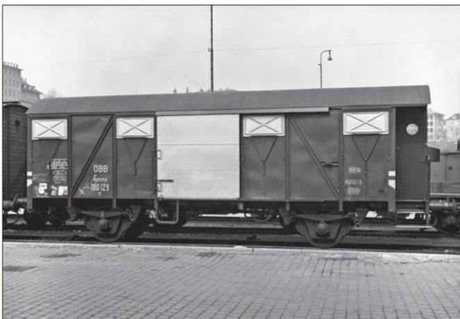
Bei späteren Lieferungen verzichtete die ÖBB auf die Zollverschlüsse an den Schiebern. Die Beisserleisten zum Festlegen der geöffneten Türen behielt man hingegen bei. Das Foto zeigt den Gmms 180 902 1957 in Stuttgart Hgbf. Fotos (7) Fritz Willke
