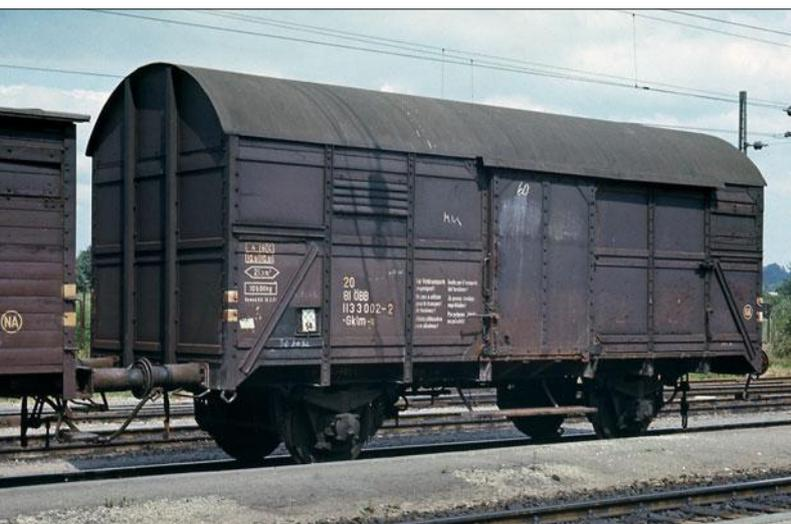
Beim dem im Juli 1971 in Gmunden Hbf fotografierten Gklm-u 113 3 002 der ÖBB kamen so ziemlich alle denkbaren Umbauten zusammen: Endfeldverstärkungen (in alter Form), Abdichtung der Wände durch Blechplatten und Aufbau eines Tonnendaches, hier mit durchlaufenden Stirnwandsäulen.
