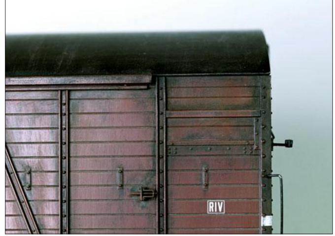
Die rechte Seite im Detail: Auch hier sind die Verschmutzungen verstärkt im Bereich der Profile und der Ladeklappe. Außerdem glänzt die Feder im Türpuffer als Andeutung des Schmieröls.
