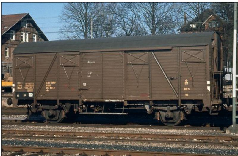
und Lüftungsschieber aus Aluminium. Die K 4 hatten selbsttragende Blechdächer, O-GP-Bremsen und keine Zollverschlüsse. 50 Wagen des Baujahrs 1958 mit elektrischen Heizleitungen wurden als Eilgutwagen verwendet. Sie wurden 1965 in Gqss 170 4 000–170 4 049 umgezeichnet. Alle anderen K4 wurden in Gs 120 0 000 ff. umgezeichnet und liefen weiterhin als EUROP-Wagen – mit Ausnahme dreier Wagen, die einem Kunden fest zugeteilt waren.
