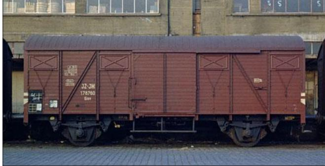
Der vermutlich 1963 in Stuttgart Hgbf aufgenommene Giov 178760 der JŽ entsprach ebenfalls den UIC-Vorgaben. Wie bei vielen Ostblock-G-Wagen war das Dach durch kleine Sicken (hier die Pafawag-Form) versteift.
