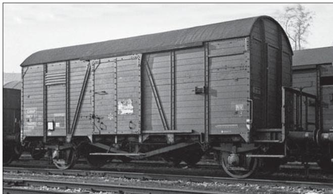
Auch Exoten landeten im EUROP-Park: Der Kf 7440912 war ein von der DRG als Versuchswagen gebauter genieteter Ghs Kassel in den Abmessungen der späteren Gs Oppeln, der 1945 in Frankreich blieb.
