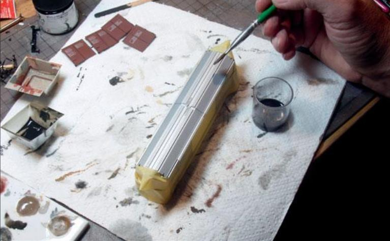
Um das Dach zu bearbeiten, wird der Wagenkasten vollständig abgeklebt. Danach wird das Dach mit Mattlack aus der Spraydose lackiert. Anschließend erfolgt ein dezentes Washing mit sehr stark verdünnter braunschwarzer Farbe.
