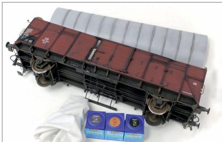
Bereich der Anschriften wische ich die Farbe danach mit einem Wattestäbchen und ggf. etwas Alkohol wieder ab, damit die Schrift wieder freigelegt wird. Die Alterung des Untergestells ist der schwierigste Teil des Patinierens, da alle Ecken und Löcher erreicht werden müssen, um einen überzeugenden Eindruck zu erhalten.
