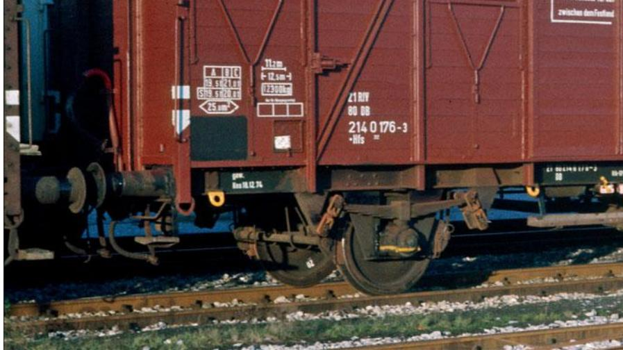
Der am 18.12.74 frisch lackierte Hfs 312 214 0 176 war zum Zeitpunkt der Aufnahme erst wenige Tage wieder im Einsatz. Die Verschmutzung durch Flugrost im Laufwerksbereich und der Rost auf den Doppelschaken waren jedoch älter. Deutlich ist zu erkennen, dass man den Anstrich des Untergestells nur im Bereich der Anschriften erneuert hatte. Das Bild zeigt auch die Spuren von Schmieröl an den Pufferstößeln und den Gleitbacken der Achshalterbleche.
