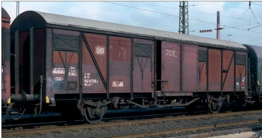
klötzen und automatischer Lastabbremung, sodass sie als Glmmehs für eine Geschwindigkeit von 120 km/h geeignet waren.
