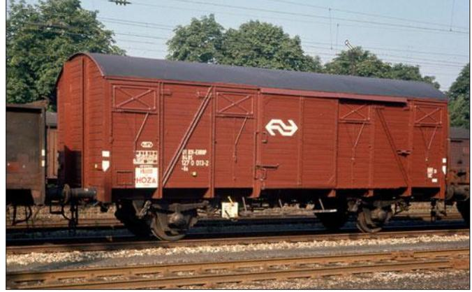
Am selben Ort, jedoch knapp drei Jahre zuvor im Juli 1970: der Gs 127 0 013 der NS, mit Zollverschlüssen an den Klappenschiebern und dem markanten Umstellschild der Westinghouse-Bremse.
