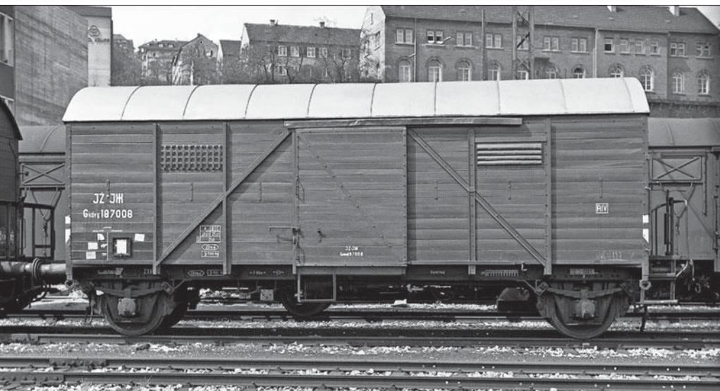
Ehemalige Bremen verblieben nach 1945 auch in Jugoslawien. Die Bilder zeigen links den Gkgvd 187889 der JŽ mit neuen Lade- und Lüftungsöffnungen im Frühjahr 1959 in Stuttgart Hgbf. Hingegen besaß der im Sommer 1954 fotografierte Gvg 184074 der JDŽ (oben) noch die ursprünglichen Öffnungen. Bei beiden Wagen fallen die verzogenen Abdeckungen der Türlaufschienen auf.
