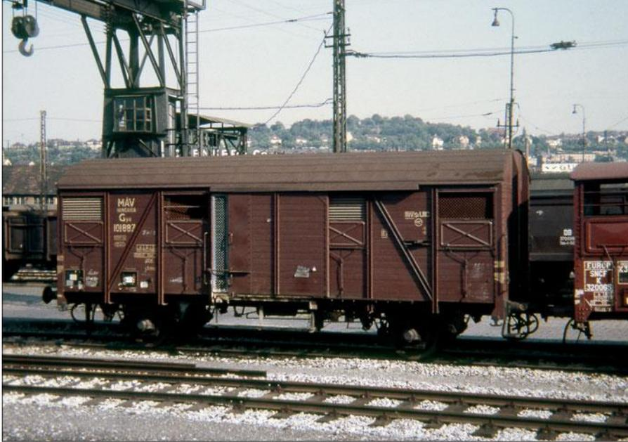
Der MÁV Gye 101887 mit Bretterwänden und in Längsrichtung gesicktem Dach stand im August 1964 in Stuttgart Hgbf. Neben der teilweise geöffneten Schiebetür ist das aus der Tür herausgezogene Belüftungsgitter für den Obst- und Gemüsetransport zu erkennen.
