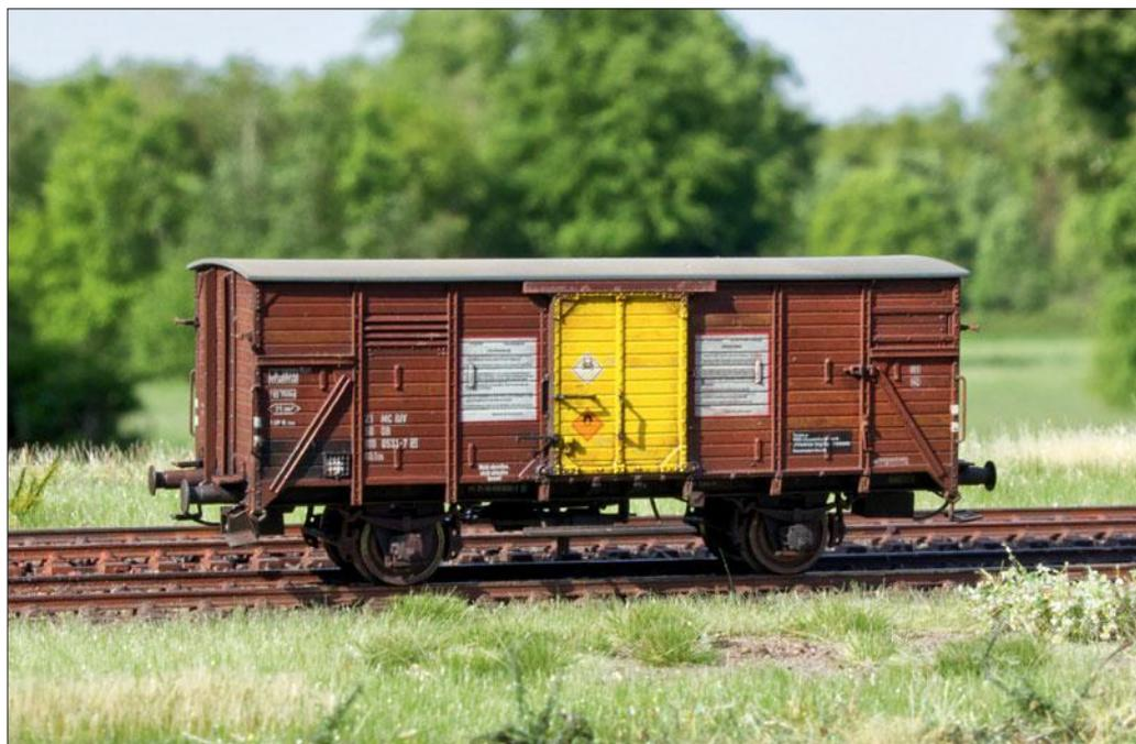
Wagen deutscher Bauart entstanden weder zwangsläufig in Deutschland, noch kamen sie stets als „Beutewagen“ oder Reparationsleistung in andere europäische Länder. Den F N° 30513 lieferte Arlöfs Mekaniska Verkstad & Waggonfabrik in Schweden 1913 nach Verbandsbauartzeichnungen an die BDŽ. *Werkfoto, Slg. Paul Scheller*
