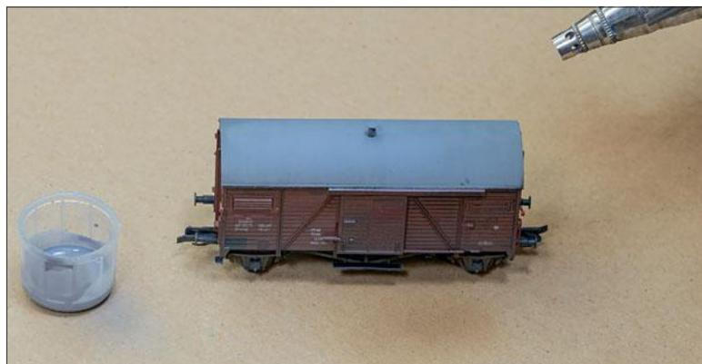
zu beachten, dass die Beschriftungen am Untergestell sichtbar bleiben. Gegebenenfalls sind die Beschriftungen bei zu starker Abdeckung wieder zu säubern. Auch hierfür kann man ein Wattestäbchen benutzen, das mit etwas Verdüner angefeuchtet wurde.
