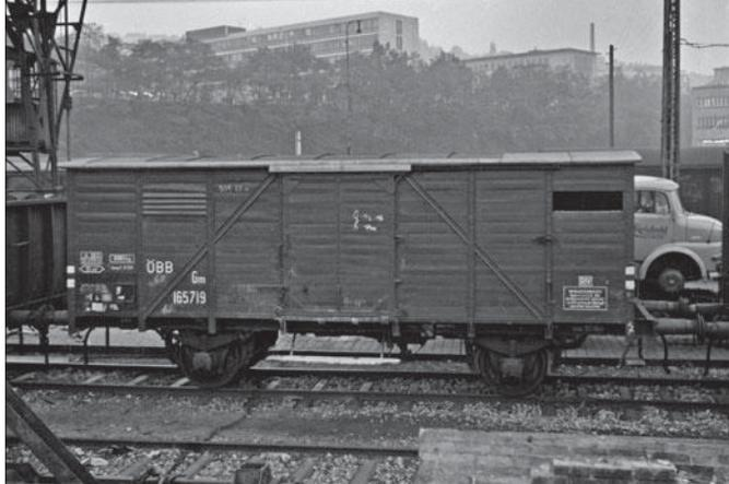
Mit der bei der ÖBB üblichen Form der Verstärkungen, Blechdach und ohne Bremserhaus 1963 aufgenommen bei strömenden Regen in Stuttgart Hgbf: der als Versuchswagen mit 20-t-Radsätzen ausgestattete Gm 165 719.
