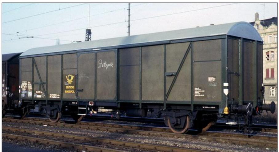
Die 4,40 m breiten und 2,20 m hohen Türen waren wie die Mitteltüren von Schiebewandwagen ausgeführt. Zurrösen im Fußboden und am Obergurt dienten der Ladungssicherung.
