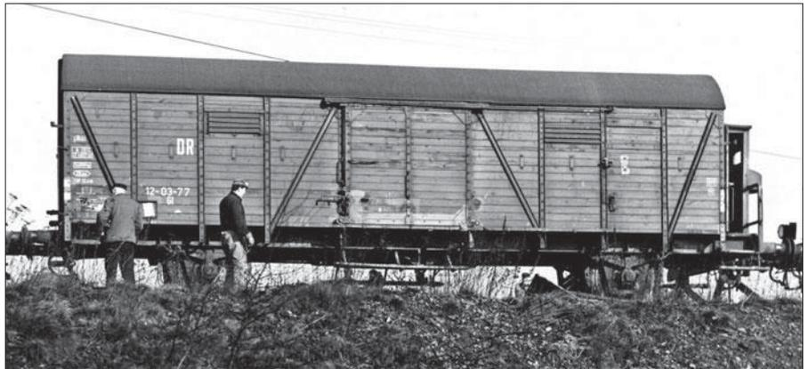
Der GI 12-03-77 der DR, aufgenommen im Februar 1964 in Zwickau, entspricht technisch zwar grundsätzlich dem oben gezeigten 12-02-62, bei diesem Wagen waren die Diagonalprofile aber unten direkt mit den Kastensäulen verschweißt. Außerdem hatte er damals bereits Rollenlagerradsätze. Foto Günter Meyer, Slg. Dr. Manfred Meyer
