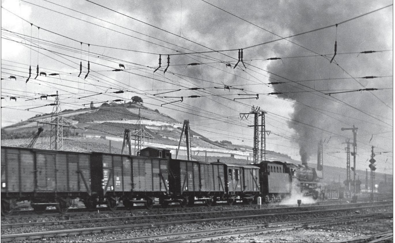
Bis Mitte der 50er-Jahre prägten die Flachdach-G-Wagen der Länder- und Verbandsbauart das Bild der Güterzüge, so wie bei diesem von einer Lok der Baureihe 44 am 11. Oktober 1954 durch Würzburg gezogenen Dg aus Bebra. Foto Bustorff, Slg. SC
