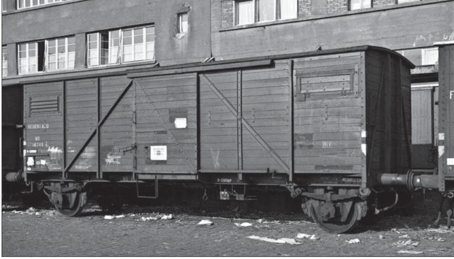
Während andere Bahnverwaltungen Flachdachwagen mit einem Tonnendach versahen, erhielt dieser ehemalige Gms Bremen bei der NS ein Flachdach; das Foto zeigt den als 14749 eingereihten Wagen Anfang der 50er-Jahre in Stuttgart Hgbf.
