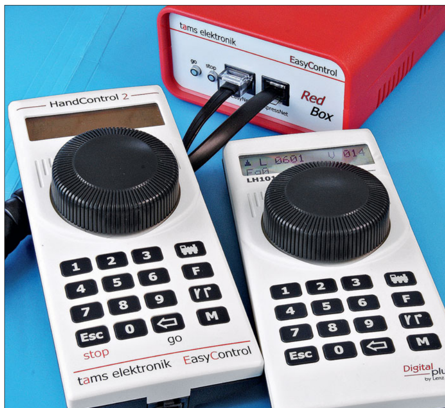
An der RedBox von Tams kann neben der hauseigenen HandControl 2 auch der Lenz Handregler LH101 betrieben werden.
