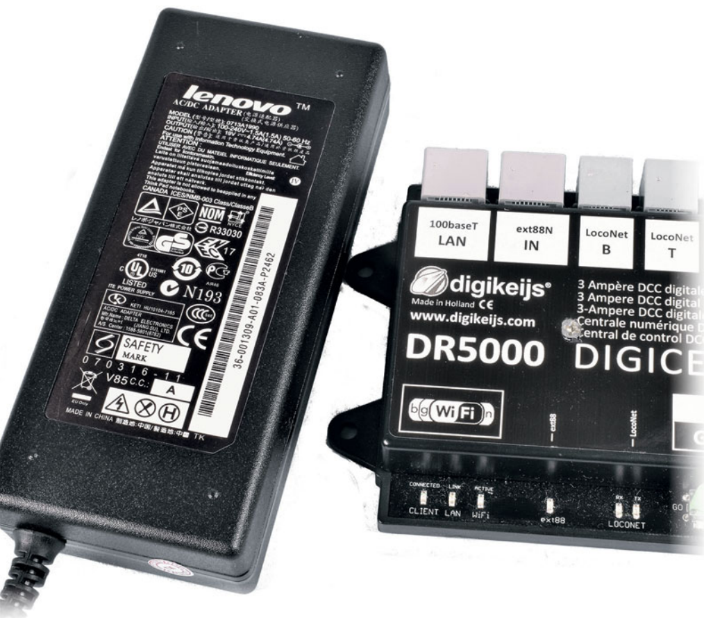
Bei meiner Digikeijs DR5000 lag ein Laptop-Netzteil von Lenovo bei. Damit ist die DR5000 kein Spielzeug, da die Modellbahn auch ohne PC-Anschluss sofort eine PELV-Anlage wird.
