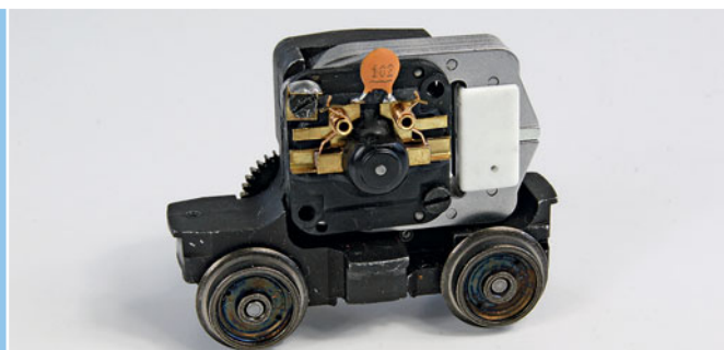
Für den Umbau muss das Antriebsdrehgestell ausgebaut werden. Der Permanentmagnet und das neue Motorschild sind bereits montiert.
