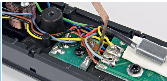
Die Platine für die bisherige Ansteuerung der Beleuchtung muss entfernt werden. Die Kontaktfeder dient dem Oberleitungsbetrieb.
