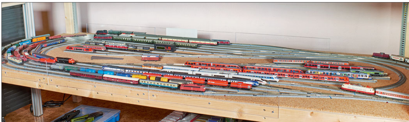
Blick in den Schattenbahnhof, der etwa 45 cm unter der oberen Ebene mit dem geplanten Bw angeordnet ist. Dadurch ist ausreichend Platz für den Zugriff auf den Fahrzeugpark und auch bei Installationsarbeiten unter der oberen Ebene.
