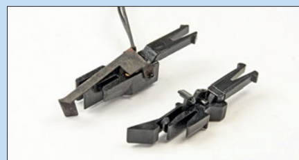
Von Krois-Modell kommt die elektrische Kupplung DKK. Das passende Gegenstück bildet die Roco-H0-Kurzkupplung. Krois-Kupplungen dürfen maximal 10 Sekunden eingeschaltet werden. Das erfordert Decoder mit Zeitsteuerung oder Schutzschaltungen.
