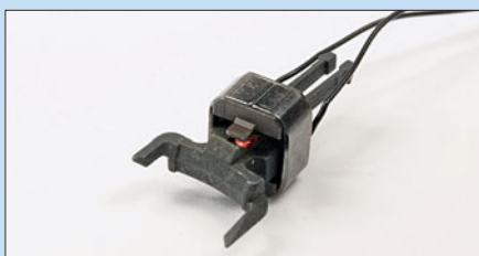
Die elektrische Kupplung (131172) von Roco arbeitet zuverlässig. Da sie keinen Dauerstrom verträgt, ist eine Ansteuerung mittels Schutzplatine oder entsprechend konfiguriertem Digitaldecoder zu empfehlen. Sie ist über den Roco-Kundendienst zu bekommen.
