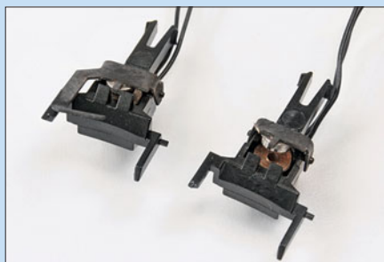
Für Einfach- und Doppeltraktionen bietet Krois-Modell die hier gezeigten Kupplungen MK1 und MK2 an. Sie kuppeln mit der Roco-Universalkupplung und der Märklin-Kurzkupplung.
