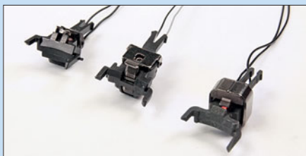
Von links nach rechts: Krois Digitalkupplung, die „neue“ Märklin-Telex-Kupplung und die Digitalkupplung von Roco
