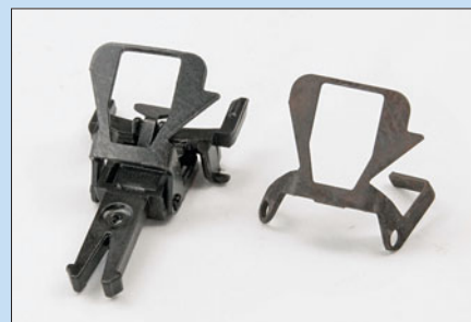
Da die Krois-Digitalkupplungen einen Magneten eingebaut haben, der die Metallbügel der Märklin-Kupplungen anzieht, bietet Krois passende nichtmagnetische Messingbügel zum Umbau der Märklin-Kurzkupplungen an.
