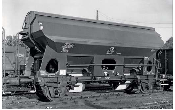
Während DWM die Stützbleche bis 1969 mit eingeschweißten Blechstreifen verstärkte – links der am 30.6.69 fertiggestellte Tdgs 930 574 1 587 im August desselben Jahres im Rbf Untertürkheim – baute Talbot bereits 1962 Wagen mit gepressten Blechen. Zu ihnen gehörte der am 22.8.62 gelieferte Tdgs 69 Ktmvms 354 366. Fotos: Fritz Willke
