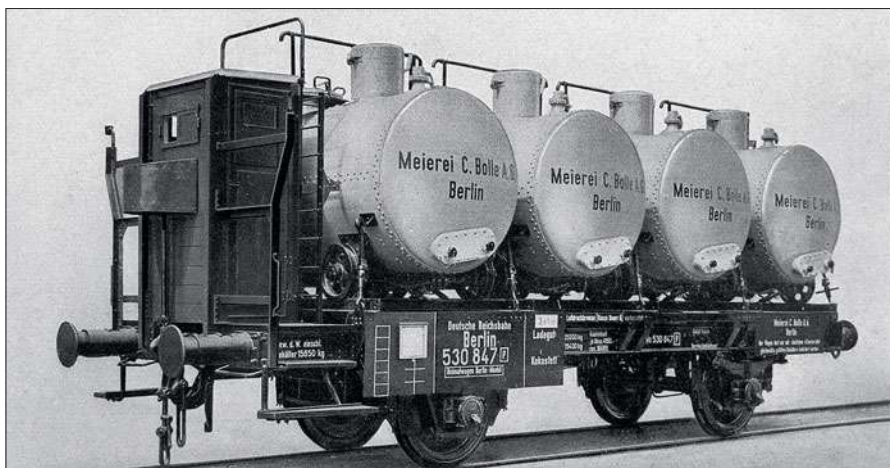
Aufnahmen der Wagen sind rar. Auf diesem Foto sind die Befestigungen der vier Behälter und die Führungsschienen gut zu sehen. Foto: Slg. S. Carstens
