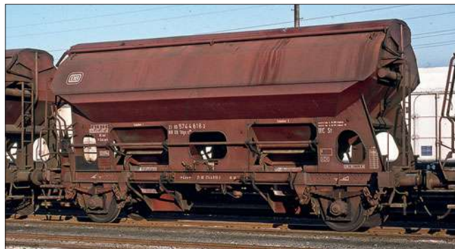
Während DWM die Stützbleche bis 1969 mit eingeschweißten Blechstreifen verstärkte – links der am 30.6.69 fertiggestellte Tdgs 930 574 1 587 im August desselben Jahres im Rbf Untertürkheim – baute Talbot bereits 1962 Wagen mit gepressten Blechen. Zu ihnen gehörte der am 22.8.62 gelieferte Tdgs 69 Ktmvms 354 366. Fotos: Fritz Willke
