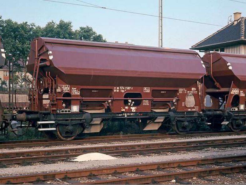
Während DWM die Stützbleche bis 1969 mit eingeschweißten Blechstreifen verstärkte – links der am 30.6.69 fertiggestellte Tdgs 930 574 1 587 im August desselben Jahres im Rbf Untertürkheim – baute Talbot bereits 1962 Wagen mit gepressten Blechen. Zu ihnen gehörte der am 22.8.62 gelieferte Tdgs 69 Ktmvms 354 366. Fotos: Fritz Willke
