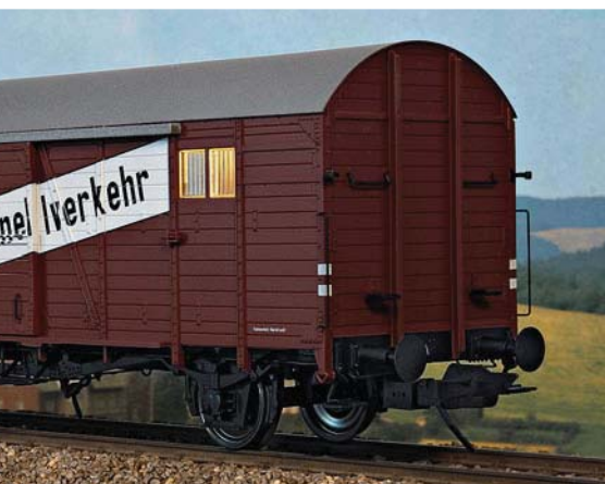
Die „äußere“ Stirnseite des Gllh 12. Am anderen Ende hat der Wagen einen Kurzkupplungskopf mit kurzem Kupplungshaken. Fotos: gp
