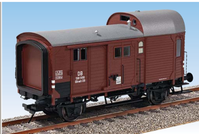
Faltenbalgseite des Gllvwh 08 mit anderer Fenstereinteilung durch das Abortabteil und das hochgesetzte Zugführerabteil
