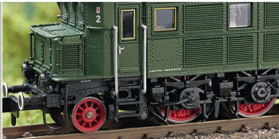
Zwischen den Radsätzen sind Sandkästen, Sandfallrohre und verschiedene Leitungen nachgebildet. Auch ist das Bremsgestänge zu erkennen. Fotos: gp
