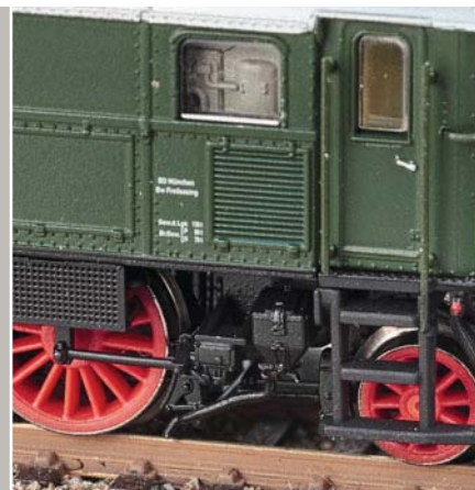
Feingestaltet zeigt sich die Sifa unter dem Führerstand 1.
