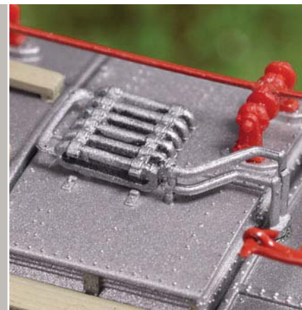
Fein detaillierter Zwischenkühler auf dem Dach der E 17.
