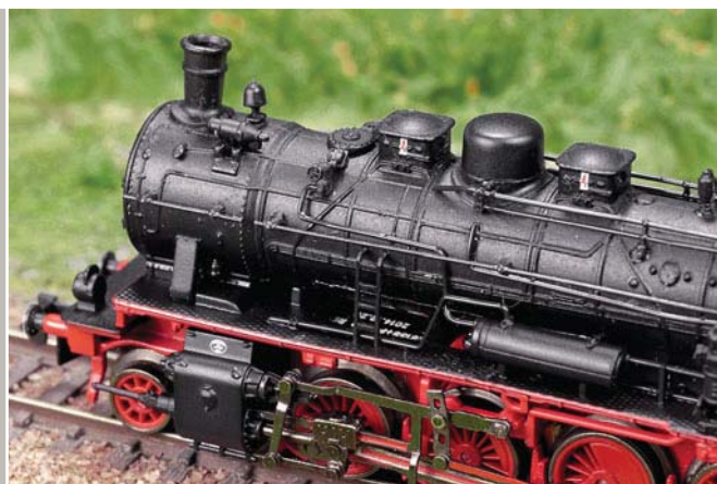
Freistehende Griffstangen, Bedienungsstangen, angesetzte Ventile, Generator und Glocken zieren den Kessel.
