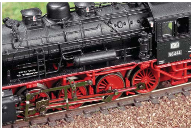
Vorwärmer, Speisepumpe und Leiter zum vorderen Sandkasten schmücken den Umlauf auf der Heizerseite.
