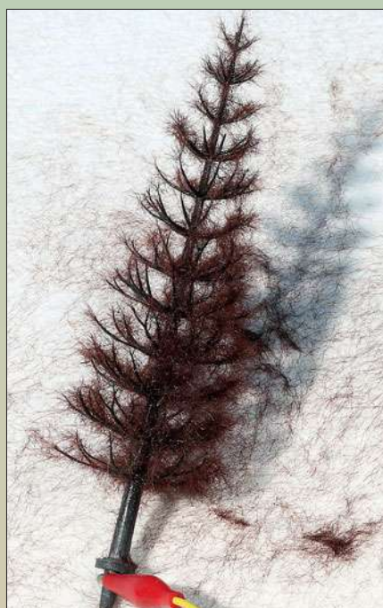
Nach dem Einsprühen des Nadelbaumrohlings mit dem Spezialkleber wird eine erste Schicht mit längeren Fasern mit dem elektrostatischen Begrausungsgerät auf das Astgeflecht des Baues aufgebracht.
