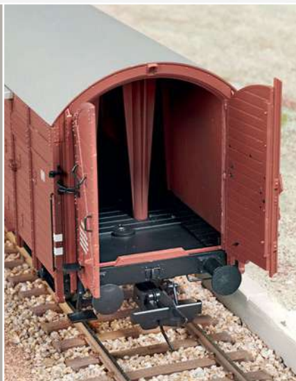
Der Glt 23 besitzt vorbildgerecht 11-lagige Blattfedernachbildungen mit den bis 1935 kurzen Blattfedern von 1100 mm Länge.
