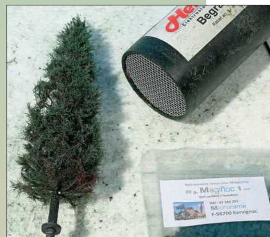
Im zweiten Arbeitsschritt erfolgt das „Benadeln“ der Zweige mit den deutlich kürzeren und feineren grünen Fasern. Dabei muss man etwas vorsichtig vorgehen, denn Fasern werden schnell zu dicht und verklumpen.
