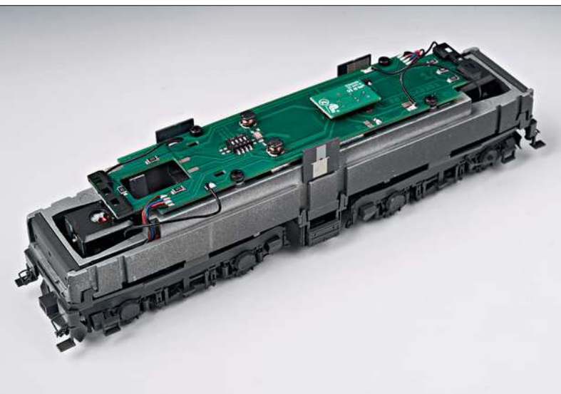
Die Getriebekette der Roco-1041. Die Stromabnahme erfolgt mit oben aufliegenden Radschleifern über alle Achsen.
