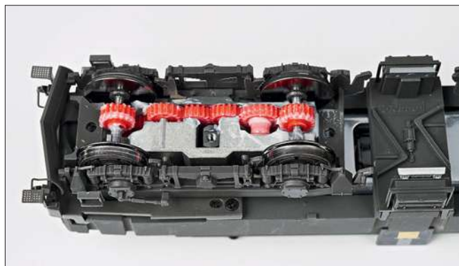
Die Getriebekette der Roco-1041. Die Stromabnahme erfolgt mit oben aufliegenden Radschleifern über alle Achsen.
