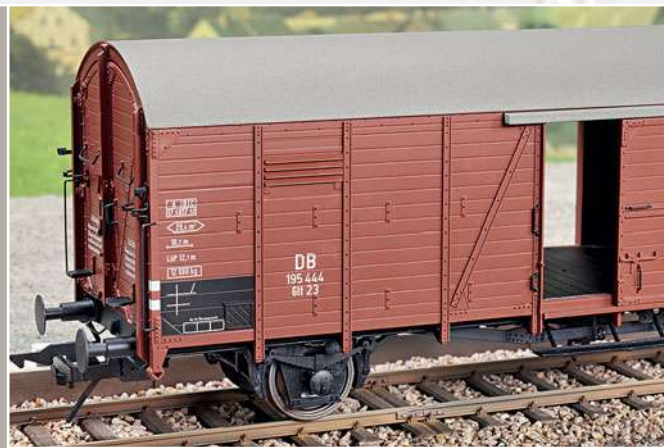
Der Glt 23 besitzt vorbildgerecht 11-lagige Blattfedernachbildungen mit den bis 1935 kurzen Blattfedern von 1100 mm Länge.
