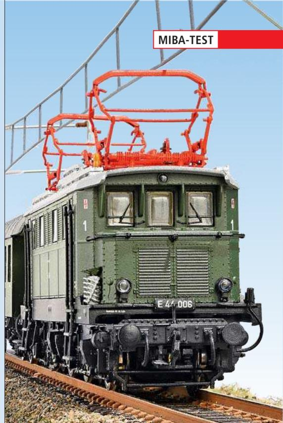
Griffstangen am Vorbau, die Aufstiegsleitern, die Heizleitung oder auch der Zwischenkühler für den Kompressor. An dieser Stelle sei vermerkt, dass sich das Gehäuse aus mehreren Formteilen wie Dach, Vorbauten und Rahmen zusammensetzt.
