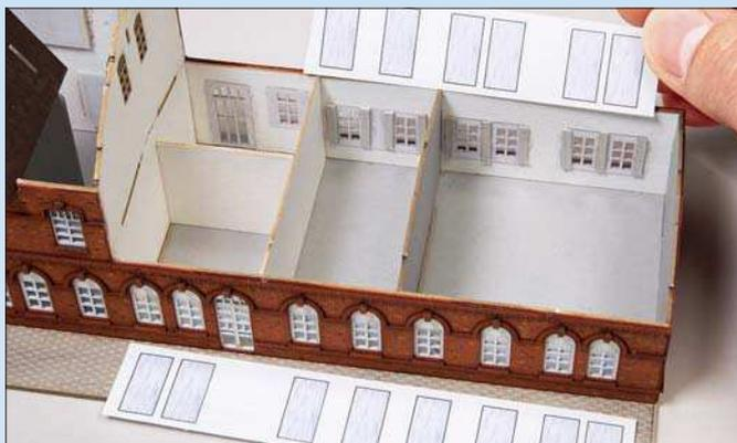
Am PC wurden mit einem Grafikprogramm Gardinen angelegt, ausgedruckt und von hinten mit 1 mm Abstand zur Wand aufgeklebt.
