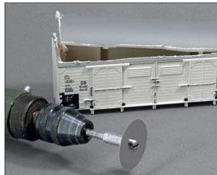
**Oben und links: Für den Umbau zu einem Wagen mit Blechdach wird das Dach mit der Kreissäge herausgetrennt und anschließend alle Kanten bis zur Höhe der Wandoberkanten abgetragen und sauber verschliffen.**
