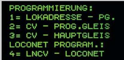
Neben der unabdingbaren CV-Programmierung können auch Loconet-CVs mit der Smartcontrol Light eingestellt werden.
