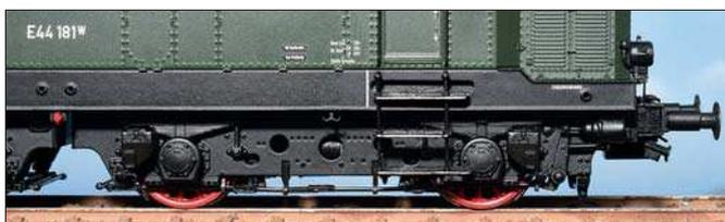
Die Drehgestelle sind auch von unten eine Augenweide. Exakt nach Vorbild sind Drehzapfen, Luftbehälter und Tatzlagermotoren nachgebildet.
