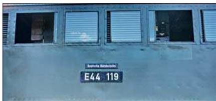
Typisch für die E 44 waren die Schiebefenster auf der Gangseite des Maschinenraums, die hier für den Fotografen extra alle geöffnet wurden. Foto: bz
