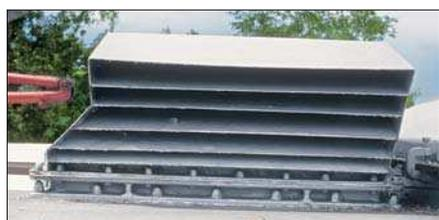
Das Lüftungsschema der E 44 mit Widerstandsbremse verdeutlicht das aufwendige Lüftungssystem, dessen Entlüftungsaufsätze wegen der Nähe der Stromabnehmer eine besondere Form bekamen (links). Abb: Slg. bz
