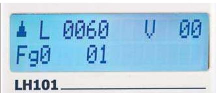
Sinnvoll ist die Fahrrichtungsanzeige durch einen nach oben oder unten gerichteten Pfeil (nach oben zeigend bedeutet Vorwärts). Das Display zeigt den normalen Fahrmodus an (fehlender Punkt links neben dem „V“).
