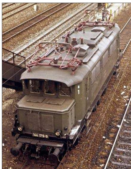
Links: Blick auf das Dach der 144 179 an der Donnersbergerbrücke in München. Der vordere Vorbau hat auf der Oberseite zwei Revisionsklappen. Foto: bz
