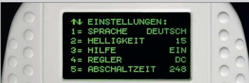
Der allgemeine Menüpunkt „Einstellungen“ ermöglicht die detaillierte Konfiguration des Handreglers. Interessant ist dabei der Punkt 4. Im DC-Betrieb wird die Fahrtrichtung durch die Drehrichtung des Impulsgebers definiert. Schaltet man um auf AC-Betrieb wird die Fahrtrichtung durch Drücken des Impulsgebers gewechselt. Fotos: gg
