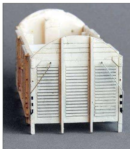
**Auch an der Stirnseite sind neue Griffstangen anzubringen. Anschließend folgen noch Signalstützen und beim gewählten Vorbild außerdem die Kuppung für eine elektrische Heizleitung.**
