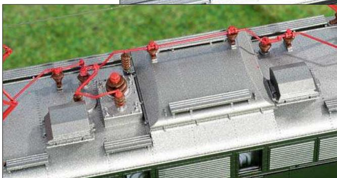
Links das Dach der E 44 181W. Auffällig ist die andere Form von Trafohaube, Hauptschalter und Leitungsführung. Loks mit Widerstandsbremse haben zudem zwei große Entlüftungsaufsätze.
