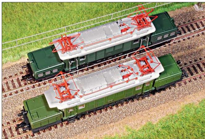
ÖBB- und DB-Version aus der Vogelperspektive: Die Laufsteg- und Dachleitungen unterscheiden sich genauso wie die Hauben der Bremswiderstände mit unterschiedlich ausgeführten Ausblasöffnungen. Bei der E 94 in DB-Version wurde das verlängerte Dach vorbildgerecht umgesetzt.
