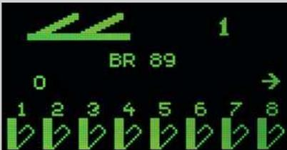
Die Fahrstraßensteuerung wird durch ein Symbol visualisiert. Fahrstraßen können von einer Intellibox übernommen werden.
