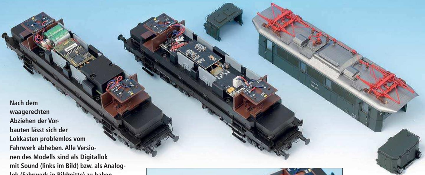
Nach dem waagerechten Abziehen der Vorbauten lässt sich der Lokkasten problemlos vom Fahrwerk abheben. Alle Versionen des Modells sind als Digitallokok mit Sound (links im Bild) bzw. als Analoglokok (Fahrwerk in Bildmitte) zu haben.
