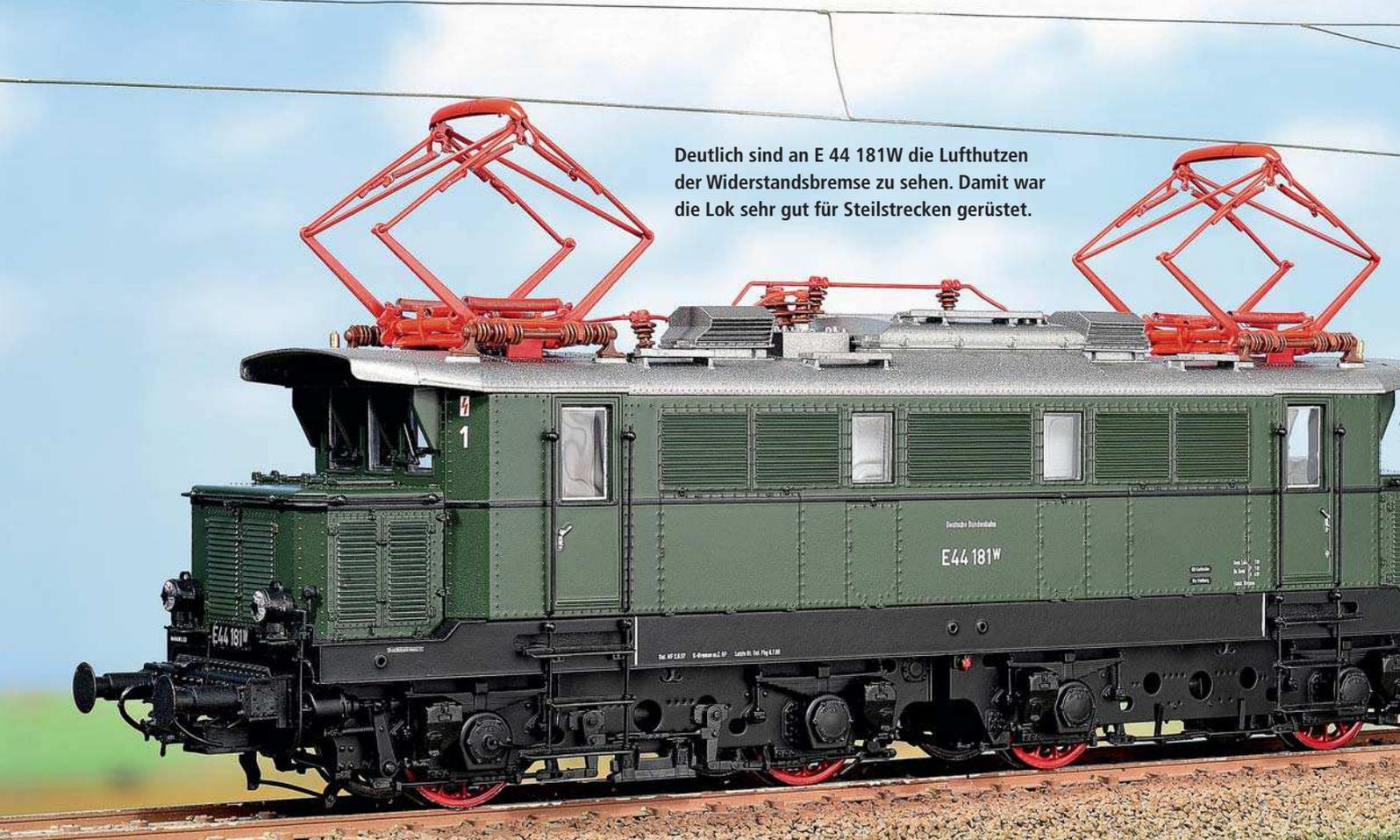
Deutlich sind an E 44 181W die Lufthutzen der Widerstandsbremse zu sehen. Damit war die Lok sehr gut für Steilstrecken gerüstet.
