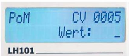
Bekannt ist die Funktion des Programmierens während des Betriebs (PoM), die durch die Menüführung etwas übersichtlicher ist als beim LH100. Das Einlesen der CV-Werte während des Betriebs ist nicht möglich.
