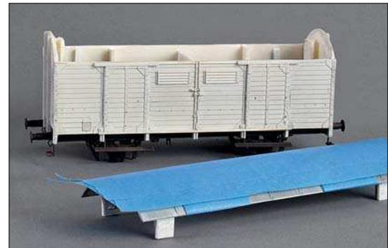
**Zur Andeutung des auf den Vorbildfotos zu erkennenden Farbnebels wird das Dach partiell abgeklebt und vorsichtig mit weißer Farbe angesprüht.**
