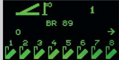
Das Steuern von Magnetartikeln funktioniert über diesen Bildschirm, unten die Zuordnung zwischen Weichen und Tasten.
