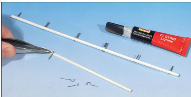
Beim gleichen Anbieter fand sich passendes Rundmaterial. Zur Verdeutlichung der Biegetechnik ist ein noch nicht abgelängtes Fallrohr zu sehen, wie es mit dem LötKolben erwärmt und gebogen wurde.
