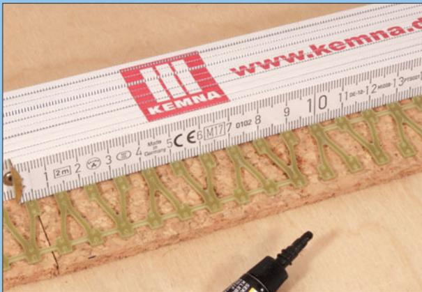
Mit Sekundenkleber können die Schwellenroste auf den Unterbau, der hier aus einer Korkschiicht besteht, aufgeklebt werden. Um ein ebenes Gleis zu erhalten, empfiehlt es sich, die Schwellen bis zum Abbinden des Klebers von oben gleichmäßig zu belasten.
