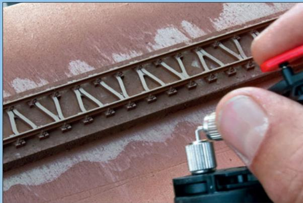
Der komplette Oberbau wurde hier mit einer Airbrush-Pistole in einem rostbraunen Farbton lackiert. Der dünne Farbauftrag verdeckt nicht die winzigen Details.
