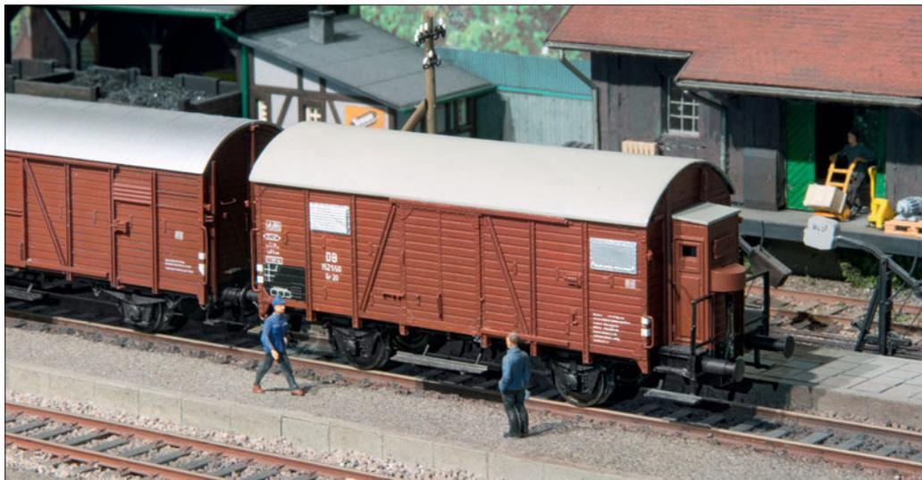
Unser Fleischmann Gr 20 entstammt der alten Einfachserie, hat aber ein neues Untergestell und ein Weinert-Bremserhaus. Wir haben zum Einbau der neuen Klappen bewusst eine „alte Gurke“ verwendet, um zu zeigen, dass auch solche Wagen optisch aufgewertet werden können. Wer das Modell perfektionieren möchte, schabt zusätzlich die Konterplatten der Bindeösen ab und ritzt dort die Bretterfugen nach. *Modellbau und Foto: Christoph von Neumann, SC*
