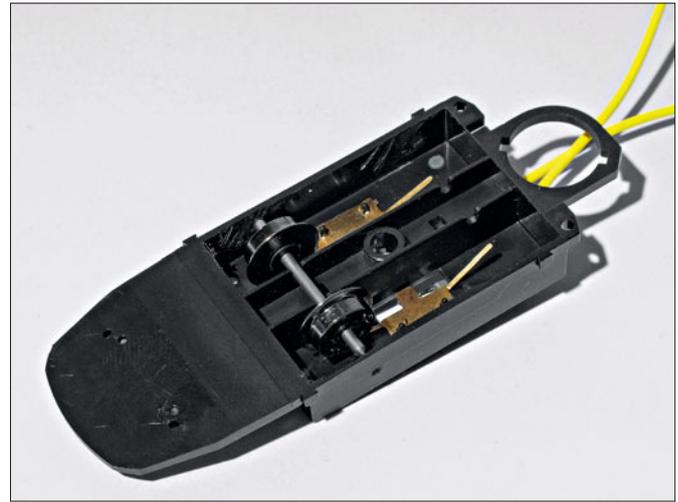
In die Fahrgestelle werden Federn zur Stromabnahme eingebaut. An den Innenseiten muss etwas nachgearbeitet werden.
