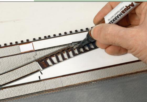
In gleicher Weise werden auch die Weichen mit den genannten Bauteilen bestückt; die Radlenker sind zuvor zu entfernen. Bei Einkleben der Gleiseinlagen ist sowohl bei den Gleisen, als noch im besonderen Maße bei den Weichen auf Einhaltung der Rollräume für die Spurkränze zu achten. Ein Griffel (zum Anreiben von Buchstaben etc.) ist bei der Montage und hier insbesondere bei der exakten Ausrichtung der Einlagen hilfreich. Auch ein Waggon sollte zur Überprüfung der Rollräume stets vorhanden sein.
