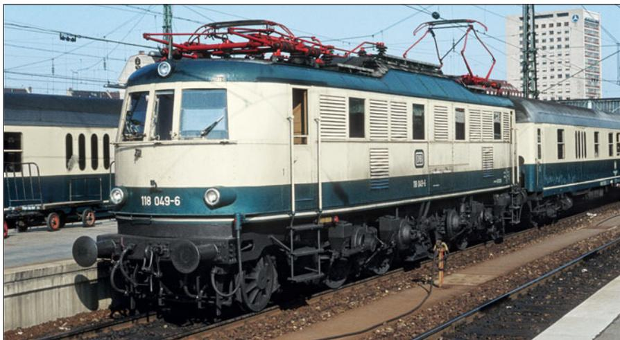
gab es Brüche an den aus Leichtmetall bestehenden Oberscheren; sie wurden in der Folge durch eine Ausführung aus Stahl ersetzt, weshalb zusätzliche Ausgleichsfedern notwendig wurden.
