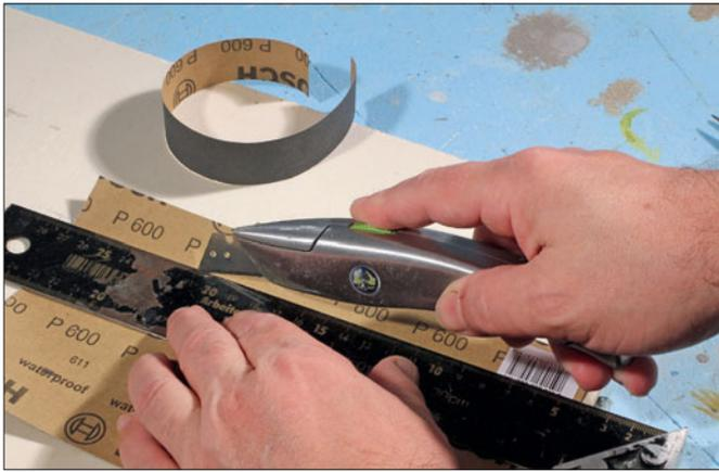
Das 600er-Schleifpapier ist der ideale Werkstoff zum Nachbilden von Dachpappe. Die Streifen werden mit einem Cutter abgetrennt. Im Original sind die Rollen 1 m breit; dies entspricht 22,2 mm in 1:45.
