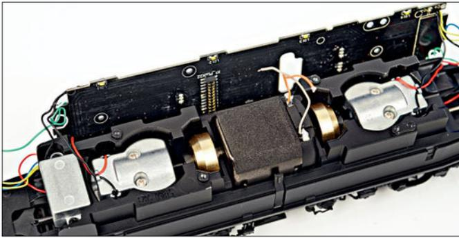
Der Motor ist wie immer bei Piko sehr kontaktsicher über Kabel angeschlossen. Er trägt an beiden Wellenenden kleine Schwungmassen. Über kurze Kardanwellen werden die Schneckengetriebe erreicht.
