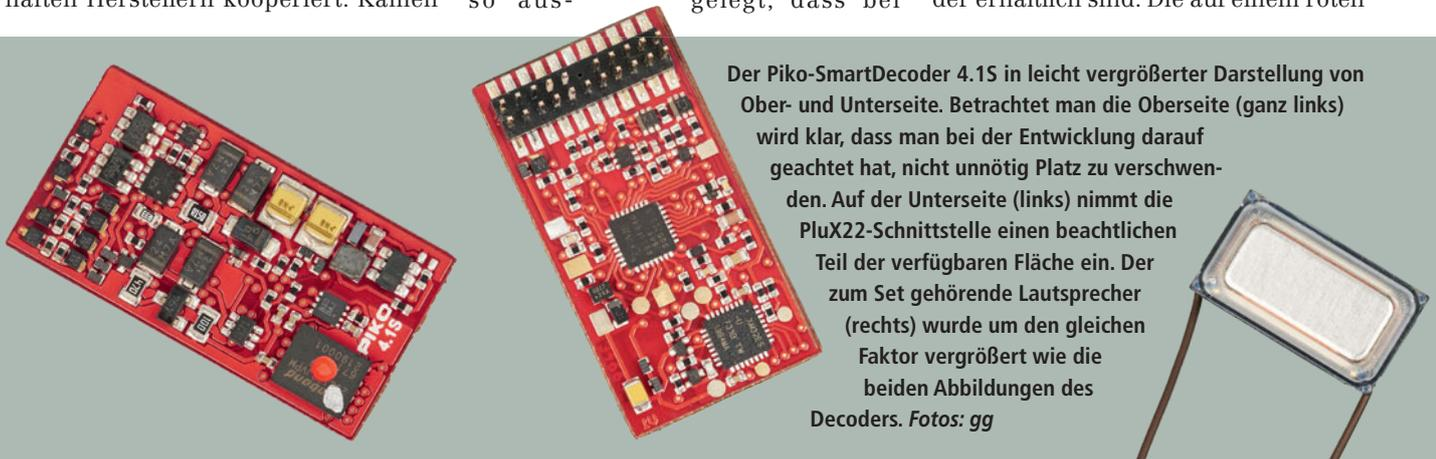
Der Piko-SmartDecoder 4.1S in leicht vergrößerter Darstellung von Ober- und Unterseite. Betrachtet man die Oberseite (ganz links) wird klar, dass man bei der Entwicklung darauf geachtet hat, nicht unnötig Platz zu verschwenden. Auf der Unterseite (links) nimmt die PluX22-Schnittstelle einen beachtlichen Teil der verfügbaren Fläche ein. Der zum Set gehörende Lautsprecher (rechts) wurde um den gleichen Faktor vergrößert wie die beiden Abbildungen des Decoders. Fotos: gg
