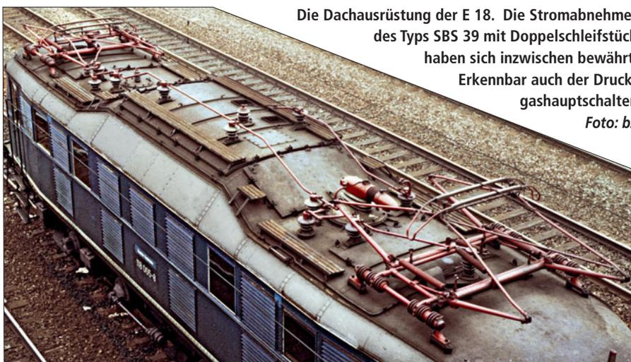
Die Dachrüstung der E 18. Die Stromabnehmer des Typs SBS 39 mit Doppelschleifstück haben sich inzwischen bewährt. Erkennbar auch der Druckgashauptschalter. Foto: bz
