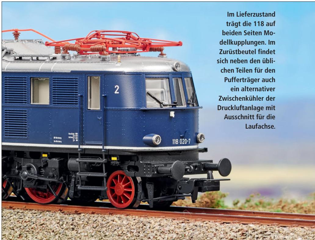
Im Lieferzustand trägt die 118 auf beiden Seiten Modellkupplungen. Im Zurüstbeutel findet sich neben den üblichen Teilen für den Pufferträger auch ein alternativer Zwischenkühler der Druckluftanlage mit Ausschnitt für die Laufachse.
