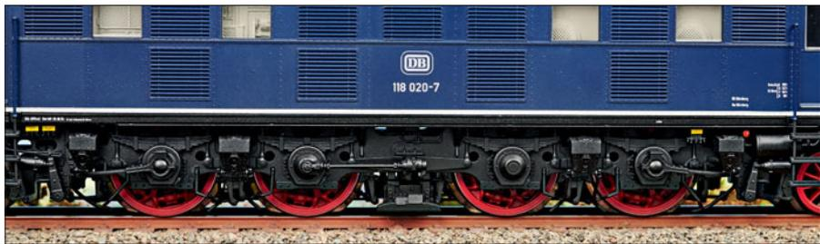
Das Fahrwerk von der rechten Seite. Separat angesetzt sieht man mittig den Fliehkraftbremsdruckregler mit seiner Antriebswelle, darunter den Indusi-Magneten und die beiden Lenkbügel. Alle Sandkästen sind ebenfalls separat angesetzt.
