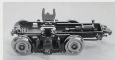
Die Rollböcke sind komplett aus Messing hergestellt. Die Achsen lagern in POM-Buchsen und drehen extrem leicht. 9 mm RP25-Radscheiben entsprechen dem 400 mm Originalrad.
