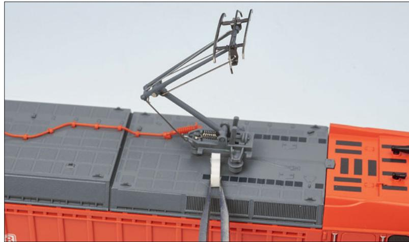
Bei Scherenstromabnehmern wird der Fixer auf die untere Querstrebe gesteckt. Um den Federweg zu definieren wird das Bauteil unten gekürzt. Im Beispiel wurde eine Lok von Piko verwendet. Die Version für Piko-Einholmpantographen wird von unten eingeklippt, was etwas Fingerspitzengefühl erfordert. Wer sich dies nicht zutraut, sollte den Stromabnehmer vorher demontieren. Fotos: gg
