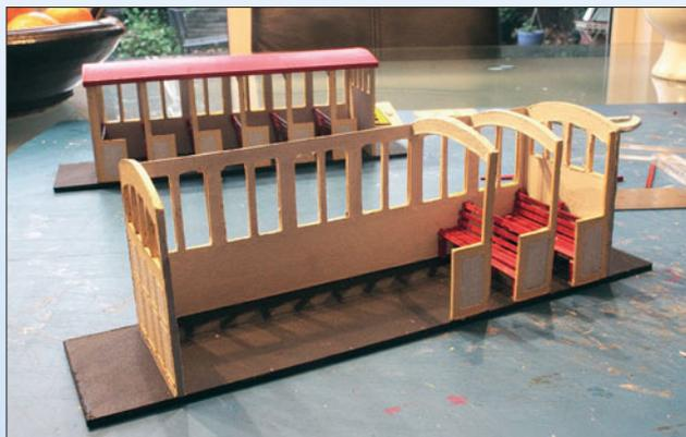
Beim vollständigen Selbstbau der beiden Kabinenwagen wurden Hartkarton und Acrylglas verwendet. Auch die erhabenen Partien der Wagenkästen ließen sich mit Kartonstreifen nachbilden.
