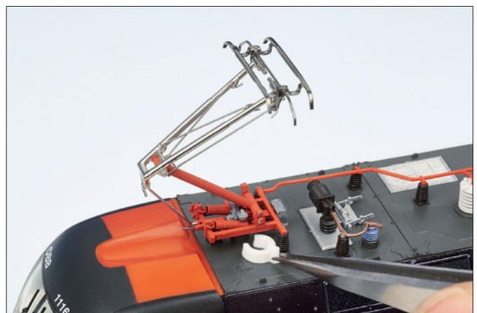
Der Fixer vom Typ A wird an die Befestigungsschraube geklippt. Die Scherfläche ist gegebenenfalls in der Höhe anzupassen.
