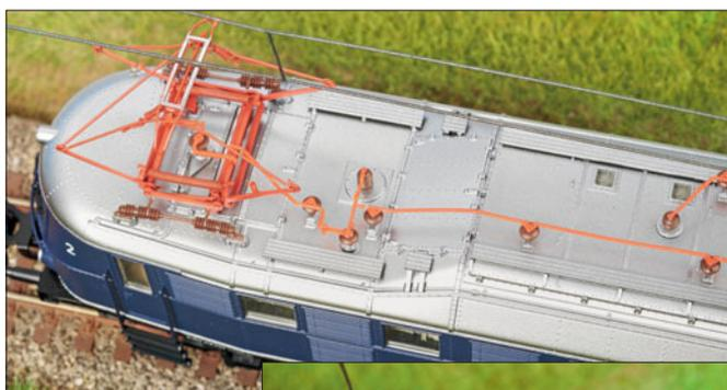
Der Pantograph ist auch aus der Draufsicht äußerst vorbildgerecht. In bester Gravur sind der Drehisolator-Antrieb, der Dachtrennschalter und der Oberspannungswandler nachgebildet.
