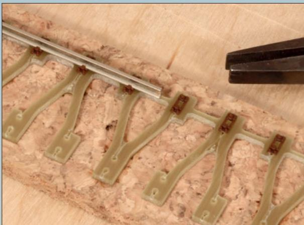
Vorsichtig werden die Schienenprofile in die Kleineisen eingefädelt. Da dies nicht allzuschwer geht, sollte man wenn möglich auf den Einsatz einer Zange verzichten. Falls dies dennoch erforderlich werden sollte, muss man darauf achten, dass die Kleineisen nicht beschädigt werden.
