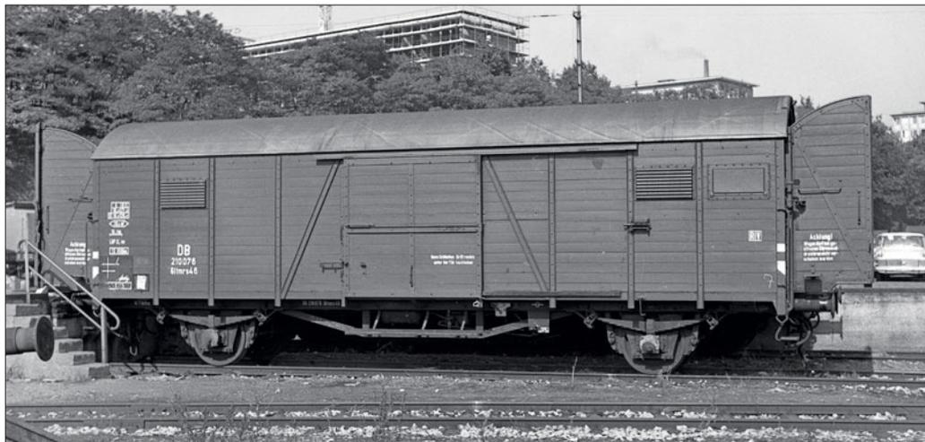
tungsklappen nach links in die Endfelder. Auch bei den Gl(t)-Bauarten gab es viele unterschiedliche Ausführungen: Von zwei bis vier Klappen auf jeder Seite in den unterschiedlichsten Positionen war alles vertreten. Hingegen behielt man bei Gm(rh)s 30 und Gm(h)s 35 – wobei auch 1949/50 neu gebaute Wagen solche Klappen erhielten – die alten Positionen bei.
