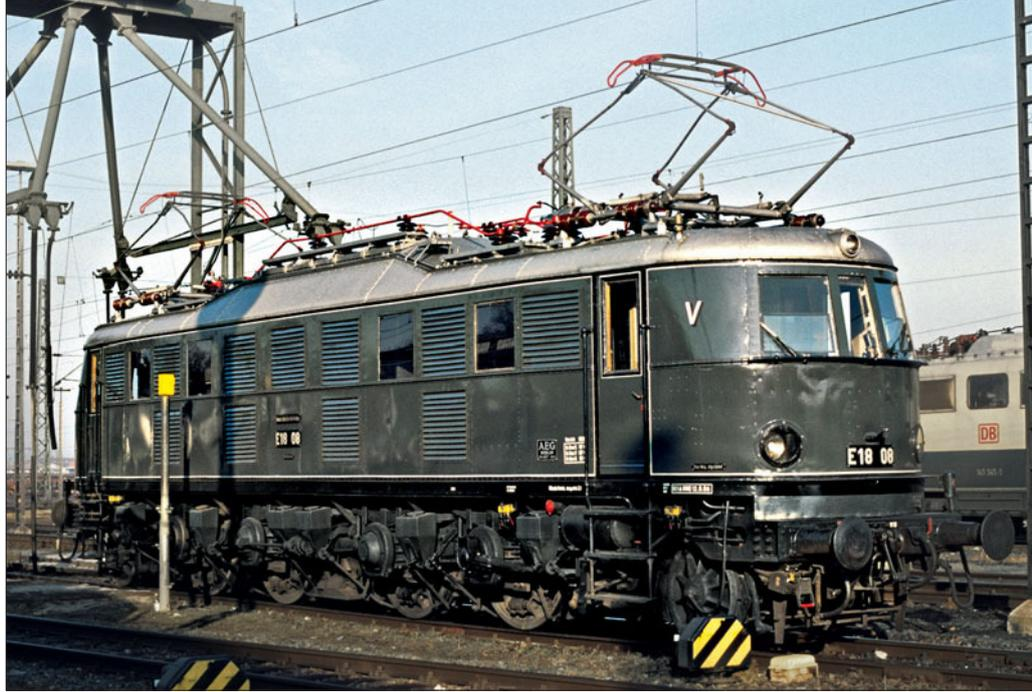
Anlässlich des 150-jährigen Jubiläums der Eisenbahn in Deutschland wurde die Maschine weitgehend zurückversetzt in den Zustand der Epoche II: Neben der ursprünglichen Beschriftung sind dies vor allem die grau erscheinende Lackierung in RAL 4h, feine Zierlinien und alte Lampen. Augenfällig ist das Fehlen der ursprünglichen Frontschürze und das Vorhandensein des nachträglich angebauten Indusi-Magneten. Foto: bz
