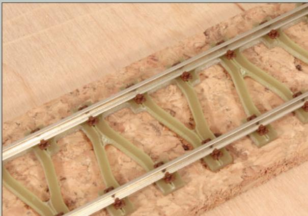
Der fertige Oberbau vor der Lackierung. Auf den Schwellen sind alle Kleineisen montiert. Beim Einfädeln der Schwellen sollte natürlich möglichst keine Schienenbefestigung ausgelassen werden ...
