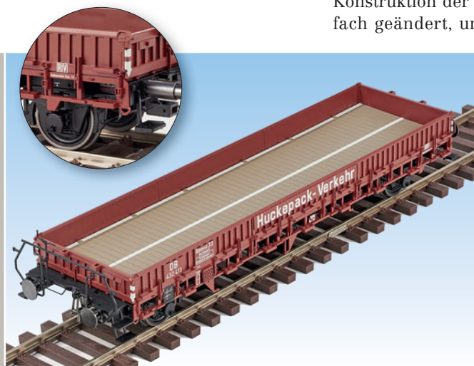
Variante des Rmms 33 als Rmms 33 für den Huckepackverkehr in Ausführung der Epoche III mit Bremserbühne und Stahlklappen
