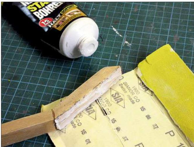
Um die Pflasterfläche plan zu schleifen, wurde ein speziell verwendbares, handliches Werkzeug für Schleifpapier angefertigt.
