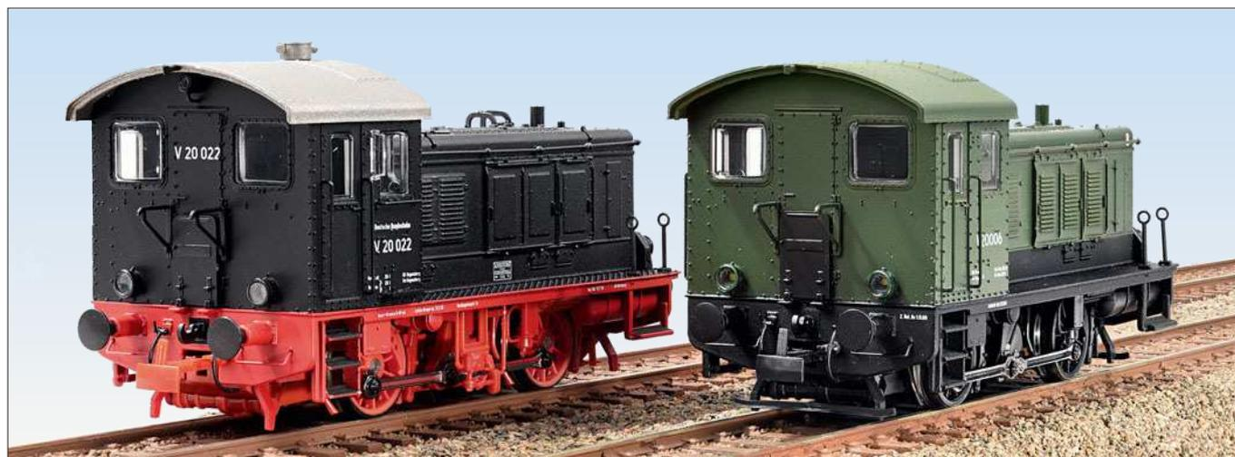
Beim Vergleich der beiden Probanden fällt weiter auf, dass der Umlauf der DB-Maschine über eine Noppenstruktur verfügt, während die DR-Version einen glatten Umlauf zeigt. Zudem hat die DB-Lok unter dem Umlauf noch das Sifa-Gerät. Fotos: gp
