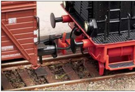
Die elektromagnetisch arbeitende Rangierkupplung bietet durch das Absenken des Kupplungshakens die Funktion des An- und Abkuppelns. In beiden Fällen wird der Kupplungshaken über die Tasten F1 oder F2 abgesenkt und die Lok entweder langsam an den Wagen weg- oder herangefahren.
