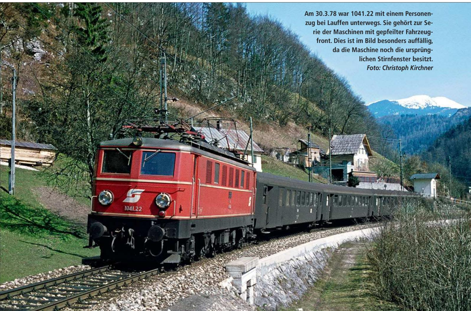
Am 30.3.78 war 1041.22 mit einem Personenzug bei Lauffen unterwegs. Sie gehört zur Serie der Maschinen mit gepfeilter Fahrzeugfront. Dies ist im Bild besonders auffällig, da die Maschine noch die ursprünglichen Stirnfenster besitzt.
