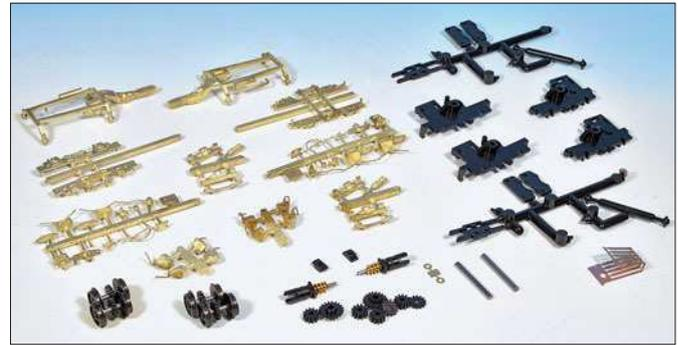
Der Bausatz besteht im Wesentlichen aus einem Weißmetall-Fahrwerk, geätzten Seitenwänden und einem Kunststoffdach. Der Faulhaber-Motor sorgt zusammen mit dem gut abgestuften Getriebe für beste Fahreigenschaften. Rechts oben die Messingguss-Details. Rechts: Weil man durch die großen Fensterflächen bestens in den Triebwagen hineinschauen kann, sollte die Inneneinrichtung unbedingt verwendet werden.
