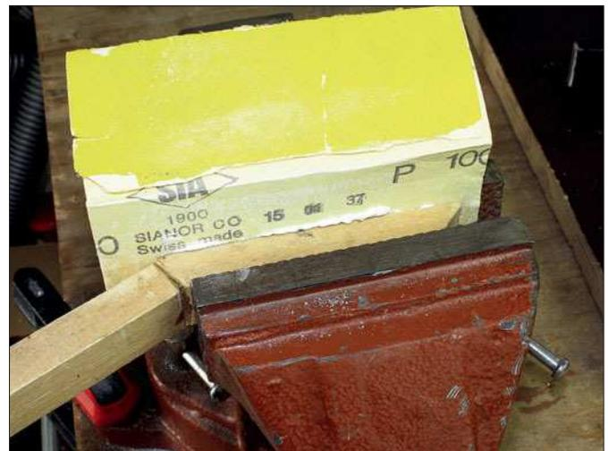
Da die Schleifpapierauflage fest und sicher sitzen muss, wurden Montagekleber und ein Schraubstock zum Anpressen eingesetzt.
