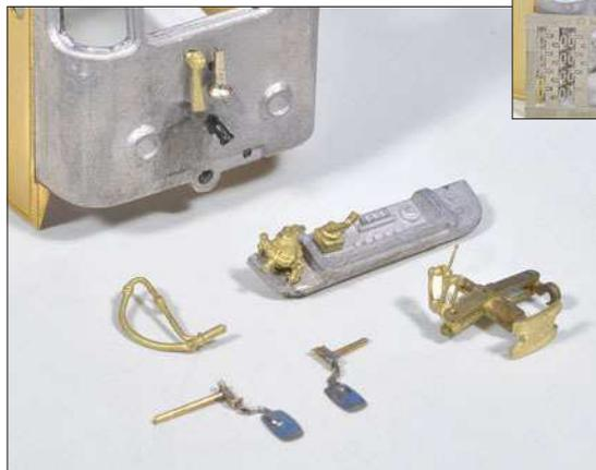
Links: Frontdetails und Führerpulte können erst nach der Lackierung montiert werden, um das Abkleben nicht zu erschweren. Die Frontsteckdose stammt aus dem Zurüstsatz des VT 70 von Tillig, die zweite Fanfare von Weinert (4362, gekürzt). Oben die passenden Griffe aus dem Ätzblech von AW Lingen.
