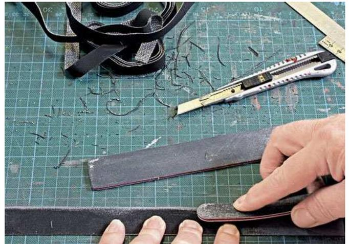
Wo sie direkt am Gleis zu liegen kommen, sollten die Kanten der Oberflächen-Strukturmatte leicht schräg angeschliffen werden.
