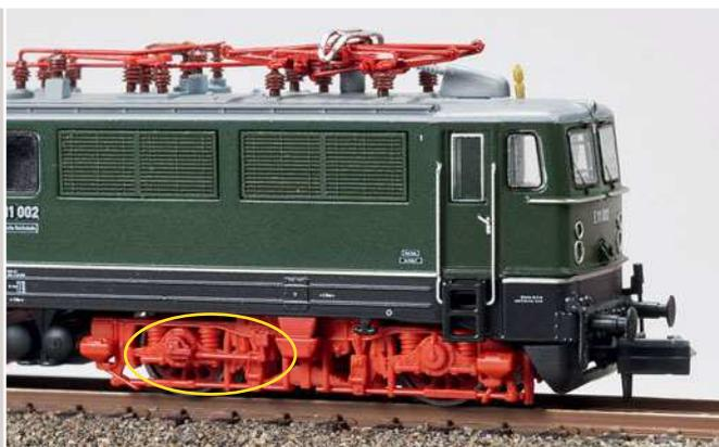
Die E 11 zeigt sich mit Schürze, Kuppelsteckdose der Mehrfachsteuerung und einem Fliehkraftbremsdruckregler.
