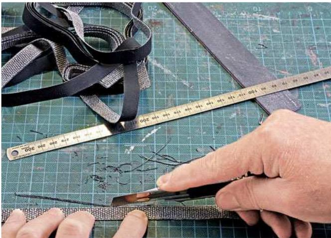
Die Pflaster-Gleisfüllung von CH-Kreativ (Artikel-Nr. SPH0017) muss an den Rändern gemäß Pflastermuster exakt beschnitten werden.
