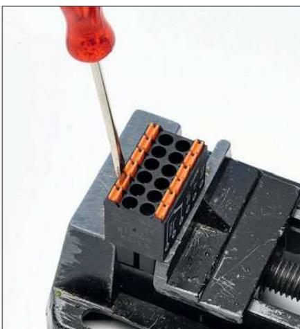
Ein kleiner Schraubstock ist eine praktische Hilfe beim Fixieren der Leitungen im Steckverbinder. Fotos: ip
