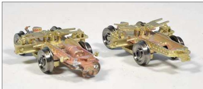
Die Gabeln liegen auf kleinen Stegen rechts und links vom Scharnier. Damit sie waagrecht liegen (linker Rollbock), sollten die Stege um ein paar Zehntel-millimeter niedriger gefeilt werden.
