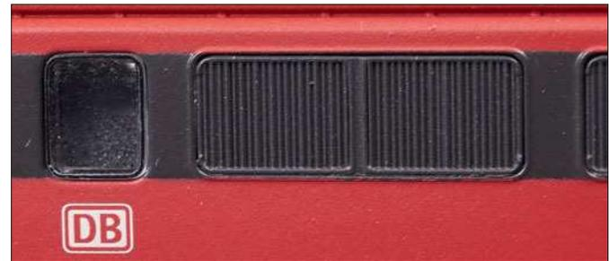
die Gestaltung der Dachhauben unterscheiden. Die Dachhauben der 142 besitzen Sicken zur Stabilisierung und sind im mittleren Bereich etwas anders eingeteilt. Die Zugösen sind bei beiden angedeutet. Während die Vorserienloks noch Druckluftpfeifen über dem Führerstand hat, sind die Serienloks wie die 142 mit Typhonen ausgerüstet.
