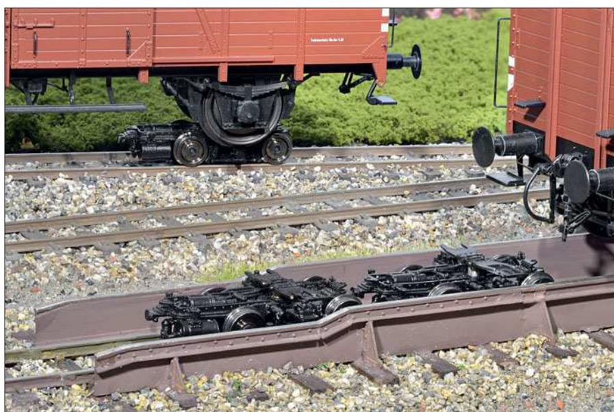
**70** Schon viele Tüftler haben mit unterschiedlichsten Konstruktionen versucht, das Aufschemeln von O-Güterwagen zu bewerkstelligen: Heb- und senkbares Grubengleis, zu hohe Grube mit doppelter Stufe oder eine geneigte Gleislage – alles nicht ideal. Der Spur-0-Spezialist Schnellenkamp bietet nun ein System an, das optisch sehr dicht am Vorbild ist und tadellos funktioniert. Martin Knaden stellt Rollböcke und Grube vor. *Foto: MK*
