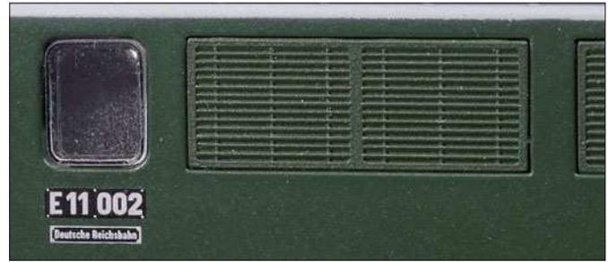
Sowohl die waagerechten Mehrfachdüsengitter der Vorserienloks wie auch die senkrechte Variante der Gitter präsentieren sich sehr fein graviert und zeigen zudem die unterschiedlichen Ausführungen der Ausschnitte bzw. Art der Einfassung.
