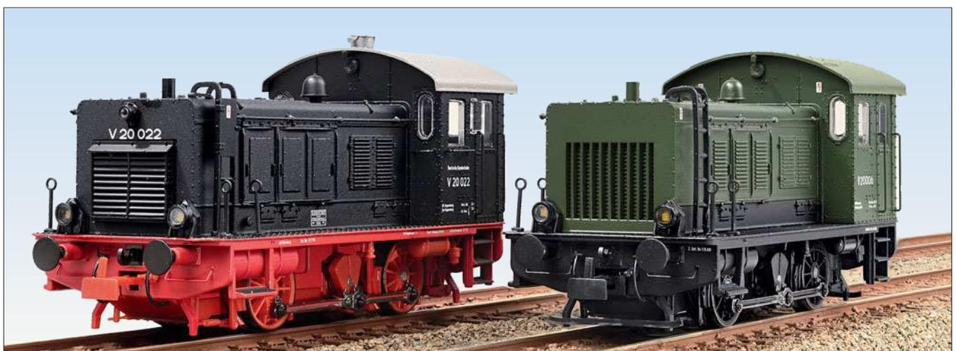
Die DB- und DR-Varianten unterscheiden sich hauptsächlich durch die unterschiedlichen Lüftungsöffnungen und durch die seitlichen Klappen am Vorbau. Die DB-V 20 verfügt zudem über die Aufstiegssicherung an der Leiter am Vorbau und über ein drittes Spitzenlicht.
