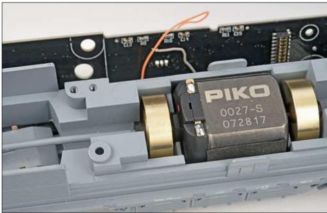
Wie üblich liegt der Piko-Motor in Längsrichtung im Fahrwerk. Lange, bei diesem Modell vergleichsweise dünne Kardanwellen sorgen für die Kraftübertragung zu den gekapselten Getrieben der Drehstelle.
