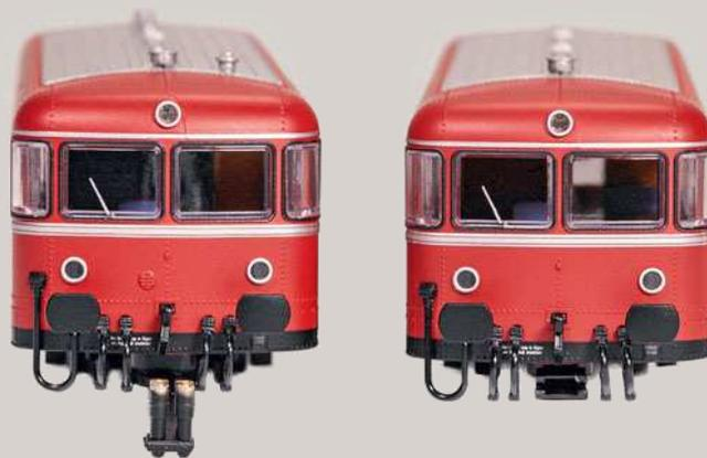
Die elektrisch leitende starre Kupplung (links) kann gegen Kupplungsaufnahmeschächte (rechts) getauscht werden.
