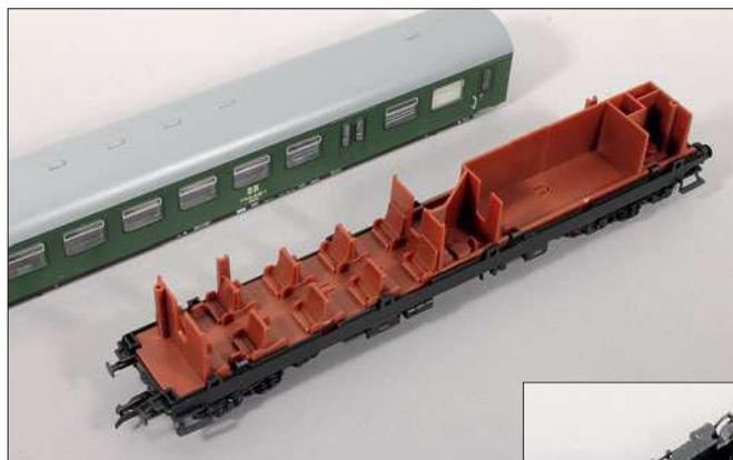
Links: Durch vorsichtiges Abstreifen der Seitenwände lassen sich die Wagenkästen abheben, hier beim Halbgepäckwagen BDghwse, der auch mit seiner korrekten Innenaufteilung überzeugt.
