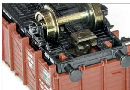
Links: Die kleine Kunststofffeder in der Kuppungsaufnahme soll dafür sorgen, dass sich die Kupplung bei geschobenen Wagen nicht aufstellt. Im Gegenzug muss aber deren Kraft beim Einkuppeln überwunden werden. Sie kann mit der Schraubenzieherklinge nachgebogen werden, jedoch ist dieser Eingriff schwer zu dosieren und wird leicht irreversibel. Daher ist die Bearbeitung des Kuppungsarms vorzuziehen.
