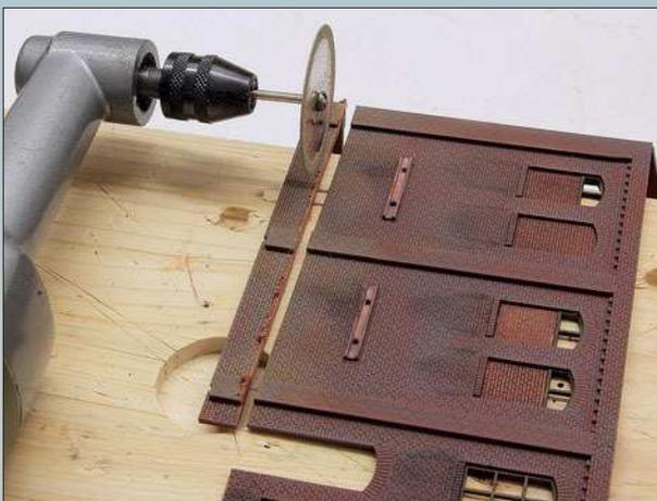
Nachträglich erschien es sinnvoll, den Sockel im zweiten Obergeschoss zu entfernen. Mit dem Proxxon-Winkelschleifer und langsamer Drehzahl ging dies eigentlich ganz gut, ohne etwas zu beschädigen. Besser ist es natürlich, die Bauteile bereits vorher passend zuzuschneiden.
