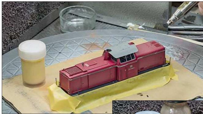
Unser Modell von Roco erhält als Erstes einen lasierenden Überzug mit stark verdünnter „Sandfarbe“. Das Fahrgestell wird zuvor schützend mit Abdeckband abgeklebt.
