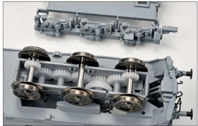
In den Drehstellen sind die jeweils äußeren Achsen angetrieben. Die innere Achse wurde als Laufachse mit Höhenspiel konzipiert. Je Drehgestell unterstützt ein Haftreifen die Zugkraft. Fotos: MK
