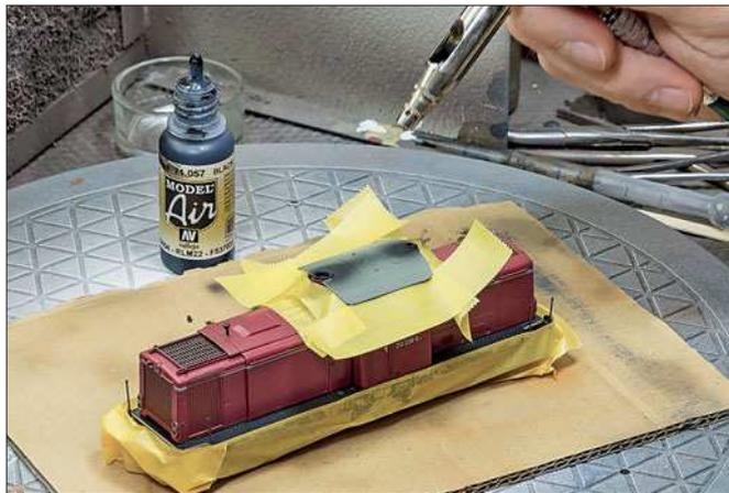
Das Dach erhält mit schwarzer Farbe die für Diesellokomotiven typischen Abgas Spuren am Dach. An den Auspuffrohren selbst kann der Ruß kräftig nachgebildet werden, während die Intensität zu den Seiten hin nachlässt. Auch hier dient wieder Maskierband als Schutz vor ungewollter Einfärbung.
