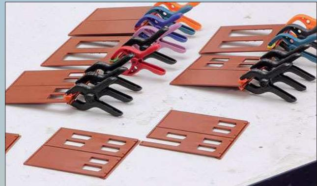
Auf diese Weise können nach und nach die Einzelteile zu Wandsegmenten zusammengeklebt werden. Aus diesen lassen sich dann die größeren Wandteile zusammenfügen.
