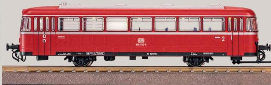
Deichsel verbindet die Fahrzeuge für eine breitere Stromabnahmebasis. Um Schäden vorzubeugen, sollte man aber nur solche Fahrzeugkombinationen zusammensetzen, wie in der Gebrauchsinformation beschrieben. Die Kontaktsicherheit wird zudem durch pendelnd gelagerte Antriebsachsen gesteigert.
