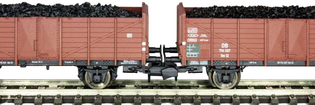
Die SK-Kupplung folgt der Norm NEM 355 bzgl. der Kupplungsaufnahme, kann also bei aktuellen Modellfahrzeugen einfach gegen die dort zu meist verbauten Steckkupplungen getauscht werden. Auch wenn die Unterschiede zur N-Standardkupplung auf den ersten Blick kaum auffallen, so zeigen sich im Betrieb deutliche Unterschiede. Neben der speziellen Form des Kupplungskopfes fällt vor allem der die Öffnung des Kupplungskopfes begrenzende seitliche Riegel und der gekröpfte Kupplungsarm auf.
