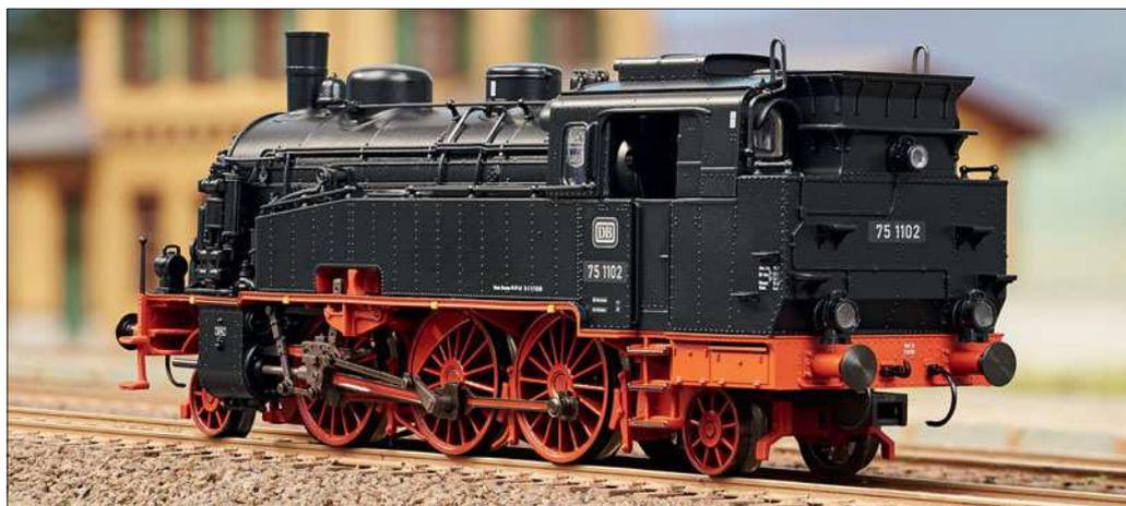
Ein Blickfang am Heck der Maschine sind die Aufstiegsleitern neben dem Kohlenkasten. Den unteren Lampen fehlt die Konsole zur Befestigung. *Fotos: gg*
