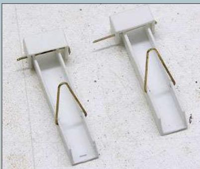
Die Aufhängungen der Schüttbleche wurden einfach aus Messingdraht gebogen. An der Rundung oben habe ich später noch vorbildgerecht kleine Umlenkrollen aus Messing angelötet; sie sind beim Zubehör für den Schiffsmodellbau erhältlich.
