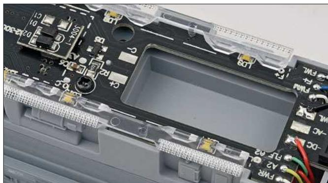
Dieser Freiraum wurde für einen großen Stützkondensator reserviert. Lötspots sorgen für den Anschluss. Auf jeder Platineenseite gibt es sechs LEDs, die über Lichtleitkörper der Maschinenraumbeleuchtung dienen.
