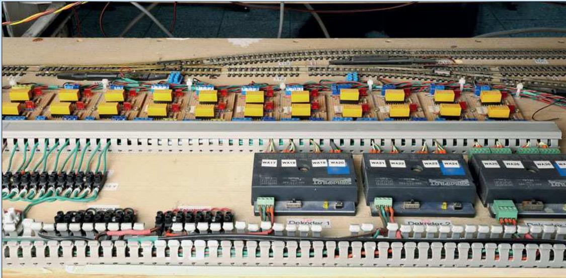
Die alten „stromfressenden“ elektromagnetischen Unterflurweichenantriebe von Roco werden potenzialfrei über die Matsushita-Relais angesteuert; vorn die ESU-Switchpiloten.
