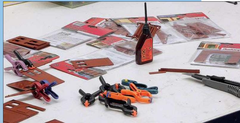
An Werkzeug braucht man nicht viel: Kleber, Cutter, Schneidbrett und ein paar Klammern reichen aus. Die Klammern werden dazu verwendet, um die Bauteile zu fixieren, bis der Kleber ausgehärtet ist. Wenn man sie in dieser Zeit nicht mit der Hand zusammendrücken muss, kann man zwischenteilig weiter bauen und erzielt schnell Fortschritte ...
