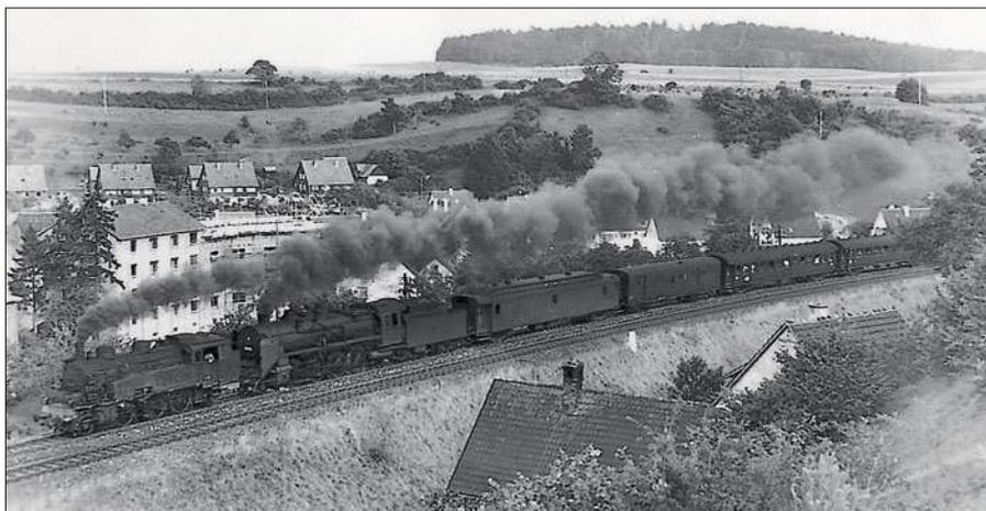
Mit der zweiten Bauserie war auch die Rauchrohr-Überhitzerfläche auf 40,75 m<sup>2</sup> angewachsen. Ab der Reihe 3 (Loknummern 910 bis 923 aus den Baujahren 1916 bis 1917) waren die Maschinen mit stählerner Feuerbüchse ausgestattet.
