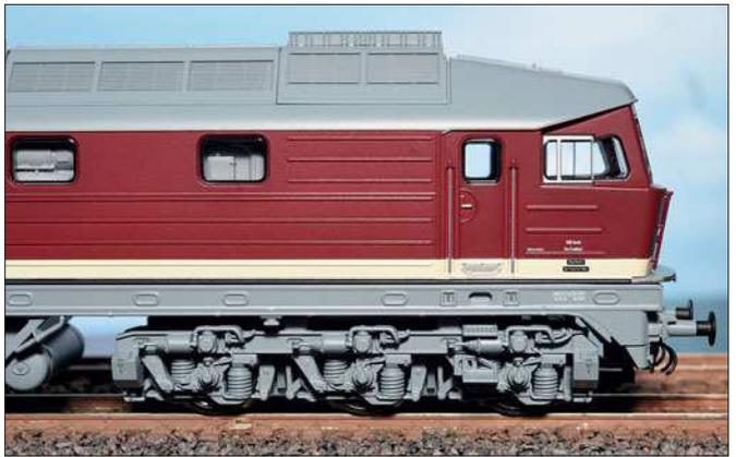
Vorbild. Zwischen den Drehgestellen „hängt“ (wie beim Original deutlich außermittig) der große Tank, an dessen Stirnseiten die zwei Luftbehälter sitzen, während an seinen Außenseiten die Batteriekästen dominieren. Hier Fehler zu suchen ist erfolglos; selbst der Tank-einfüllstutzen samt Tankdeckel mit Sicherung wurde nicht vergessen.
