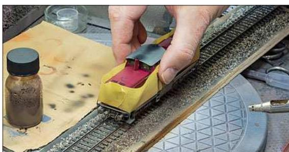
Damit auch die Räder gleichmäßig eingefärbt werden, wird die Lokomotive unter Strom gesetzt. So kann man die Radscheiben lackieren, ohne dass die Seitenwangen der Drehgestelle Teilbereiche abschatten. Man vermeidet so blanke Stellen, welche beim Fahrbetrieb negativ auffallen würden.
