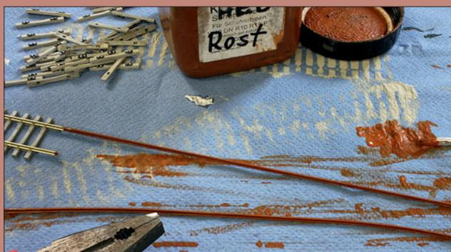
Die beiden entsprechenden Schienenprofile erhalten einen Rostanstrich, der in zwei Schichten aufgetragen werden muss, damit er komplett deckt. Danach biegt man die beiden Gleisstücke in einem sanften Bogen.
