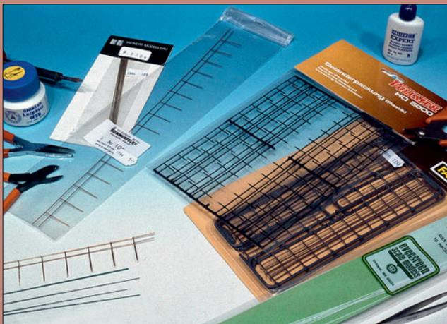
Die „Drängelgitter“ lassen sich aus Materialien diverser Zubehörhersteller bauen. Polystyrol und Messingdraht sind ideale Werkstoffe. Die Kunststoffgeländer lassen sich einfacher zusammenkleben, die Metallteile sind stabiler, müssen aber gelötet werden.
