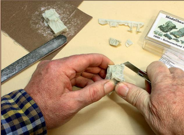
Die Resinteile kommen oft mit Graten und Häuten vom Abgießen aus der Verpackung. Diese gilt es durch Schleifen oder mit dem Bastelmesser zu entfernen. Anschließend sollte ein Entfetten das Rohmaterial empfänglicher für den Farbauftrag machen.
