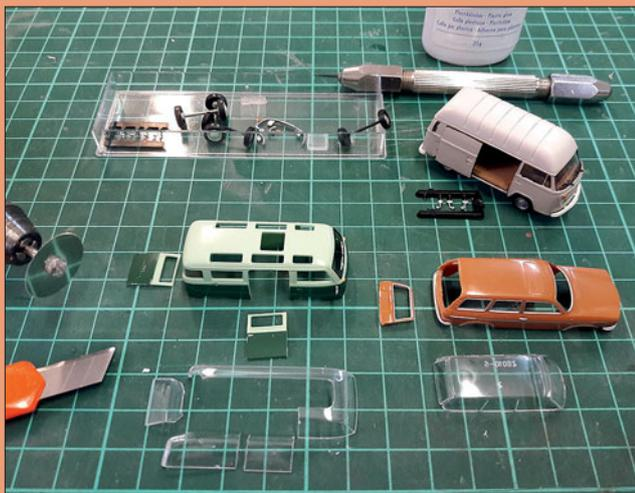
Die diversen Kleintransporter und Kombis mussten vor dem Auftrennen der Heckklappen und Türen zunächst sorgfältig zerlegt werden. Der Trennvorgang mit einem feinen Rundsägeblatt betrifft auch die Verglasung.
