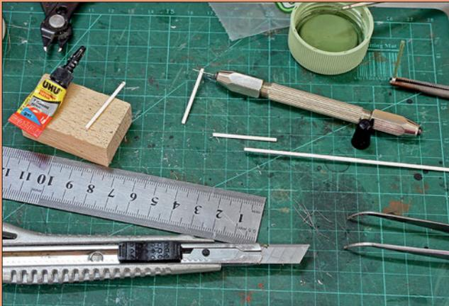
Für eine fortlaufende Wäscheleine im Garten sind zunächst ein paar Pfosten erforderlich. Sie entstehen aus Rundprofilen (Durchmesser von 1,6 mm), die mit einem 0,5-mm-Bohrer aufgebohrt und mit Drahtstückchen kreuzweise bestückt werden.
