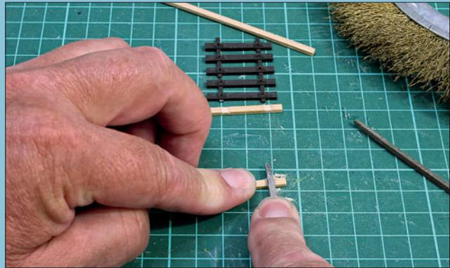
Die abgeflachten Vertiefungen zur Aufnahme der Kleisenplatte werden nach einer vorherigen Markierung mit einer kleinen Vierkantfeile angebracht. Mit einer Drahtbürste lässt sich zusätzlich noch eine vertiefte Holzmaserung in Längsrichtung der Schwelle anbringen.
