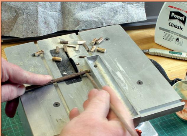
In der Wirkung unübertroffen sind Stapel aus echtem Holz. Diese Methode erfordert aber einen vergleichsweise hohen Arbeitsaufwand. Hier wurden dazu die verholzten Stängel der Goldrute mit der Tischkreissäge auf eine einheitliche Länge gebracht. Vorsicht mit den Fingern!
