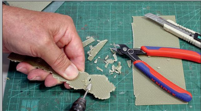
Die beim Vorbild beobachteten Kuhlen, in denen nur Sand oder Split liegt, erreicht man mittels eines kugeligen oder tropfenförmigen Fräsers. Man muss ihn langsam laufen lassen, damit das Plastik nicht schmilzt.
