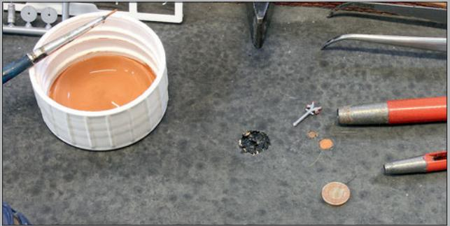
Mannlöcher und Abdeckungen für die Gas- und Wasserregulierung bohrt man oder – zur Erzielung von sauberen Rändern – stanzt sie ganz einfach. Geätzte Deckel setzt man lose ein, die Stanzöffnungen malt man etwas rostig an.
