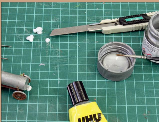
Einen normalen Jauchewagen kann man zu einem Wasserwagen umrüsten, indem man ein Styroporkügelchen teilt und eine Hälfte passend bemalt als Trinkwanne an den Wagen klebt.
