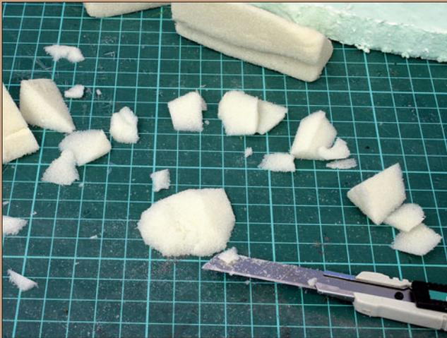
Für einen freistehenden Misthaufen schafft man sich einen Grundkörper, der als Haufenform aus Styrodur oder dem besser zu schneidenden Puren geschnezt wird. Ist der Misthaufen freistehend geplant, fallen alle Seiten schräg ab.
