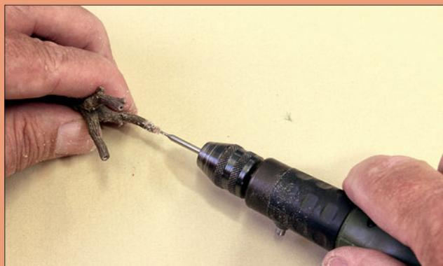
In dem Rohling sind die weiterführenden Astlöcher schon vormarkiert, aber eben noch nicht tief genug, um belaubte Ästchen einzuschieben. Sie müssen daher noch aufgebohrt werden; mit der Kleinbohrmaschine ist diese Arbeit schnell erledigt.
