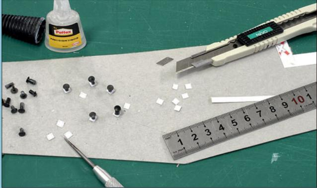
Aus etwas dickerem Papier (120 g) entstanden die Montageplatten auf der Rückseite der Puffer – durch das Tränken mit Sekundenkleber werden sie richtig hart. Mit einer Graviernadel erhielten sie vier Einkerbungen in den Ecken.
