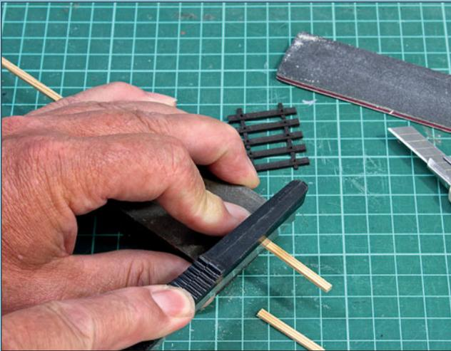
Zur Nachbildung sind fertige Plastikschwelle nicht geeignet. Daher entsteht die Schwelle aus einer 2 x 3 mm messenden Kiefernholzleiste, die im Bastelbedarf oder wirklich gut sortierten Baumärkten erhältlich ist. Mit der Bastelsäge von Roco lassen sich die Schwelle schnell ablängen.
