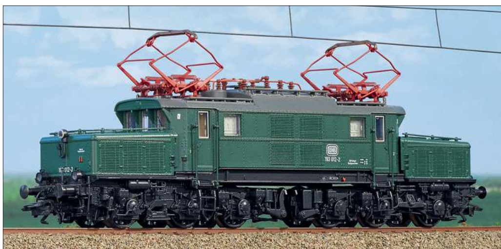
H0: Die Baureihe 193 gehört zu den technisch leicht aktualisierten und neu bedruckten Varianten. Sie besitzt jetzt LED-Anfahrleuchten im Fahrwerksbereich.
