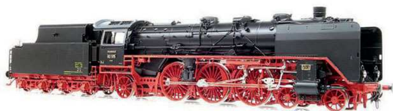
H0: Auffällig an 03 175 ist die Ventilsteuerung Lenzscher Bauart.
