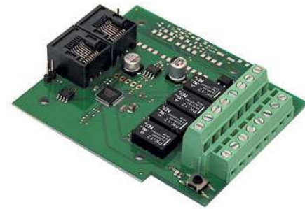
Schaltdecoder SD-34-BiDiB für den BiDi-Bus von Tams mit Umschaltrelais
