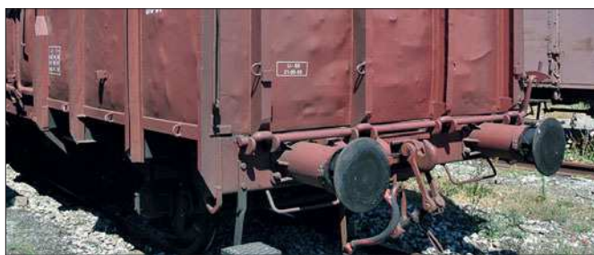
H0: Für die Ausrüstung von FS-Güterwagen bietet Günter Weimann Puffer der Typen Tipo 3 und Tipo 5 an. Im Bild ein Wagen mit den Tipo-5-Puffern.
