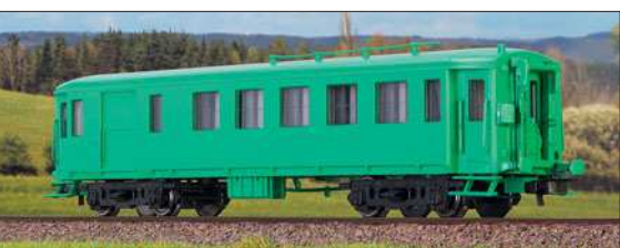
O: Der Tatra-Triebwagen wird von Andreas Heyden gefertigt; bemerkenswert ist die Anlenkung der Drehgestelle.
