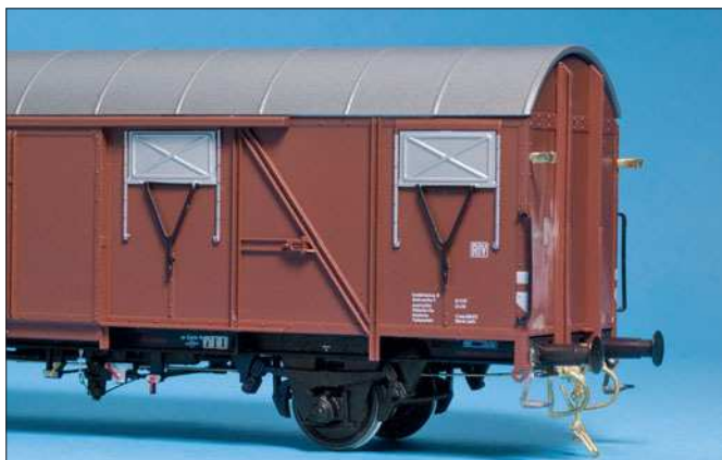
H0: Für die Detaillierung von Güterwagen kündigte CN-Modell geschweißte Signalhalter an.
