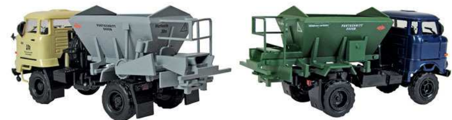
H0: Der Salzstreueraufsatz für den DDR-Lasten W50 ist ein exakt konstruiertes Modell. Links die Seite mit dem Reibradantrieb, rechts ist der Hydrauliktank zu erkennen.
