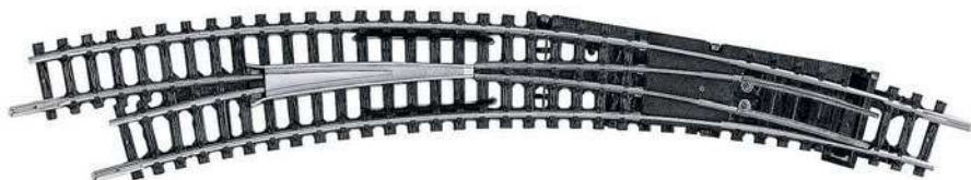
N: Bogenweiche für die Radien R3 und R4 mit elektrisch polarisiertem Herzstück
