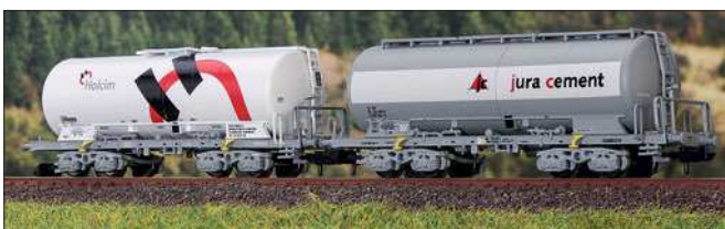
N: SBB-Silowagen UACS N zum Transport staubförmiger Schüttgüter
