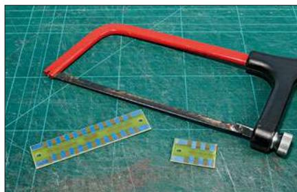
Links: Von einer Verteilerleiste von Viessmann wird ein Stück mit der Anzahl der benötigten Lötplätze abgeschnitten. Dies spart Platine und später beim Einbau auch Platz.
