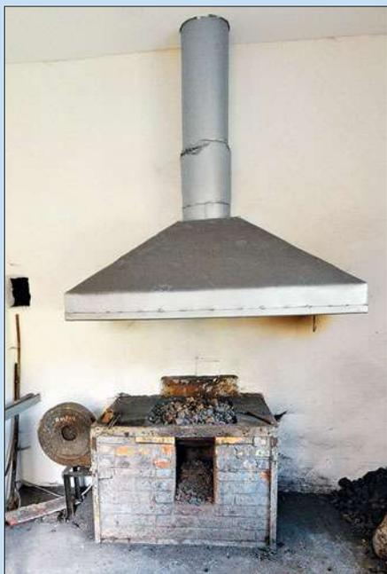
Bei den polnischen Waldbahnen verfügte fast jede Lokstation der Dampflokzeit über eine kleine Schmiede, deren Ausstattung zumeist nur aus einem Schmeldeofen mit Schmeldefeuer, dem dazugehörigen Gebläse und dem Werkzeug in Gestalt von Schmeldehämmern, Ambossen, Schraubzwingen usw. bestand. Da die Originalschmelde in Cisna Majdan noch heute existiert (Foto links), konnte sie als unmittelbares Vorbild für den Nachbau dienen.
