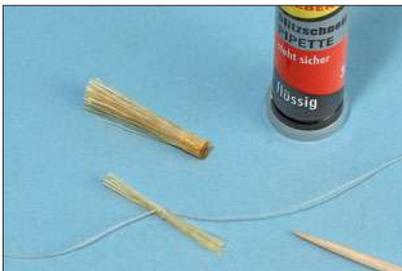
Dieses kleine Bündel wird nun aus der Verklebung herausgebrochen. Den Knoten versieht man zur Sicherheit mit einem Tropfen Sekundenkleber.
