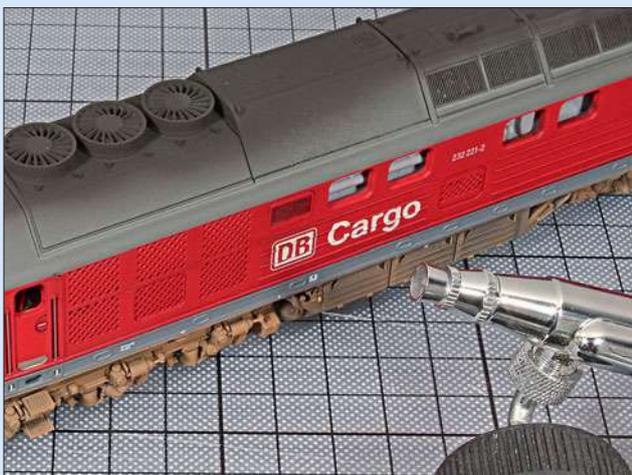
Nachdem das Dach mit allen neuen Anbauteilen grau lackiert wurde, entstand die Verschmutzung. Anhand von Vorbildaufnahmen wurden die typischen Rußspuren auf der Dachoberfläche mit einer Airbrush-Pistole nachgebildet. Die Farbe wurde sehr stark verdünnt, sodass kein deckender Überzug entstand. Im noch nicht ganz durchgetrockneten Zustand wurden die Farbpigmente mit einem harten Pinsel an bestimmten Stellen wieder „abgefegt“ oder typische Verlaufsspuren angedeutet.
