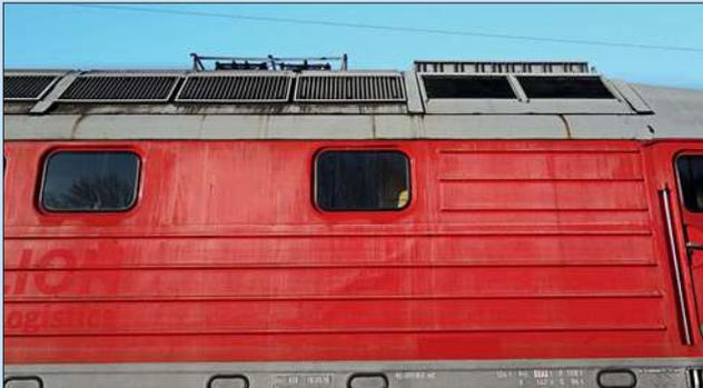
Auch wenn die Lokomotiven der Baureihe 232 gewaschen wurden, sind an den Oberflächen ausgebleichener Lack und Verlaufsspuren von schmutzigem Wasser zu erkennen. Insbesondere unter den Lüftern sind braune Verlaufsspuren vorhanden.
