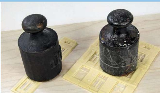
Kleine Gewichte drücken die Resinbauteile plan auf die ebene Unterlage. Die Gewichte sollten erst nach Abkühlen der Bauteile heruntergenommen werden.
