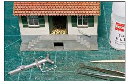
Die beiden Handläufe an der Gebäudewand werden ebenfalls mit Sekundenkleber befestigt, ihnen sollte vorher der Kunststoffglanz genommen werden.
