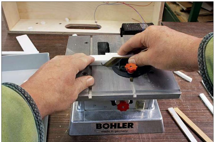
Ein Garant für senkrechte und exakt rechtwinklige Schnitte ist eine solche Modellbau-Tischkreissäge mit einem präzise eingestellten Anschlag.
