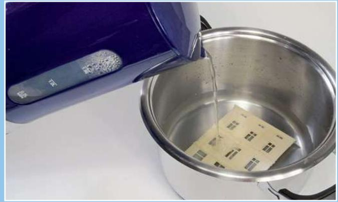
Nach dem Überbrühen mit heißem Wasser warten, bis das Bauteil die Wärme aufgenommen hat und biegsam geworden ist. Dann lassen sich die Resinteile problemlos wieder in Form bringen.
