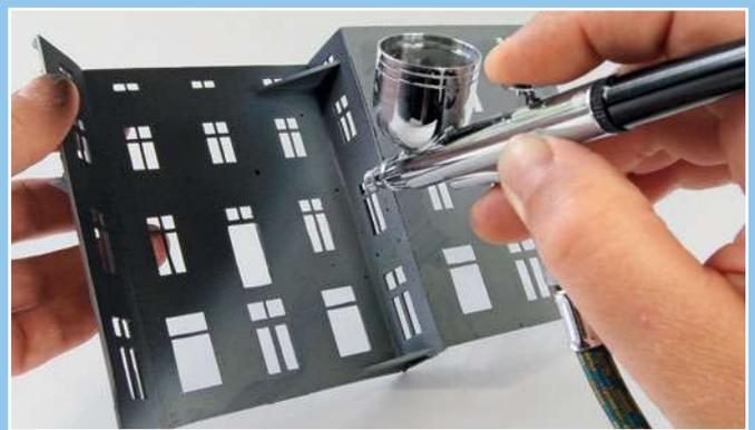
Damit später die Beleuchtung nicht durch Mauerteile oder Fenstersprossen durchschimmert, werden die Innenseiten der Fassaden mit der Airbrushpistole in Mattschwarz gespritzt.
