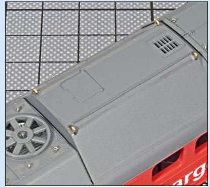
Kranösen erhält man als Neusilberätzteile von Kuswa. Hier müssen die einzelnen Ösen mit einer kleinen Schere vom Trägerblech getrennt werden (links). Die Ösen werden in die zuvor gebohrten Löcher geklebt. Beim Vorbild standen diese meist diagonal zu den Außenkanten der einzelnen Dachsegmente (Mitte). Die großen Dachsegmente wie die der E-Bremse und die Abdeckung des Schalldämpfers besaßen verstärkte Dachösen. Diese wurden im Modell aus feinem Draht gebogen und in zwei Bohrungen geklebt (rechts).
