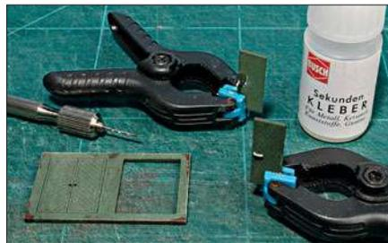
Die Türgriffe werden mit Sekundenkleber fixiert. Durch das Lackieren von Türblatt und Griffen müssen die vorhandenen Löcher im Türblatt nochmals geöffnet werden.
