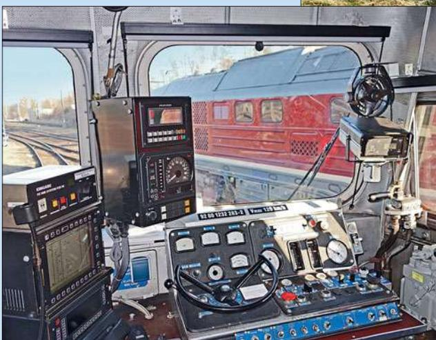
Der Führerstand der 232 ist recht eng. Die Fahrstufen wählt man über ein Stellrad. Links sind die nachträglich eingebauten Einbaugeräte der Funkanlage und das EBU-La-Gerät zu erkennen. Mittig davon befindet sich die Zugsicherung für die Holland-Verkehre der 232.9. Diese Geräte waren in den nur in Deutschland eingesetzten Loks nicht vorhanden.
