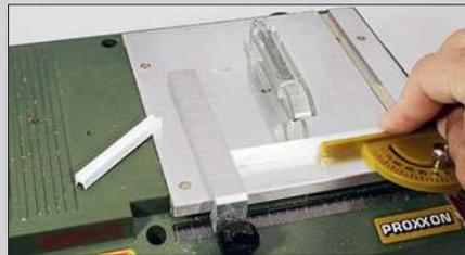
Große Profile und insbesondere die Doppel-T-Profile der Träger sollte man auf einer Tischkreissäge mit Anschlag schneiden.
