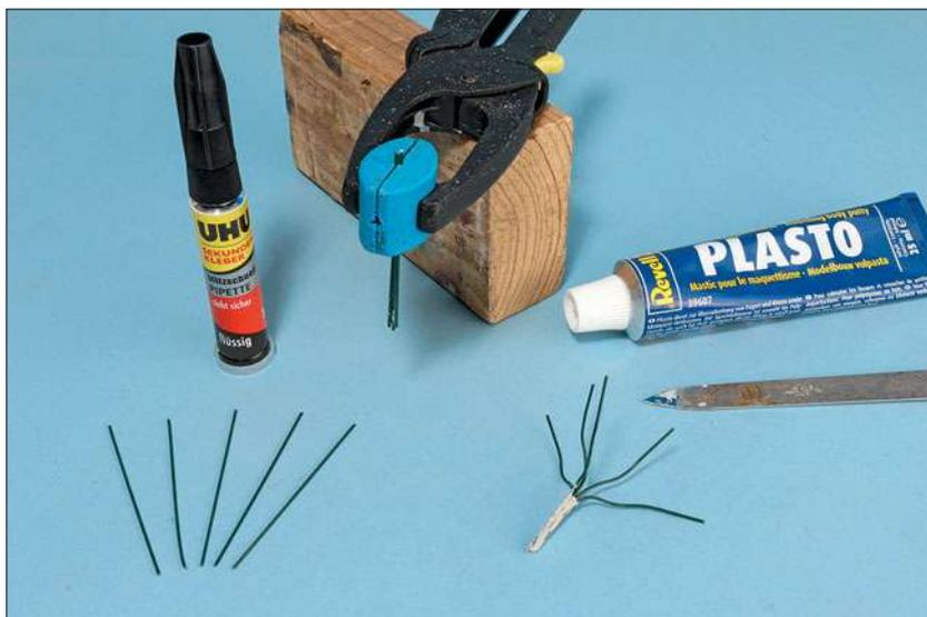
Beeresträucher entstehen aus kurzen Stücken von Blumensteckdraht. Die zusammengefassten Enden des Drahts werden mit Sekundenkleber fixiert. Der Stamm kann dann mit Revell-Plasto modelliert werden. Die Astenden werden unregelmäßig gebogen.
