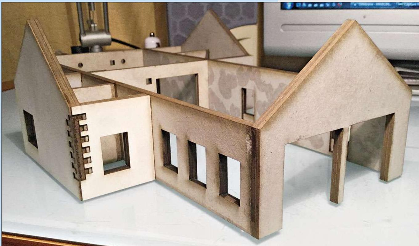
Der Korpus des Lokschuppens von der Rückseite zeigt die etwas verwinkelte Bauweise mit insgesamt sieben Räumen. Sämtliche Spalten und Lücken zwischen den Wandelementen sind hier bereits mit einer Kittmasse plan verspachtelt worden.
