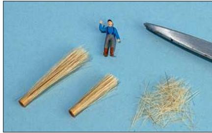
Die werksseitig zu Bündeln verklebten Schweineborsten werden zunächst mit einer Haushaltsschere auf eine passende Länge zugeschnitten.
