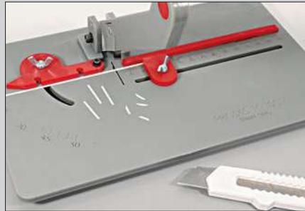
Dünne Rechteckprofile kann man mit einer Schneidemaschine mit scharfer Klinge sehr gut ablängen. Dabei sollten Anschläge und ein Winkel vorhanden sein.
