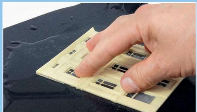
Um Gussgrate und -häute zu entfernen, schleift man die Werkstücke auf der Rückseite vollflächig plan. Überschüssiges Material wie Guss-häute in den Fenstern werden sauber entfernt.
