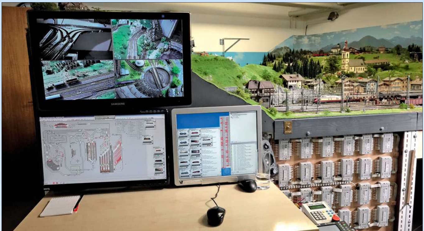
Volle Kontrolle bietet der Arbeitstisch des „Fahrdienstleiters“. Mit vier Kameras werden neuralgische Stellen auf der Anlage überwacht und auf dem oberen Monitor angezeigt. Über die unteren Monitore wird die Anlage gesteuert bzw. werden die Züge gestartet.
