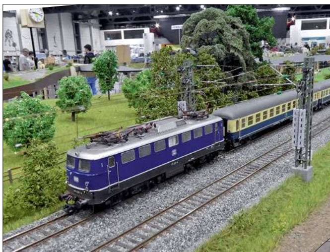
Seit einiger Zeit hat sich im Fremo auch ein Oberleitungs-betrieb etabliert. Die Fahrleitungsmasten kommen dabei in der Regel von Sommerfeldt. Die Fahrleitung wird aus Federbronzedraht selber gelötet. An den Modulübergängen werden winzige Ösen gebogen, die zur Verbindung mit dem Nachbarmodul dienen. An den Schattenbahnhöfen muss diese Form der Oberleitung tatsächlich etwas abgespannt werden. Die Stromabnehmer der Fahrzeuge müssen für den Fremo-Betrieb auf den richtigen Anpressdruck eingestellt werden. Bei den meisten Stromabnehmern gelingt dies durch den Ausbau einer der beiden Anpressfedern.
