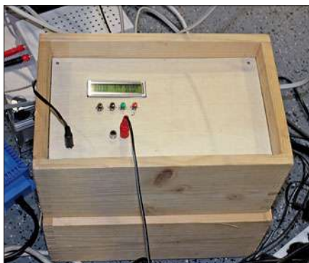
Der Uhrtaktgeber ist in eine einfache Holzkiste aus dem Baumarkt eingebaut. So ist der Taktgeber gut verpackt und trotzdem sofort einsetzbar.
