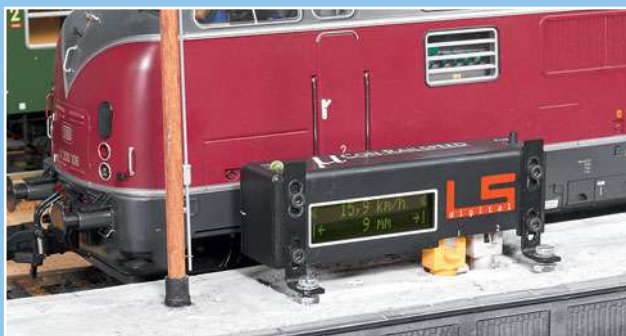
In Verbindung mit iTrain wird die Lok über eine Auswahl von Fahrstufen an dem \mu Con-Railspeed-Modul vorbeigefahren und die Messwerte der einzelnen Fahrstufen von iTrain für die Steuerung der Fahrzeuge übernommen.
