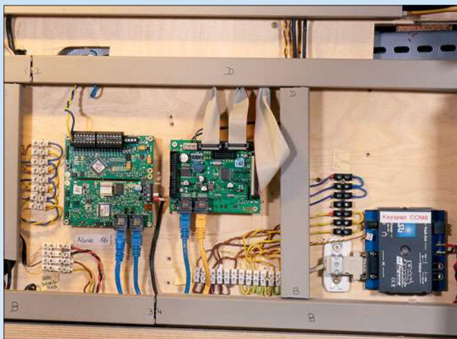
Hinter dem Anlagenrahmen sind die Digitalkomponenten von Fichtelbahn installiert. Patch-Kabel verbinden die Komponenten.
