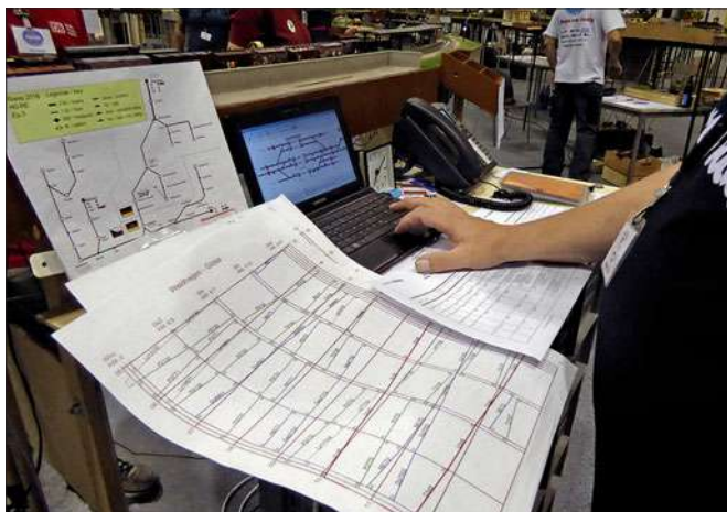
Am Arbeitsplatz des Fahrdienstleiters Waldhagen liegen ein Bildfahrplan, eine Netzspinne, stehen die Uhr, das Telefon und ein Notebook mit der Software Rocrail zur Steuerung des Bahnhofs.
