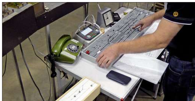
Der Arbeitsplatz des Fahrdienstleiters Langenthal: Telefon, Uhr, Fahrplan und das Stellpult sind die Arbeitsmaterialien für den geordneten Betrieb. Die Intellibox dient zur Stromversorgung des Erbert-Pults.
