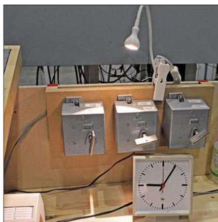
Der Arbeitsplatz des Fahrdienstleiters Langenthal: Telefon, Uhr, Fahrplan und das Stellpult sind die Arbeitsmaterialien für den geordneten Betrieb. Die Intellibox dient zur Stromversorgung des Erbert-Pults.
