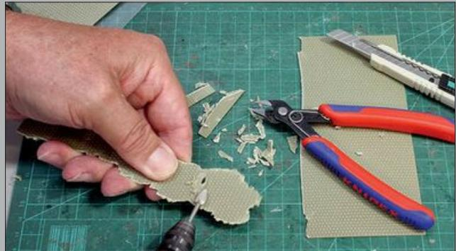
Die beim Vorbild beobachteten Kuhlen, in denen nur Sand oder Split liegt, erreicht man mittels eines kugeligen oder tropfenförmigen Fräasers. Man muss ihn langsam laufen lassen, damit das Plastik nicht schmilzt.
