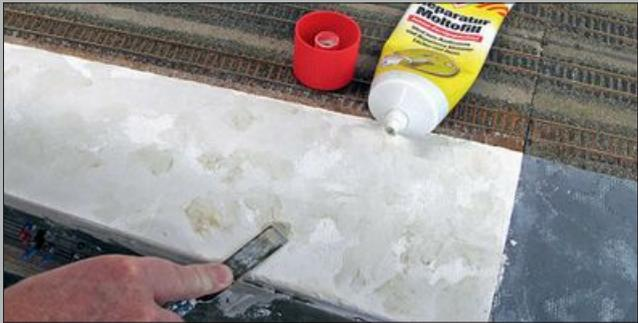
Mehrfach aneinandersetzbare Kopfsteinpflasterplatten erhält man u.a. durch Abgüsse in Silikonformen. Eine Keramikmasse wird in Wasser gegeben, das Ganze sämig gerührt und die Form ausgegossen. Mit einem Stahllineal abziehen, aushärten lassen, fertig!
