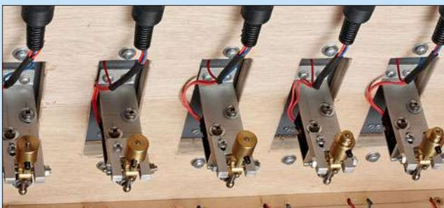
Alle acht Gleisbremsen haben ihre eigene Steuerung und sind über Stecker angeschlossen. Das gewährleistet im Fall des Falles einen schnellen Ausbau.
