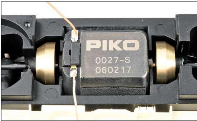
In der Lokmitte lagert ein Motor aus hauseigener Fertigung, der zwei Schwungmassen trägt, die zugleich auch als Lagerschalen für die Kardanwellen dienen. In den Drehgestellen sind sämtliche Räder – davon zwei mit Haftreifen – über gut abgestufte Schnecken-Stirnradgetriebe angetrieben. Der komplette Antriebsstrang läuft dabei in sämtlichen Geschwindigkeitsbereichen nahezu lautlos. *Fotos: MK*
