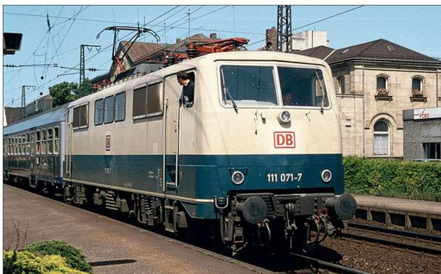
Ab der Ordnungsnummer 071 wurde der Spalt zwischen Verschleißpufferträger und Fahrzeugfront größer. Mit dem Signet der DB AG zeigt sich im Juni 1994 die 111 071 in Fürth.
