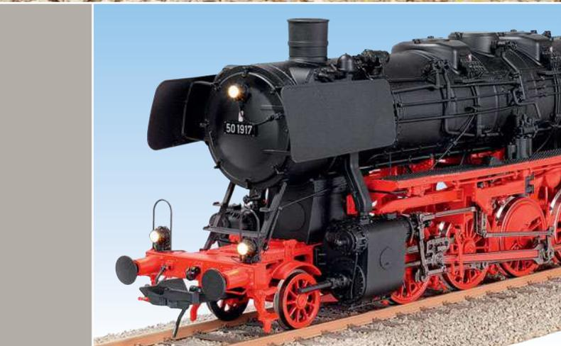
Nicht nur die Öffnungen der Rauchkammerstütze wurden geschlossen, auch erhielt die zweite Lenz-50 gekröpfte Einströmröhre mit quadratischem Querschnitt.
