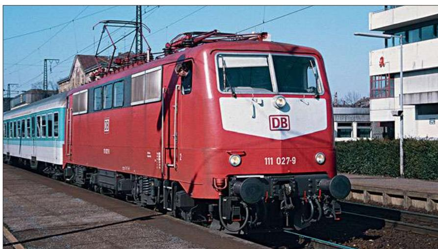
Gut stand den 111 das ab 1987 gültige Farbschema in Orientrot mit weißem Latz – in diesem Fall von der Fensterunterkante abgesetzt. Dieses trägt im Frühjahr 1995 die 1976 von Krauss-Maffei gelieferte 111 027 – ebenfalls in Fürth. Fotos: Peter Wittmann, Slg. gg (2)
