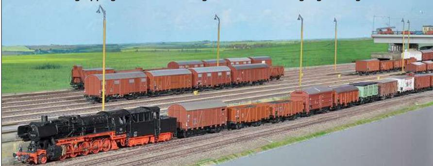
Mit konstant langsamer Geschwindigkeit schiebt V 90 030 Wagen für Wagen über den Eselsrücken. Der Aushänger hat dazu die Kupplungen im richtigen Moment gelöst. (Tatsächlich hat der Bediener des Rangierbahnhofs rechtzeitig einen der drei Entkupppler betätigt.)
