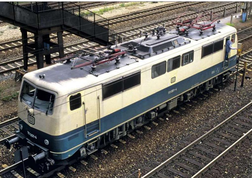
Die 111 des ersten Bauloses wurden mit Stromabnehmern vom Typ SBS 65 (unten links) ausgeliefert, mussten ihn aber an Loks der Baureihe 103 abgeben. Im Austausch erhielten sie den Typ DBS 54 (oben). Später kam der SBS 81 zum Einsatz (unten rechts). Fotos: bz (3)
