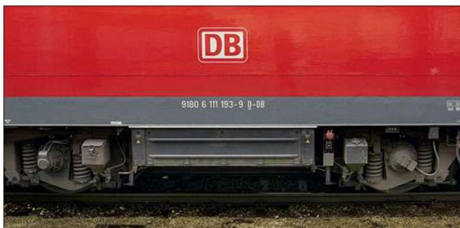
Die Batteriekästen füllen bei der 111 den gesamten Raum zwischen den Drehgestellen. Interessantes Detail der 111 193 sind die unterschiedlichen Sandkästen an den beiden Drehgestellen.
