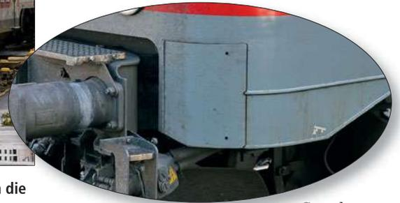
Senk-antrieb im Grundrahmen befand und der Druckluftanschluss über einen Teflonschlauch erfolgte. Gleichzeitig wurde auf das fest installierte 36-polige Kabel der Wendezugsteuerung verzichtet, und dieses durch eine abnehmbare Lösung ersetzt.
