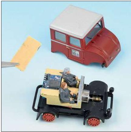
Das Öffnen ist eigentlich nicht vorgesehen. Wer sich dennoch traut, entdeckt unter den Sitzen den Motor. Der Decoder (ESU Nano) wird von einem Klebestreifen abgedeckt.
