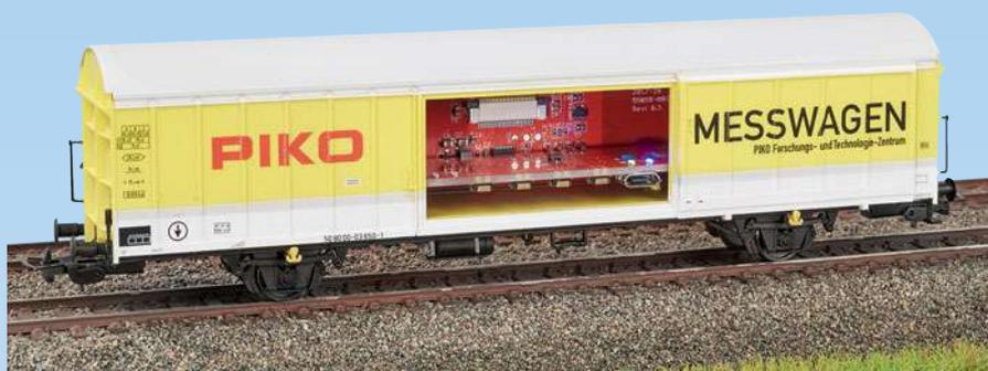
Blick in den Wagen mit der funktionsreichen Elektronik. Über die USB-Buchse können Messwerte abgegriffen und der Akku geladen werden. Vier LEDs zeigen Betriebszustände an.
