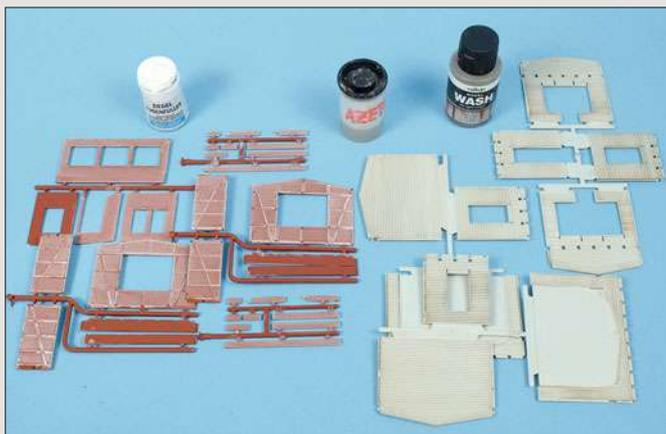
Im ersten Schritt werden alle Bauteile mit einer dünnen (!) Schicht Azeton überzogen, um das Material zu mattieren. Dann erfolgt das Ausfügen mit Fugenfüller bzw. Patinierung mit „Wash“.
