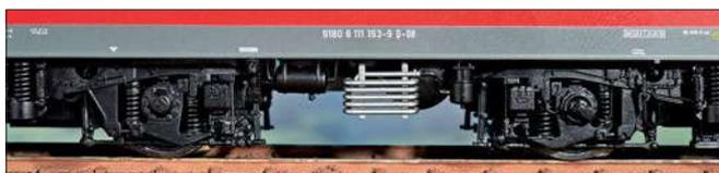
Die Drehgestelle sind nicht nur äußerst plastisch graviert, sie haben zudem auch separat angesetzte Sandkästen, Geberleitungen und Schneeräumer. Links: Farblich in Silber abgesetzt der Nachkühler des Kompressors
