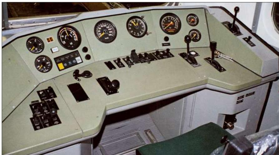
Eine Neuerung der 111 gegenüber den ab 1956 an die Bundesbahn gelieferten Elloks war der DB-Einheitsführerstand. Er stellte eine deutliche arbeitsergonomische Verbesserung dar und erleichterte den Wechsel zwischen Baureihen bzw. Steuerwagen. Foto: AEG, Slg. bz
