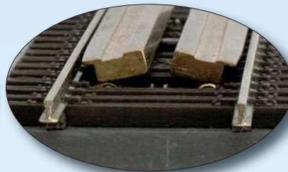
Die Gleisbremsen aus der Nähe betrachtet. Gefräste Messingprofile sind in Längsrichtung drehbar gelagert und werden mit einem Hubmagneten nach außen gekippt, sodass sie sich innen an die Radsätze legen. Die Steuerung jeder Gleisbremse erfolgt über eine separate Platine (unten). Hier werden Zeit und Stromstärke angezeigt. Die jeweils aktive Bremse ist durch ihre Leuchtdiode zu erkennen. *Fotos: EF Tuttlingen*
