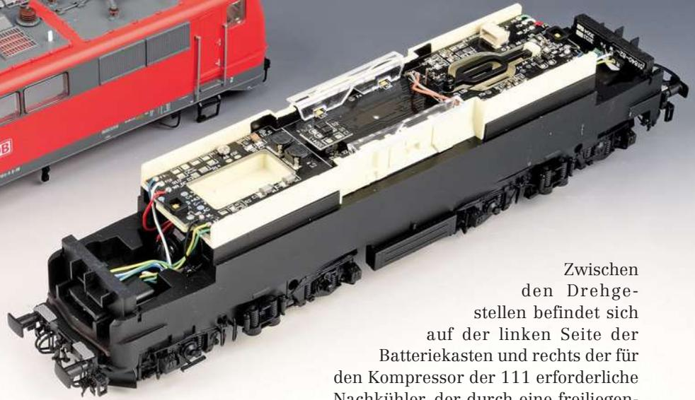
Zwischen den Drehstellen befindet sich auf der linken Seite der Batteriekasten und rechts der für den Kompressor der 111 erforderliche Nachkühler, der durch eine freiliegende Leitung direkt mit dem Ölabscheider verbunden ist.
