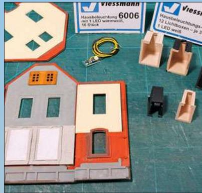
Das fertige Passepartout aus Karton wird exakt hinter die Fensteröffnungen geklebt. Jetzt können die dem Bausatz beiliegenden Gardinen auf den Karton geklebt werden. Für die einzeln beleuchteten Fenster werden die LED-Lichtboxen von Viessmann verwendet. Die Lichtboxen werden von außen schwarz lackiert, damit möglichst wenig Licht durch den Kunststoff scheinen kann.
