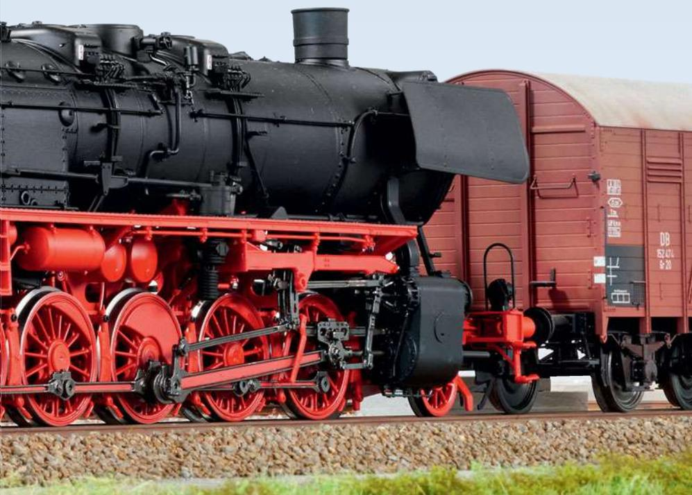
Auch der Kabinentender ist mit der achtpoligen und selbstrastenden Lok-Tenderkupplung ausgestattet. Angraviert ist das Dossierrohr für Speisewasserchemikalien und die Klappen der Werkzeugkästen am Tenderende.
