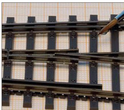
Auch beim Einsetzen der Radlenker bei den Weichen von Tillig ist der UV-Kleber nützlich. Die Klebestellen weisen zwar einen leichten Glanz auf, der aber später durch die farbliche Behandlung des Gleises nicht mehr zu sehen ist.
