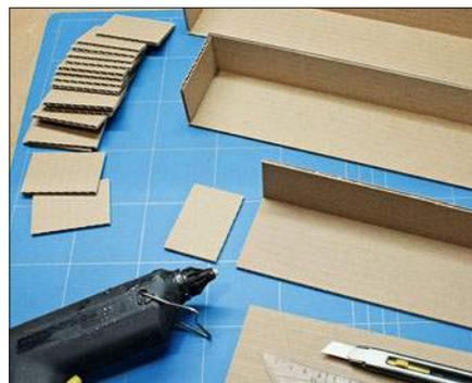
Die L-förmig gekanteten Einlagen entstehen aus gewöhnlicher Wellpappe. Es ist zweckmäßig, wenn die Wellen der Pappe rechtwinklig zur Schnittrichtung liegen. An den Enden halten rechteckige Pappstücke den Winkel. Sie werden mit Heißkleber befestigt.
