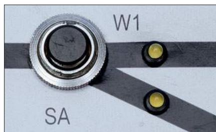
Ein weiteres Einsatzgebiet für UV-Kleber ist die Arretierung von LEDs im Stellpult. Bei LEDs ohne Fassung mit planer Oberfläche ist eine UV-Verklebung empfehlenswert.
