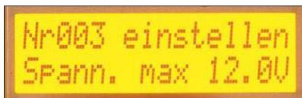
Je nach Ausführung liegt die maximale Ausgangsspannung bei 12 oder 14 V. Die Spannung lässt sich zudem begrenzen.
