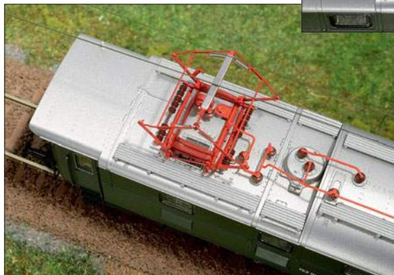
Die Stromabnehmer wirken sehr zierlich und zeigen Details wie die Isolatoren der Druckluftleitung und den Antrieb. Unterhalb der SBS-10-Nachbildungen wurden sogar die Ausblasöffnungen der Fahrmotorkühlung nachgebildet. Hauptschalter und Dachleitungen sind wie immer bei Piko genauestens ausgeformt.
