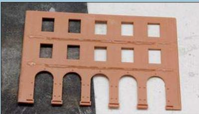
Die Klebeflächen wurden mit Schleifpapier egalisiert. Leider half das nur bedingt, denn es bleiben einige Fugen sichtbar. Danach wurden die Seitenwände miteinander verbunden. Nimmt man es genau, müssten die Ecken noch mit Spachtelmasse nachgearbeitet werden. Die Wände werden auf der Bodenplatte ausgerichtet.
