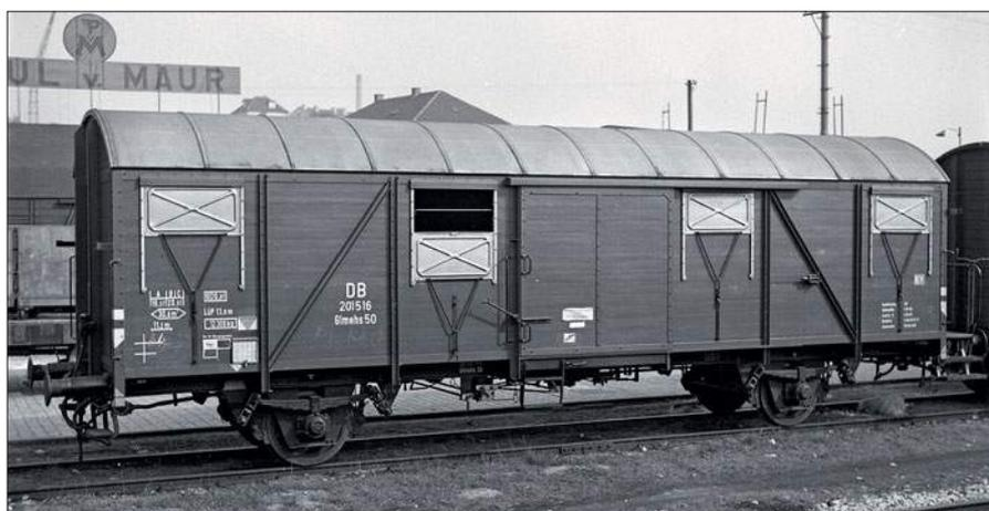
kamen aber bereits Leichtmetalldächer. Gebaut wurden sie sowohl ohne Handbremse als auch mit der 500 mm langen Vorbau-Handbremsbühne, z.T. auch mit Blechbremserhaus. Zusätzlich zu diesen 280 Glmehs 50 beschaffte die DB 100 auf der gleichen Konstruktion basierende Leig-Einheiten.
