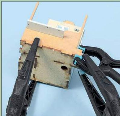
Bei vollflächigen Verklebungen, wie hier am Vorbau, verhindern Klammern ein Verziehen der Kartonteile.
