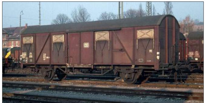
unterscheiden sich diese Umbauten in vielen Details: Sprengwerk, Seilhaken über den Achsen, PVC-Dach und kurze Handbremsbühne – Letztere erhielten auch andere Gbs 245 im Zuge der Vorbereitung für den AK-Einbau. SC
