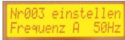
Für jedes Profil lassen sich zwei Frequenzen für die gepulste Gleichspannung in Abhängigkeit der Spannungshöhe einstellen.
