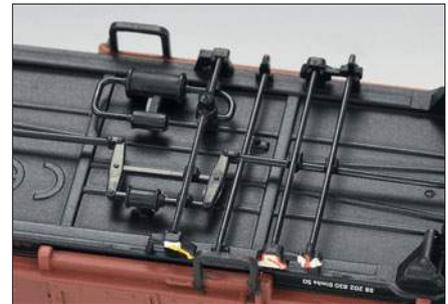
Winzig klein und doch mit allen Komponenten ausgestattet ist die separat angesetzte Bremsanlage. Davor die farbigen Bremsumsteller in korrekten Positionen.
