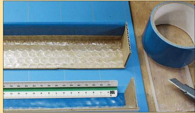
Damit das Ganze noch etwas sauberer aussieht, umfasst ein Streifen Klebeband den hochstehenden Schenkel. Dazu wurde breites Gewebeband verwendet.
