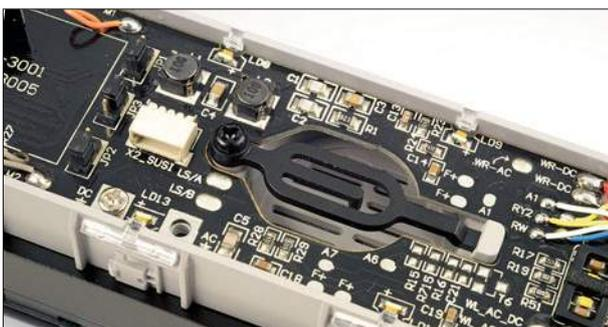
Zu diesen Verbrauchern zählen auch kleine LEDs über jedem einzelnen Maschinenraumfenster. Ihr Licht wird mittels Lichtleitkörpern auf die Sichtseite der Blende verteilt. Ebenfalls hier zu sehen: Die SUSI-Schnittstelle und der Einbauräum für den optionalen Lautsprecher.
