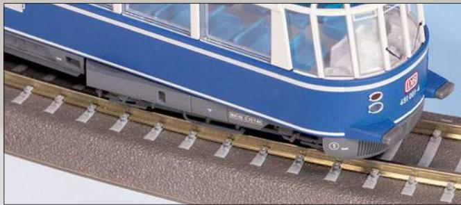
Um enge Modellgleisbögen durchfahren zu können, ist die Schürze im Bereich der Drehgestelle schwenkbar ausgeführt worden, was bei Geradeausfahrt kaum erkennbar ist.
