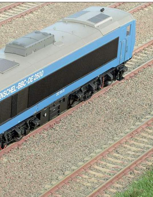
Konstruktion auf das Wesentliche reduziert wurde. Die freistehenden Radatzlager werden durch einfache Lenker vertikal geführt, Stoßdämpfer und Anhebekonsolen sind angraviert, ebenso wie die Sandkästen, deren Sandfallrohre freistehend bis Mitte Schiene reichen.
