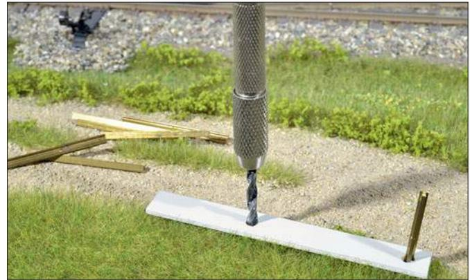
Modellbahnstudio Lenzen empfiehlt für die Baugröße 0 einen Pfostenabstand von 44 mm. Damit die Abstände immer gleich sind, wurde aus einem Rest von Polystyrol eine einfache Schablone gefertigt.
