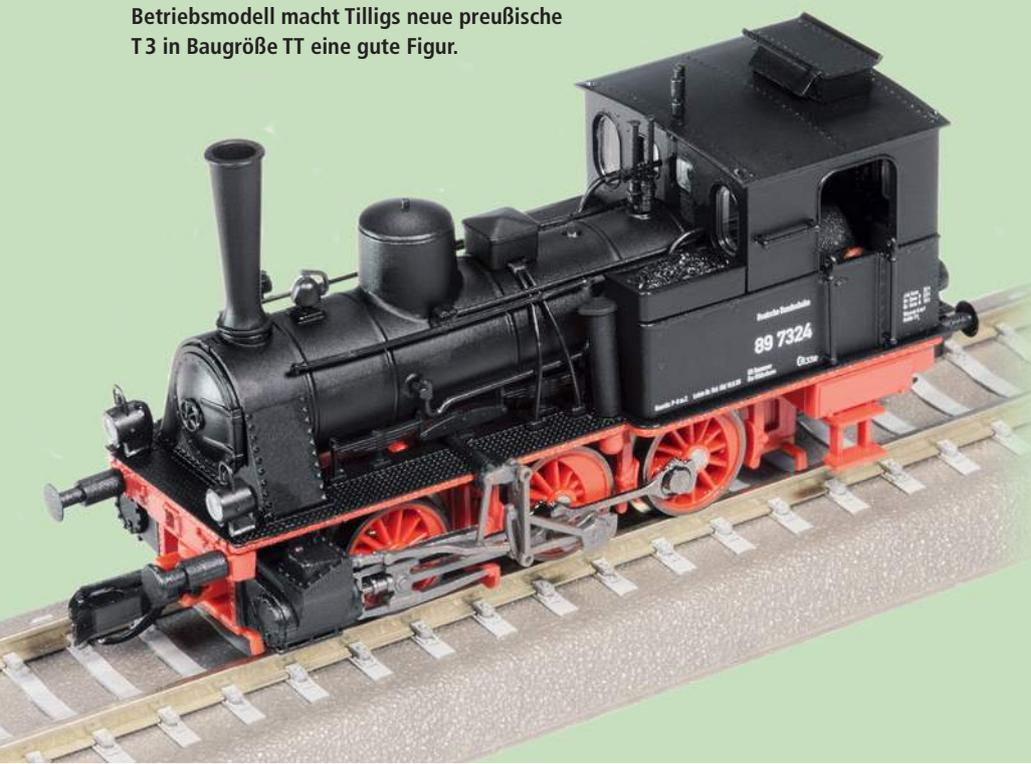
Bei Tillig ist konzeptionell neu, dass der kleine Dreikuppler generell mit fest eingebautem DCC/MM-Decoder aus dem Hause Uhlenbrock ausgeliefert wird. Das Fahren im Analogbetrieb wird im vollen Umfang unterstützt. Bei Einsatz eines Bühler-Fahrgerätes und insbesondere auch mit dem Tillig-TFi war mit dem Probanden Langsamfahren eben so gut möglich wie im Digitalbetrieb. Der Regelbereich der Geräte wurde weitgehend genutzt.
