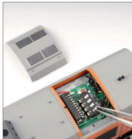
Nach Lösen von vier Schrauben kann das Lokgehäuse abgehoben werden. Die verlöteten Kabel sind ausreichend lang bemessen und sorgen für eine sichere Stromverbindung zur Beleuchtung.
