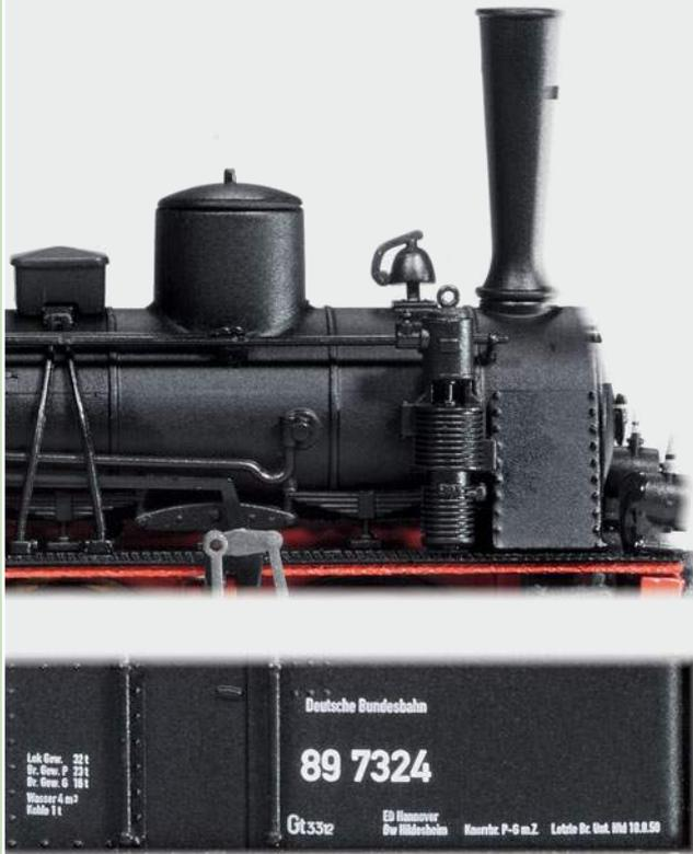
Die starken Vergrößerungen machen deutlich, wie detailliert das Modell nachgebildet worden ist. Freistehende Teile wie die Glocke oder die Pumpe (oben) überzeugen ebenso wie die Bedruckung (Mitte). Unten: Während für die Teile der Allan-Steuerung robuster Kunststoff zum Einsatz kam, besteht die Kuppelstange aus brüniertem Neusilberblech.
