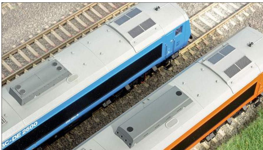
Von den zahlreichen Bauformen der Abgasschalldämpfer wurden zwei im Modell realisiert: Die längere Bauausführung ist auf 202 003 montiert, die kompakte auf 202 004. Die Luftauslässe der Bremswiderstände sind als Haube konstruiert.
