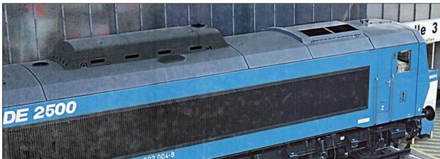
Hinter der etwas kryptischen Nummer 608099-33001-1 verbirgt sich die 202 002, die von 1974 bis 1977 fest mit einem Silberling-Steuerwagen gekuppelt war. Dieser trug den Pantografen, den Trafo und den Eingangstromrichter (Vierquadrantensteller), sodass beides zusammen eine hochmoderne Ellok bildete. Foto vom 15.1.1975 in Kaiserslautern: Karlheinz Buchholz
