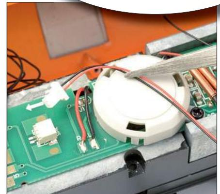
Zum Einbau eines Lautsprechers ist die Schallkapsel bereits vormontiert und das Anschlusskabel mit passendem Miniaturstecker werksseitig beigelegt.
