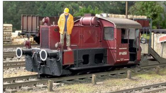
Die weißen Warnringe an den Puffertellern waren an vielen Fahrzeugen noch bis weit in die Epoche III hinein zu finden. Im Modell bestehen sie aus einer selbstklebenden hauchdünnen Folie; sie lassen sich mit einer Pinzette leicht aufbringen und sauber ausrichten. Abschließend sollten sie noch mit mattem Klarlack versiegelt werden. *Fotos: Hans Wunder*
