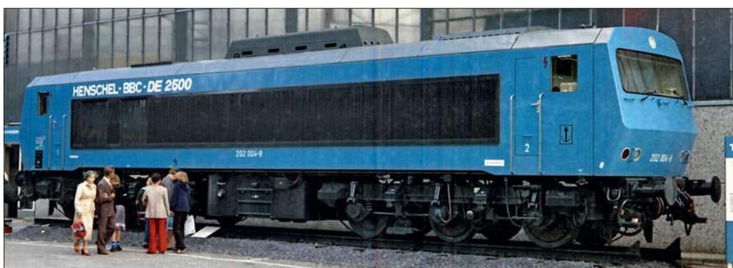
Ebenfalls sechsachsig ist 202 004. Sie erstrahlt in kräftigem Blau – hier am 30. Juni 1979 auf der Internationalen Verkehrsausstellung in Hamburg. Der Aufsatz für den Abgasschalldämpfer auf dem Dach ist noch im Ablieferungszustand. Foto: bz
