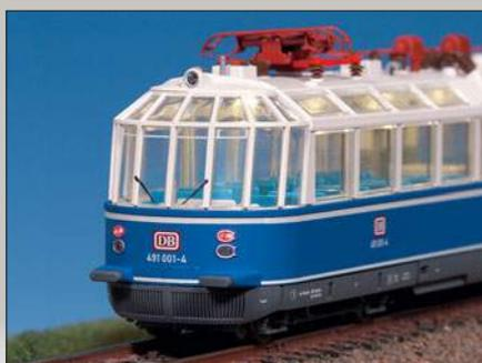
Im Foto sind nur ein Teil der zahlreichen Beleuchtungseffekte darstellbar, die der werksseitig eingebaute Decoder „FlexDec“ bietet: Innenraumbeleuchtung, Spitzen-/Schlussignale, Aufblenden des Spitzenlichtes, Leuchtstoffröhrensimulation usw. Fotos: Rainer Ippen
