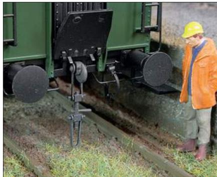
In Thalrodach wird jedoch bekanntlich mit Schraubkupplung gefahren; zum Austausch bietet Lenz eine Original-Kupplungsnachbildung unter der Art.-Nr. 49015 an. Der Messing-Bremschlauch stammt hier von Addie-Modell (BT 30 263), die Kunststoffschläuche sind ältere Lenz-Modelle, an denen der Absperrhahn ergänzt wurde. Nachdem die Umrüstung erfolgte, kann unser Werkstattleiter die Arbeit abnehmen ...
