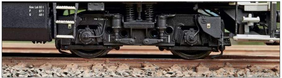
Am Drehgestell gut erkennbar die für die V 90 typischen Megi-Federn. Alle Anbauteile wurden freistehend angeordnet: Die von außen gut sichtbaren (echten) Schraubenfedern der Kastenabstützung mit mittig angeordneten hydraulischen Schwingungsdämpfern, wie auch die Bremszylinder mit den zugehörigen Hebeln an der Bremswelle; die Sandkasten mit den Sandfallrohren, die am Ende vorbildgerecht wegen des aufgesetzten Gummischlauchs dicker sind.
