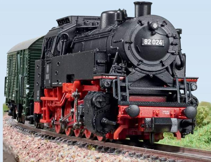
vernickelten Radsätze und das feine Gestänge tragen zum positiven Gesamtbild bei. Schaut man von oben auf das Modell, fällt der Durchblick zwischen Wasserkästen und Kessel auf. Das Lokgehäuse wurde in Gemischtbauweise gefertigt, wobei die Wasserkästen sowie der untere Teil von Führerstand und Tender aus Metall bestehen, der Rest des Gehäuses hingegen aus Kunststoff. Die oberen Teile von Führerstand und Tender sind aufgeklipst.
