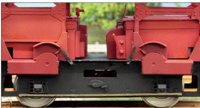
Zur Bedienung der Ka 4013 stand der Fahrzeugführer auf dem Trittbrett. Dementsprechend waren die Bedienelemente Fahrstufenschalter, Sandstreuvorrichtung, Fahrtrichtungsschalter und Fußbremse seitlich am Fahrzeug angeordnet.
