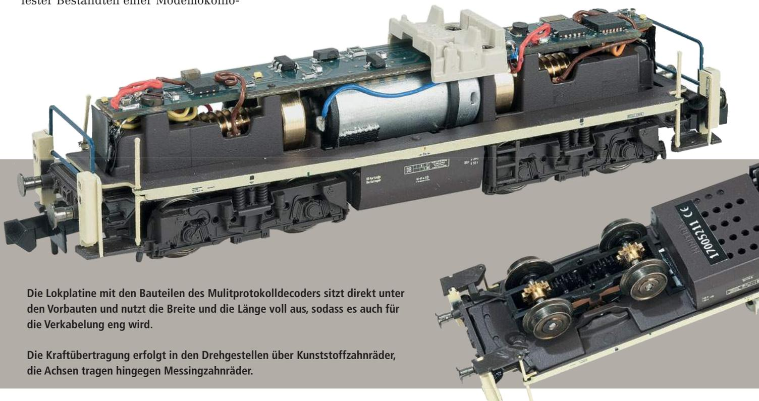
Die Lokplatine mit den Bauteilen des Multiprotokolldecoders sitzt direkt unter den Vorbauten und nutzt die Breite und die Länge voll aus, sodass es auch für die Verkabelung eng wird.
