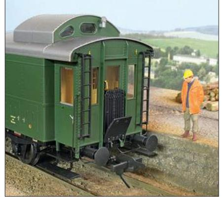
Oben: Der frisch ausgelieferte Pwi 31a von Lenz in der Ausführung der Epoche III (Art.-Nr 41130-01). Hier trägt er noch die „automatische“ Lenz-Kupplung, mit der sowohl Puffer-an-Puffer-Fahren als auch Kuppeln im Bogen möglich ist.
