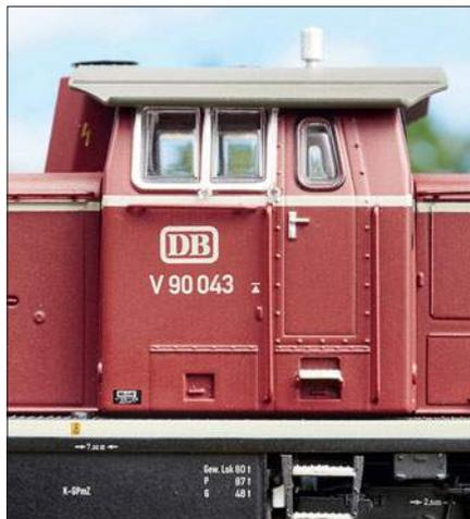
Von oben bis unten typisch Epoche III: Die Topfantenne für den Rangierfunk, das negative DB-Emblem, das MaK-Fabrikschild und die vollständigen Bremsanschriften. Etwas ausgeprägt wurden die Senkschrauben im Türrahmen dargestellt, der Spalt zwischen Führerstand und Umlauf wird bei der Serie hoffentlich der Vergangenheit angehören.
