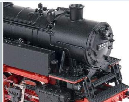
Pfeife und Glocke sind angesetzt, ebenso die Luftpumpe in dem kurzen Umlauf
