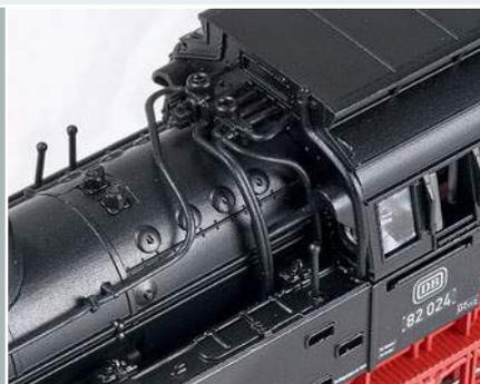
Freistehender Dampfverteiler mit Handrädern und Verrohrung, davor die Ackermänner
