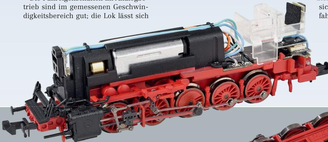
Der Motor ist im Kessel unterge-bracht und wird dort von einem spe-ziell geformten Gewicht aus Metall-druckguss auf dem Chassis fixiert. Gut zu erkennen ist die Turbo-speisepumpe mit ihren Leitungen zwischen Zylinder und Rauchkammeraufstieg.
