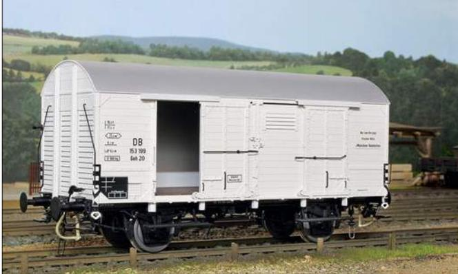
Der neue Wagen ohne Patinierung, lediglich die Pufferbohle wurde mit Bremsschläuchen und Schraubkupplungen von Addie-Modell zugerüstet.
