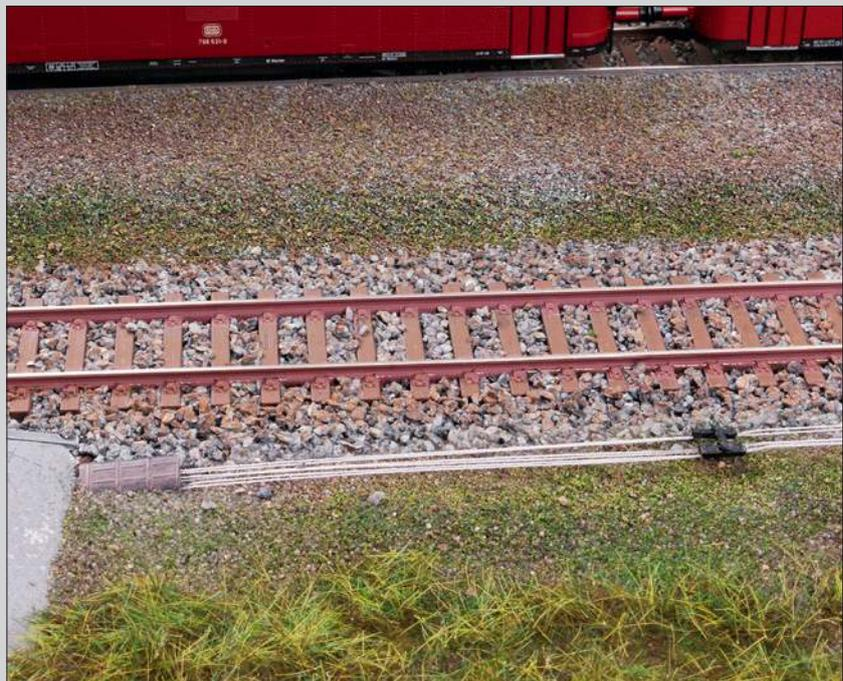
Am Ende des Bahnsteigs werden die Drahtzugleitungen erstmals sichtbar. Nachdem sie noch in einem kurzen Kanalstück geschützt verlaufen, werden sie dann an die oberirdisch verlaufenden Rollenhalter geführt.
