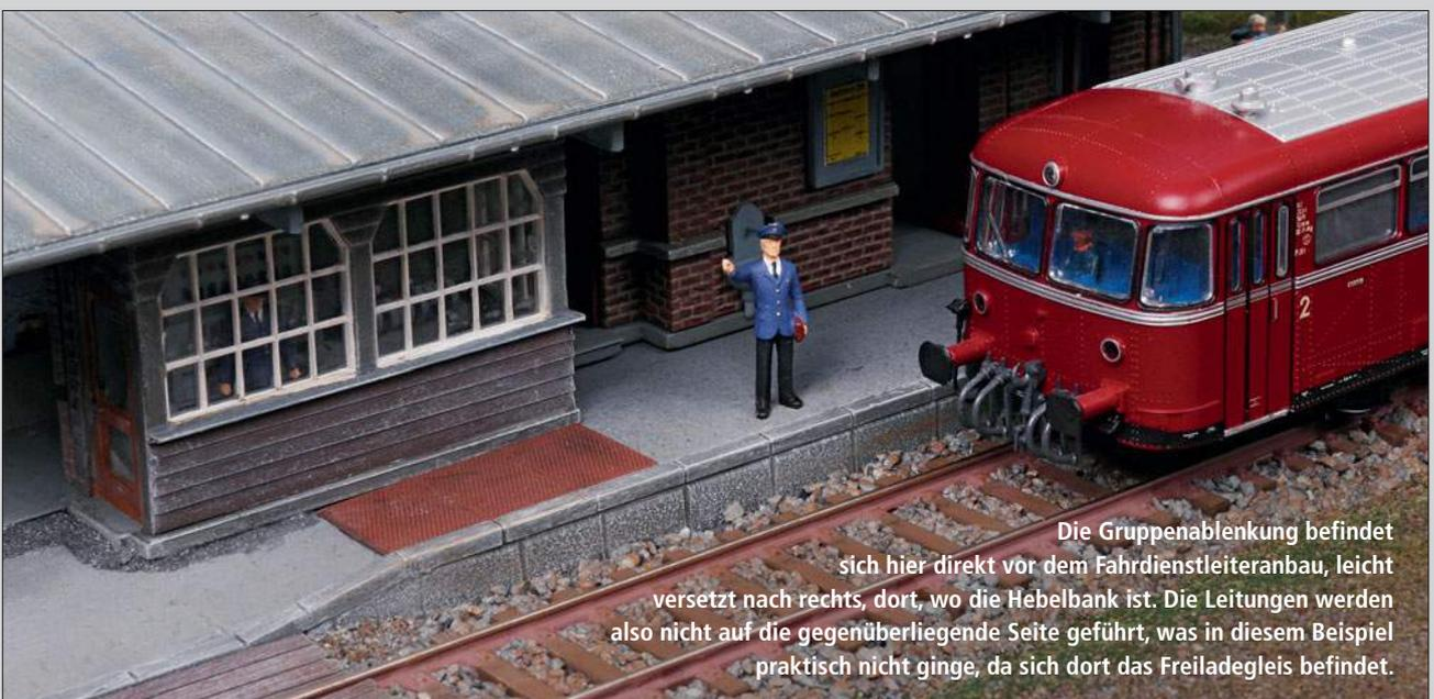
Die Gruppenablenkung befindet sich hier direkt vor dem Fahrdienstleiteranbau, leicht versetzt nach rechts, dort, wo die Hebelbank ist. Die Leitungen werden also nicht auf die gegenüberliegende Seite geführt, was in diesem Beispiel praktisch nicht ginge, da sich dort das Freiladegleis befindet.
