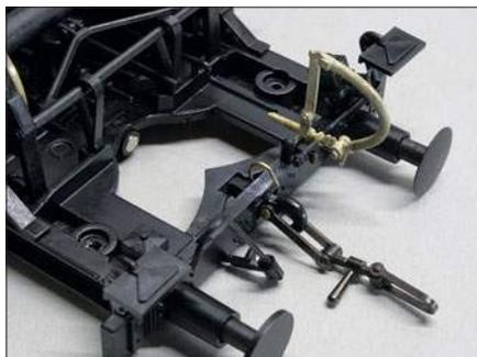
Wagenkasten und Untergestell wurden zum Patinieren getrennt. Zunächst wurde der herausnehmbare Wagenboden mit Acrylfarben gestrichen und mit dunklerer Farbe leicht schattiert.
