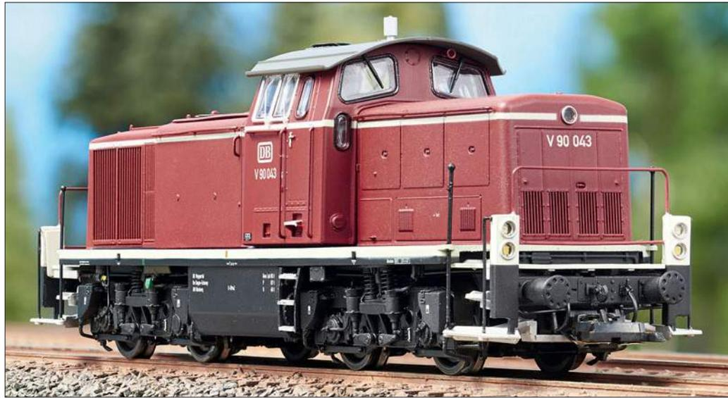
Die V 90 im Einsatz, deren äußere Schlichtheit durch den Verwendungszweck bestimmt wird. Dazu gehören die schmalen Vorbauten mit den Durchblickfenstern an der Führerhausrückwand und die Rangiertritte mit den Übergangsbühnen. In deren Geländer wurden vorbildgerecht die Lampenkästen für die Signalleuchten integriert.
