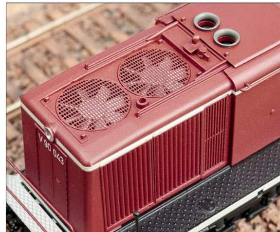
Unter den fein geätzten Abdeckgittern wirken die beiden drehbar gelagerten Lüfterränder der Kühlanlage sehr authentisch. Die verstellbaren Lamellen beim Lufteintritt an der Seite wurden in geschlossenem Zustand dargestellt. Der Umlauf hat vorbildgerecht erhabene Noppen, die Übergangsbühne eine Gitterroststruktur.
