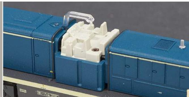
Der nachgebildete Führerstand wird über einen Lichtleiter von einer LED beleuchtet.
