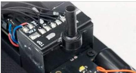
Links: Der Schlot des Rauchentwicklers ragt in die Abgasöffnung des Modells (oben), nach dem Abnehmen der aufgesteckten Lautsprecher werden die zugehörigen Kontaktflächen auf der Hauptplatine sichtbar.
