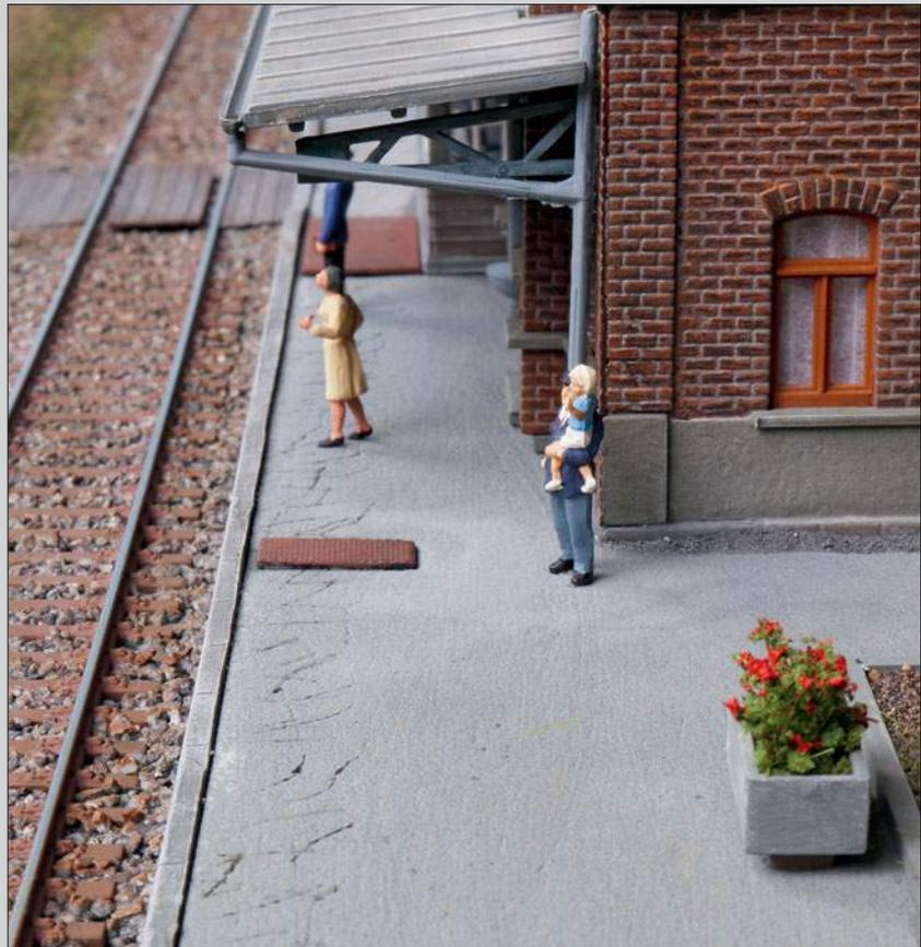
Also verlaufen sämtliche Drahtzugleitungen in einem Kanal unter dem Hausbahnsteig. Dort, wo die Leitungen durch Rollen unterstützt werden müssen, befinden sich Riffelblechabdeckungen, die einen Zugriff ermöglichen. Tatsächlich ist der Verlauf der Kanäle auch beim Vorbild häufig durch vermehrte Rissbildung in der Bahnsteigdecke gut auszumachen.
