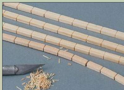
Die Mauerkronesteine entstehen aus feinen Holzleisten. Bei jeder Fuge wird ein winziges „Dreieck“ herausgeschnitten. Zum Kleben der Kronesteine wird die Mauer an die Einbaustelle auf der Modellbahn gestellt. Das Malerabdeckband verhindert, dass sie bereits kleben bleibt.
