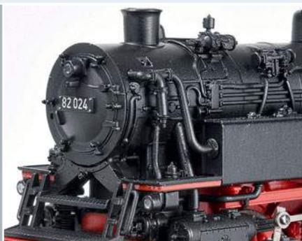
Turbospeisepumpe unter der Loklaterne und zum Mischvorwärmer führende Rohre
