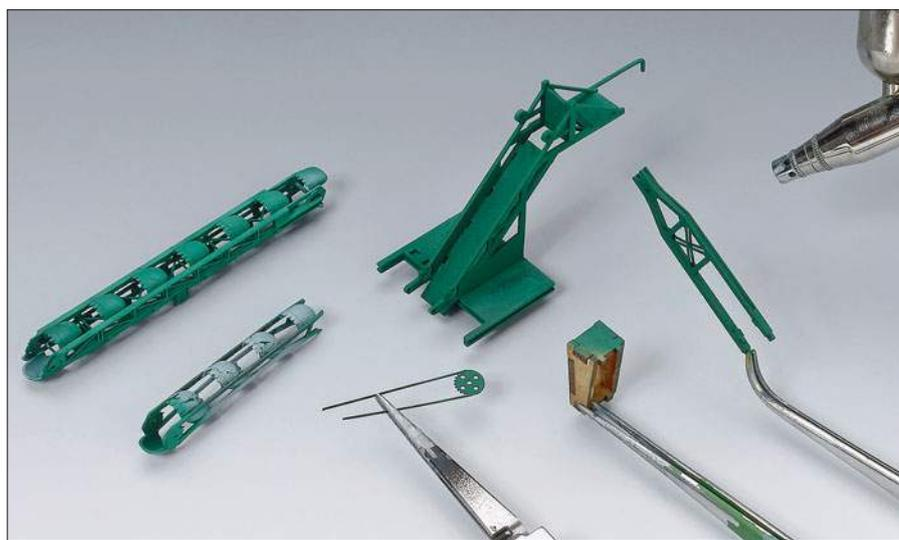
Für die H0f-Feldbahn von Busch hat bislang ein passender Eimerkettenbagger gefehlt. Markus Tiedtke stellt den leicht zu montierenden und aus Lasercut- und 3D-Druckteilen bestehenden Busch-Bausatz vor. Kleine Verfeinerungen runden das zierliche Modell ab. *Foto: Markus Tiedtke*
