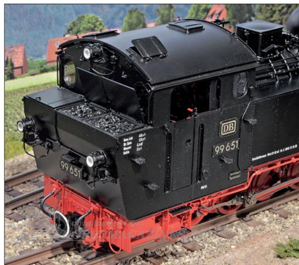
Links: Zur Darstellung realistischer Bekohlungszenen lassen sich die Tenderklappen öffnen. Ansonsten gefallen an der Lok auch die exakt nach Vorbild „auf Putz“ verlegten Leitungen (sichtbar sind ja eigentlich nur die metallenen Leerrohre ...) für die elektrische Beleuchtung.
