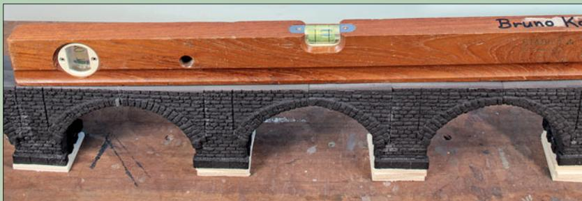
Alle Brückenteile sind zur durchgehenden Schräge geschliffen. Der Höhenunterschied von links nach rechts beträgt 25 mm; die Wasserwaage dient als Kontrollinstrument.
