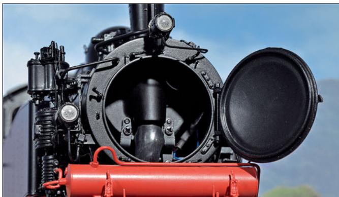
Öffnet man durch Drehen der winzigen Vorreiber die Rauchkammertür, kommt der Funkenfänger zum Vorschein. Er tarnt bestens die dahinterliegende Dampfeinheit, die per Ventilator für soundsynchronen Dampfausstoß und Zylinderdampf sorgt.
