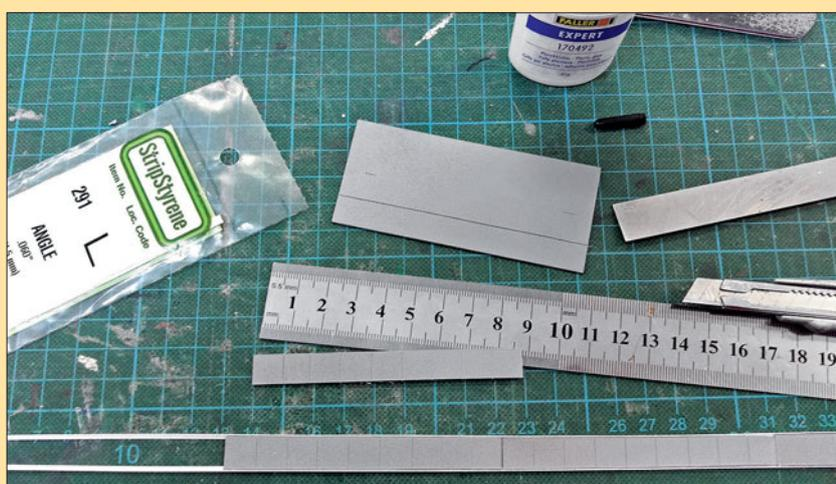
Für den Straßenbelag im Gleisbereich mussten passgenaue Füllstücke zugeschnitten werden. Sie entstanden – wie auch die übrigen Straßen auf der Anlage – aus 3 mm starken PVC-Platten. Für die Passgenauigkeit sorgten wieder Papierschablonen. Die Ränder, die über die Schwellen bis an die Schienenprofile heranreichen, müssen noch freigeschnitten werden. Hierbei hilft ein Stahllineal als Führungshilfe und ein scharfes Messer, nach Möglichkeit mit frischer Klinge.
