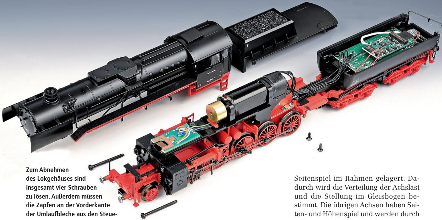
Zum Abnehmen des Lokgehäuses sind insgesamt vier Schrauben zu lösen. Außerdem müssen die Zapfen an der Vorderkante der Umlaufbleche aus den Steuerungsträgern herausgehoben werden.
