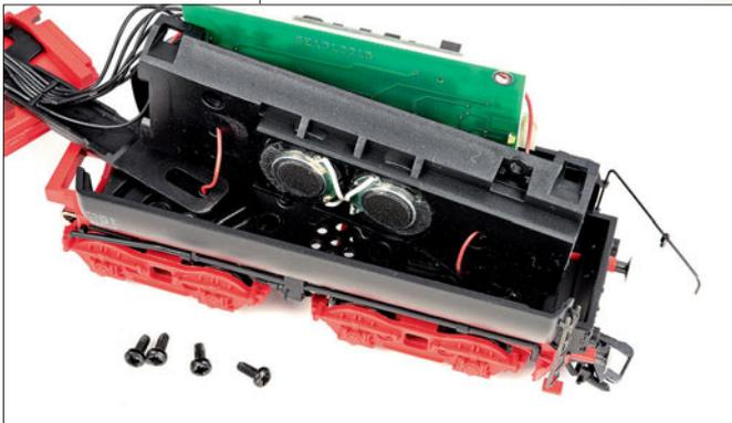
Im Tender liegt die Schallkapsel der beiden Lautsprecher. Sie dient zusätzlich als Halterung für die Deichsel wie auch als Aufnahme für die Rastnasen des Wasserkastendeckels.
