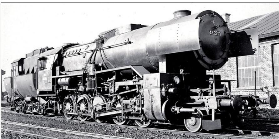
tung bemängelt. Im Unterschied zur 52 bekamen die 42 jedoch wieder Achsstellkeile. Die versuchsweise aus Bakelit hergestellten Achslagerführungen unterlagen einem vorzeitigen Verschleiß und mussten gegen Bauteile aus Grauguss getauscht werden.
