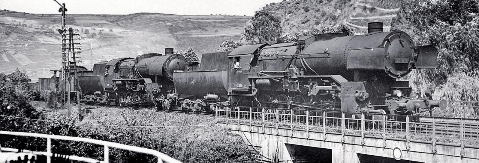
Die Baureihe bewährte sich bedingt. Zwar galt der Kessel als verdampfungsfreudig, zeigte andererseits aber früh Schäden, die auf Material minderer Qualität zurückzuführen waren. Auch konstruktive Mängel wie die festen Stehholzen führten oft zum Ausfall einer Lok. Das Zweizylinder-Fahrwerk neigte zudem jenseits von 60 km/h zu Zuckungen.
