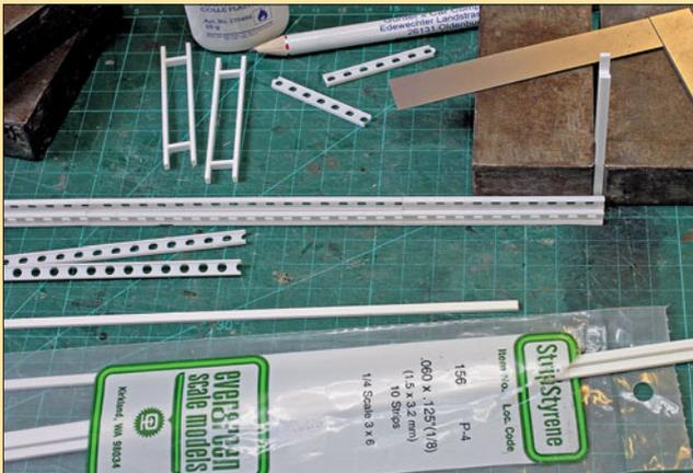
Die Rohrbrücke musste komplett selbst gebaut werden. Dazu wurden passende Lochprofile von Plastruct (im Vertrieb bei Piko) sowie Vierkant- und Rundstäbe von Evergreen verwendet.
