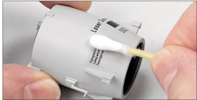
Der Wasserfilm unter der Folie lässt sich mit einem Wattestäbchen entfernen, indem man es von der Mitte aus über die Trägerfolie rollt.
