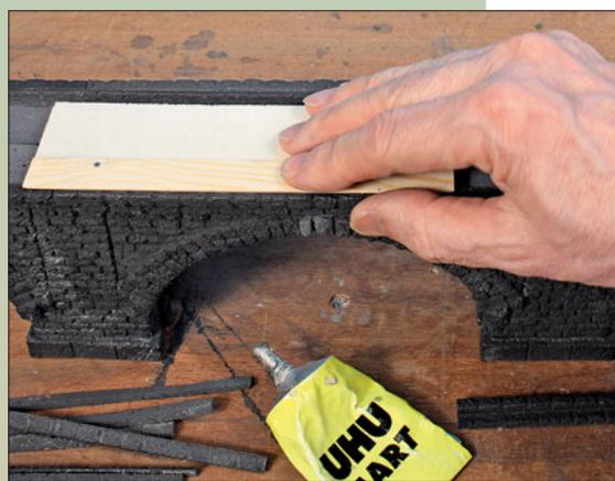
Die Fugen unter den Brüstungsleisten lassen sich nicht vermeiden; sie können aber ebenfalls mit Weißleim leicht kaschiert werden.
