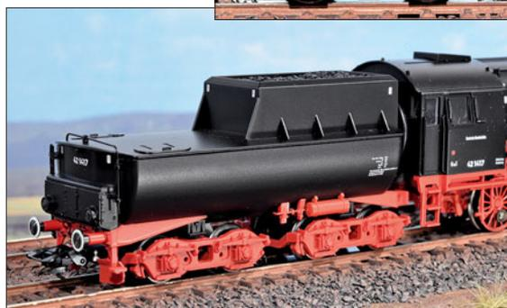
Der Tender mit Wanne aus Metall und Oberteil aus Kunststoff ist eine komplette Neukonstruktion. An freistehenden Teilen sind Vorbildentsprechend die Tenderleiter nebst der zugehörigen Griffstange angesetzt. Die Drehgestelle zeigen die typischen Aussparungen in den Drehgestell-Seitenwangen.
