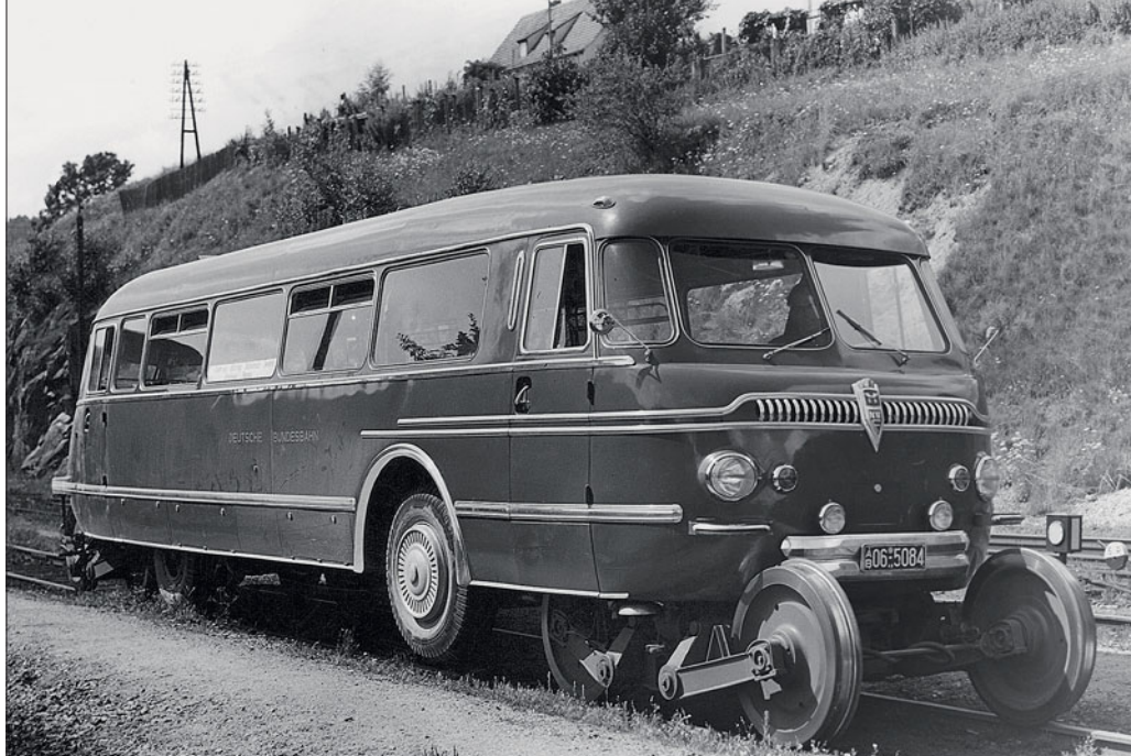
Oben: Der zweite Vorserienbus mit dem Kennzeichen AB 06 5084 ging noch im Jahr 1953 in den Planeinsatz. Im Unterschied zum ersten NWF-Bus hatte dieser nicht an jedem Seitenfenster Lüftungsschieber.
