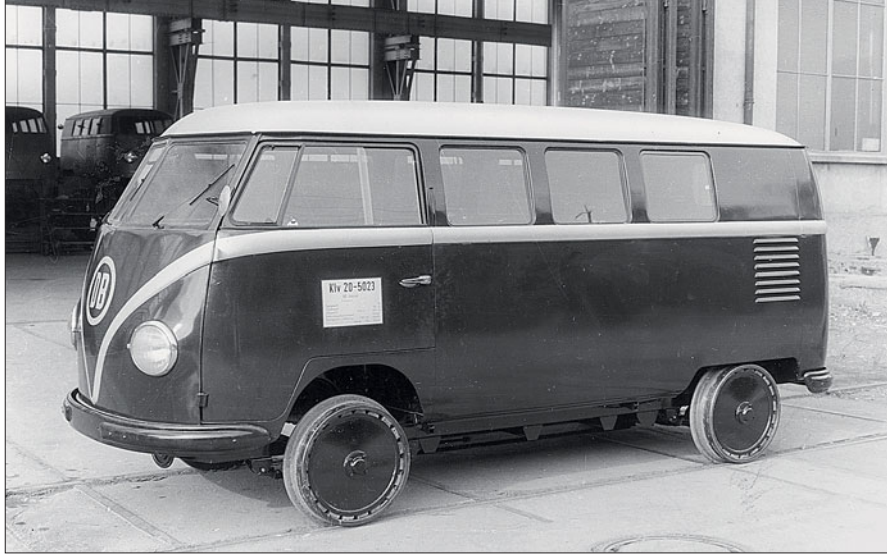
Der klassische VW-Bus auf Schienen – der Klv 20 5023 im Ablieferungszustand auf dem Werksgelände von WMD in Donauwörth. Foto: WMD
