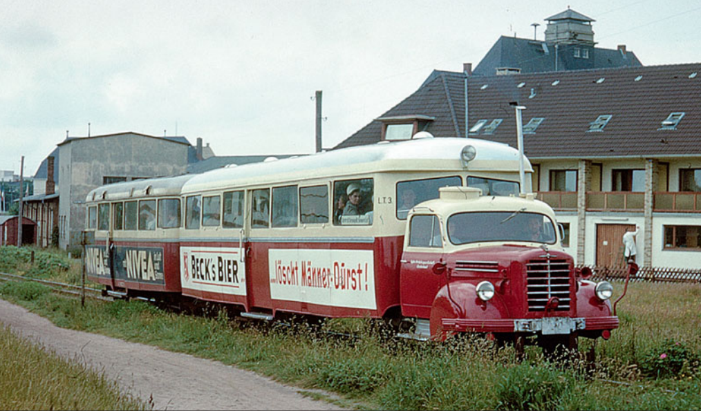
Die Sylter Verkehrsgesellschaft benutzte für ihren 1952 gebauten LT 1 als Zugfahrzeug einen Borgward-Lkw mit verkürztem Chassis. Der dazu passende Auflieger entstand in der Westerbahn-Werkstatt. Am 25. Juni 1966 verlassen LT 1 und Beiwagen 7 gerade den dortigen Kleinbahnhof in Richtung List. Foto: Dr. Löttgers
