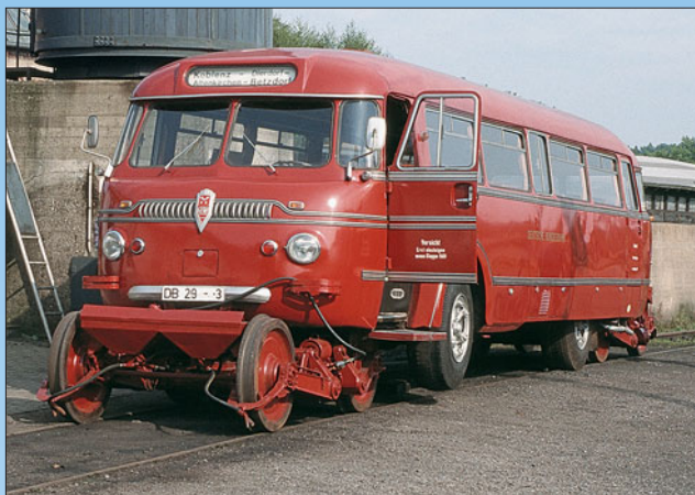
Links der Schi-Stra-Bus im aufgegleisten Zustand. Deutlich ist die Hauptluftleitung zwischen Bus und Spurwagen zu erkennen. Oben der vordere Spurwagen mit aufgestecktem Sandkasten.
