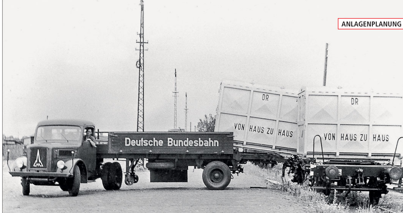
Von Beginn an dominierte bei den Straßenzustellfahrzeugen die Marke Magirus. Ein S 3500 bei der Demonstration eines Umsetzvorgangs von mit „DR“ beschrifteten Großbehältern. Foto: Archiv Michael Meinhold
