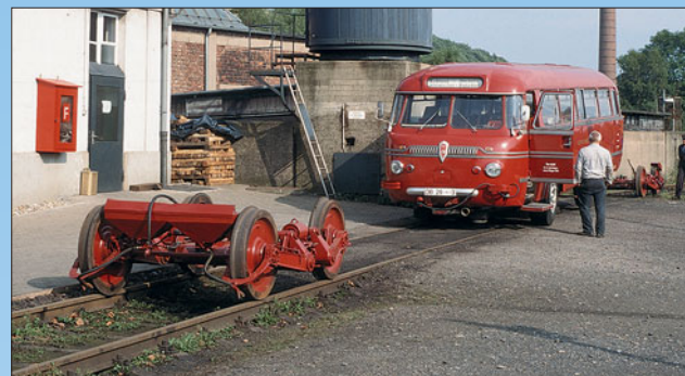
Links der Schi-Stra-Bus im aufgegleisten Zustand. Deutlich ist die Hauptluftleitung zwischen Bus und Spurwagen zu erkennen. Oben der vordere Spurwagen mit aufgestecktem Sandkasten.
