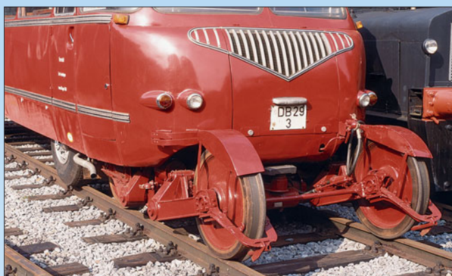
Die Luftleitung für die Bremse schließt zwischen den Radsätzen am Steuerventil unter dem Bremszylinder an (links).
