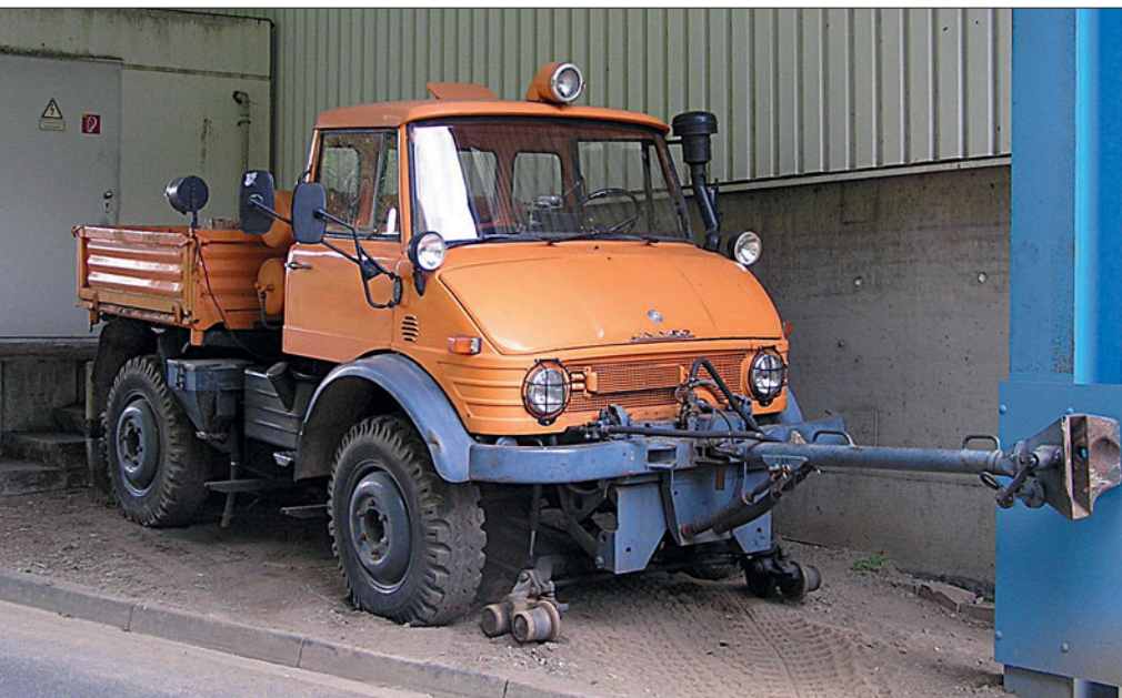
Der erste Zweiwege-Unimog 1967 hatte das gleiche Basisfahrzeug wie dieses heute bei der Firma Walzen Irl in Deuz als Reserve für eine V 60 vorgehaltene Modell – nur dass er damals noch kufenförmige Spurhalter besaß. Foto: Dr. Löttgers
