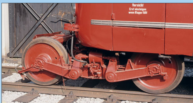
Die Luftleitung für die Bremse schließt zwischen den Radsätzen am Steuerventil unter dem Bremszylinder an (links).
