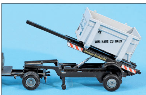
Die Tragschienen besitzen am vorderen Ende eine Verbindungsnase und unten eine deltaförmige Rollenaufnahme.
