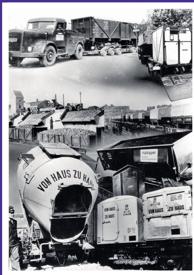
„Behältertragwagen mit 3 Eoskrt für Schüttgüter (offene Behälter mit Planen, kranbar, rollbar, mit senkrechten Wänden und Türen. Ladegewicht eines Eoskrt: 5 t, Inhalt eines Eoskrt: 7,6 m 3 “ ist die Original-Aufschrift auf der Rückseite dieses Pressebildes der DB.
