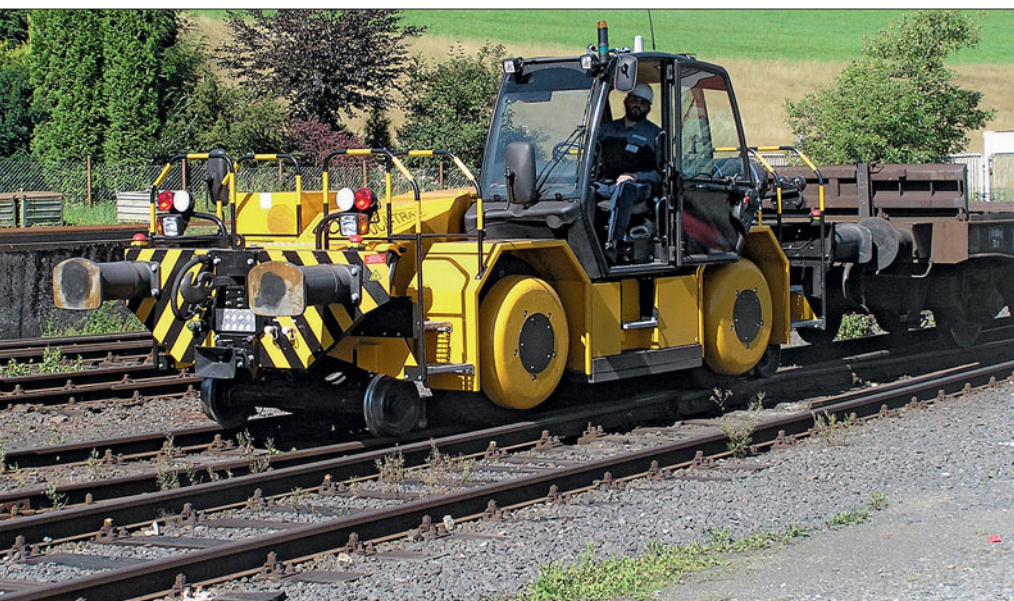
Seit 2008 erledigt bei Gontermann-Peipers in Siegen-Kaan ein belgischer Zweigege-Rotrac den Verschub der mit Kokillen oder Walzen beladenen Wagen. Foto: Dr. Löttgers
