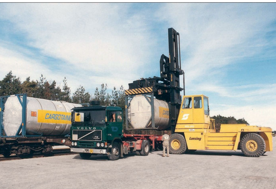
Die Verladung von Containern von der Schiene auf die Straße kann alternierend zum Portalkran durch Containerstapler ausgeführt werden. Die Aufnahme im Containerbahnhof in Wels (Oberösterreich) stammt aus den 1980er-Jahren. Foto: Manfred Peter
