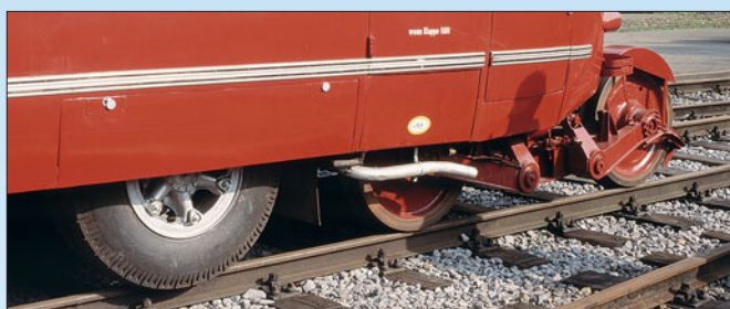
Unter der hinteren linken Tür befindet sich der Auspuff, der so angeordnet ist, dass er die Spurwagen in ihrem Lauf nicht stört.
