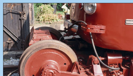
Die Luftleitung für die Bremse schließt zwischen den Radsätzen am Steuerventil unter dem Bremszylinder an (links).
