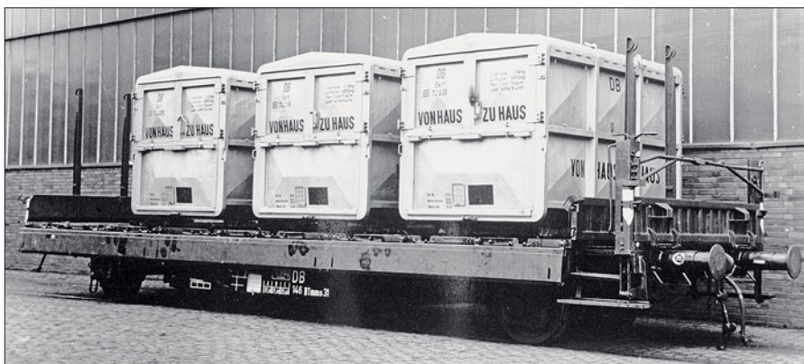
Unten: Auch etliche Vorkriegs-Rungenwagen wurden zu Behälter-Tragwagen umgebaut, wie dieser BTmms 31.
