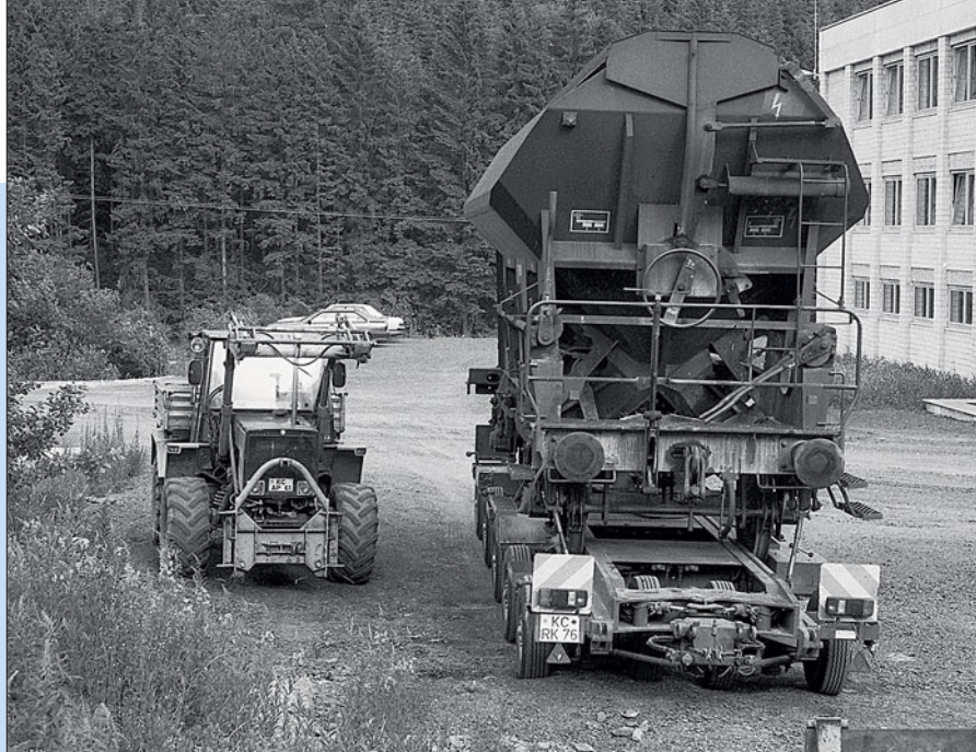
Wichtigstes Transportgut im „Tettauer Winkel“ ist Quarzsand, der in Td- (Ktmm-) Wagen gebracht wird. Neben dem Straßenroller steht eine Söllner-Zugmaschine.
