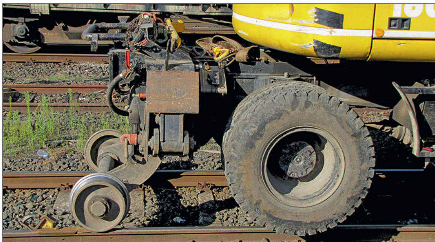
Die massive Konstruktion der Schienenführung beim Atlas-Kran ist hier gut zu erkennen. Unten: Im Rahmen von Gleiserneuerungsmaßnahmen im nördlichen Teil des Bahnhofs Siegen transportiert ein Liebherr A 900 ausgebaute Schienenstücke ab.
