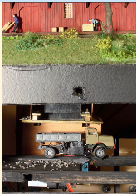
Der entladene H 6 hat von der Schüttrampe kommend unter dem Einfülltrichter angehalten. Unter dem umgebauten Brekina-Modell erkennt man Akku und Servo.
