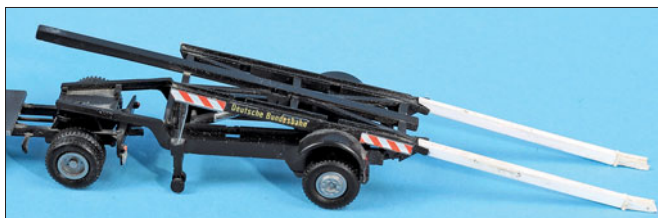
Die Tragschienen besitzen am vorderen Ende eine Verbindungsnase und unten eine deltaförmige Rollenaufnahme.
