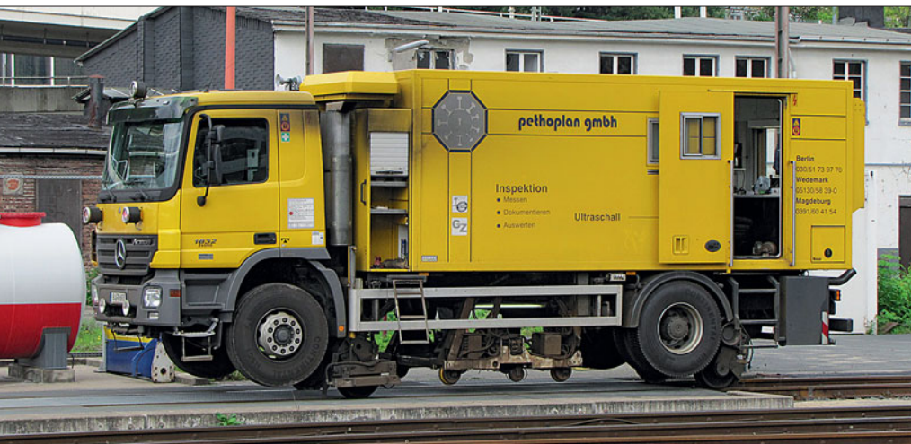
Dieser schienengängige Actros 1832 ist für 80 km/h zugelassen. Die Kraftübertragung erfolgt hydrostatisch auf die einachsigen Fahrgestelle. Gut zu erkennen sind die in Fahrzeugmitte unter dem Wagen angebrachten Ultraschall-Prüfköpfe. Foto: Dr. Löttgers
