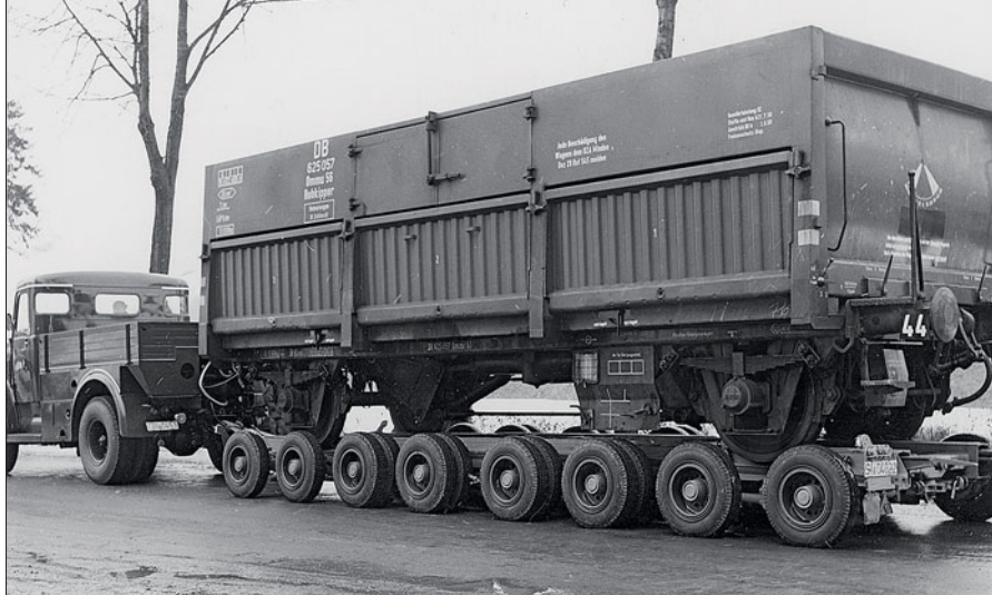
Ein achtsachsiger SEAG-Straßengerät LR 40.3 von 1958 mit einem von der SEAG entwickelten Hubkipper.
