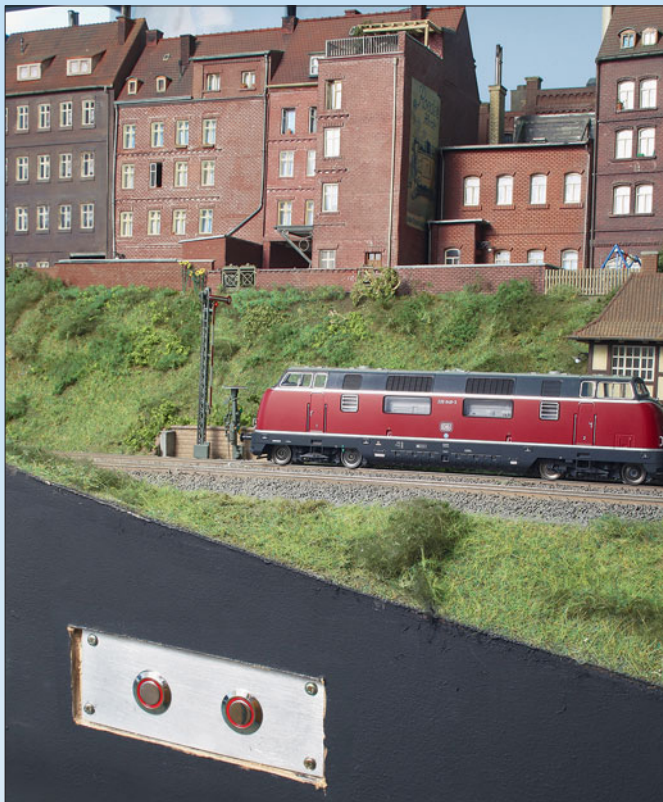
Die ABC-Blockstellensteuerung kann mittels Schalter zum Anhalten der Züge im Haltepunkt „Stehle-Ost“ unterbrochen werden.
