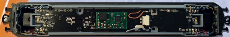
Abb. zeigt Einbaubeispiel - Art.: 82660 T125-PluX16 in TT V180 von Piko.
