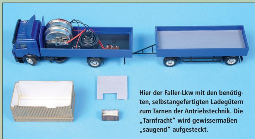
Hier der Faller-Lkw mit den benötigten, selbstangefertigten Ladegütern zum Tarnen der Antriebstechnik. Die „Tarnfracht“ wird gewissermaßen „saugend“ aufgesteckt.
