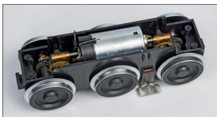
Links: Blick in das Drehgestell: Auf der Motorwelle sitzen zwei Messing-Schnecken, das restliche Getriebe besteht aus Kunststoffzahnradern. Alles ist ab Werk gut geschmiert ...
