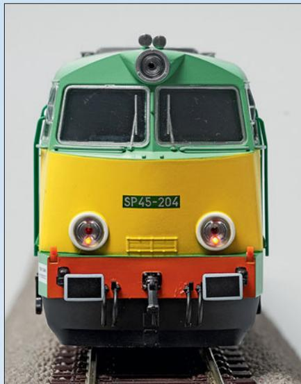
Die für unsere Verhältnisse schon fast riesigen Frontlampen werden durch winzige Öffnungen hindurch direkt mit warmweißen und roten LEDs korrekt illuminiert.
