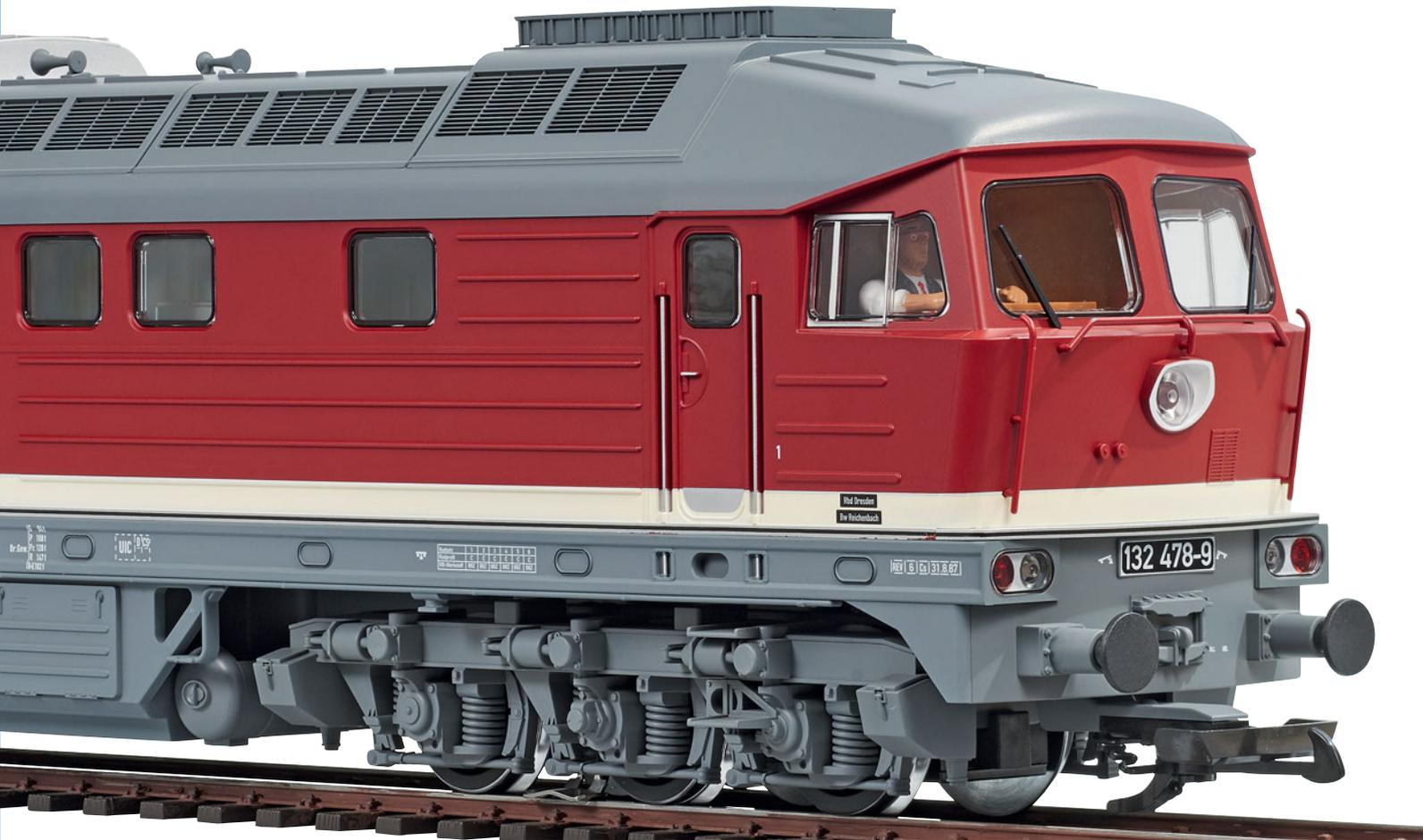
ses nicht durchbrochen. So bleibt die Elektronik der Lok auch unter widrigen Wetterbedingungen trocken und geschützt. Der Abgasauslass wurde offen ausgeführt, um bei Bedarf die Nachrüstung eines Rauchgenerators zu ermöglichen. Piko hat ein Vorbild mit alten Lüftern gewählt, dies ermöglicht ein Maximum an Farb- und Bedruckungs-
