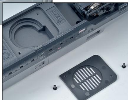
Fixiert wird der Motor durch einen Kunststoffrahmen, an dessen Seitenwänden die Andeutungen des Maschinenraums hinter den Fenstern eingraviert sind und der passend für die Aufnahme von Decoder und Stützkondensator ausgebildet ist. Der Platz für den Lautsprecher befindet sich auf der
