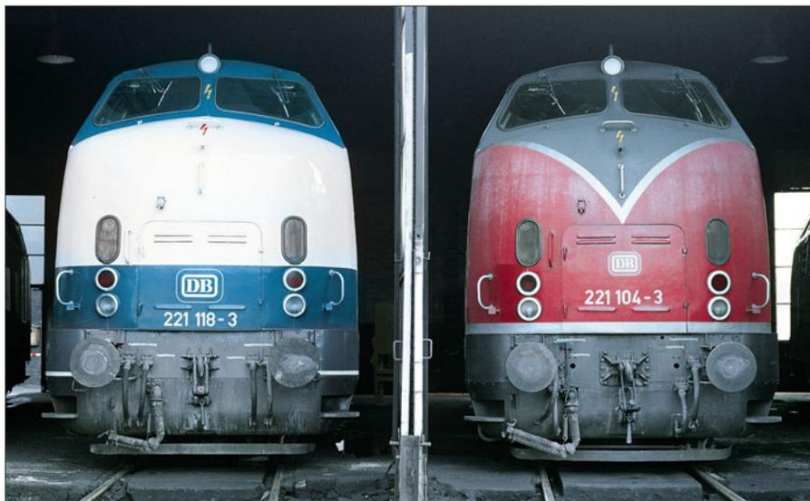
Im Hinblick auf die – dann doch nicht eingeführte ZAK – wurden andere Zughakenführungen eingesetzt und die Schlauchanschlüsse versetzt. Links die alte Version und rechts die neue.
