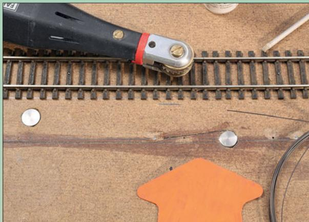
Abschließend muss der eingelassene Lenkdraht verspachtelt werden, um eine glatte Straßenfläche zu erhalten – die Car-System-Fahrzeuge geraten sonst sehr leicht ins Straucheln ...
