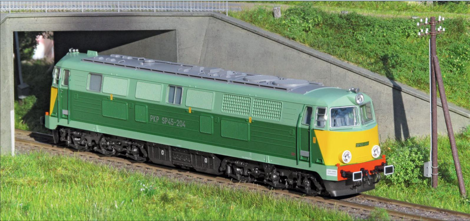
Farbegebung und Bedruckung zeigen eine gute Qualität. Dass die Ziffern der Baureihenbezeichnung per Tampondruck (und damit nicht erhaben wie beim Original) aufgebracht wurden, ist im Hinblick auf weitere Varianten verständlich. Die Trennschärfe zwischen der gelben Frontfläche und dem Grün der Seiten ist nicht bei allen bisher gelieferten Modellen vollendet präzise.
