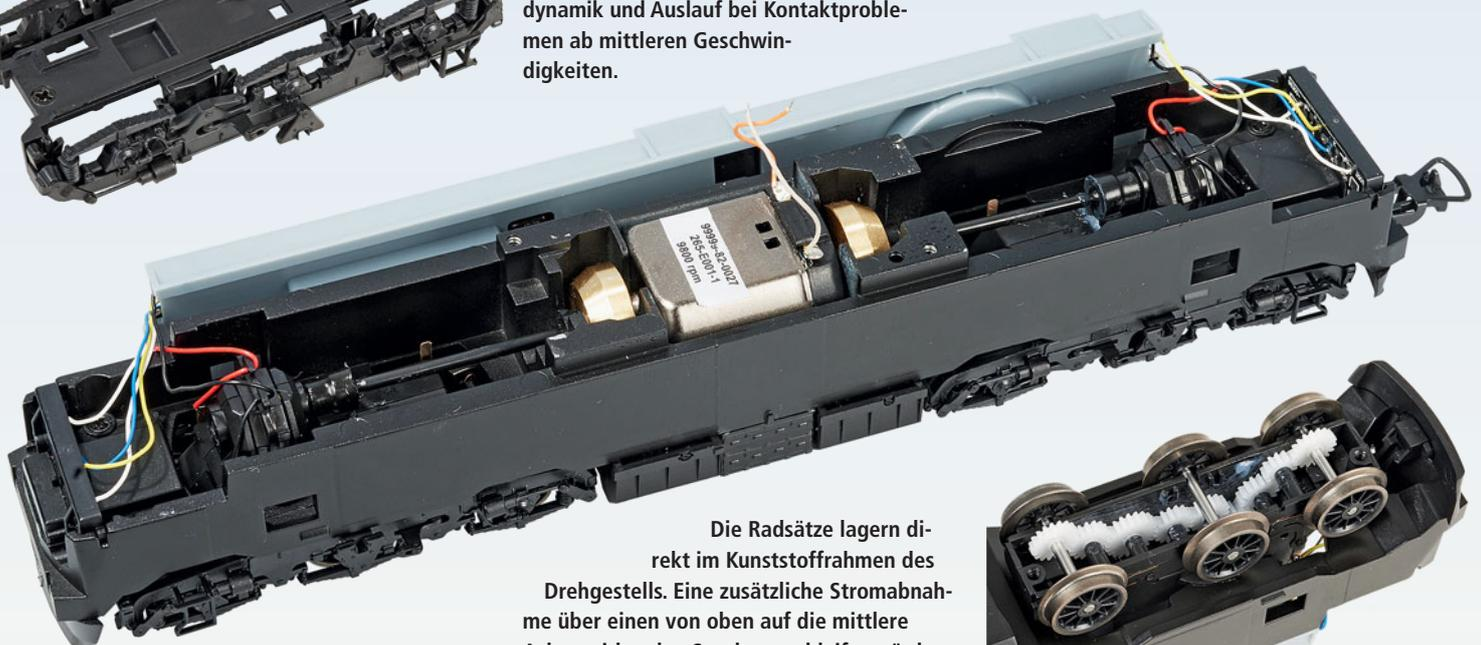
Die Radsätze lagern direkt im Kunststoffrahmen des Drehgestells. Eine zusätzliche Stromabnahme über einen von oben auf die mittlere Achse wirkenden Spurkranzschleifer würde die Kontaktsicherheit der Lok verbessern.
