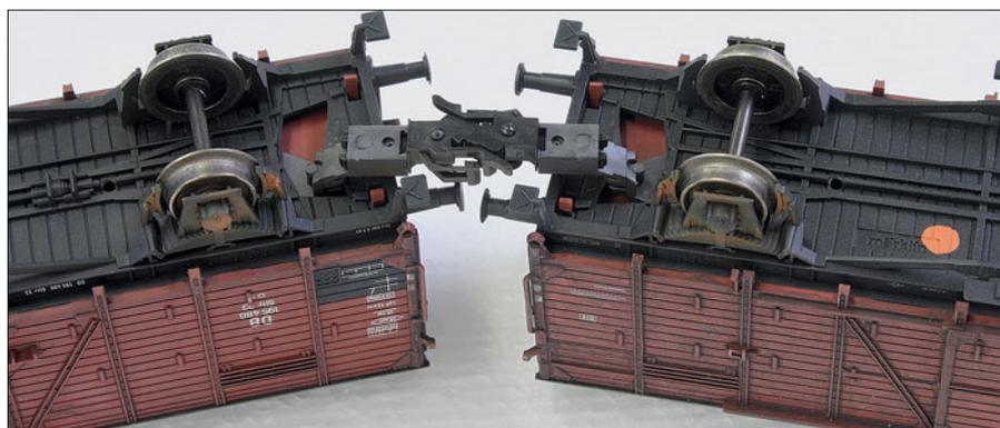
Das Charakteristikum einer wirklichen Kurzkupplung ist das Puffer-an-Puffer-Fahren. Damit sich die Puffer in Kurven und bei Weichenverbindungen nicht verhaken, sorgt die Kulissenführung dafür, dass die Kupplungsdeichsel bei der Fahrt durch einen Gleisbogen weiter nach außen geführt wird. Dann ist nur noch das „innere“ Pufferpaar nahe beieinander.
