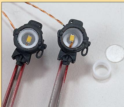
Das heißt, dass der Motor weniger Strom benötigt als die Beleuchtung. Nicht nur das hat mich bewogen LEDs einzusetzen, sondern auch der Umstand, dass zwei verdrehte Kupferlackdrähte weniger Querschnitt haben, als ein einzelnes konventionell isoliertes Anschlusskabel der Glühlampen. Damit lässt sich der Kupferlackdraht besser, sprich unauffälliger verlegen.
