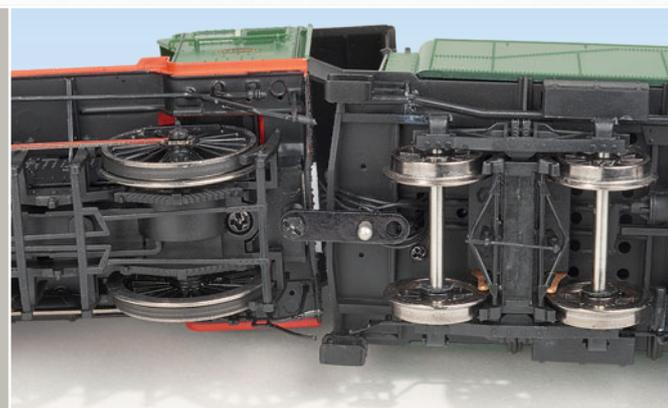
Der Antrieb erfolgt auf die letzte Kuppelachse. Lok und Tender werden über eine schlichte Deichsel verbunden.
