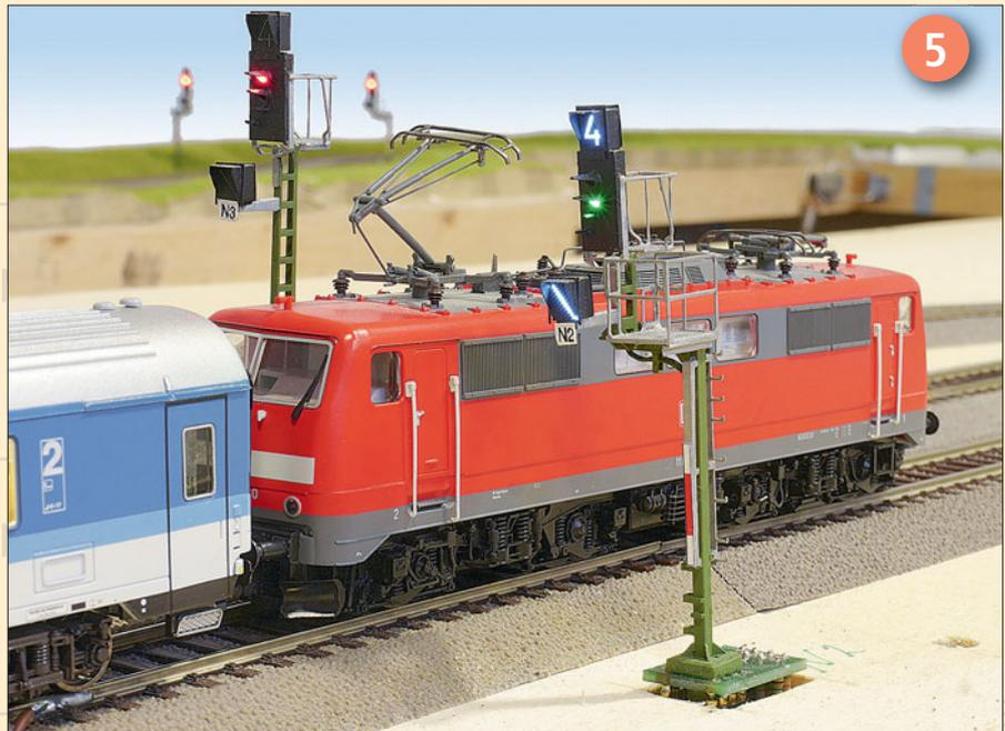
Ausfahrt für IR 51001 von Gleis 2 in Richtung Hörsel. Das Ausfahrtsignal N2 übermittelt die Zustimmung zur Abfahrt und schreibt 40 km/h im anschließenden Weichenbereich vor.
