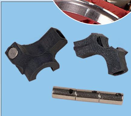
Der Magnetimpulsgeber für den rad-synchronen Auspuffschlag setzt sich aus zwei Kunststoffteilen und vier Magneten zusammen. Die zusammenhängenden Magnete wurden mit einem Eding auf einer Seite gekennzeichnet.
