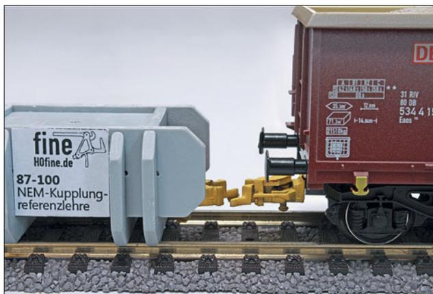
Auch bei den Kurzkupplungen ist eine Höhenjustierung erforderlich. Mit der NEM-Lehre von H0fine gelingt dies auch im laufenden Betrieb, weil der Kunststoff keinen Kurzschluss verursacht, wenn er auf die Schienen gesetzt wird.
