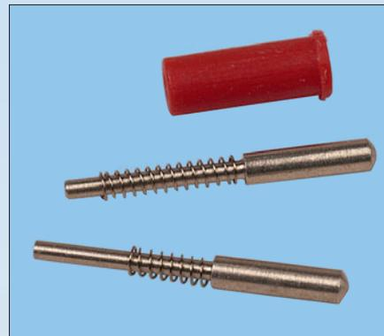
Die Stromabnahme von den Rädern erfolgt über federnd in Kunststoffhülsen gelagerte Stifte (Pilzkontakte). Um den Anpressdruck und den damit einhergehenden Rollwiderstand etwas zu reduzieren, wurden die Federn um gut 1/3 gekürzt.
