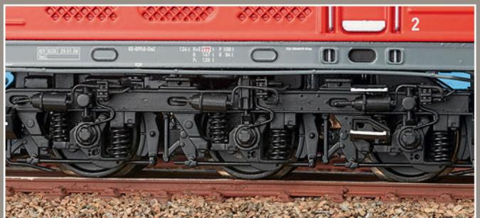
Die Drehgestelle sind minuziös in ihren Details nachgebildet. Viele Teile wie Bremszylinder, Achslagerdeckel mit S-förmig angesetzten Leitungen und Bremsanlage sind extra montiert.
