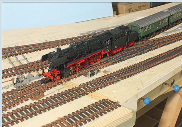
Vor Beginn des Schotterns, aber nach der Farbgrundierung der Gleise, muss alles mechanisch und elektrisch funktionieren. Zum Test werden die Gleise zumindest provisorisch elektrisch angeschlossen und alle Gleise mit entgleisungsempfindlichen Fahrzeugen, etwa mehrachsigen Loks und Dreiaxsern, abgefahren.
