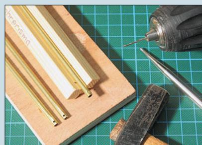
Oben: Um die Schubstangen aus 4-mm-Messingrohr mit den Umlenkhebeln zu verbinden, werden in die Stangenenden 1-mm-Ms-Drähte eingelötet, die um 90° abgewinkelt in entsprechende Bohrungen in den Hebeln greifen. Hier ein Bohrprisma für Rohre aus zwei 8-x-8-mm- und einer 4-x-4-mm-Kiefernleiste. Bohrungen gut ankörnen!
