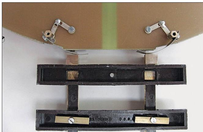
Federkontakte unter der Scheibe versorgen das Bühnengleis mit Fahrstrom.
