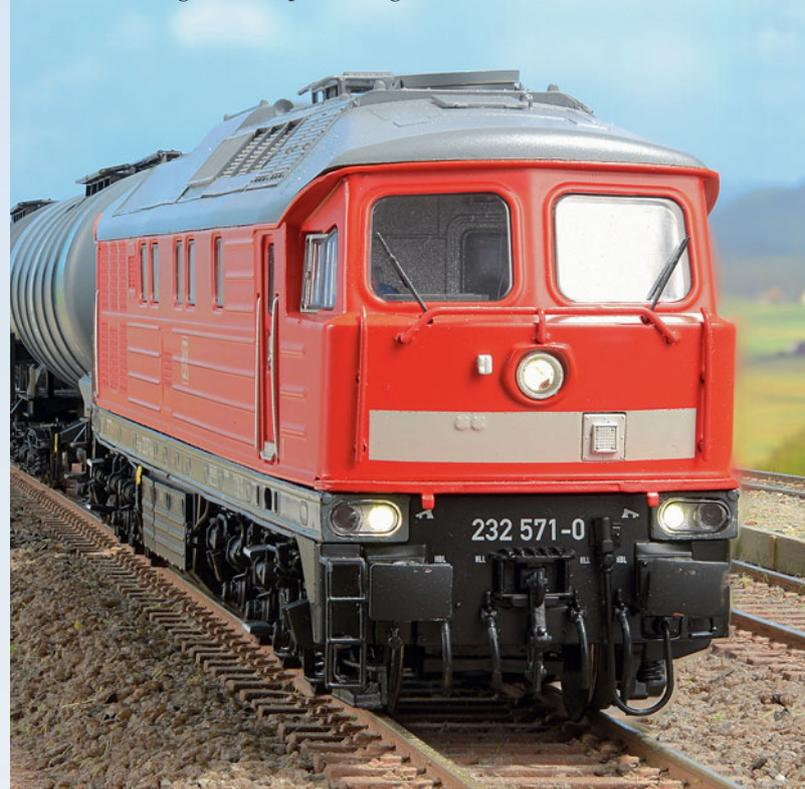
Für gute Durchlüftung sorgen die vorbildgerecht senk- und waage- recht durchbrochenen Lüfter in den Dachsträgen.
