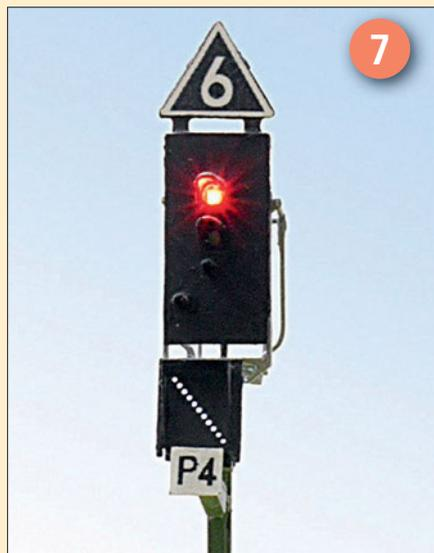
Auch die Bahn muss haushalten: Von Signal P4 (rechts) führt die Fahrt ausschließlich über mindestens eine im Abzweig liegende Weiche (hier Weiche 1). Das Zs3 kann daher als Formsignal ausgeführt werden. Dieses „Blechschild“ ist kostengünstiger als ein Lichtsignal, wie bei P3 (links).
