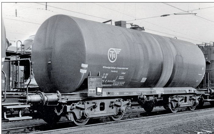
VTG-Kesselwagen im Wandel der Zeit. Links der 075 0 144 [P], aufgenommen im Dezember 1970: die Drehgestelle waren verstärkt und mit Rollenlagern ausgerüstet, aber immer noch mit Ketten gegen Durchdrehen gesichert. Rechts der 770 0 250 [P] Ende der 80er-Jahre im Hamburger Hafen auf der Hohen Schaar: Inzwischen sind die Gefahrguttafeln dazugekommen, die Holztritte durch Gitterroste ersetzt und die Ketten an den Drehgestellen entfallen. Fotos: Joachim Claus, Benno Wiesmüller
