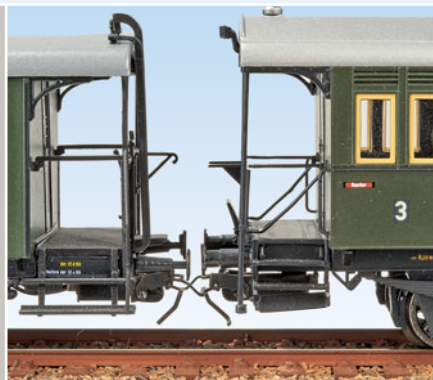
Die Flanken der beiden Haken führen nun die Bügel nach oben.
