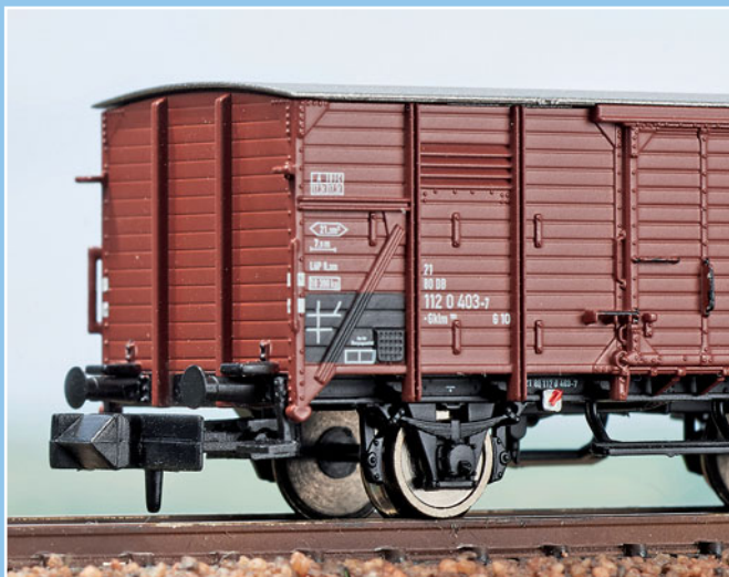
Die DB-Epoche-III- und -IV-Varianten besitzen Endfeldverstärkungen und hochkant auf den Stirnwänden montierte U-Profile.
