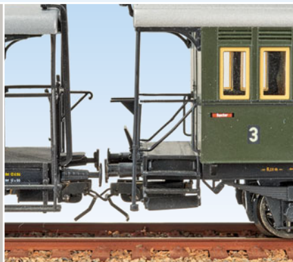
Die Bügel rasten hinter den beiden Haken ein und stellen eine starre Verbindung her.
