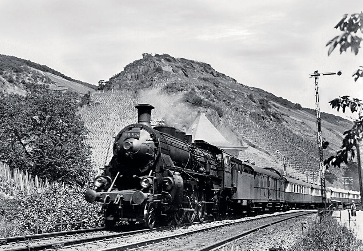
Bei dieser 18.5, die in den 30er-Jahren bei Boppard am Rhein mit dem Rheingold aufgenommen wurde, ist gut die an der Rauchkammertür fest angebaute Signalleuchte für das Signal 18, später als Zg 7 bezeichnet, erkennbar. Foto: Eisenbahnstiftung
